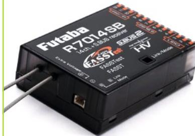
er auch S.BUS/S.BUS2-Komponenten sowie die Übertragungssysteme FASST und FASSTest. Ausgelegt ist er für eine Versorgungsspannung von 4,8 bis 8,4 Volt. Die Abmessungen betragen 50x37x15 Millimeter, das Gewicht 21 Gramm und der Preis 209,- Euro.
