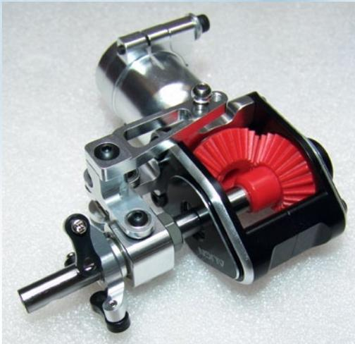
Auch im bereits vormontierten Heckrotor sind beim 760X die roten Kegelräder verbaut
