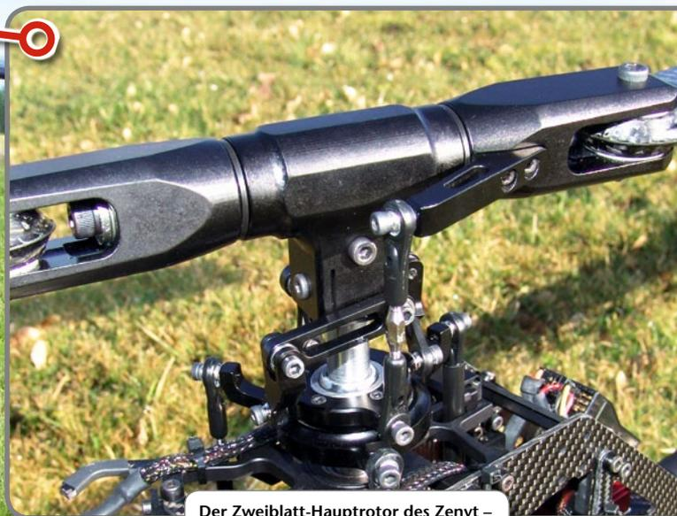
Der Zweiblatt-Hauptrotor des Zenyt – ebenfalls in Ganzmetall gefertigt und ausgerüstet mit klassischen Taumelscheiben-Mitnehmern
