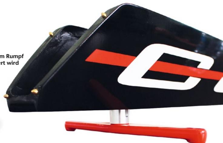
Für extremes Speedfliegen empfiehlt SAB, die Haube zusätzlich im Bereich des Carbon-Hebels mit Klebeband zu fixieren. Gemäß aktueller Information sollen ab sofort alle COMET-Hauben zusätzlich noch mit einer Schraube ausgestattet sein, um hier entsprechende Sicherheit zu bieten.
