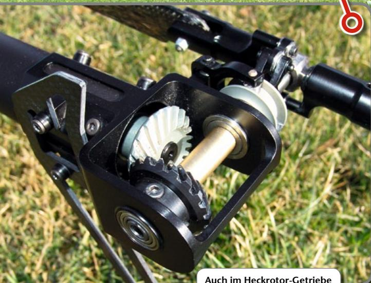
Auch im Heckrotor-Getriebe werden spiralverzahnte Kegelräder verwendet
