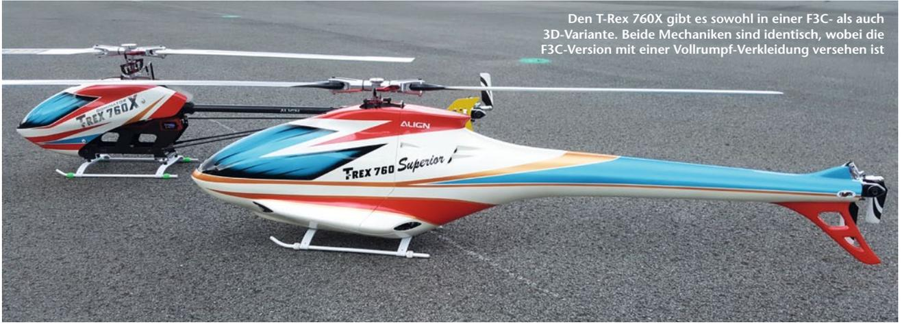
Den T-Rex 760X gibt es sowohl in einer F3C- als auch 3D-Variante. Beide Mechaniken sind identisch, wobei die F3C-Version mit einer Vollrumpf-Verkleidung versehen ist
