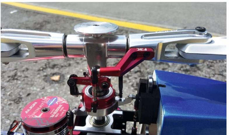
Der mit F3C-Anlenkhebeln und O-Ring-Dämpfung versehene EFL-Rotorkopf
