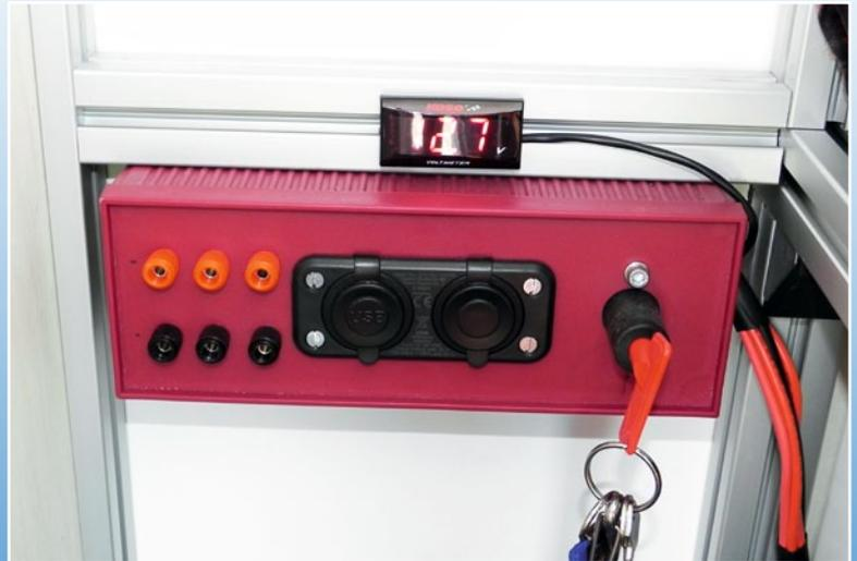
Die elektrischen Anschlüsse, wobei eine 12-Volt-Solarbatterie die Stromversorgung sicherstellt
