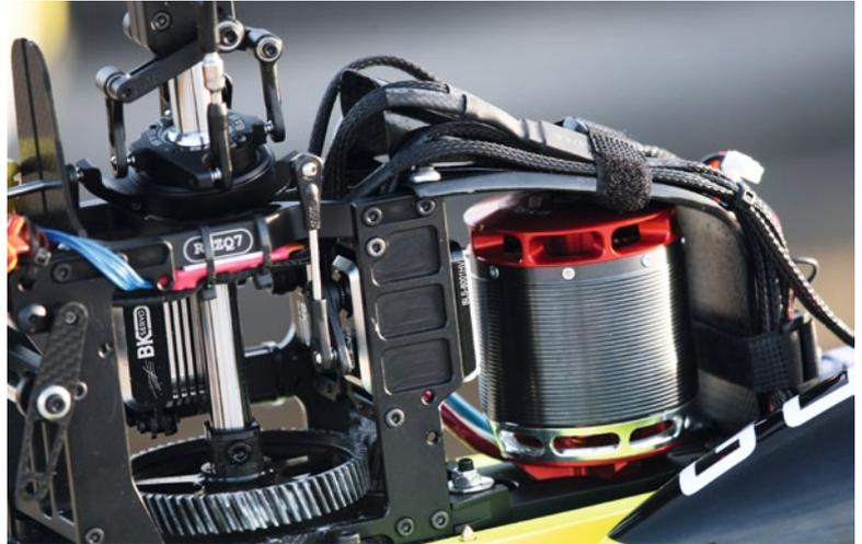
Das CFK-Motorschild dient auch hervorragend als Halt für die Kabelführung
