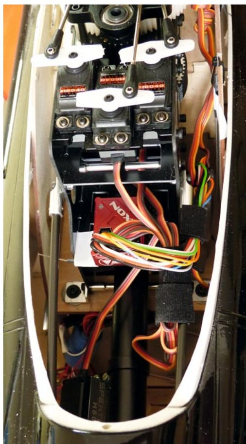
Da die Plattform vor den Servos nicht im 90-Grad-Winkel zur Rotorwelle sitzt, muss das AXON von BavarianDEMON geringfügig unterlegt werden
