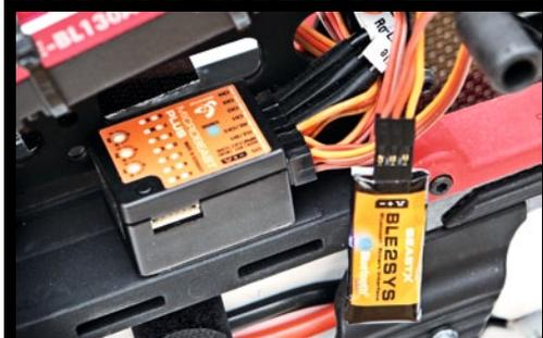
Zum Lieferumfang der T-Rex 760 X Super Combo gehört unter anderem auch das microbeast PLUS. Eine ausführliche Vorstellung dieses beliebten Flybarless-Systems aus dem Hause BeastX gibt es in RC-Heli-Action 02/2017. Das Heft kannst Du bestellen unter [www.rc-heli-action.de](http://www.rc-heli-action.de).
