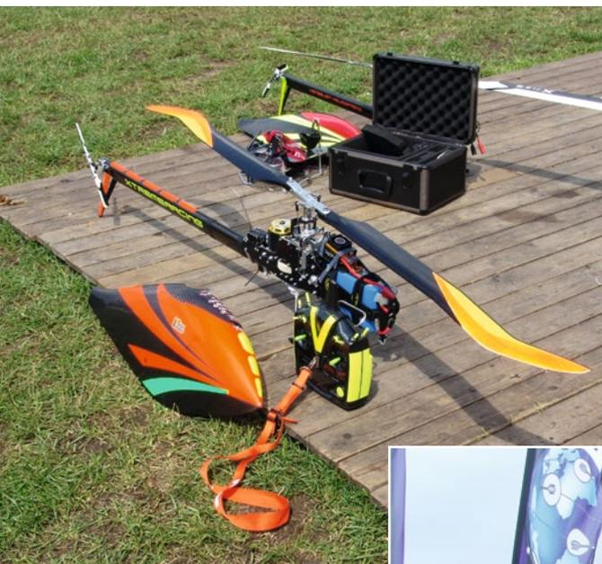
Spezialblätter am Henseleit TDS von Georges van Gansen mit sichelförmigem Randbogen. Diese Geometrie soll den maximal fliegbaren Anstellwinkel beim Speeden nach oben verschieben
