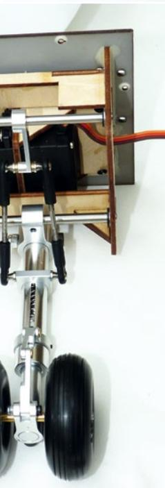
Das gefederte Bugfahrwerk mit Doppelreifen ist selbstverriegelnd, um das Servo zu entlasten
