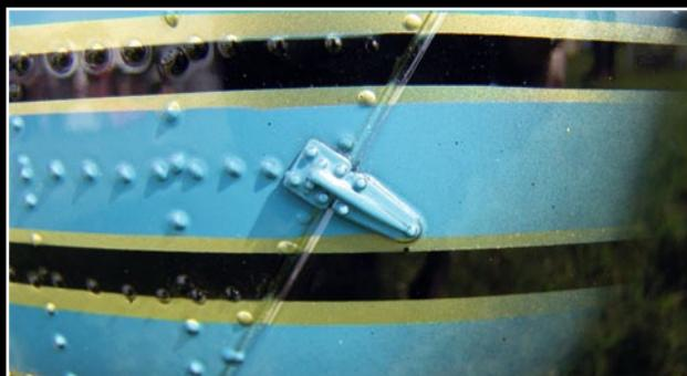
Bei der Firma Heli-Planet stehen verschiedene Muster und Größen an Nieten-Lochbändern zur Verfügung, um die Nietenreihen fachgerecht aufzubringen
