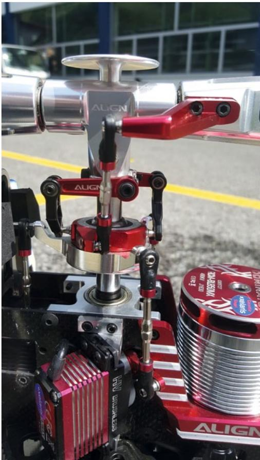
Bei der 120-Grad-Taumelscheiben-Anlenkung kommen die bewährten Align Hochvolt-Servos des Typs DS 820M zum Einsatz. Verstärkte Servohebel gehören zum Lieferumfang
