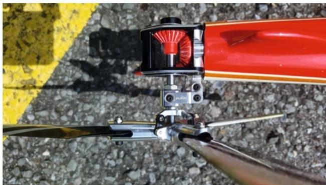
Serienmäßig rüstet Align den T-Rex 760X sowohl in 3D- als auch F3C-Version mit einem Dreiblatt-Heckrotor aus
