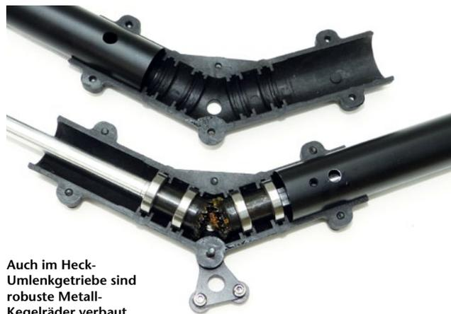
Auch im Heck-Umlenkgetriebe sind robuste Metall-Kegelräder verbaut
