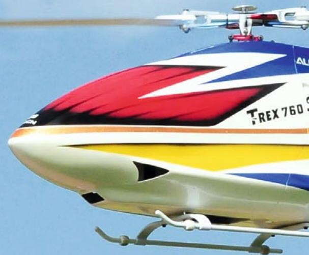
Ein genauer Bericht über den Heli – auch über den Aufbau – ist schon mit dem T-Rex 700X in RC-Heli-Action 12/2016 erschienen. Vieles, fast alles, ist identisch mit dem neuen T-Rex 760X. Die Haupt-Unterschiede bestehen darin, dass der 760X länger ist sowie einen größeren Rotordurchmesser und eine andere Heckrotor-Übersetzung in Verbindung mit einem Dreiblatt-Heckrotor bekommen hat.
