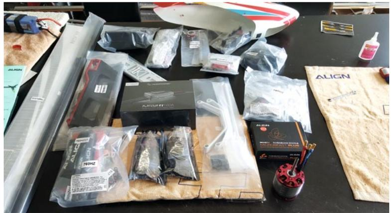
So präsentiert sich der Inhalt des Baukastens. Zum Lieferumfang der Super Combo gehören unter anderem auch der Außenläufer RCM-BL 850 MX, der Hobbywing-Controller Platinum HV 160A V4 und das Flybarless-System microbeast PLUS
