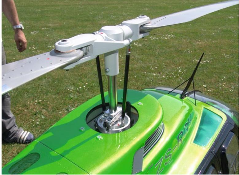
Das Zweiblatt-Hauptrotorsystem der Bell 206B3 mit den langen Ansteuergestängen
