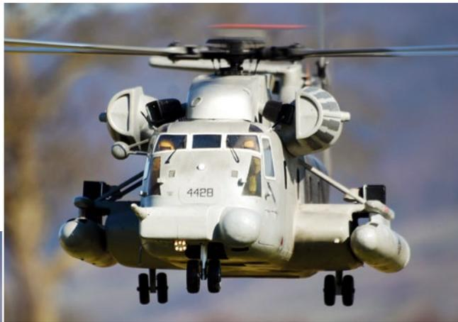
17 Kilogramm wiegt Roland Kaufmanns MH 53J Pave Low im Nachbau-Maßstab 1:11, die einen Rotordurchmesser von 2.000 Millimeter hat. Die Besonderheit: Das Modell wird von einem Benzin-Kettensägemotor mit einem Hubraum von 46 Kubikzentimeter angetrieben
