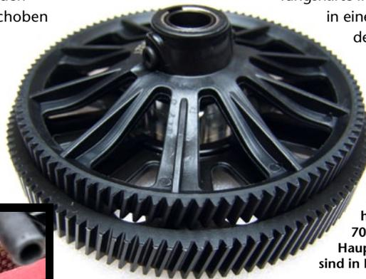
Das schrägverzahnte Autorotations-Zahnrad hat 102 Zähne (T-Rex 700X hat 104 Zähne), das Hauptzahnrad 112. Beide sind in Modul 1 ausgeführt
