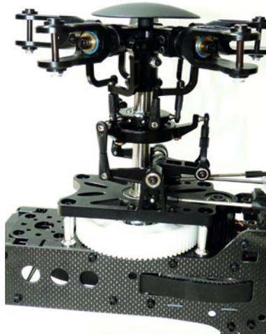
Rotoranlenkung nebst Taumelscheibe und Umlenkhebeln
