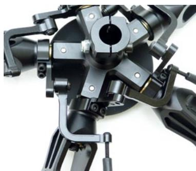
Die Blattlagerwellen des Fünfblatt-Rotors sind im Zentralstück mit Querstiften gesichert
