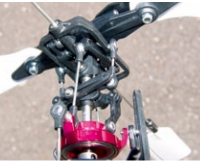
Blick von unten auf die Kunststoff-Steuerbrücke der Stabilisierungsstange, an der auch die kugelgelagerten Bell/Hiller-Mischhebel montiert sind
