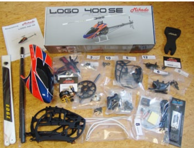
Die Combo des LOGO 400 SE beinhaltet die notwendigen Bauteile nach Baugruppen sortiert inklusive Motor, V-Stabi 5.0 Express blueline, Carbon Haupt- und Heckrotorblättern
