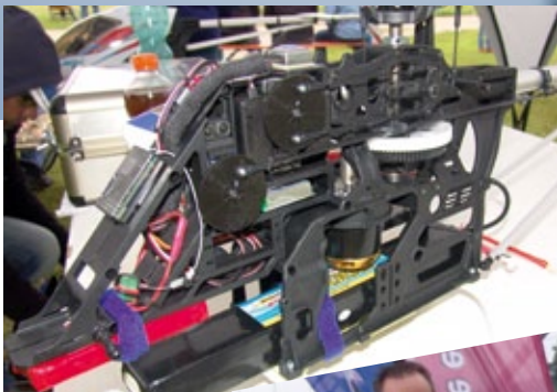
Das Referenzmodell der SDX Challenge, der Hirobo SDX in der Elektro-Spezial-Variante mit Scorpion-Antrieb sowie 6s-LiPo-Akku
