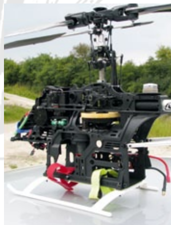
Bei der Mechanik setzt Stefan auf die serienmäßige Hirobo-SDX-Version; Abfluggewicht 3.600 Gramm. Seine Ausrüstung: Pyro 600-09, Jive 80, Gyro-System GY520 mit Heckservo BLS254, SLS-LiPo 6s/5.800 mAh
