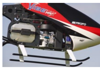
Man sieht am ruhigen Spritspiegel, dass die Tanklagerung ausgezeichnete Vibrationen absorbiert
