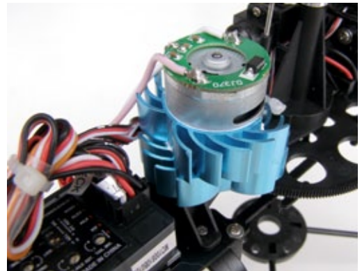
Bei der Montage des optionalen Kühlkörpers darf keinesfalls Wärmeleitpaste in den Motor gelangen. Auch die Kühlschlitze dürfen nicht verdeckt werden
