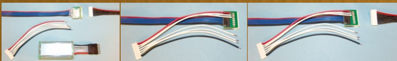
Links in den Bildern das Anschlusskabel des externen Balancers, rechts das Balancer-Anschlusskabel des Akkus. Um den LiPo-Checker einstecken zu können, wird dieser mit dem Kabel des Balancers parallel geschaltet
