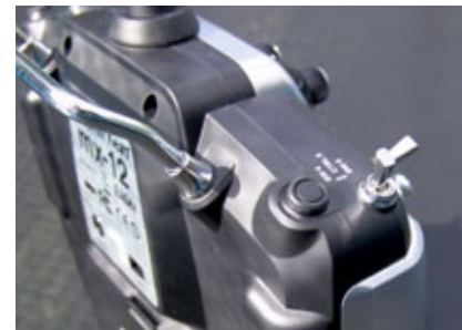
Das Sendergehäuse der mx-12 HoTT ist baugleich mit der mx-16 beziehungsweise mx-20. Serienmäßig sind bei der mx-12 jedoch nicht alle Schalterplätze belegt (Gummitüllen)
