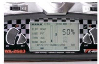
Am Sender musste die viel zu scharfe Pitcheinstellung reduziert werden. Hierzu können die im Kasten angegebenen Werte herangezogen werden, ebenso die dort beschriebene Vorgehensweise bei der Programmierung
