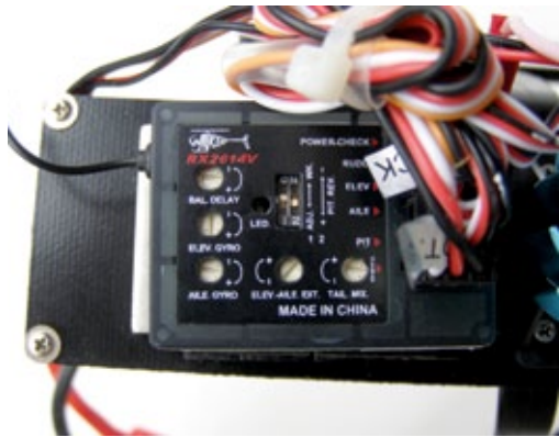
Die Regler an der Flybarless-Elektronik RX2614V standen bei der Auslieferung nahe der Mittelstellung. ELEV.GYRO haben wir stärker nach rechts eingestellt, ELEV.AILE. EXT wurde etwas reduziert (nach links drehen)
