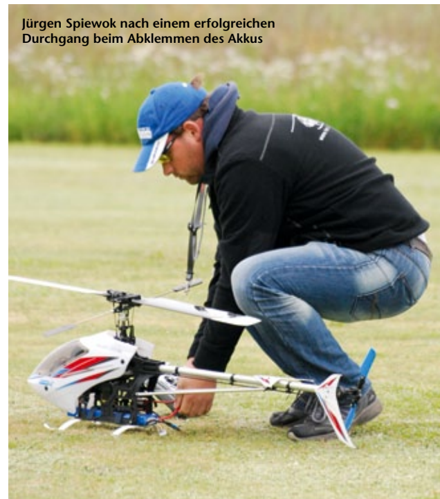
Das Referenzmodell der SDX Challenge, der Hirobo SDX in der Elektro-Spezial-Variante mit Scorpion-Antrieb sowie 6s-LiPo-Akku
