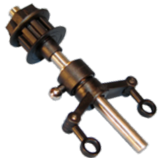
Die einzige vormontierte Baugruppe des Bausatzes: Heckrotorwelle samt Steuerbrücke
