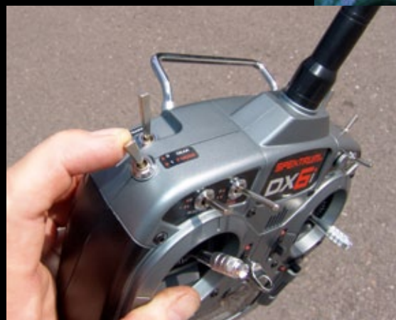
Das ist der besagte F-Mode-Schalter am Sender DX6i der vorgibt, welche Flugphase gerade aktiviert ist. Schalterstellung 0 => Normal, Schalterstellung 1 => Stunt
