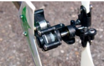
Die Heckrotorwelle ist doppelt kugelgelagert. Eine Alu-Andruckrolle verhindert das Überspringen des Zahnriemens
