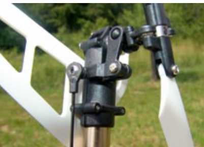
Ansicht des gleitgelagerten Heck-Umlenkhebels von unten, der direkt mit der Pitchschleibehülse verbunden ist
