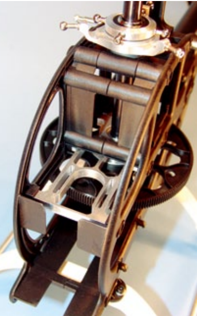
Die durchverschraubte, senkrechte Verrippung vor der Hauptrotorwelle steift das Chassis spürbar aus
