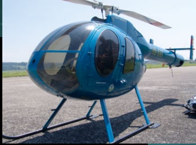
Die auf Elektroantrieb umgerüstete MD 520N mit NOTAR-System von Beat Sigrüst
