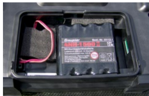
Der vierzellige NiMH-Akku mit 1.500 Milliamperestunden Kapazität. Ganz rechts im Akkuschlacht befindet sich auch der Slot für die Micro-SD-Card
