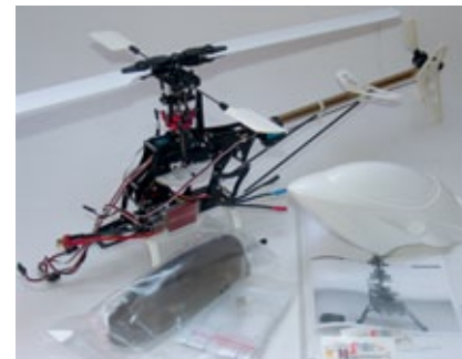
Lieferumfang des E-Max 400. Die Mechanik ist bereits inklusive vier Micro-Servos, Motor und Controller vormontiert
