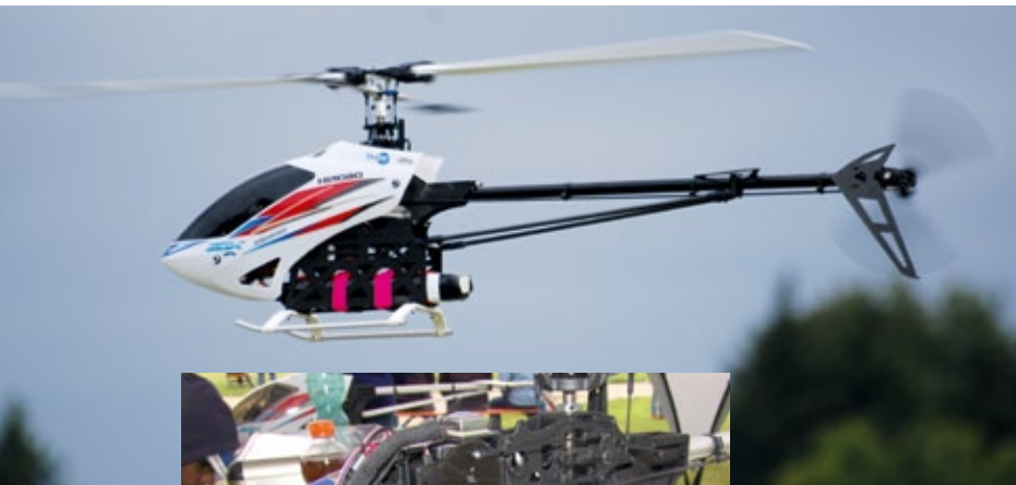
Das Referenzmodell der SDX Challenge, der Hirobo SDX in der Elektro-Spezial-Variante mit Scorpion-Antrieb sowie 6s-LiPo-Akku
