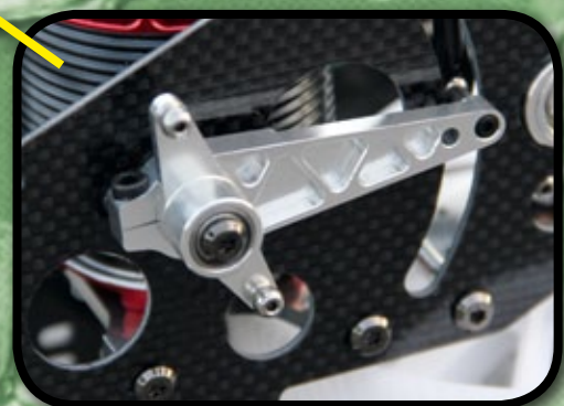
Einer der Hebel des Quick-Calibration-Systems, mit dem eine einfache, aber genaue Justage der Anlenkung ermöglicht wird
