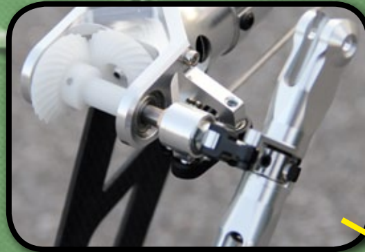
Im Heckrotor, der über eine Starrwelle angetrieben wird, agieren hochbelastbare Kegelräder mit Spiralverzahnung. Gehäuse und Blatthalter sind aus Alu
