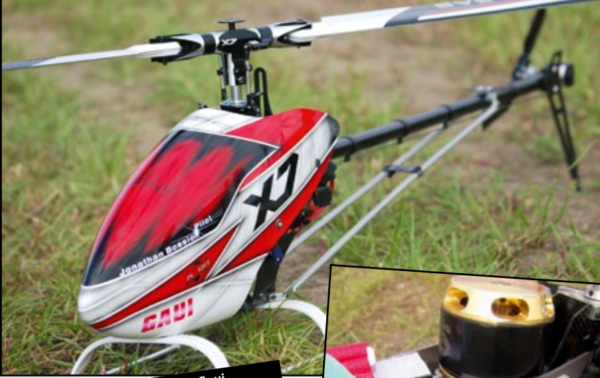
Der brandneue Gaui X7, von dem wir erste Prototypen sichten konnten. Man beachte die am Motorträger angebrachten Zusatzkühlbleche sowie die Gestängemitnahme des Flybarless-Kopfs
