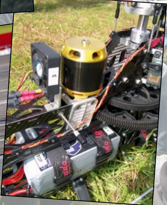
Der große LOGO XXtreme, Mikados neues 800-Heli-System, wurde gekonnt in Szene gesetzt von Kyle Dahl aus Bakersfield/USA sowie Andy Rummer. Bei den Detailfotos ist der Zusatzlüfter an Kyles Maschine zu erkennen, mit dem der Scorpion-Motor mit Kühlluft beaufschlagt wird
