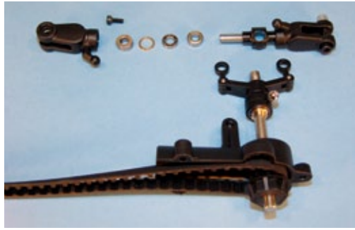
Die Blatthalter des Heckrotors sind mit Radial- und Axiallagern abgefangen. Die Anlenkkugel ist aus nahezu verschleißfreiem, verchromtem Messing
