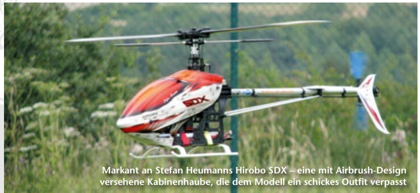
Bei der Mechanik setzt Stefan auf die serienmäßige Hirobo-SDX-Version; Abfluggewicht 3.600 Gramm. Seine Ausrüstung: Pyro 600-09, Jive 80, Gyro-System GY520 mit Heckservo BLS254, SLS-LiPo 6s/5.800 mAh
