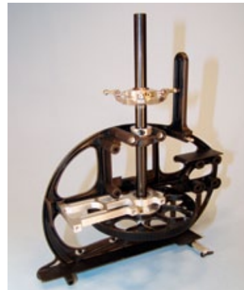
Hier sieht man den großen Lagerabstand der Hauptrotorwelle und davor die senkrechte Verrippung, die maßgeblich zur Steifheit des Chassis beiträgt
