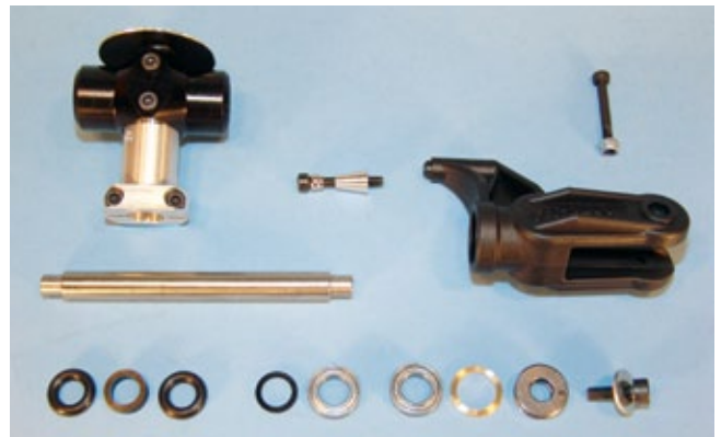
Der Rotorkopf mit seiner abgestuften, 8-mm-Blattlagerwelle. Dem Baukasten liegen unterschiedliche Kopfdämpfungen bei
