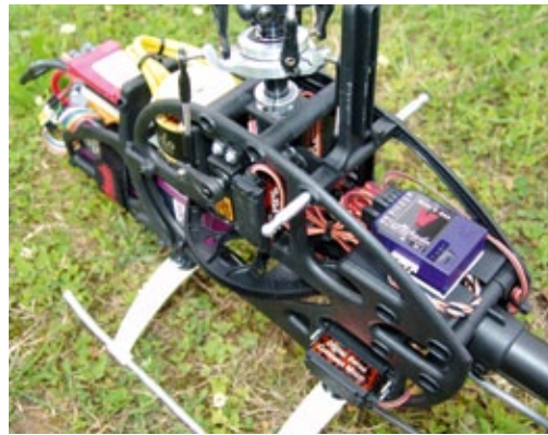
Das Mikado Mini V-Stabi sitzt auf der hinteren RC-Plattform und wird direkt von zwei Spektrum-Satelliten versorgt
