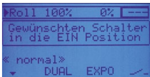
Alle Externschalter und Drehgeber lassen sich via Software den gewünschten Funktionen frei zuordnen
