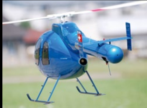
NOTAR bedeutet „no tail rotor system“ – es gibt keinen Heckrotor. Die Hochachsensteuerung erfolgt hier durch ein Luftschubsystem
