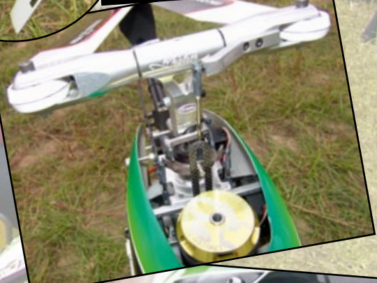
Bobby Watts aus den USA flog sowohl in seiner Demo als auch im Synchron-Wettbewerb den neuen Whiplash von Miniature Aircraft, der mit einem Scorpion HK4525-520KV motorisiert ist
