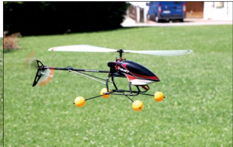
Für das erste Anfängertraining sollte in jedem Falle ein Trainingslandegestell montiert werden
