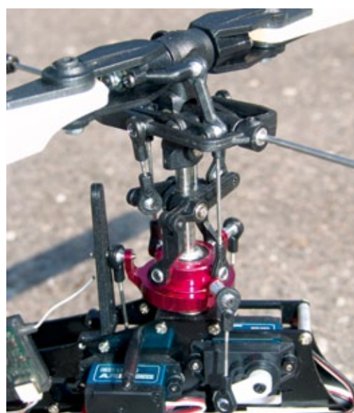
Der Zweiblatt-Hauptrotorkopf ist aus Kunststoff, die Taumelscheibe aus Aluminium gefertigt. Die Bell/Hiller-Mischhebel sowie der Pitchkompensator sind kugellagert
