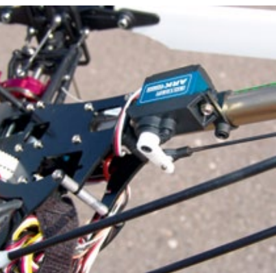
Das Heckrotorservo ist vorteilhafterweise am Heckrohr angeflanscht. Dadurch entfällt beim Nachjustieren des Zahnriemens eine erneute Gestängejustage
