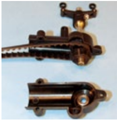
Beim 400 SE kann aufgrund des kurzen Riemens die sonst übliche obere Andruckrolle entfallen
