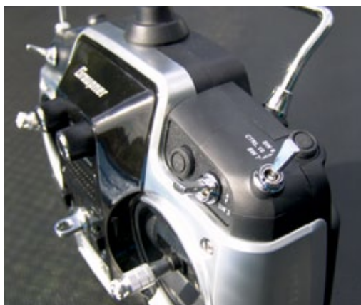
Alle Externschalter und Drehgeber lassen sich via Software den gewünschten Funktionen frei zuordnen
