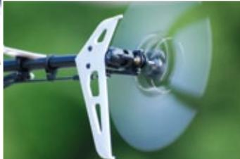
in den von hinten angelenkten Blatthaltern. Achtung dann auch beim Einstellen des Spurlaufs: Das Herausdrehen der Gestänge führt zu weniger Einstellwinkel und umgekehrt.
