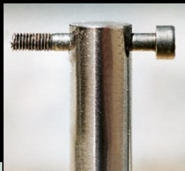
Schaftschrauben kommen besonders dort zum Einsatz, wo hohe Scherkräfte auftreten – wie hier bei der Rotorkopf-Befestigungsschraube, wo hohe Festigkeit am Ende der Querbohrung gefordert ist
