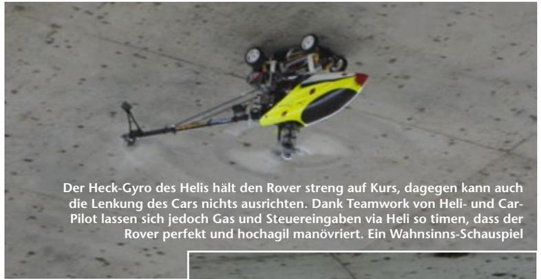
Der Heck-Gyro des Helis hält den Rover streng auf Kurs, dagegen kann auch die Lenkung des Cars nichts ausrichten. Dank Teamwork von Heli- und Car-Pilot lassen sich jedoch Gas und Steuereingaben via Heli so timen, dass der Rover perfekt und hochagil manövriert. Ein Wahnsinns-Schauspiel
