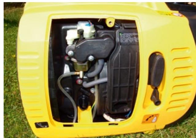
Die Verarbeitung macht auch im Inneren einen sehr guten Eindruck. Der Luftfilter ist leicht zugänglich. Der Ölfüllstutzen ist auch gleichzeitig der Ölablauf und sitzt unterhalb des Vergasers
