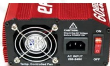
Die Geräterückfront mit einem der beiden, temperaturgesteuerten Lüfter, dem Netzanschluss und dem Betriebsschalter (kein Netztrennschalter)
