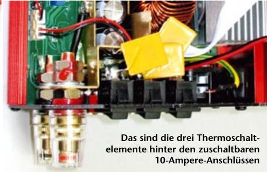
Das sind die drei Thermo-schalt-elemente hinter den zuschaltbaren 10-Ampere-Anschlüssen
