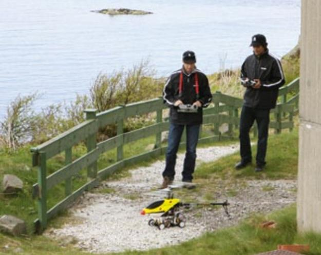
Der Air-Rover klar zum Einsatz: Ein T-Rex 600 von freakware ist mittels Spezialkufen auf einem Tamiya-Fighter befestigt
