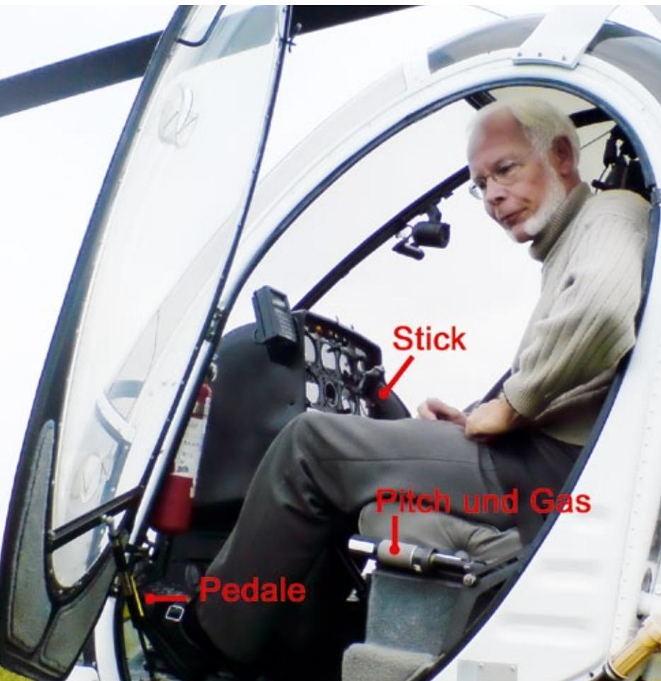
ten. So ermöglicht zum Beispiel die variable Pitchsteuerung negative Pitchwinkel und damit einen stationären Rückenflug. Dabei gibt es drei Varianten:
