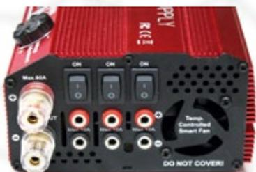
Die Frontpartie mit dem 60-Ampere-Hochlastanschluss und den drei zuschaltbaren 10-Ampere-Anschlussbuchsen
