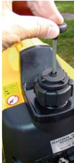
Gewusst wie: Die kleine Handpumpe im Tankverschluss erzeugt einen Überdruck, damit der Vergaser sofort beim Start mit Sprit versorgt wird
