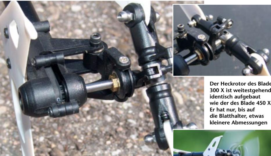
Der Heckrotor des Blade 300 X ist weitestgehend identisch aufgebaut wie der des Blade 450 X. Er hat nur, bis auf die Blatthalter, etwas kleinere Abmessungen
