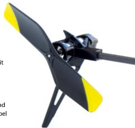
Einfacher geht es nicht: Heckantrieb mit einem gesonderten Motor, der eine Blattverstellung hinfällig macht. Die Hochachsen-Steuerung erfolgt ausschließlich über Drehzahländerung
