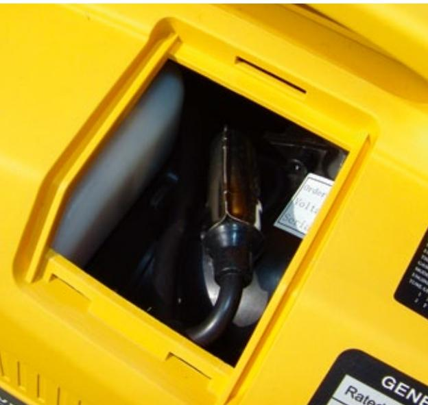
Die Zündkerze wird nach dem Abnehmen der oberen Service-Klappe zugänglich
