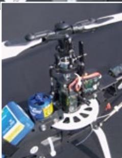
Der Zweiblatt-Rotorkopf mit durchgehender Blattlagerwelle und relativ weicher Dämpfung. Für die Mitnahme des Taumelscheiben-Innenrings sorgen zwei am Kunststoff-Zentralstück befestigte Arme
