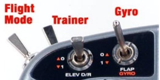
Mit dem auf der Stirnseite des Senders befindlichen Schalter „Flightmode“ schaltet man von Normal- auf Kunstflug um. Für das Heckrotor-Gyro-System gibt es zwei wählbare Empfindlichkeiten, die sich ebenfalls über die entsprechenden Schalterstellungen abrufen lassen
