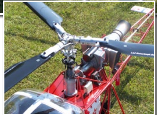
Die Lama von Bruno Ziegler, die mit einem Benzinmotor (Hubraum 29 Kubikzentimeter) angetrieben wird
