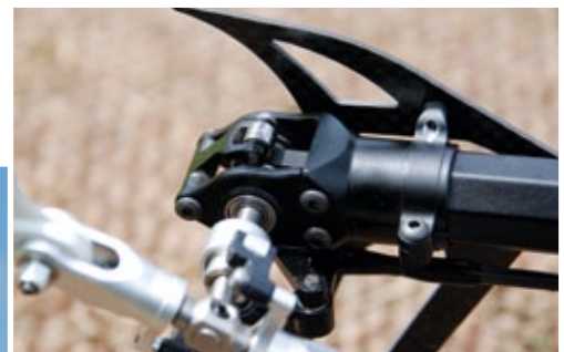
Kugellager sorgen dafür, dass der Riemen nicht überspringt
