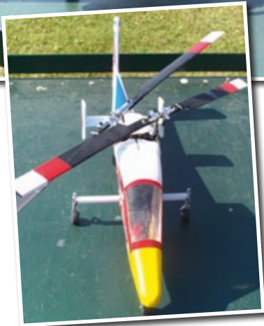
Seltene Rotor-Spezies – der Eigenbau-Flettner von Anton Thoma mit seinen ineinanderkämpfenden Rotoren
