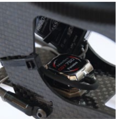
Das Flybarless-System Futaba CGY 750E V1.31, dessen Sensor unten im Chassis platziert werden kann. Die Kabel werden mit einer Raupe Heißkleber gesichert
