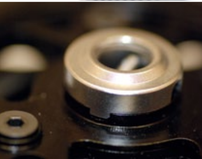
Nahaufnahme der Rotorwellen-Mitnahme mit Hilfe eines Passstifts. Dieser wird durch die Freilaufhülse geschoben und mit einem Deckel arretiert, wie auch der Auszug aus der Anleitung verdeutlicht
