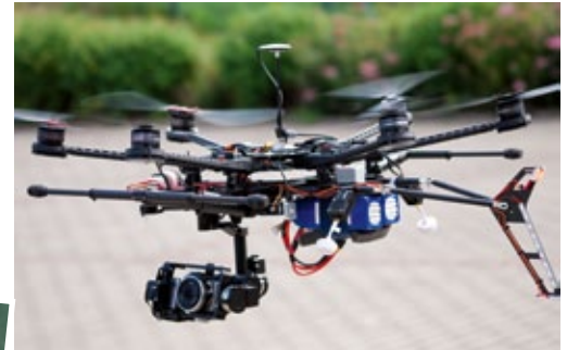
Während des Einsatzes wird das Landegestell ferngesteuert hochgeklappt, um der Gimbal-unterstützten Kamera in jede Richtung freie Sicht zu bieten
