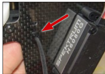
... und den innen liegenden Kabelstrang mit Kabelbinder, der in die Chassisbohrungen eingeführt wird, sichern. Wichtig: Der Kabelbinder soll nur die Klettbandschleufe fixieren
