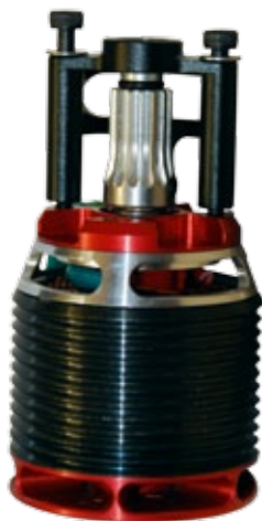
Das Gegenlager, das für einen geringeren Verschleiß der Motorlager sorgt, wird zusammen mit dem Motor am Träger verschraubt
