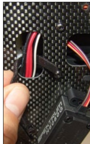
Chassis und Satellit gründlich entfetten und passend zugeschnittenes Doppelklebeband aufbringen
