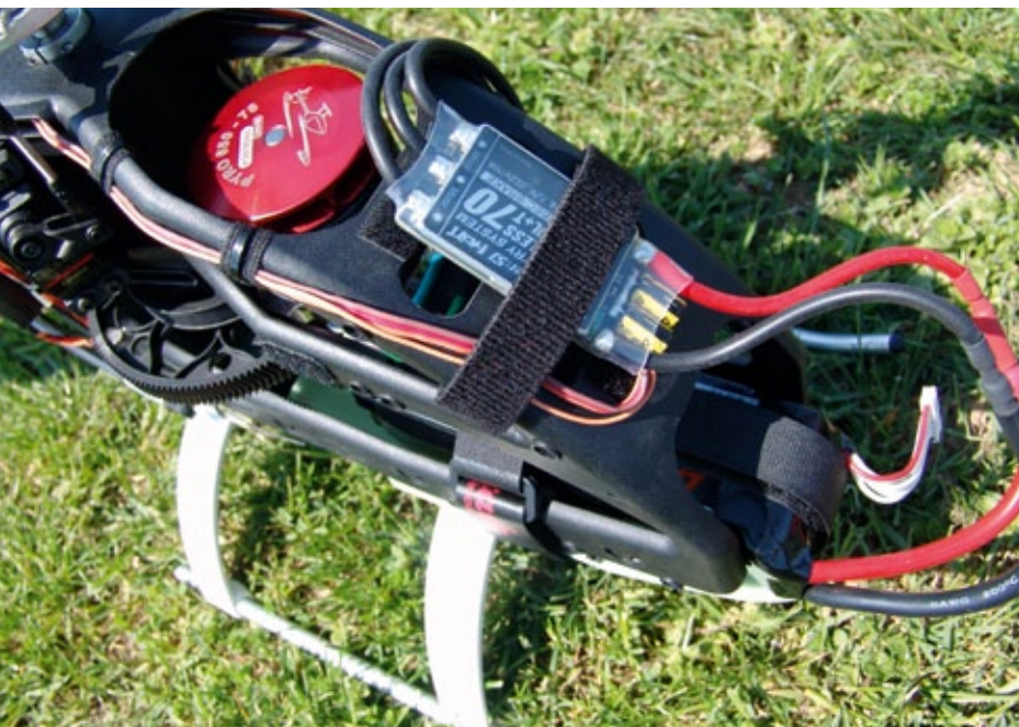
Als fliegender Teststand für den brushless control +T70 diente ein LOGO 500SE mit Pyro 650/78 an einem 6s-LiPo mit 5.000 Milliamperestunden
