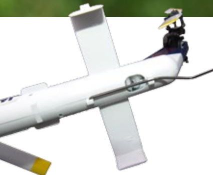
Unterseite des Heckauslegers. Hinter dem Hecksporn ist das Heck-Umlenkgetriebe erkennbar
