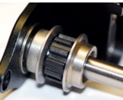
Das Zahnriemenrad des Heckrotors, ebenfalls dreiteilig konzipiert und mit Delrin-Verzahnung versehen
