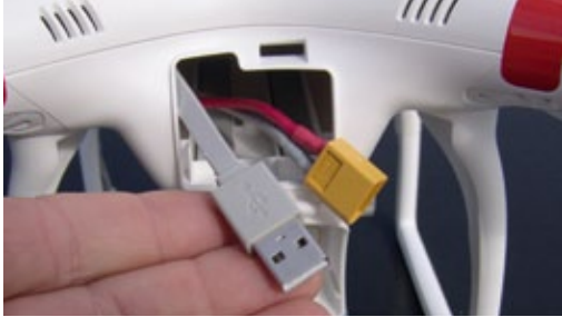
Die USB-Buchse des Phantom wird für Software-Updates mit dem Computer verbunden
