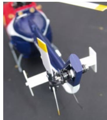
Der Heckrotor der BO-105 sitzt gemäß Vorbild auf der linken Seite, besitzt ein Kegelradgetriebe und Pitchsteuerung. Die Anlenkung ist zwar spielbehaftet, die Performance während des Betriebs ist jedoch zufriedenstellend
