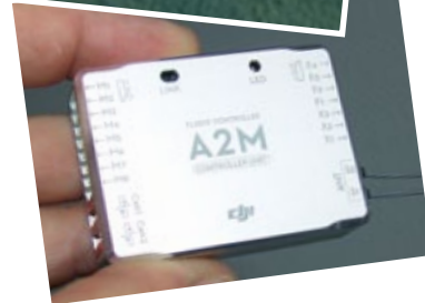
Neu im DJI-Programm ist der A2M Flight Controller in Aluminium-Gehäuse. Er hat einen integrierten Empfänger und bietet Anschlussmöglichkeiten für Satelliten. Neue Sensoren und eine leistungsstärkere IMU sollen für sehr gute Performance sorgen. Der A2M ist auch über Bluetooth/iOS-App einstellbar
