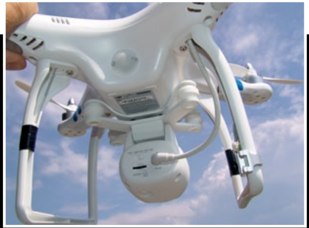
Rückseite mit micro-SD-Kartenslot und Ein-Aus-Schalter für Kamera und Funkübertragung
