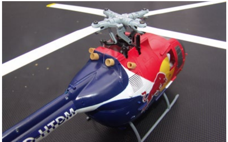
Blick auf die eingesetzten Auspuff-Attrappen und einen der beiden mit Schlitzen versehenen Lüftungsdeckel
