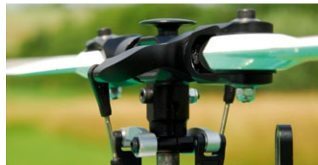
Die Blattverstellarme wurden so konstruiert, dass eine mechanisch einwandfreie Anlenkung gegeben ist – die Gestänge laufen nahezu 90 Grad zu den Anlenkarmen, der Weg ist somit symmetrisch
