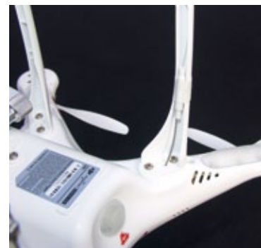
Die Empfangsantenne muss an der Kufe mit Klebeband gesichert werden
