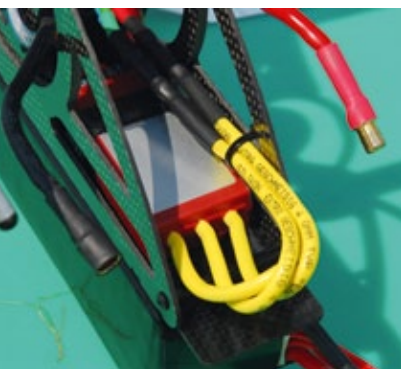
Der Kontronik Jive 100 LV sitzt unten an der Akkurutsche. Durch die Öffnung auf der Unterseite der GFK-Haube bekommen Controller und Motor ausreichend Kühlluft
