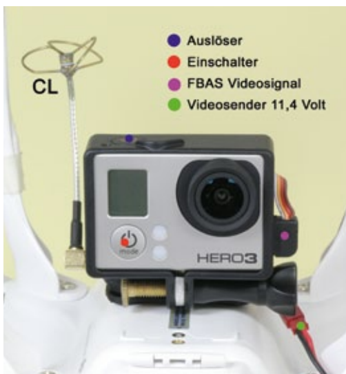
Komplette Montage für FPV mit guter Bodenfreiheit
