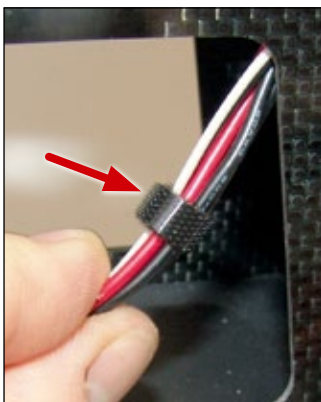
Controller- und BEC-Kabel mit Klettbandstreifen bündeln ...
