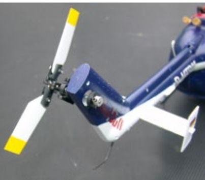
Extrem verwindungssteif und stabil ist der gesamte Heckausleger mit interner Carbon-Konstruktion
