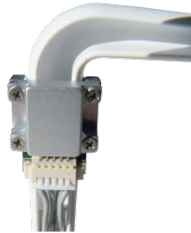
Befestigung des digitalen Kompasses mittels mehrpoliger Steckverbindung
