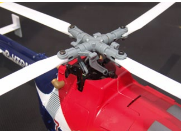
Sieht nicht nur klasse aus, sondern funktioniert auch bestens – der linkslaufende Vierblatt der BO-105. Die Anlenkgestänge übernehmen auch die Mitnahme des Taumelscheiben-Innenrings
