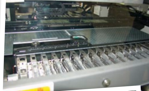
Vollautomatische SMD-Bestückung mit anschließender Qualitäts-Kontrolle
