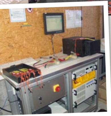
Hier werden die Controller vollautomatisch auf Herz und Nieren geprüft
