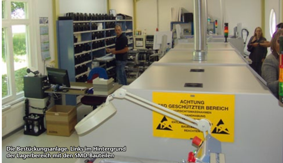
Vollautomatische SMD-Bestückung mit anschließender Qualitäts-Kontrolle
