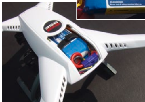
Der 3s-LiPo-Akku hat eine Kapazität von 3.000 Milliamperestunden
