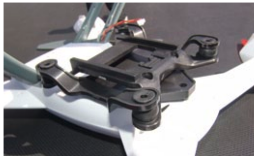
Die in Gummidämpfern aufgehängte Plattform fürs Gimbal
