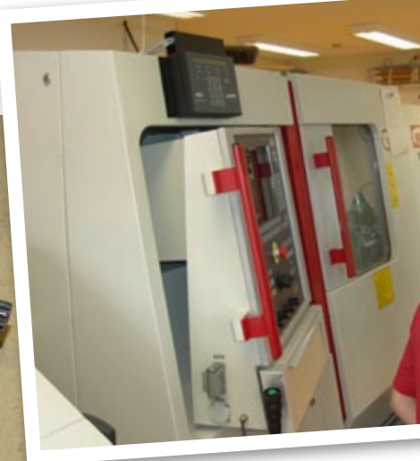
Die Mechanik-Werkstatt, in der alle Motorenteile auf einer hochmodernen CNC-Vierachs-Maschine mit Doppelspindel in Eigenfertigung hergestellt werden
