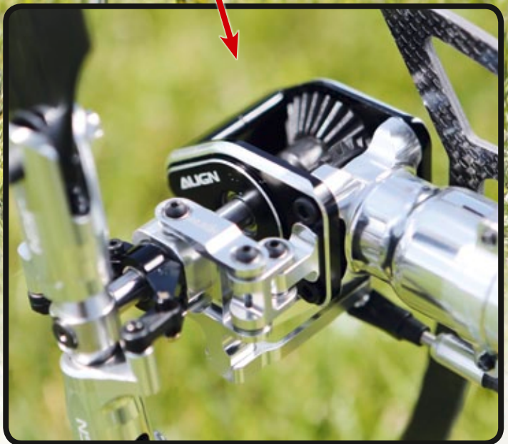
Der Heckrotor – eine Orgie aus Alu und Kugellagern mit doppelt angelenkter Pitch-Schiebehülse. Lediglich die Kegelräder sind aus hochbelastbarem Kunststoff gefertigt
