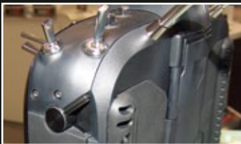
Zwar lassen sich alle Schalter und Prop-Kanäle beliebig via Software frei zuordnen und programmieren, es besteht jedoch auch eine Möglichkeit der mechanischen Anordnung der jeweiligen Bedienelemente
