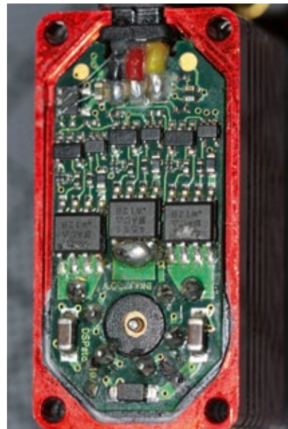
Die Elektronikplatine der HSB-93xx-Servos, die ebenfalls hochwertig vor Vibrationseinflüssen geschützt ist
