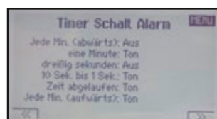
Zwei Timer stehen bereit und lassen sich funktionsbezogen mit ihren Alarmen programmieren
