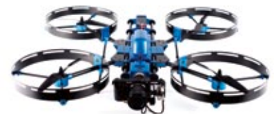
Markant sind der modular aufgebaute Frame mit dem Klappmechanismus und dem Rotorschutz. Die Kamera ist frontseitig angeordnet
