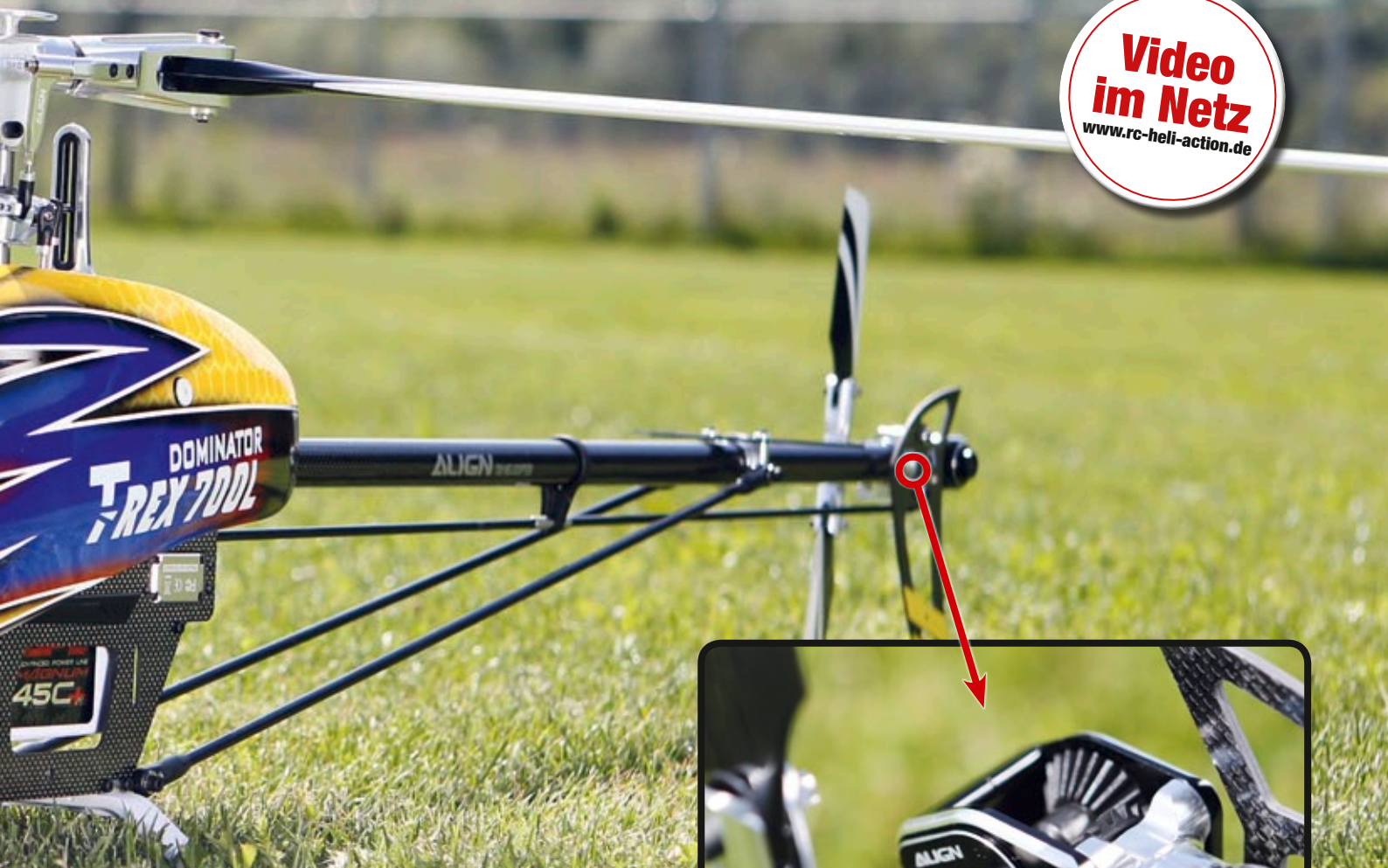
Der Heckrotor – eine Orgie aus Alu und Kugellagern mit doppelt angelenkter Pitch-Schiebehülse. Lediglich die Kegelräder sind aus hochbelastbarem Kunststoff gefertigt
