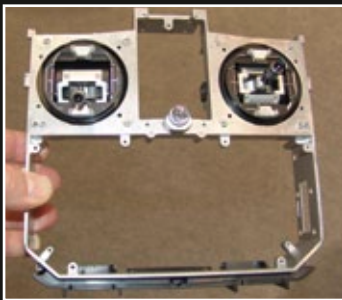
Stabil, hochpräzise gefertigt und dennoch relativ leicht – das Gehäuse der 28X ist aus Aluminiumguss
