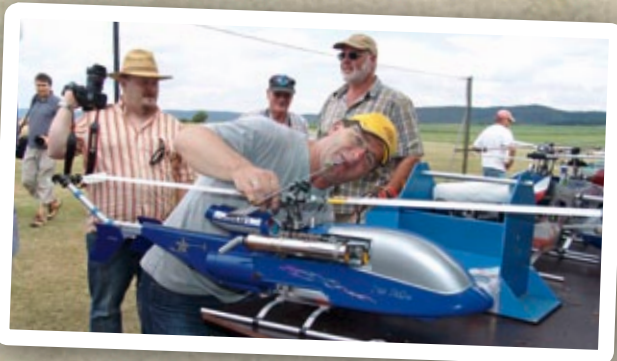
Michael Vogler bereitet hier seine Schlüter SX-81 Flachmechanik vor. Dieser Trainer war speziell für Kunstflug ausgelegt und der Motor über eine Getriebe-Zwischenstufe sehr weit oben angeordnet
