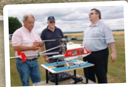
Ein kleinerer Ranger in Trainer-Ausführung von Kavan. Auch er fliegt heute mit Elektroantrieb. Fast der gesamte „Rumpf“ besteht aus bedruckten Aluminium-Platten
