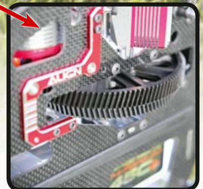
Sowohl das Haupt- als auch das Heckrotor-Abtriebs-Zahnrad bestehen aus stabilem Kunststoff und sind schrägverzahnt
