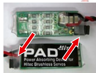
Bei einem BEC-Betrieb von 7,4 Volt oder niedriger muss der kleine Jumper (neben Kabelanschluss) abgezogen werden
