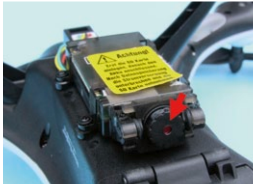
Die Optik kann bei grober Unschärfe durch sehr vorsichtiges Drehen fokussiert werden
