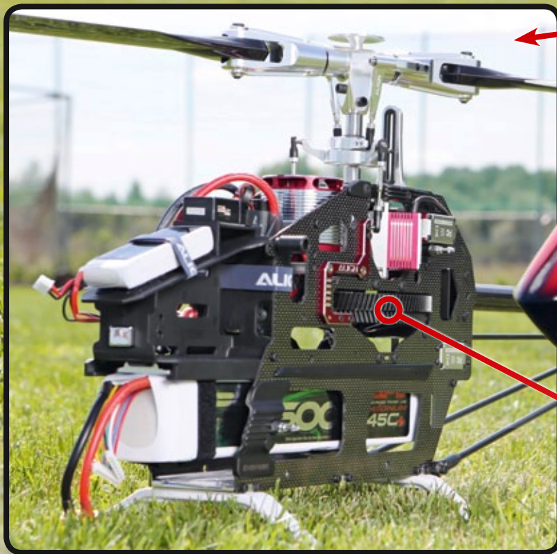
Das zweiteilige CFK-Chassis hat von außen aufgesetzte Alu-Verstärkungsprofile. Der 12s-LiPo-Akku wird mittels des bewährten Align-Schienensystems im unteren Bereich befestigt
