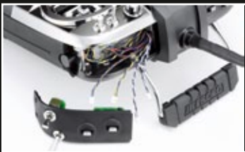
Stabil, hochpräzise gefertigt und dennoch relativ leicht – das Gehäuse der 28X ist aus Aluminiumguss
