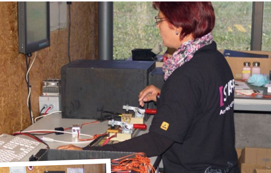
Die Ankerwicklerei. Links im Bild die automatische Wickelmaschine, die seinerzeit von Harald Konrath gebaut wurde
