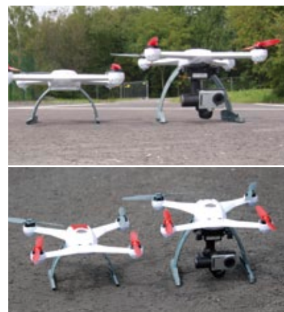
Markant ist nicht nur das Kamera-Gimbal des Blade 350 QX 2 AP, sondern auch sein wesentlich höheres Landegestell als das des standardmäßigen Blade 350 QX (links im Bild)
