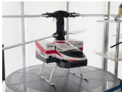
Hirobo erweiterte die Angebotspalette für Industrie-Anwendungen sowie zur Überwachung von Umwelt und Infrastruktur enorm aus. Hier der GPS-gesteuerte und elektrisch angetriebene Großhubschrauber HX-1 mit Koaxial-Hauptrotorsystem
