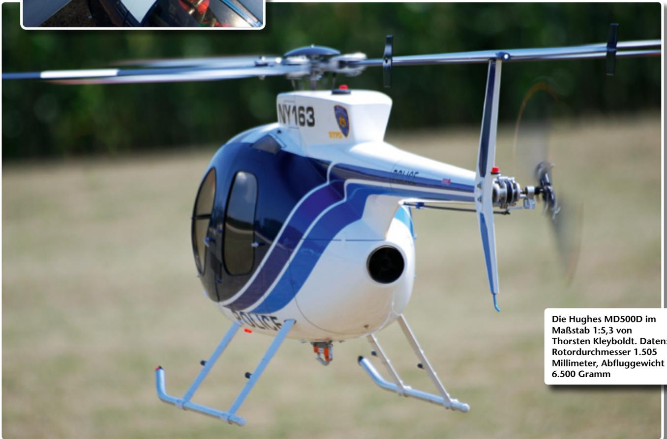
Die Hughes MD500D im Maßstab 1:5,3 von Thorsten Kleyboldt. Daten: Rotordurchmesser 1.505 Millimeter, Abfluggewicht 6.500 Gramm
