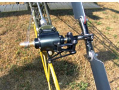
Der Präzision wegen ist der Heckrotor wie üblich über eine Schubstange angelenkt. Die Drahtspindel dient nur der Scale-Optik. Der Heckantrieb erfolgt über eine 6-Millimeter-Edelstahlwelle
