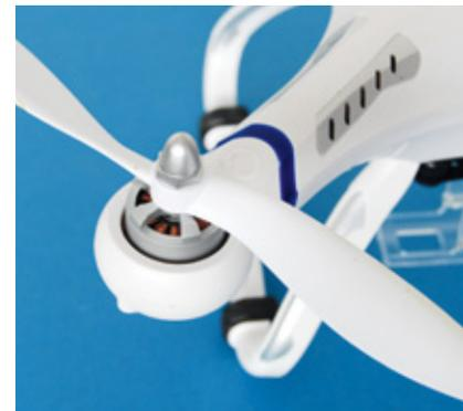
Bei der Platzierung der Propeller ist auf die richtige Drehrichtung zu achten
