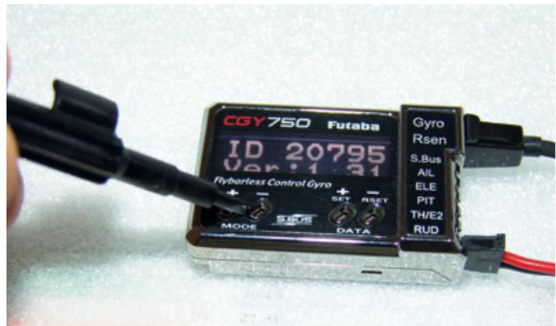
Das Navigieren innerhalb der Menüs und Verstellen der Werte erfolgt über vier Tasten, die sich am besten mit dem beiliegenden Kunststoff-Schraubendreher erreichen lassen
