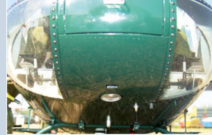
Der im Rumpfbauch eingelassene Suchscheinwerfer kann ferngesteuert ausgefahren werden
