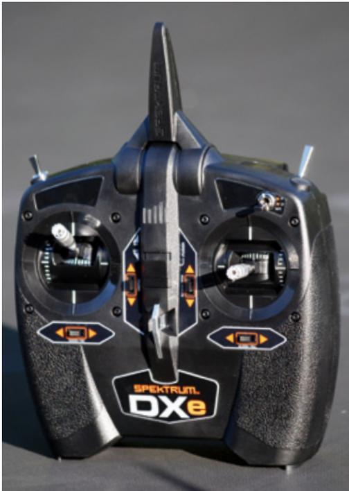
Die DXe liegt den RTF-Sets bei und ist mit allen benötigten Schaltern ausgerüstet
