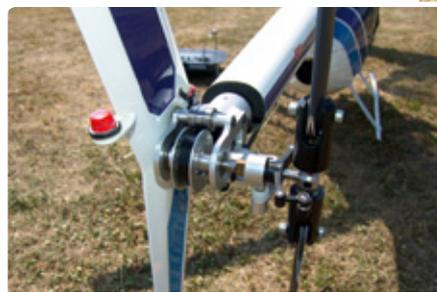
Der originale Heckrotor des Acrobat Shark mit seiner markant großen Alu-Riemenscheibe und Dreifach-Kugellager-Andruckrolle
