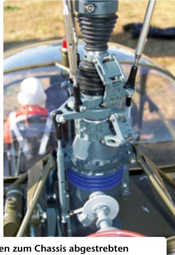
Blick auf den zum Chassis abgestrebten Hauptrotormast mit vorbildgetreu gefertigter Taumelscheibe sowie Mitnehmern
