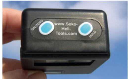
Mit kurzem Drücken auf ON/ZERO lässt sich das Gerät auf Null zurücksetzen, mit langem Tastendruck kann man das Gerät ein- beziehungsweise ausschalten. Die Taste HOLD speichert den aktuellen Anzeigewert
