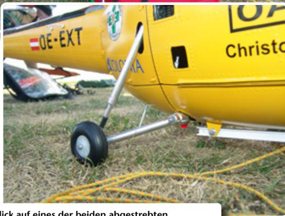
Blick auf eines der beiden abgestrebten Hauptfahrwerke. Deutlich zu erkennen sind auch die zahlreichen Nieten-Immitationen am Rumpf
