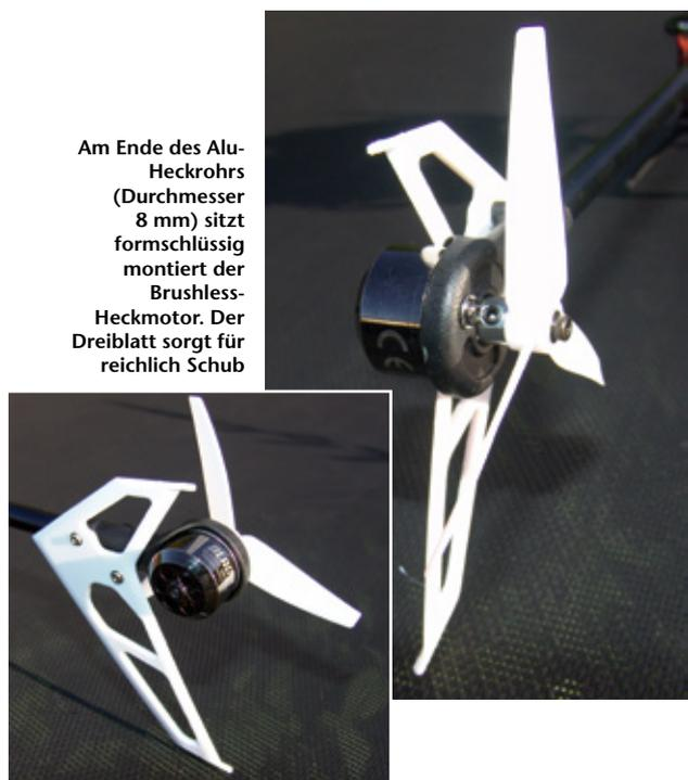
Am Ende des Alu-Heckrohrs (Durchmesser 8 mm) sitzt formschlüssig montiert der Brushless-Heckmotor. Der Dreiblatt sorgt für reichlich Schub
