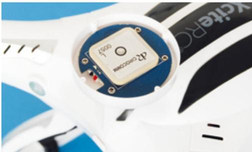
Das GPS-Modul ist exponiert über dem Kopter platziert. Auf diese Weise werden Störungen durch die übrige Elektronik verhindert
