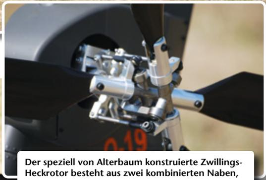
Der speziell von Alterbaum konstruierte Zwillings-Heckrotor besteht aus zwei kombinierten Naben, die in einem Winkel von 55 Grad zueinander versetzt schwingend auf einer gemeinsamen Heckrotorwelle angeordnet sind
