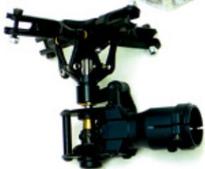
Das Heckrotor- und das Heckwinkelgetriebe werden über Starrwelle verbunden
