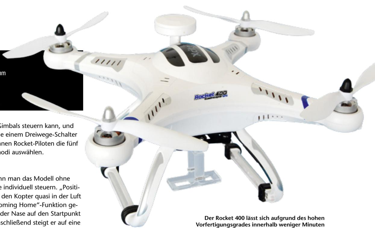
eines angeschlossenen Gimbals steuern kann, und einem Zwei- (SWB) sowie einem Dreibeige-Schalter (SWA). Mit letzteren können Rocket-Piloten die fünf unterschiedlichen Flugmodi auswählen.
