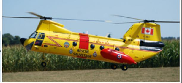
Die Labrador hat einen Rotordurchmesser von 2,2 Metern, wiegt 22,2 Kilogramm und wird angetrieben von einem Kontronik Pyro 850-40L. Beim Flybarless-System/Mischer wird ein bavarianDEMON 3SX eingesetzt. In RC-Heli-Action 07/2015 wird dieses außergewöhnliche Modell ausführlich vorgestellt
