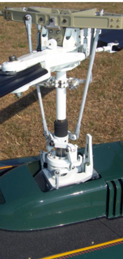
Der Zweiblatt-Rigidrotor der Bell mit der so typischen Hilfsrotor-Wippe
