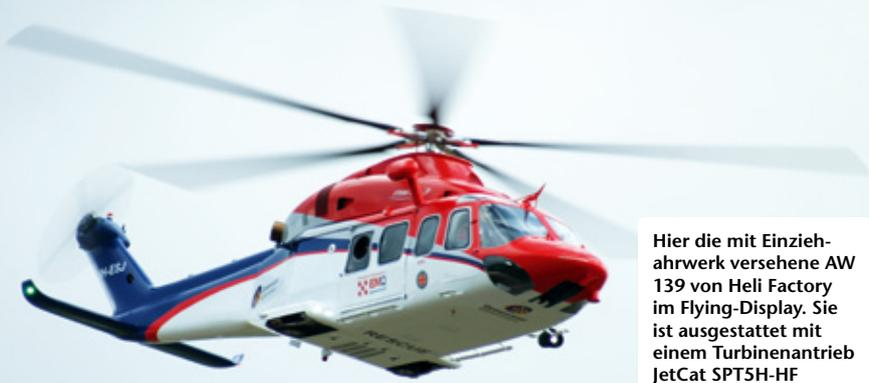
Hier die mit Einzylinderwerk versehene AW 139 von Heli Factory im Flying-Display. Sie ist ausgestattet mit einem Turbinenantrieb JetCat SPT5H-HF
