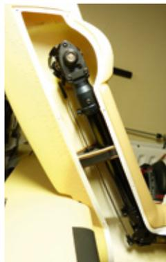
Die Revisionsklappe lässt sich demontieren. Zu erkennen sind der Schaumstoffspant und die Anlenkung
