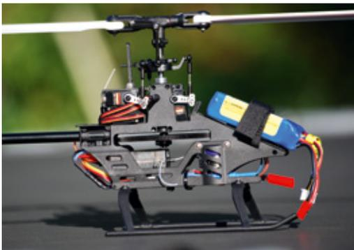
Der AR636 ist im Chassis unter dem Hauptzahnrad untergebracht, darunter der Dual-Controller für die beiden Motoren
