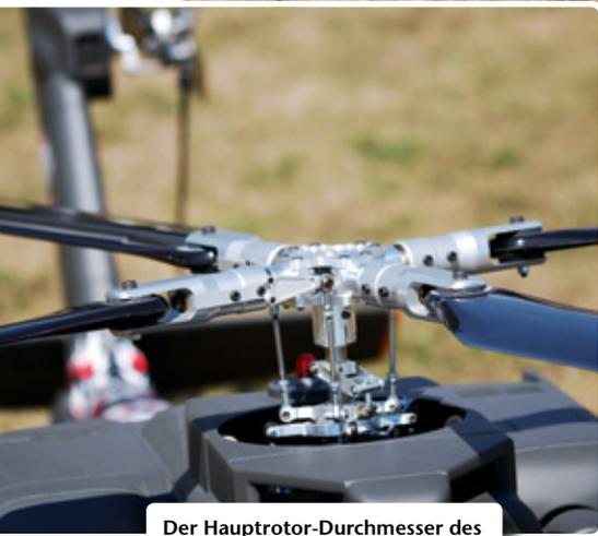
Der Hauptrotor-Durchmesser des Vierblatts beträgt 2,5 Meter
