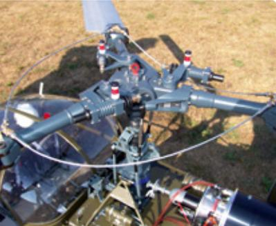
Der vorbildgetreu von Heli-Factory gefertigte, rechtsdrehende Dreiblatt-Hauptrotor verfügt über zahlreiche, liebevoll gestaltete Details wie Dämpferbehälter, Beschriftungsbleche, Faltenbälge und mehr
