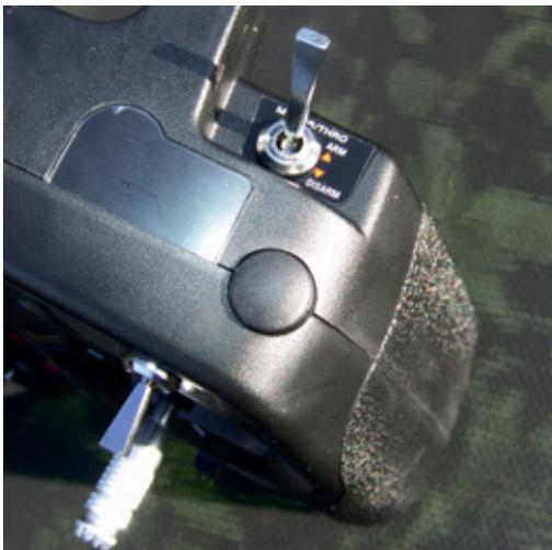
Rechts oben befinden sich Motor-Aus-Schalter, davor ein Dual-Rate-Schalter für Nick und Roll
