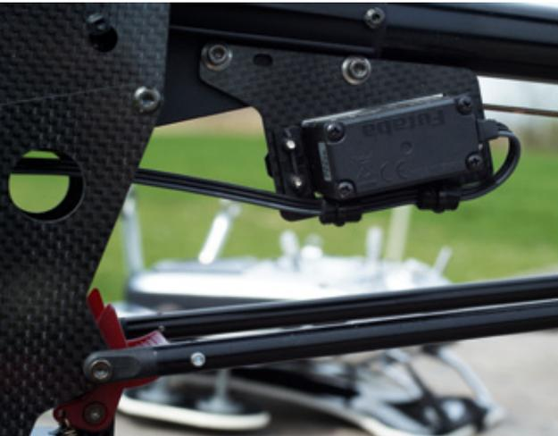
Das am CGY 750 angeschlossene Heckservo ist ein Futaba BLS 276HV, dessen Kabel ebenfalls sauber verlegt ist
