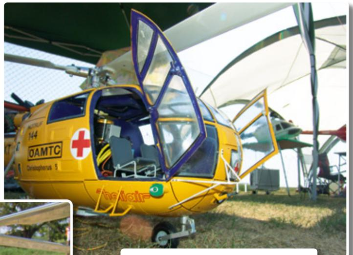
Als Basis für diesen Nachbau diente ein Rumpfbausatz Alouette von Smartmodels, der mit einer Hurricane 550-Mechanik von Gaudi kombiniert wurde
