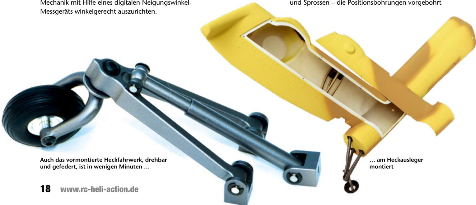
Auch das vormontierte Heckfahrwerk, drehbar und gefedert, ist in wenigen Minuten ...
