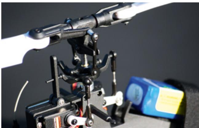
Die Blatthalter werden von hinten angelenkt, wobei Doppelkugelgelenke verwendet werden. Der Taumelscheiben-Außenring wird mit seinem Stift in einer Führung arretiert
