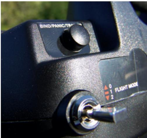
„Retter in der Not“ – der Panik-Tastschalter oben links an der Stirnseite der DXe, davor der Dreistufen-Flugphasenschalter
