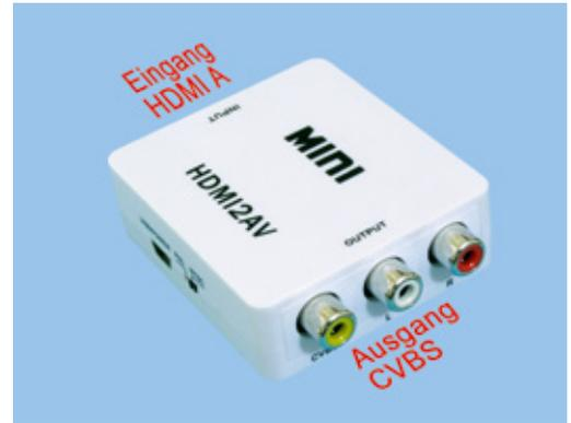
HDMI2AV sorgt für 15,- Euro für den Anschluss analoger Monitore und Brillen. Strom kommt vom Sender
