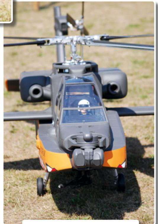
Ausgerüstet mit einer 6.000er-Jakadofsky-Turbine und einem Abfluggewicht von 24,4 Kilogramm, bietet dieses Modell hervorragendes Flugbild
