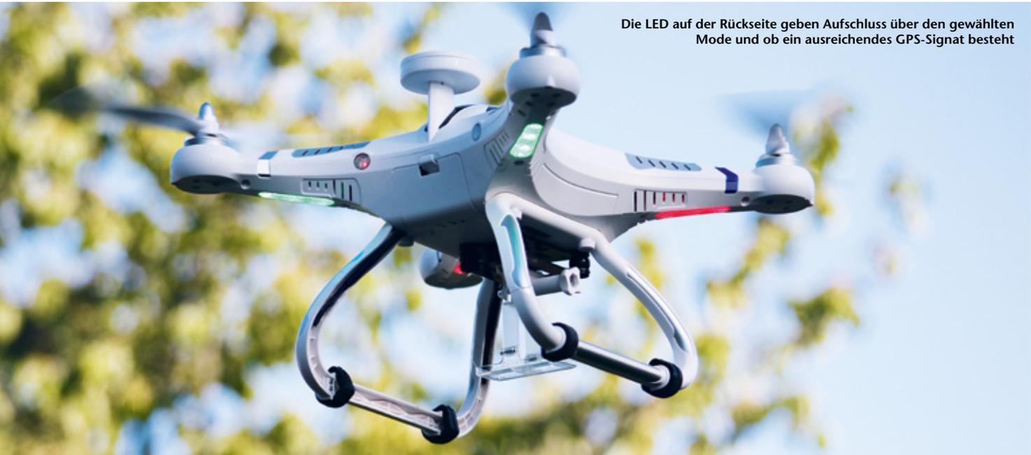
Die LED auf der Rückseite geben Aufschluss über den gewählten Mode und ob ein ausreichendes GPS-Signal besteht
