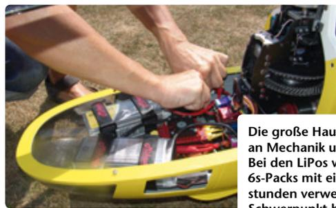
Die große Haube ist abnehmbar, sodass man bequem an Mechanik und RC-Komponenten heran kommt. Bei den LiPos werden zwei in Serie geschaltete 6s-Packs mit einer Kapazität von 12.000 Milliamperestunden verwendet – hauptsächlich so viel, um den Schwerpunkt bequem einhalten zu können
