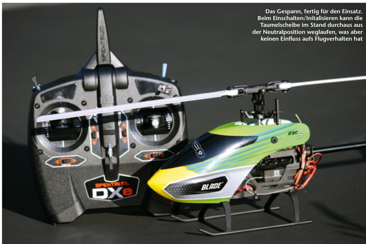
Das Gespann, fertig für den Einsatz. Beim Einschalten/Initialisieren kann die Taumelscheibe im Stand durchaus aus der Neutralposition weglaufen, was aber keinen Einfluss aufs Flugverhalten hat
