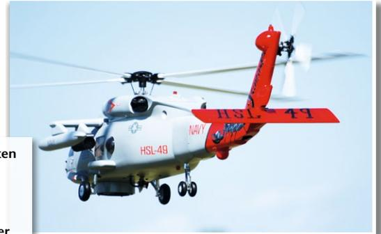
Alles, wie beim bemannten Vorbild: Hochgesetzter Heckrotor, gefedertes Dreibein-Räderfahrwerk und als Stummelflügel ausgeführte Waffenträger
