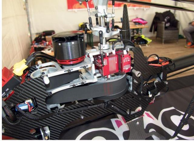
Der HD 750 mit seinem markanten, zweistufigen Riemengetriebe
