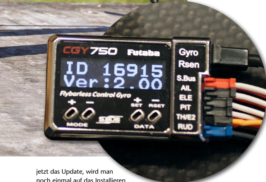
jetzt das Update, wird man noch einmal auf das Installieren der neuen Software aufmerksam gemacht und bestätigt nun mit „WRITE“ den Start des Installationsprozesses. Im Display des CGY ist nun „UPDATE RUNNING“ und nach einigen Minuten „UPDATE COMPLETE“ zu lesen.
