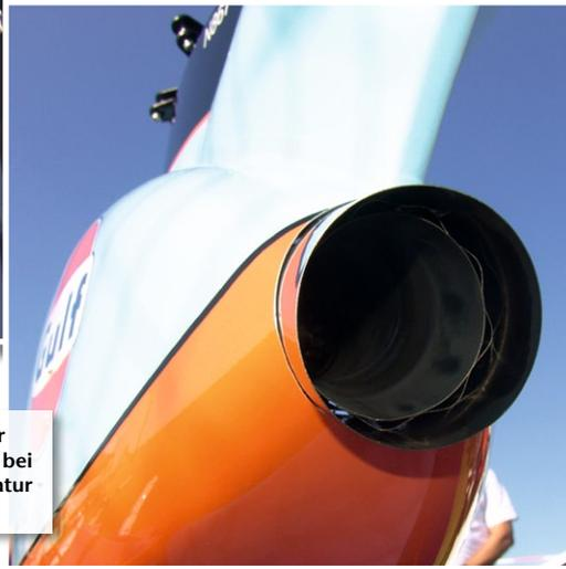
Wie beim bemannten Vorbild – der Turbinenauslass der Hughes. Auch bei Kunstflug bleibt die Abgastemperatur stets unter 600 Grad Celsius
