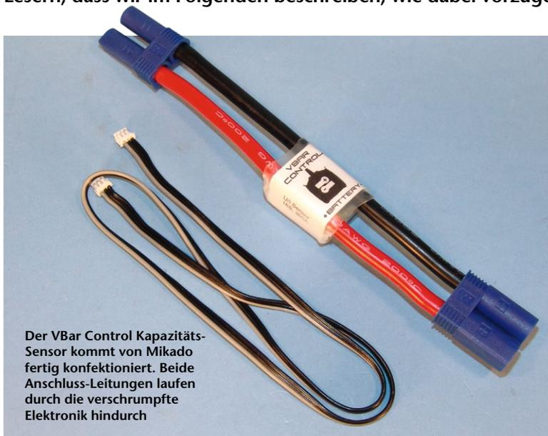
Der VBar Control Kapazitäts-Sensor kommt von Mikado fertig konfektioniert. Beide Anschluss-Leitungen laufen durch die verschraubte Elektronik hindurch
