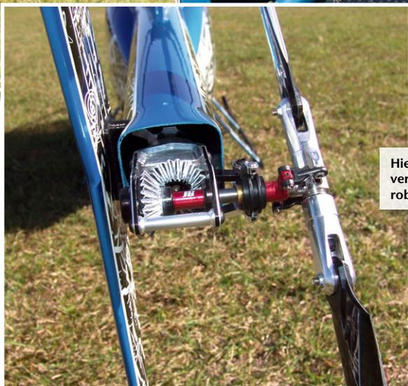
Hier der originale, mit dem Seitenleitwerk verschraubte Forza-700-Heckrotor mit seinen robusten Kunststoff-Kegelrädern
