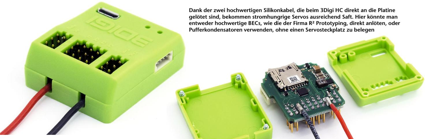
Dank der zwei hochwertigen Silikonkabel, die beim 3Digi HC direkt an die Platine gelötet sind, bekommen stromhungrige Servos ausreichend Saft. Hier könnte man entweder hochwertige BECs, wie die der Firma R<sup>2</sup> Prototyping, direkt anlöten, oder Pufferkondensatoren verwenden, ohne einen Servosteckplatz zu belegen
