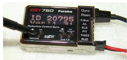
Das Navigieren innerhalb der Menüs und Verstellen der Werte erfolgt über vier Tasten, die sich gut mit dem beiliegenden Kunststoff-Schraubendreher bedienen lassen. Auch „uralte“ CGY 750-Versionen, wie beispielsweise hier die Version 1.31, lassen sich mittels ...
