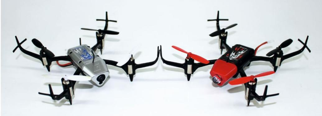
Die beiden neuen handlichen Graupner-Quadrokopter Alpha 110. Links die FPV-Variante mit eingebauter Kamera, daneben die RTF-Version mit frontseitiger LED
