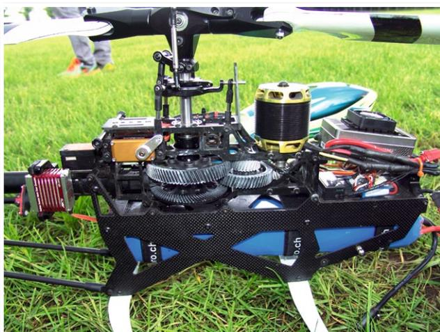
Blick aufs zweistufige Hauptgetriebe von Duncans Soxxos. Der Heli ist mit Scorpion-Außenläufer, Hobbywing-Controller und microbeast-PLUS-Flybarless-System ausgerüstet
