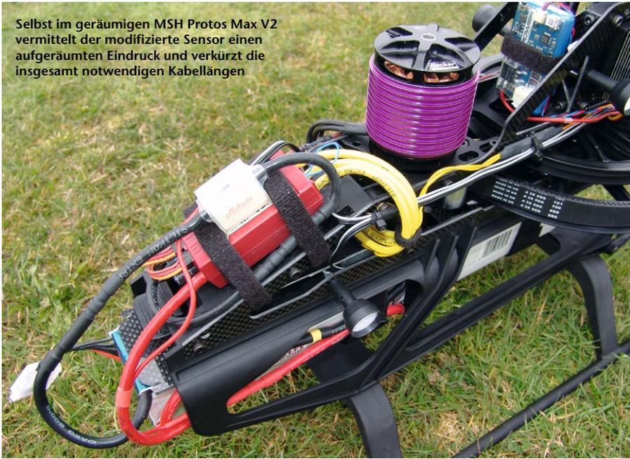
Selbst im geräumigen MSH Protos Max V2 vermittelt der modifizierte Sensor einen aufgeräumten Eindruck und verkürzt die insgesamt notwendigen Kabellängen
