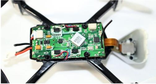
Kleine Schale, aber großer Kern. Hier arbeitet ein hochmoderner HoTT-Flight Controller inklusive Empfänger – alles bequem vom Sender aus über Telemetrie programmierbar. Die Motor-Controller sind ebenfalls auf dem Board untergebracht
