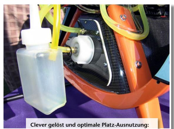
Clever gelöst und optimale Platz-Ausnutzung: Im CFK-Bodenpodeest ist der Kerosintank verstaub, der etwa 1,6 Liter Fassungsvermögen hat. Unmittelbar davor der für Kunstflug notwendige, kleine Hoppertank
