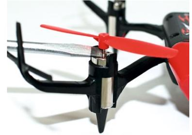
Ein Wechsel der Luftschrauben ist schnell erledigt. Hier hebelt man vorzugsweise mit einem Schraubendreher zwischen Motor und Nabe
