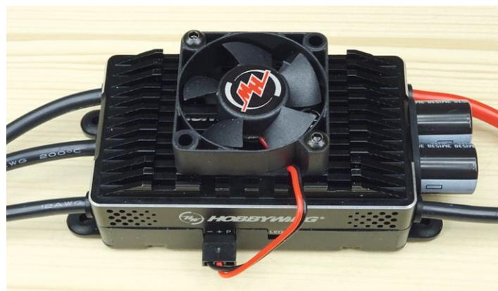
Der beiliegende Lüfter wiegt etwa 10 Gramm und sorgt für ordentlich Luftdurchsatz
