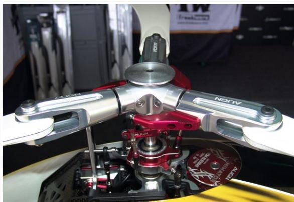
Entdecken wir beim Align-Distributor freakware – der neuen Align-Dreiblatt-Haupt- und Heckrotor für den für den T-Rex 700/800. Diese sind aus Ganzmetall gefertigt und optisch ans gewohnte T-Rex-Outfit mit rot eloxierten Parts angelehnt. Die drei Blattlagerwellen des Hauptrotors werden mit Stahl-Querbolzen im sehr flach bauenden Zentralstück befestigt
