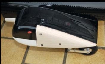
So sieht der fertig verschliffene Randbogen aus, der konturenmäßig mit dem Flügel eine Einheit bildet
