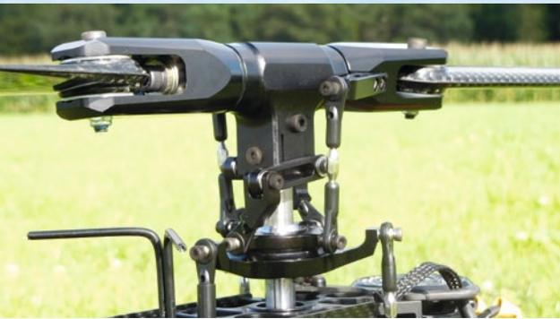
Der Ganzmetall-Hauptrotorkopf des Zenyt mit seinen am Zentralstück verschraubten Mitnehmerarmen. Sämtliche Gewindestangen sind mit Sechskant-Flächen versehen, um das Verstellen mittels Gabelschlüssel bewerkstelligen zu können
