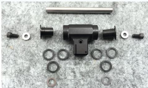
Die Dämpfung des Rotorkopfs besteht aus drei Kunststoffringen pro Seite. Die 10 Millimeter starke Blattlagerwelle ist in entsprechenden Delrin-Buchsen gelagert, die im Zentralstück eingesetzt werden
