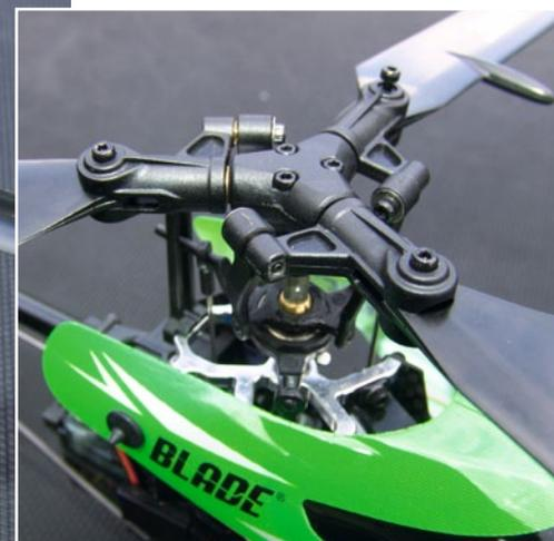
Darin unterscheidet sich der Blade Trio 180 CFX vom Blade 180 CFX – er hat ein Dreiblatt-Hauptrotorsystem, der Rest ist baugleich
