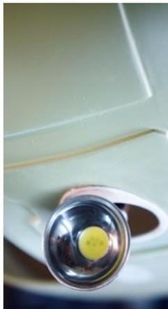
Die Anlenkung des ausklappbaren Scheinwerfers erfolgt über ein gesondertes Servo
