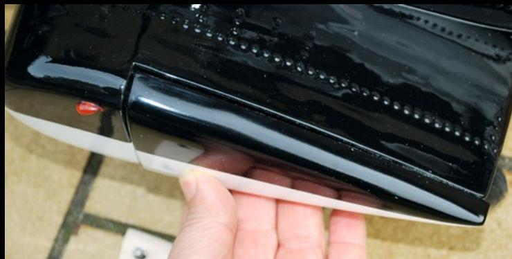
Demontiert man die Waffenattrappen und setzt den Randbogen an den Flügel an lässt sich erkennen, dass hinsichtlich der Passung Verbesserungspotenzial vorhanden ist
