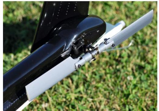
Erfolg. Die ersten Flüge bei sehr viel Wind attestieren ein sehr agiles Heck. Mit diesem Setup und dank der neuen Graupner-Software für den Gyro-Empfänger dreht der Airwolf jetzt auch in Verbindung mit dem vergrößerten Ausschlag sehr schöne und gleichmäßige Pirouetten mit den unterschiedlichsten Drehraten. Da kann auch das sehr große Seitenleitwerk dem Heckrotorschub nichts mehr anhaben.
