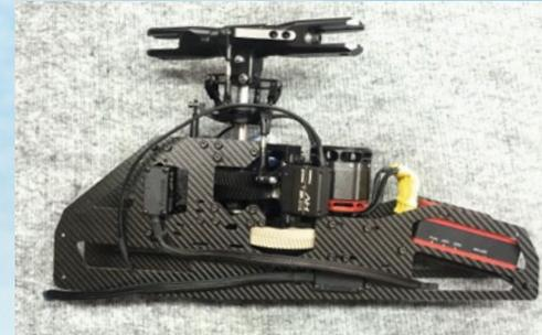
Die soweit vervollständigte Mechanik wartet noch auf die ordnungsgemäße Verkabelung, bei der die zahlreichen Aussparungen im Chassis eine enorme Hilfe sind
