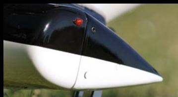
Die Schraubenköpfe im weißen Bereich wurden mit einem Aufkleber versehen, sodass sie noch unauffälliger werden
