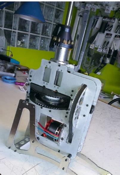
Zum Einsatz kommt eine modifizierte Vario Elektro-Mechanik, deren Seitenteile etwas gekürzt wurden. Zudem konnte auf den Heckabtrieb verzichtet werden. In der ersten Getriebestufe wird ein Zahnriemen verwendet. Beim Antriebsmotor kommt ein Kontronik Pyro 800 zum Einsatz
