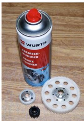
Mit Bremsenreiniger wurde der Abrieb entfernt, die Zahnräder gesäubert und ...
