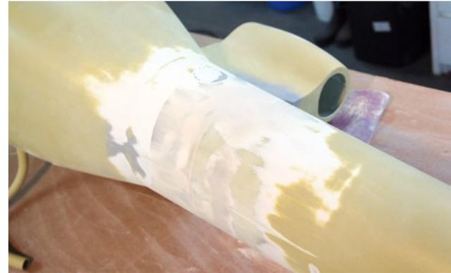
Zwar lässt sich das Heckteil zwecks besserem Transport auch demontierbar gestalten, doch Guy verklebte es mit der Zelle. Die Naht wurde entsprechend so verspachtelt und verschliffen, dass ...
