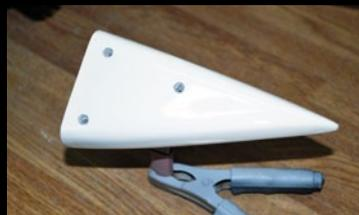
Nach dem Trocknen des Harzes können die neuen Randbögen mit Zweikomponentenlack lackiert werden
