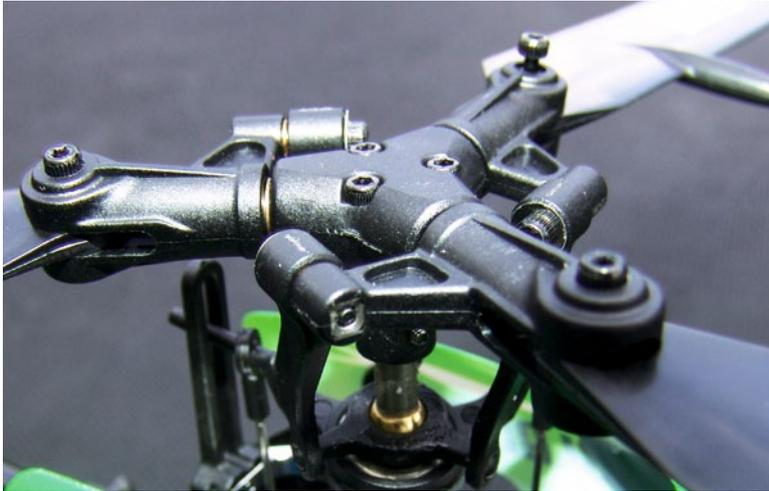
Deutlich zu erkennen sind die am Blattverstellarm verschraubten Gestänge, durch die ein gesonderter Mitnehmer entfallen kann
