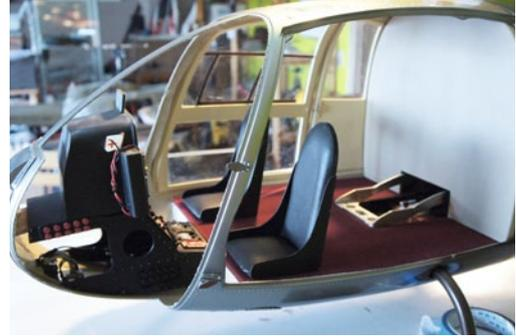
In Sachen Scale-Ausschmückung des Cockpits ist durch die gekürzte Mechanik genügend Platz vorhanden. Die Pilotensitze und die Instrumenten-Konsole sind bereits montiert
