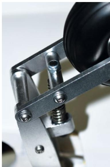
Zu erkennen ist die Inbusschraube, die die Feder für die Dämpfung des Fahrwerks arretiert. Um ein selbstständiges Lösen zu verhindern, wurde auf den herausschauenden Teil dieser Madenschraube eine Stoppmutter aufgedreht. Damit ist die Inbusschraube gekontert und kann sich nicht mehr von alleine herausdrehen
