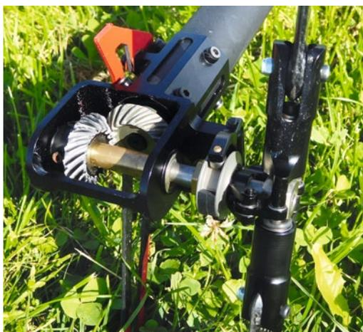
Der Heckrotor mit seinen pallloidverzahnten Kegelrädern läuft nicht nur leise, sondern besitzt auch ein extrem spielarme Anlenkung, die für gute Hochachsen-Performance sorgt
