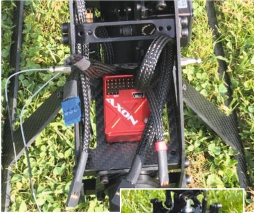
Über der Heckrohr-Lagerung befindet sich die Plattform für das Flybarless-System – hier ein AXON von bavarianDEMON. Der Empfänger nebst Stützakku sind ...
