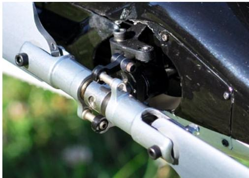
Vergleicht man beide Anlenkungs-Varianten, lässt sich erkennen, dass mit der TDR-Baugruppe (Hebelarm) der Anlenkpunkt näher an der Welle sitzt und daraus mehr Ausschlag resultiert
