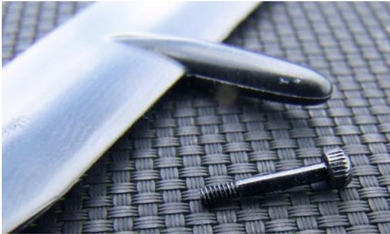
Die Rotorblätter haben einen frontseitigen Massenausgleich. Zur Befestigung im Blatthalter werden sogar hochfeste Schrauben mit langem Schaft verwendet
