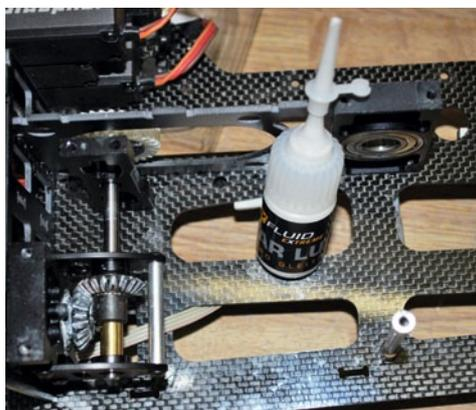
... anschließend alles wieder mit DryFluid Gear Lube gefettet
