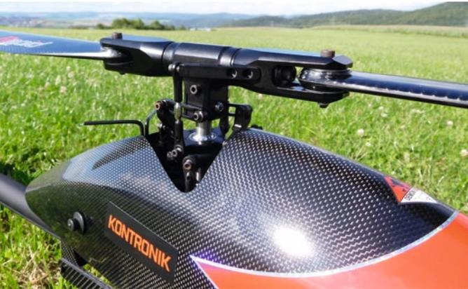
Hier wird deutlich, wie niedrig die Hauptrotoreinheit konstruiert ist, um das Mastmoment möglichst niedrig zu halten. Die entsprechenden Aussparungen für die Taumelscheiben-Anlenkung sind bereits in der CFK-Haube vorgenommen
