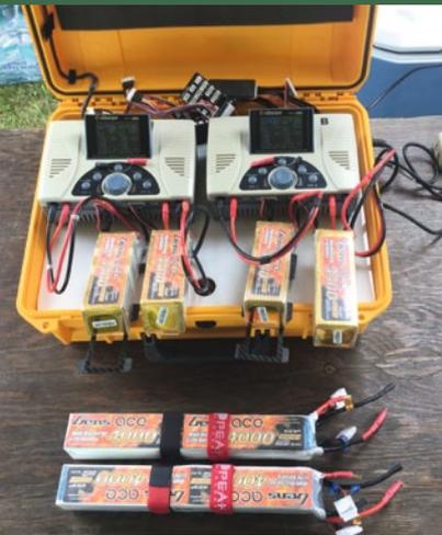
Um die Wartezeit zu verkürzen, wird mit zwei Ladegeräten geladen, wobei pro Lader zwei Akkupacks angeschlossen sind
