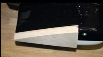
Das Holz-Sandwich wird an den Flügel angehalten, angerissen und dann mit etwas Übermaß ausgeschnitten
