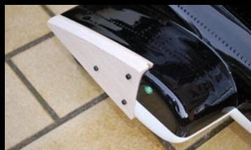
Die Befestigungs-Bohrungen sind vorgenommen und der Randbogen kann zum Schleifen montiert werden
