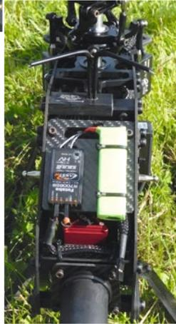
wird ein Abstandshalter mit Silikonschlauch überzogen und auf Höhe des Motors montiert.
