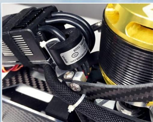
Der Sensor GOV E8 wurde im Peak 700 des Autors auf der Controller-Platte befestigt. Eines der Motorkabel ist einfach locker hindurch geführt, da die Drehzahl-Abtastung berührungslos erfolgt
