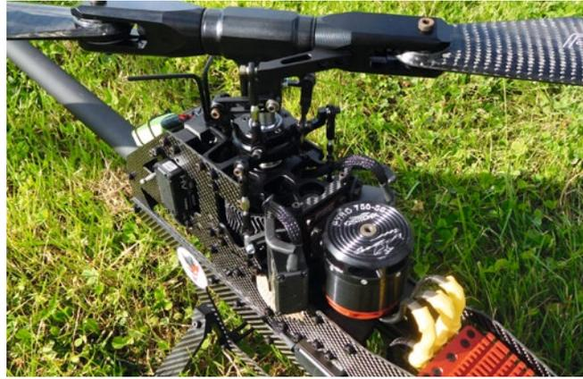
Die Draufsicht verdeutlicht, dass im Zenyt auch durchaus größere Außenläufermotoren montiert werden könnten, wobei der verwendete Pyro 750-56 mehr als genügend Leistung bereit stellt
