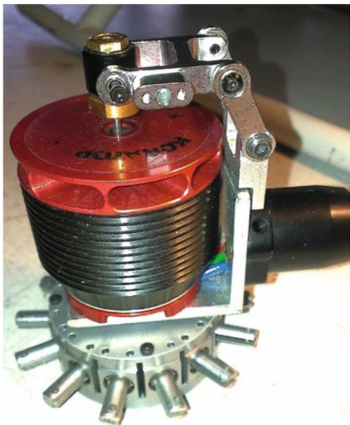
So sieht die Fenestron-Mechanik mit dem eigenen Antrieb aus. Deutlich zu erkennen ist das in der hohlen Welle geführte Pitchgestänge. Der kugelgelagerte Anlenk-Mechanismus stammt vom KDS Agile7.2
