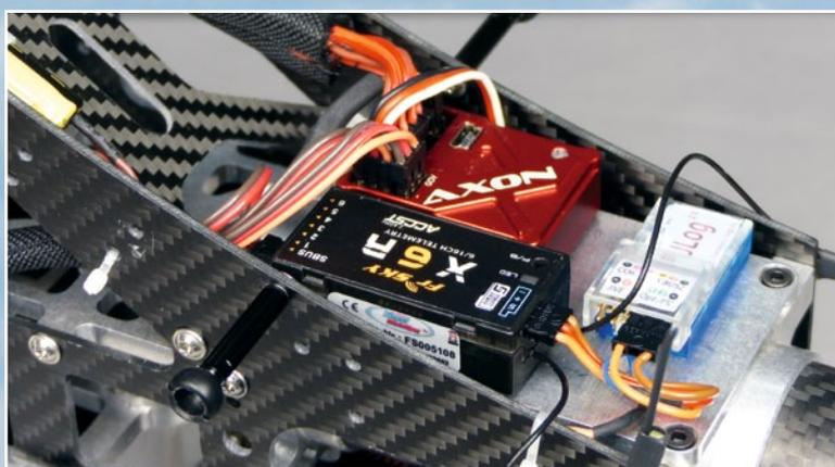
Am RC-Einbau im Modell ändert sich nichts. Lediglich der Stecker des Sensors wird ins AXON eingesteckt. Der Motor-Controller wird nun ebenfalls vom AXON angesteuert, während er beim Autor zuvor im Empfänger steckte
