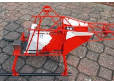
Zwischen den beiden Kufenbügeln in der Mechanikaufnahme ist der GFK-Tank zu erkennen, der hier bereits mit allen Schlauchanschlüssen versehen ist
