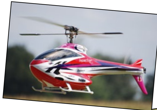
Der Impaction, ein modifizierter Stayssee-Rumpf, des Japaners Sawamura Yasuichi, in der eine Kyosho Caliber-Elektro-Mechanik arbeitet. Die Lackierung und das Farbschema sind hier vortrefflich gelungen
