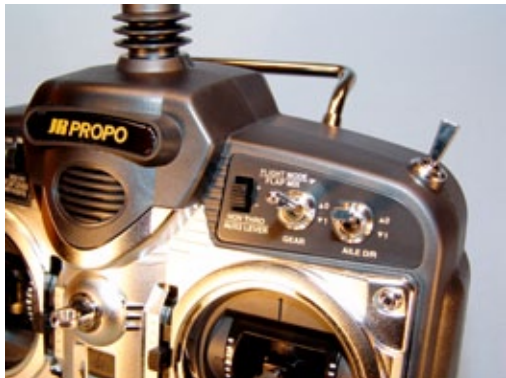
An der rechten Stirnseite des Gehäuses sitzt der dreistufige Flugphasenumschalter. Dual Rate, Gear Kanal (K5) und Schwebeflug-Gas-Trimmer sitzen oben
