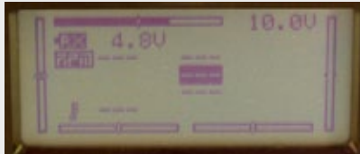
Nach dem Umschalten des Startbildschirms werden auch die über den Downlink kommenden Daten direkt angezeigt (natürlich nur, wenn Sensoren angeschlossen sind)
