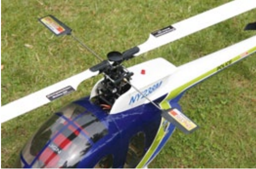
Erprobung der Competitionblades in Verbindung mit der Vollrumpfverkleidung Hughes 500 und einem Paddelkopf
