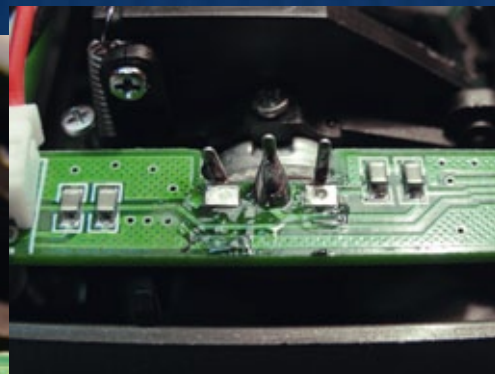
Hier wurden die beiden äußeren Anschlüsse des Potis vorsichtig entlötet
