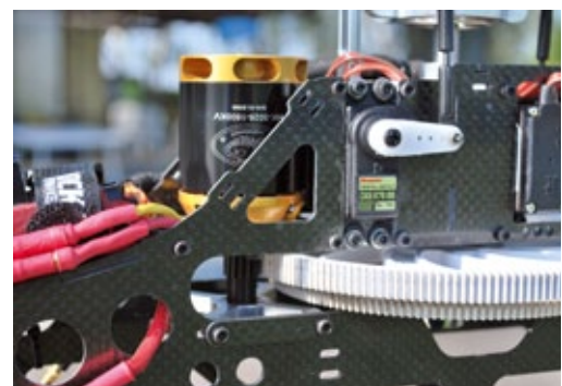
Der Scorpion 3026-1600 mit seinem Gegenlager und Ritzel macht nicht nur einen sehr soliden Eindruck, sondern hat sich auch in der Praxis bewährt
