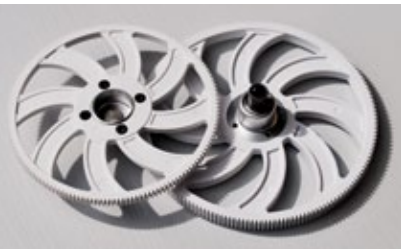
Die sauber kämmenden Hauptgetrieberäder mit Freilauf. Das kleinere Zahnrad treibt den Heckrotor an
