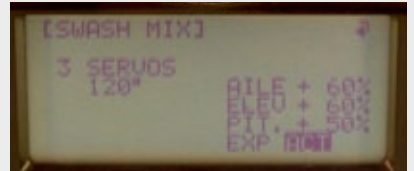
Der Taumelscheibenmischer (hier drei Servos 120 Grad eCCPM) erlaubt die Linearisierung der Servodrehbewegung (EXP ACT)
