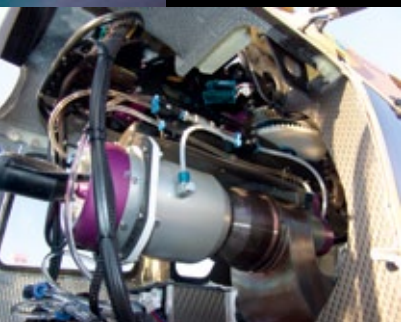
Deutlich zu erkennen ist die im Gehäuse eingeschraubte Kerosindüse, hier bei einer Zweiwellenturbine
