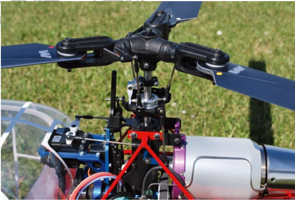
Der Vario-Dreiblattkopf mit 5 Millimeter starken Blatthalteschrauben und den vollsymmetrischen M-Blades aus Aluminium. Gut zu erkennen ist die 120-Grad-Anlenkung der Taumelscheibe
