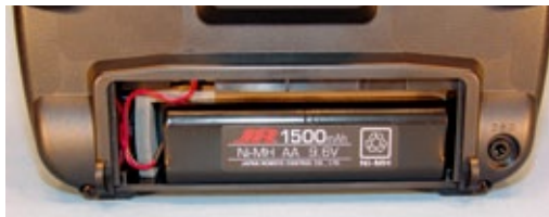
Der mitgelieferte NiMH-Senderakku (9,6V/1500mAh) sitzt klapperfrei in einem Formeinsatz aus Moosgummi
