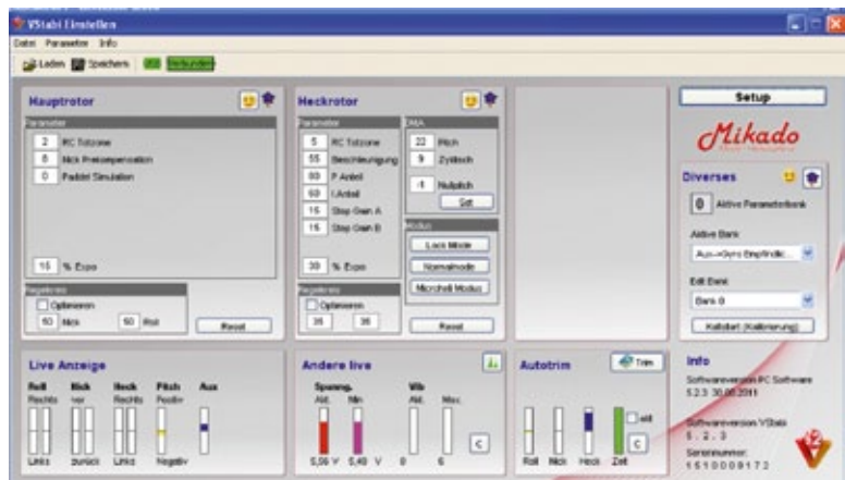
Mit diesen Werten wurde V-Stabi eingestellt (Screenshot der Programmier-Software), die sich für den X-Tron 500 als ideal erwiesen
