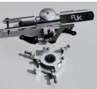
Hauptrotorkopf und Taumelscheibe sind präzise gefertigt und leichtgängig
