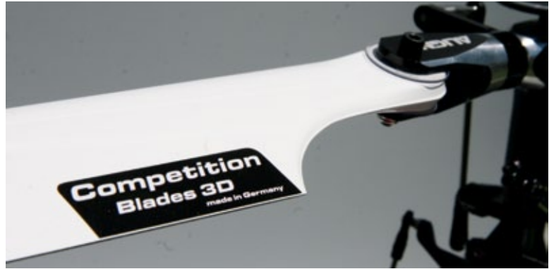
Blick auf die Blattwurzel. Die Competitionblades haben eine Anschlussdicke von 12 Millimeter, können aber mit entsprechenden Distanzscheiben auf größere Blatthalter adaptiert werden
