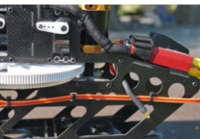
Dank der vielen Aussparungen im Chassis lassen sich die Kabel gut befestigen
