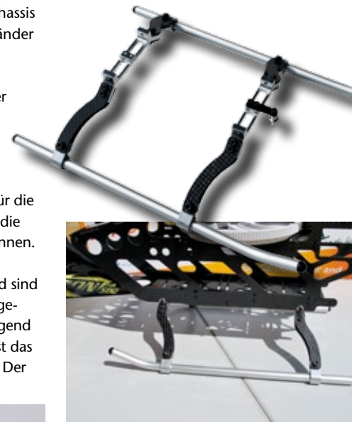
Das Kufengestell ist nicht nur schön anzusehen, sondern auch präzise gefertigt und montagetECHNisch wesentlich aufwändiger als zwei einfache Kunststoffbügel. Am vorderen Kufenbügel ist die untere Kabinenhaubenaufnahme befestigt
