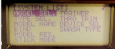
Das System-Menü erlaubt die grundlegenden Einstellungen die modellübergreifend gelten. Hier erfolgt auch das Binden des Empfängers
