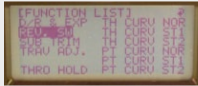
Das Funktionsmenü zeigt einen Überblick über die Untermenüpunkte, die wie die Seiten eines Buchs nacheinander aufgeblättert werden können
