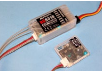
Sind Sender und Empfänger gebunden, wird dies durch eine blaue LED je Empfangsteil angezeigt
