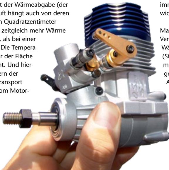
Ein guter Helimotor alleine nützt nichts – auch die Gebläsekühlung des Helisystems hat großen Einfluss auf die Kühlung
