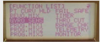
Das Funktionsmenü zeigt einen Überblick über die Untermenüpunkte, die wie die Seiten eines Buchs nacheinander aufgeblättert werden können
