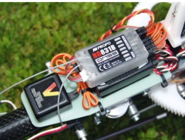
Der JR RG831B im Three Dee MP-E während der praktischen Erprobung zusammen mit einem Mikado V-Stabi ...
