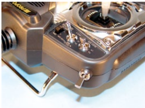
An der linken Stirnseite sitzt ab Werk der Autorotationschalter. Oben auf der Fläche Dual Rate, Aux 2 und Schwebeflug-Pitch-Trimmer
