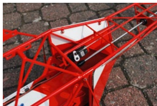
Das Heckrotorservo sitzt im Gitter-Heckausleger und lenkt über einen Stahldraht den Heckrotor-Umlenkhebel an. Unmittelbar vor dem Servohebel ist der Kupplungsanschluss der Heckrotor-Antriebswelle zu erkennen
