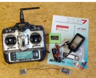
Das XG7-Fernsteuerset kommt mit komplett ausgebautem 2G4-DMSS-Sender, Achtkanal-Empfänger, Schalterkabel, Empfängerakku und Netzladegerät
