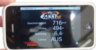
Anzeige der FASSTest-Telemetrie-Werte via Smartphone in Verbindung mit dem neuen Fasstest-Empfänger und WLAN-Adapter
