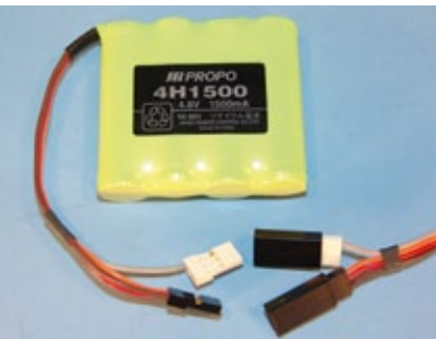
Im Empfängerakku ist ein temperaturabhängiger Widerstand verbaut, der dem Ladegerät Rückmeldung gibt (weiße Zusatzbuchse)
