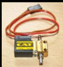
So sieht ein JetCat-Kerosinventil aus, das von der ECU angesteuert wird
