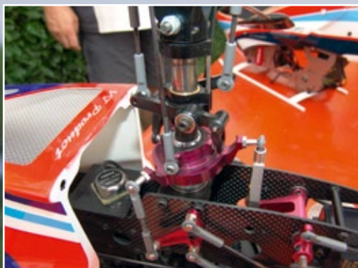
Taumelscheibe, Pitchkompensator und hinten auf der Plattform der Sensor des GY701
