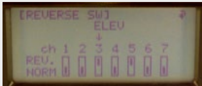
Bei der Servowegumkehrung lassen sich alle Servos mit einem Blick übersichtlich erfassen
