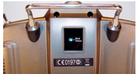
Die LED des Sendermoduls ist gut auf der Gehäuserückseite erkennbar
