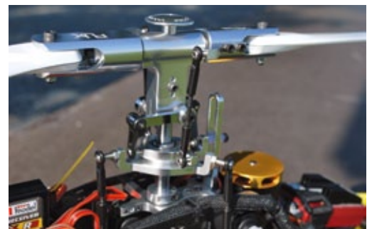
Der fertig montierte Hauptrotor mit allen Anlenkungen – ein Minimum gegenüber den Paddelköpfen mit Pitchkompensator und den ganzen Gestängen
