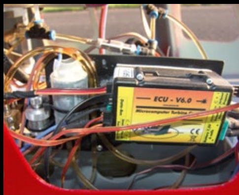
Die ECU ist im Modell verantwortlich für den vollautomatisch ablaufenden Startvorgang, quasi Schaltzentrale, Kontrollorgan und Gehirn der Turbine
