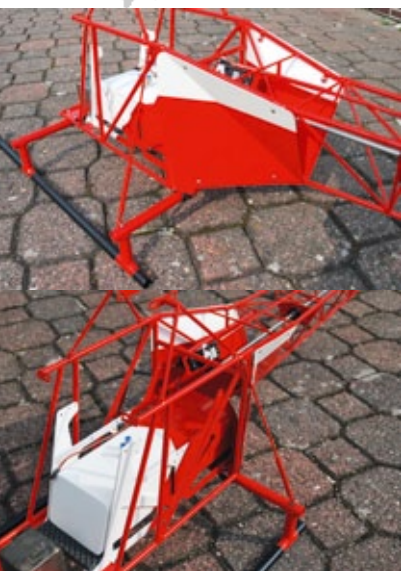
Blick auf die verschraubten Seitenbleche und den selbst gefertigten Fahrwerks-Stoßdämpfer
