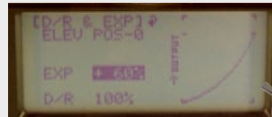
Bei der Darstellung der Exponentialfunktion wird nur eine Seite des Servoweges angezeigt, was zunächst gewöhnungsbedürftig ist
