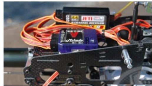
Der Hauptverantwortliche für die guten Flugeigenschaften des Helis ist das Mini V-Stabi von Mikado in der Version 5.2.3
