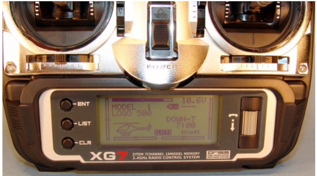
Die Bedienung des Menüs erfolgt durch drei Drucktasten (Enter, List, Clear) und der intuitiv zu bedienenden Dreh/Drück-Walze
