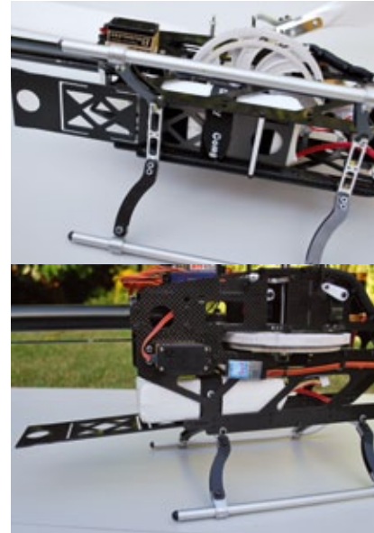
Das Einschleiben der Akkuplatte – dem Baukasten liegen übrigens zwei Exemplare bei – von hinten ins Chassis. Die Schienenführung ist deutlich zu erkennen. Der Akku muss wegen Einhaltung des Schwerpunkts so weit wie es geht nach vorne.
