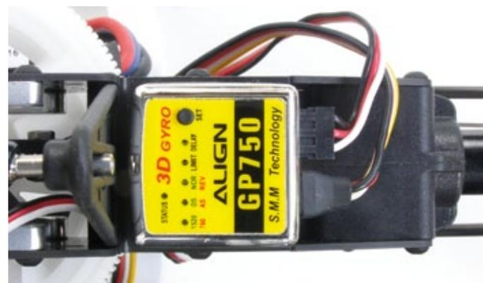
Separater Heckrotor-Gyro beim T-Rex 450 Pro
