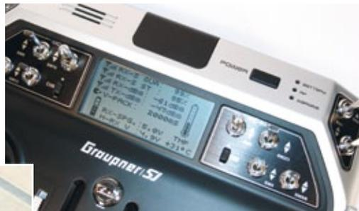
Auf dem oberen Display werden ausschließlich Telemetrie-Daten dargestellt. Es ist hintergrundbeleuchtet und im Betrieb sehr gut einsehbar
