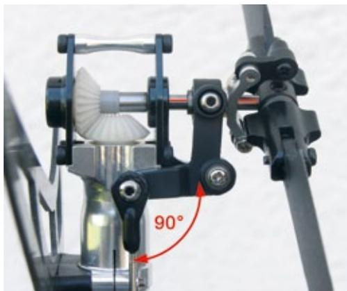
Ein pitchgesteuerter Heckrotor. Die rot markierten Wege für die Schiebehülse müssen gleichlang sein, der Winkel an der Anlenkung sollte ungefähr 90 Grad betragen
