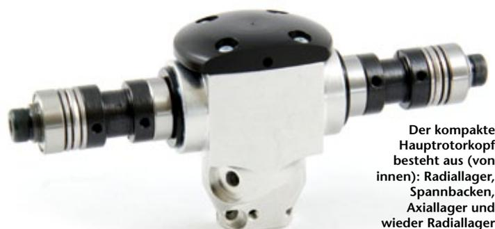
Der kompakte Hauptrotorkopf besteht aus (von innen): Radiallager, Spannbacken, Axiallager und wieder Radiallager
