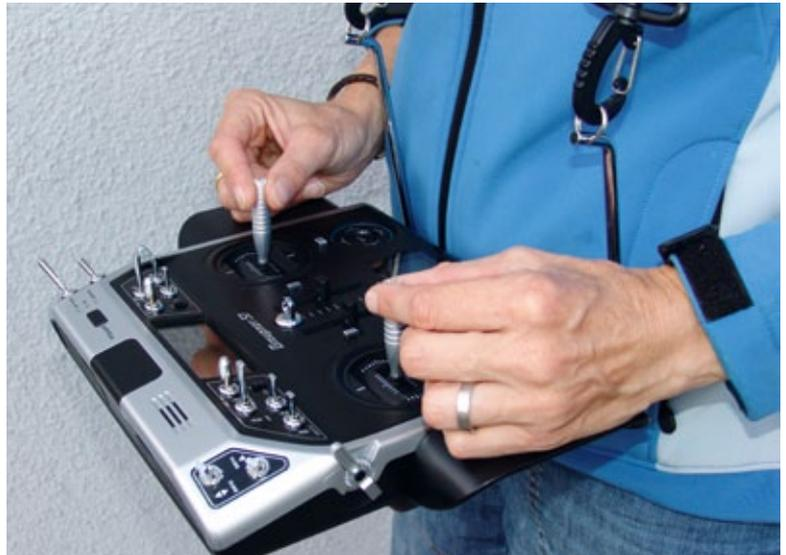
Perfekte Ausrichtung: Dank gekrüppfter Bügel hängt der Sender genau waagrecht und hat keinerlei Tendenz zum Abkippen nach vorne
