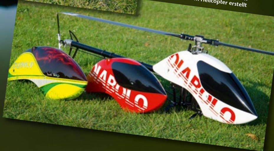
Er handelt sich um einen reinrassigen 700er-3D-Heli, der aber auch im niedrigen Drehzahlbereich betrieben werden kann. Durch das lange Heckrohr mit einem Durchmesser von 30 Millimeter (mm) können problemlos 750er-Rotorblätter geflogen werden.
