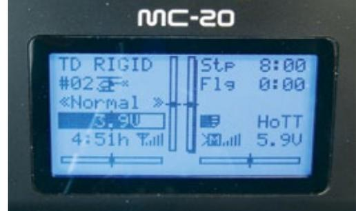
Das untere Display dient zur Programmierung und zeigt im Startbildschirm alle relevanten Daten wie Modellspeicher, Betriebsspannung von Sender und Empfänger, Flugphase und Uhren. Das Kartensymbol signalisiert eine eingeschobene SD-Karte
