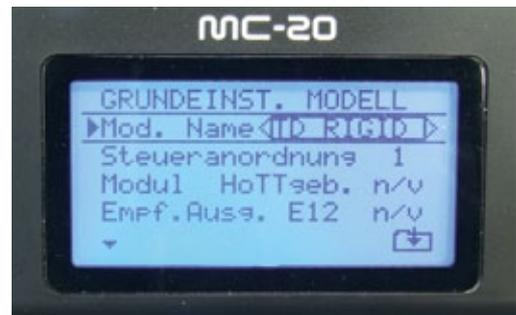
In den Menüs geht es sehr strukturiert und übersichtlich zu. An einen Modellspeicher können für Diversity-Betrieb mehrere Empfänger gebunden werden
