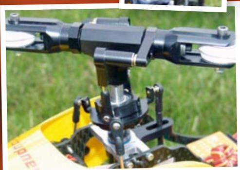
Der Ganzmetall-Hauptrotorkopf mit der Dreipunkt-Taumelscheibe und den Rotorkopf-Steuerstangen, die auch die Mitnehmerfunktion übernehmen
