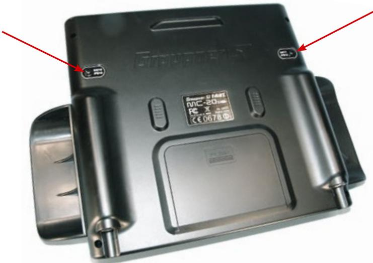
Die Gehäuse-Unterseite ist auch für die Nutzung als Handsender optimal gestaltet. Alle Teile sind perfekt verarbeitet, die Umhängebügel per Bajonettverschluss komplett abnehmbar. Man beachte die beiden praktischen, zusätzlichen Taster (Pfeile)
