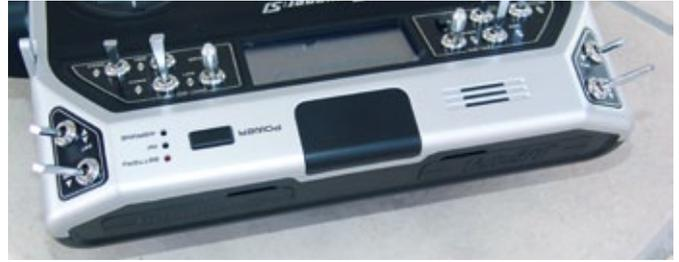
Die eingebaute Patch-Antenne ist vollständig ins Gehäuse integriert. Der Sender wird mit einem zeitverzögerten Taster einbeziehungsweise ausgeschaltet. Auf der linken Seite befindet sich der Lautsprecher für die Sprachausgabe
