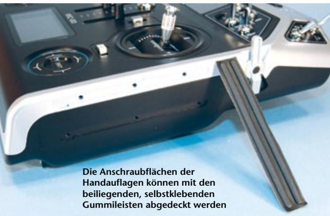
Die Anschraubflächen der Handauflagen können mit den beiliegenden, selbstklebenden Gummileisten abgedeckt werden
