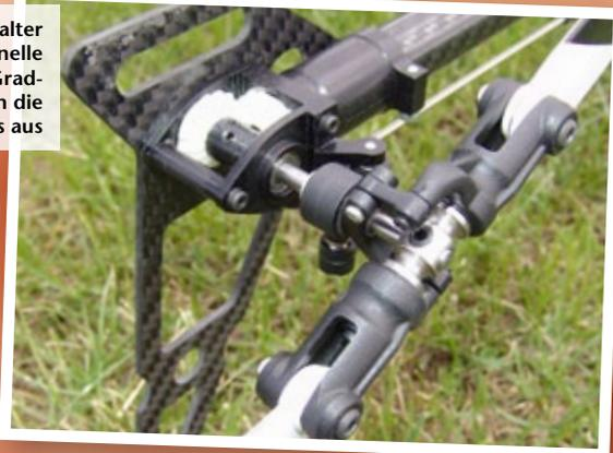
Übersichtlicher Aufbau: Das zweigeteilte Chassis behergt im oberen CFK-Teil das komplette Getriebe inklusive Servos, der Unterbau besteht wie das Landgestell aus Alu (die Serie wird schwarz eloxiert sein)
