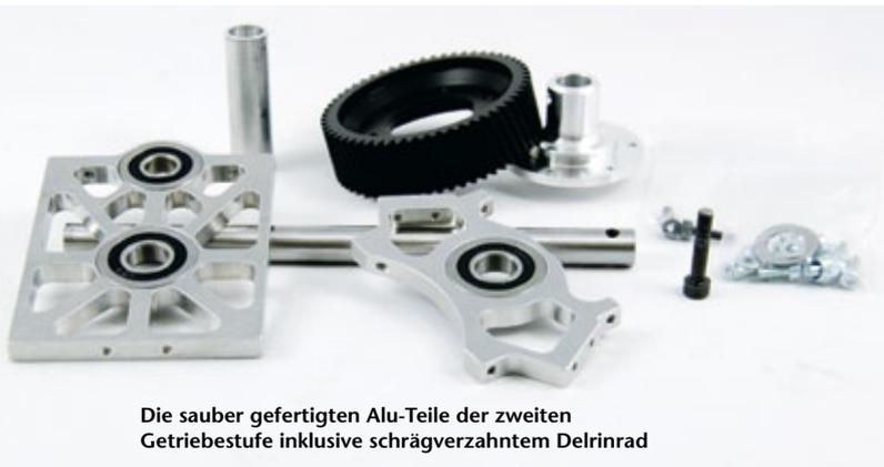
Die sauber gefertigten Alu-Teile der zweiten Getriebestufe inklusive schrägverzahntem Delrinrad
