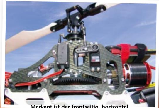
Markant ist der frontseitig, horizontal angeordnete Motor, der den Rotor über ein zweistufiges Getriebe antreibt
