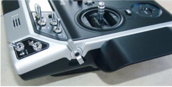
Die seitlichen, gerasteten Drehgeber lassen sich bequem von oben oder der Seite bedienen
