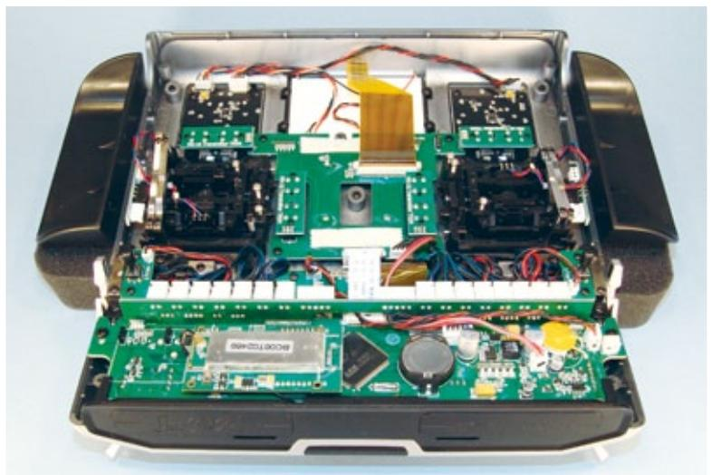
Die mc-20 HoTT ist auch innen sehr gut verarbeitet. Eine Lithium-Batterie sorgt für den Erhalt der Daten bei abgezogenem Akku
