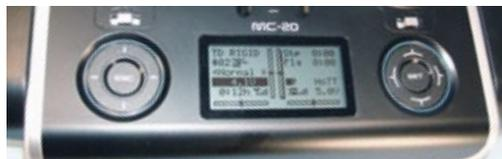
Zwei runde Cap-Touch-Bedienfelder dienen zur Kommunikation. Damit gelingen die Eingaben intuitiv und schnell. Bei Bedarf können sie gesperrt werden
