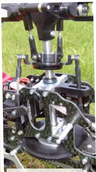
Die Taumelscheibenführung ist am oberen Domlagerbock angeflanscht
