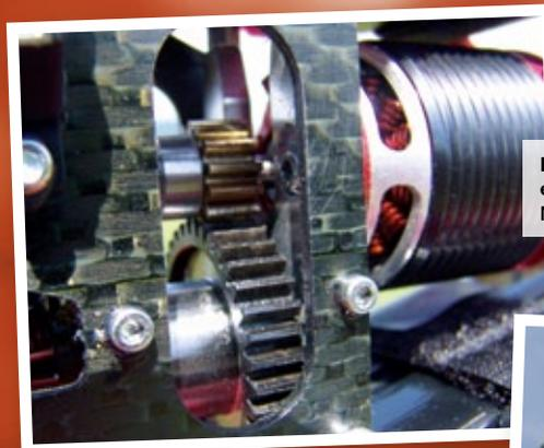
Detail der ersten Getriebestufe mit einer Zahnrad-Kombination aus Messing und Kunststoff
