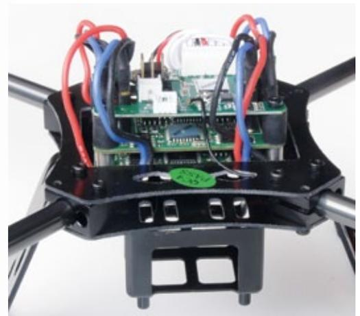
Die dreistöckig angelegte Elektronik. Die obere Platine ist vibrationsgeschützt auf Gummilagern verschraubt
