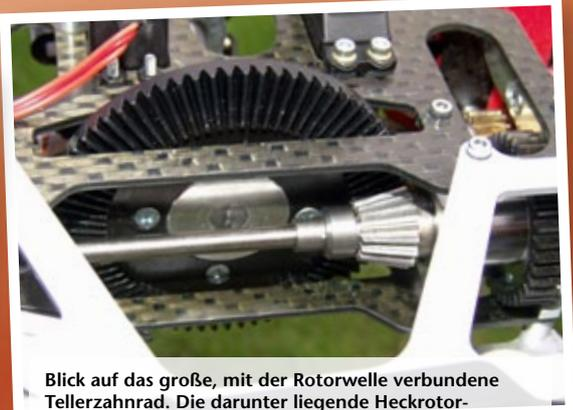
Blick auf das große, mit der Rotorwelle verbundene Tellerzahnrad. Die darunter liegende Heckrotor-Starrwelle wird direkt aus der ersten Getriebestufe heraus angetrieben. Der Freilauf sitzt unmittelbar hinter dem Stahl-Kegelrad in einer Alu-Glocke
