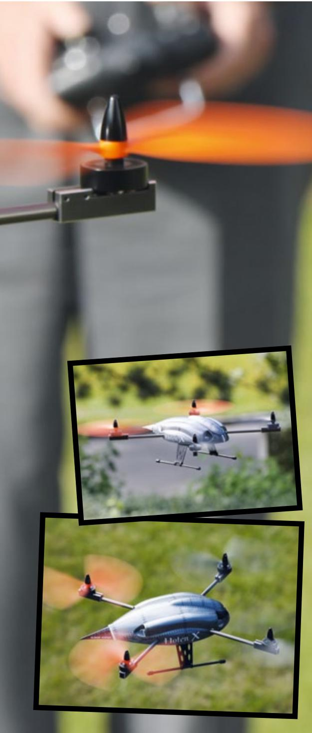
Rotorwellenabstand und 322 Gramm Masse ist das Teil deutlich erwachsener als die drei kleinen Geschwister und kommt mit vier Brushlessmotoren und einem größeren 7,4-Volt-LiPo-Akku mit einer Kapazität von 1.000 Milliamperestunden daher. Das sieht recht leistungsfähig aus. Der Profi freut sich, und der Anfänger runzelt die Stirn, ob das dann wohl nicht doch zu viel Power für unbedarfte Einsteiger ist. Und wie steht es mit der Flugdauer? Fragen, die beantwortet werden wollen.
