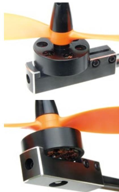
Die Brushlessmotoren sind auf stabilen Metallböcken montiert. Die unten offen liegenden Wicklungen sollte man gut gegen Schmutz schützen
