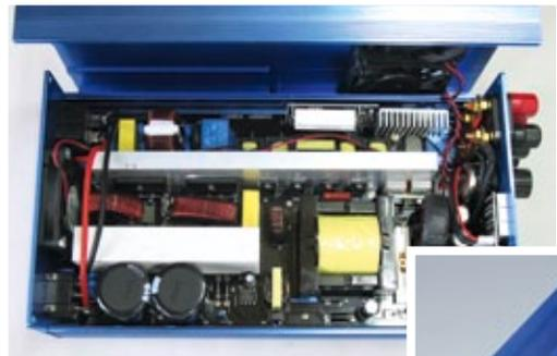
Die aktuelle Version des S1200 im neuen Design und mit modifiziertem Display für Strom- und Spannungswerte
