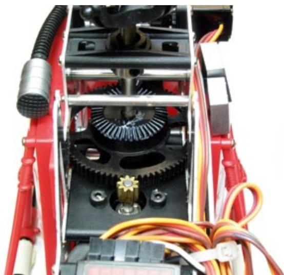
Motorritzel gegen Hauptzahnrad auf minimales, aber druckfreies Spiel justieren. Oben das Kegelrad für den Heckantrieb
