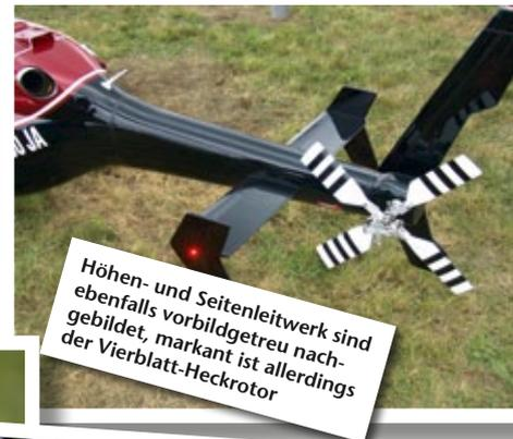
Höhen- und Seitenleitwerk sind ebenfalls vorbildgetreu nachgebildet, markant ist allerdings der Vierblatt-Heckrotor
