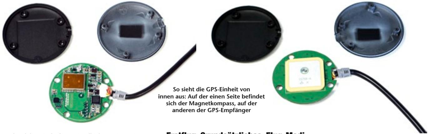
So sieht die GPS-Einheit von innen aus: Auf der einen Seite befindet sich der Magnetkompass, auf der anderen der GPS-Empfänger
