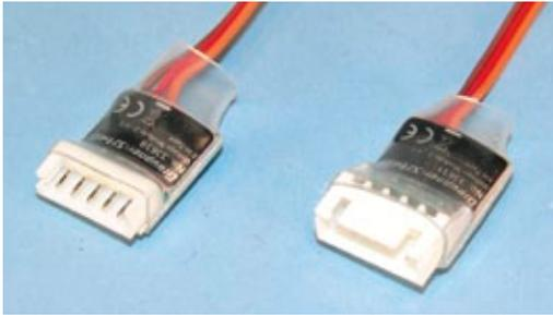
ist konfigurierbar. Neben der Anzeige der Einzelzellen-Spannungen auf dem Senderdisplay erhalten wir auch automatisch die aktuelle Gesamtspannung des Akkupacks sowie die sich aus der Voreinstellung (zum Beispiel Warschwelle 3,3 V/Zelle) ergebende Minimal-Spannung (hier 9,9 V bei einem 3s-LiPo).
