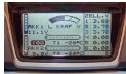
In der Statusanzeige werden die aktuell anliegenden Einzelzellen-Spannungen des Akkus dargestellt (rechts oben), Gesamtspannung des Packs (links oben) und Minimalspannung bei Alarm (links unten)
