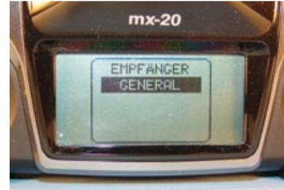
Um auf das Voltage Modul zugreifen zu können, wird im Sender das GENERAL-Telemetriemodul gewählt
