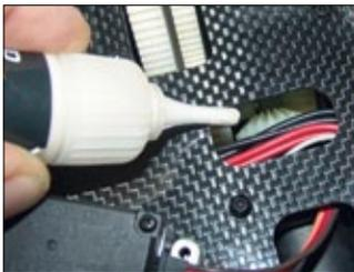
Beim Schmieren sollte man auch das Kunststoff-Kegelradgetriebe des Heckabtriebs nicht vergessen (Zugang durch die Chassis-Öffnung) ...
