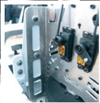
Durch die im vorderen und unteren Bereich abgewinkelten Seitenteile ist die Mechanik enorm stabil. Die Schrauben zur Befestigung an den Spanten sind bestens zugänglich
