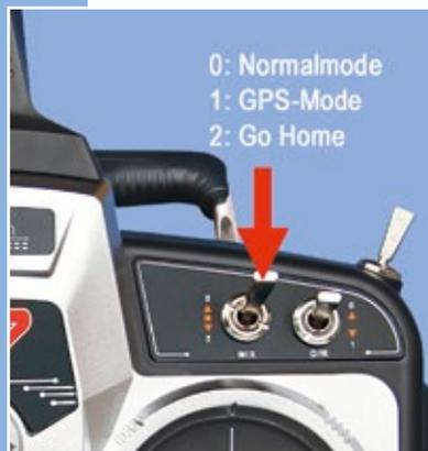
Normalmode: MIX- und FMOD-Schalter in Position 0 bedeutet ganz normalen Flug ohne GPS, Kompass und Höhenmesser. Der Kopter begeistert dann mit einem zum MX400 (Test RC-Heli Action Heft 5/12) weitgehend identischen, ganz hervorragenden Flugverhalten – und das sogar bei mäßigem Wind und Turbulenz. Kurven lassen sich nach etwas Übung sehr dynamisch in heliähnlicher Manier mit Schräglage fliegen. Selbst ein schneller fast senkrechter
