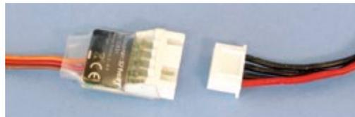
Hier wurde der XH-Stecker des Voltage Moduls so ausgeschnitten, dass auch 3s LiPos ohne Modifikation der Balancer-Buchse eingesteckt werden können
