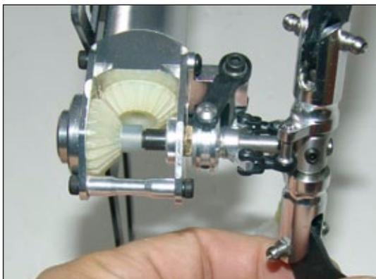
Anschließend die Schiebehülse zur anderen Seite auf Anschlag bringen und den Schmiervorgang auf der noch nicht benetzten Stelle vornehmen. Zum Schluss durch Hin- und Herbewegen der Hülse von Hand bis jeweils zu den Anschlägen für gleichmäßige Verteilung des Schmiermediums sorgen
