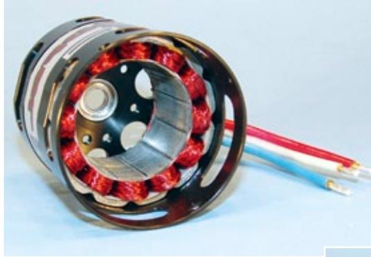
Der mäanderförmige Blechschnitt im Außenbereich des Stators spart maximal Gewicht und bietet axiale Kanäle für die Kühlluft zwischen Blech und Gehäuse-Innenwandung. Man beachte die Richtung Rotor extrem verbreiterten Polschuhe und die damit minimierte (magnetisch nutzlose) Nut zum Bewickeln
