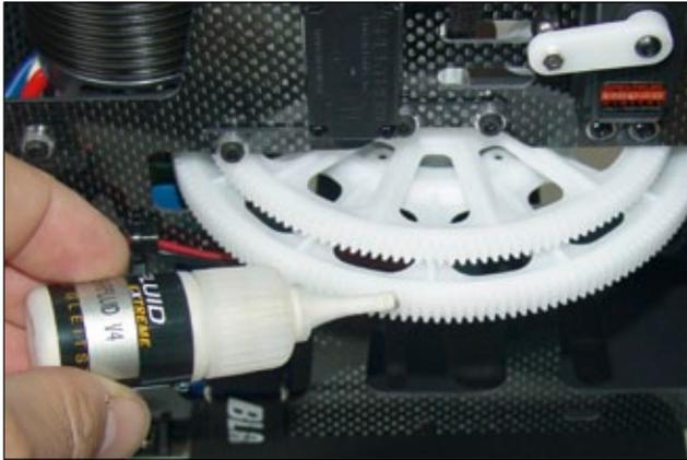
Wir empfehlen auch das Schmieren der Getriebezahnräder – jedoch nicht mit dem dünnflüssigen DryFluid aus den Schritten zuvor, sondern mit geeignetem, dickflüssigeren Medium, zum Beispiel GearFluid. Dieses eignet sich auch für den Einsatz in Verbindung mit Kunststoff. Haupt- und Heckzahnrad gleichmäßig benetzen
