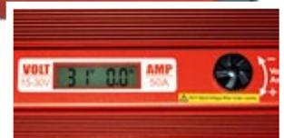
Das seitlich positionierte, hintergrundbeleuchtete LC-Display des eFuel 1200 ist bei den Anzeigewerten ungenau
