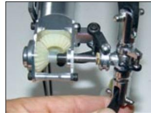
... kann die Heckrotorwelle benetzt werden. Achtung: Tropfenbildung des Gleitmittels sollte man vermeiden
