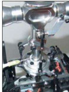
Auch die Rotorwelle sollte man im Bereich des axialen Gleitens der Taumelscheibe schmieren
