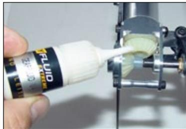
... und auch nicht das Heckrotor-Getriebe. Stets auf gleichmäßiges Benetzen aller Kontaktflächen (=Zahnflanken) achten
