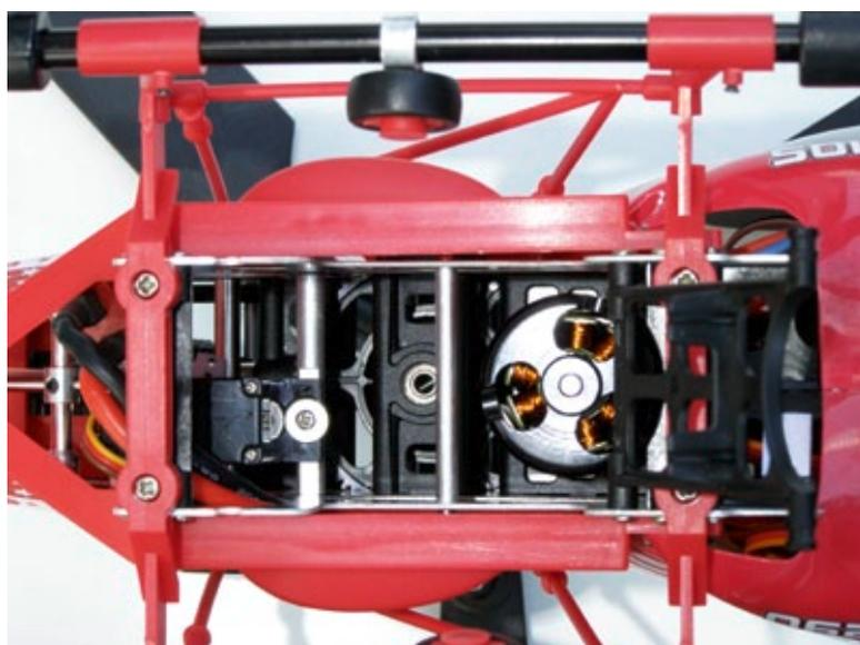
Blick in das Batteriefach auf den Motor
