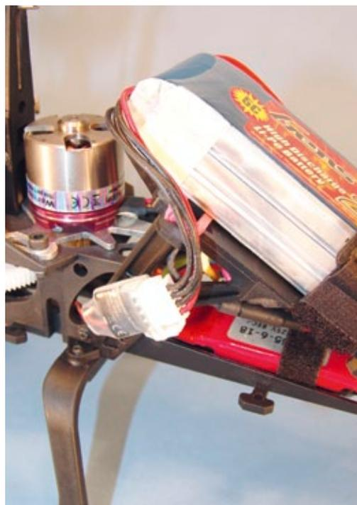
Das Voltage Modul im Mini Titan SE. Gerade bei stark belasteten Akkus im 3D-Heli mit hohen Strömen ist die Einzelzellen-Überwachung von Nutzen
