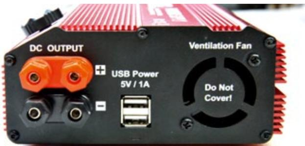
Frontseite des eFuel 30A mit zwei USB-Outputs zum Laden von Kleingeräten (Smartphone, MP3-Player etc.)
