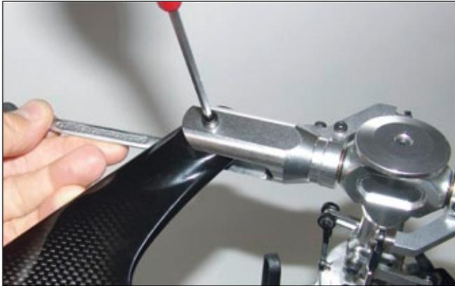
Nun können die Hauptrotorblätter montiert werden. Die Schrauben nur so fest anziehen, dass sich die Blätter von Hand noch in den Blatthaltern mit leichtem Kraftaufwand bewegen lassen. Im Umkehrschluss heißt das aber auch, dass die Blätter so fest sein müssen, dass sie beim Schräghalten des Helis nicht von alleine in den Blatthaltern einklappen
