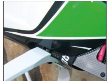
Klebband des LiPo-Akkus zuvor so positionieren, dass der Haubenrand nicht am Chassis kratzt, sondern auf dem Gewebe aufliegt
