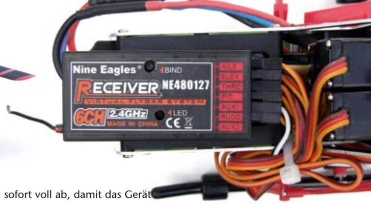
Empfänger und Flybarless-Elektronik im Gehäuse ohne Einstellmöglichkeiten
