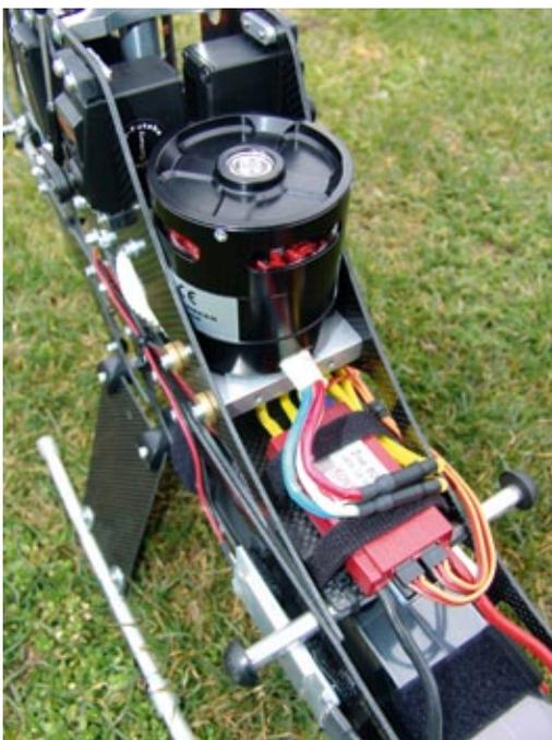
Der Copter 30 EVO passt wie angegossen in den Henseleit TDR. Dank der seitlichen Abfräsungen sitzt er saugend zwischen den Seitenteilen
