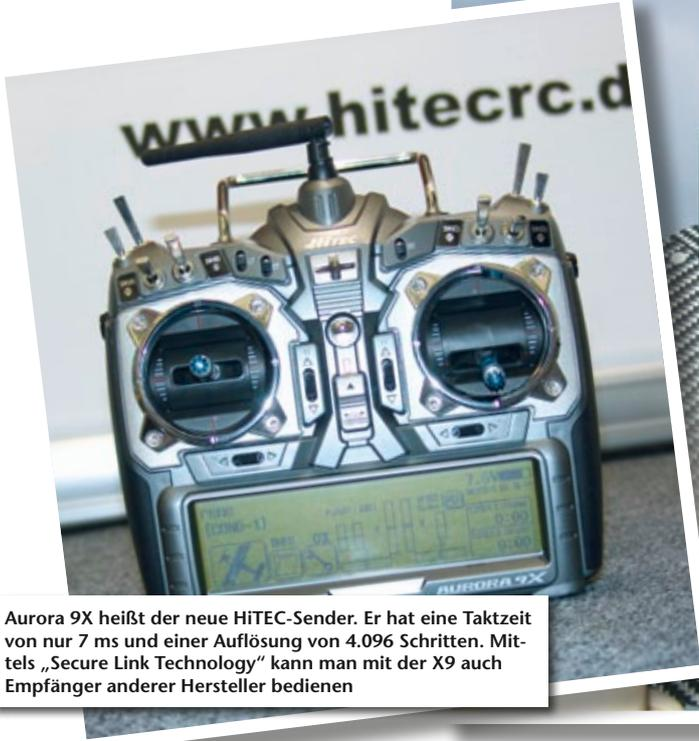
Aurora 9X heißt der neue HITEC-Sender. Er hat eine Taktzeit von nur 7 ms und einer Auflösung von 4.096 Schritten. Mittels „Secure Link Technology“ kann man mit der X9 auch Empfänger anderer Hersteller bedienen
