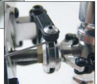
... und anschließend die beiden Metallstifte, die in die Nut der Pitch-Schiebehülse greifen
