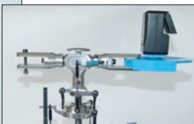
Gemäß Step 13 (siehe RC-Heli-Action 9/2013) gehen wir davon aus, dass alle sender- und flyerless-seitigen Basis-Programmierungen gemäß Manual-Vorgaben des Blade vorgenommen wurden. Besondere Beachtung gilt dem Einstellen der exakten Nullposition (null Grad Einstellwinkel) ...
