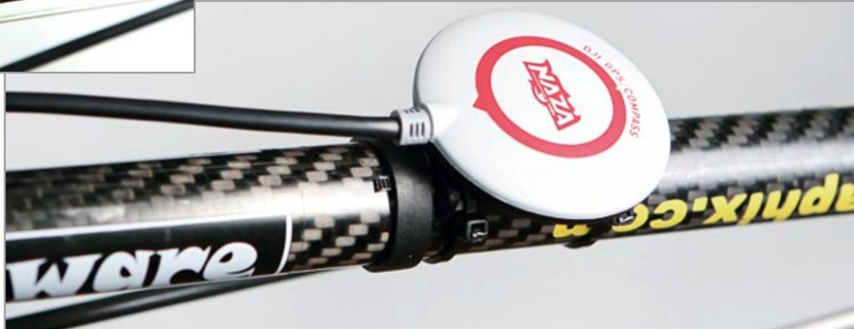
Das GPS/Magnetkompass-Modul wird mittels einer Halterung am Heckrohr befestigt. Es empfiehlt sich, nicht allein auf Klemmung zu vertrauen, sondern zusätzlich doppelseitiges Klebeband einzusetzen
