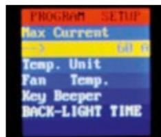
Im TFT-Color-Display des S1500 werden permanent und hochgenau die Werte für Abgabeleistung, Ausgangsspannung, maximale Strombegrenzung und Temperatur angezeigt. Die leichte Unschärfe wird durch die satinierte Schutzfolie über dem Display und den vier Tastschaltern erzeugt
