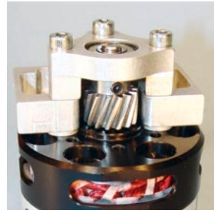
Bei der Befestigung im TDR müssen Unterlegscheiben den Motor auf Abstand zum Motorträger setzen, um die Höhe des Zentrierbunds zu überbrücken
