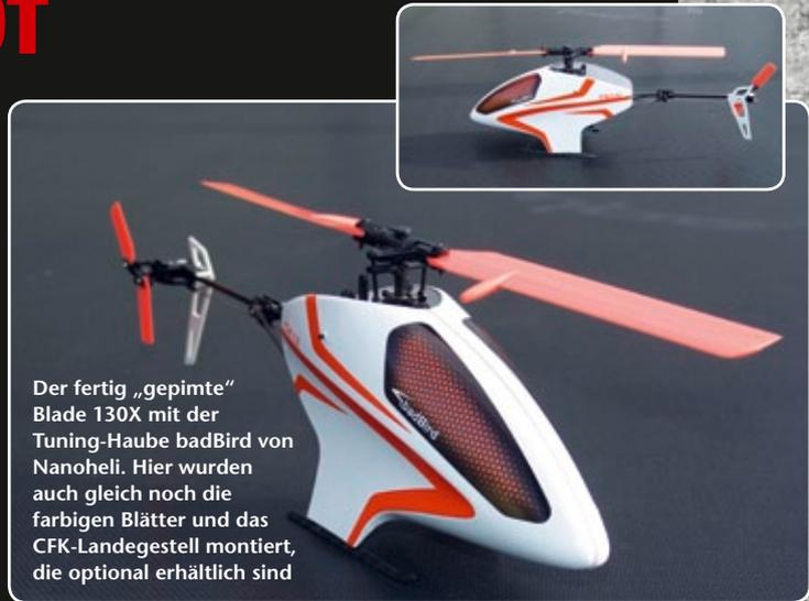
Der fertig „gepimte“ Blade 130X mit der Tuning-Haube badBird von Nanoheli. Hier wurden auch gleich noch die farbigen Blätter und das CFK-Landegestell montiert, die optional erhältlich sind
