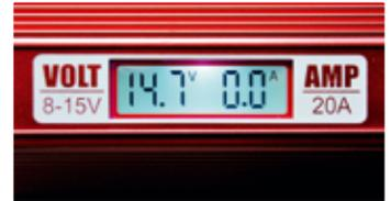
Das seitlich positionierte, hintergrundbeleuchtete LCD-Display des eFuel 20A
