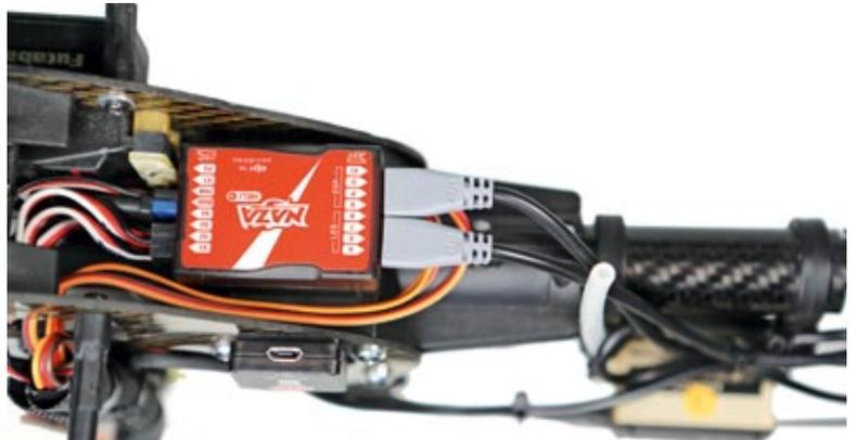
Fertig verkabelt und betriebsbereit. Hier ist der Empfänger via Futaba S-Bus (NAZA nennt das D-Bus) angeschlossen. Man beachte den USB-Anschluss an der seitlichen Remote LED, der zur Kommunikation mit dem PC dient
