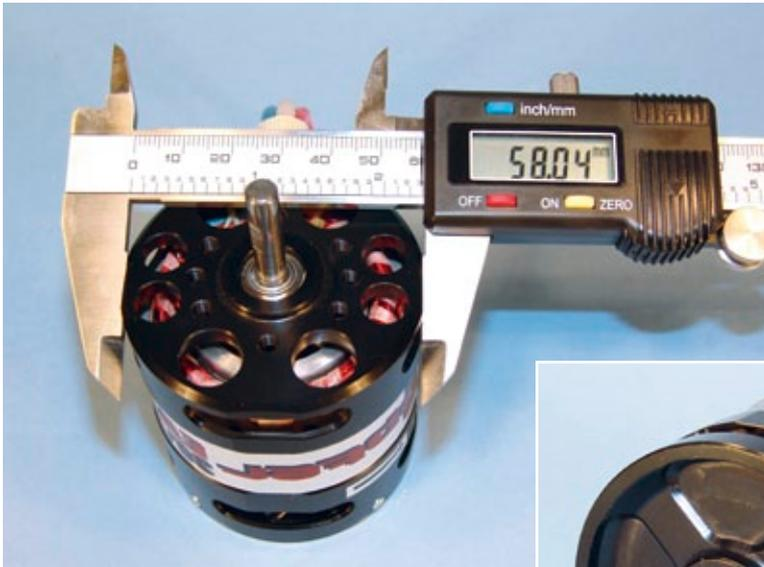
Das Sondergehäuse für den TDR besitzt seitliche Abfräsungen, um saugend zwischen die Seitenteile des Helis zu passen
