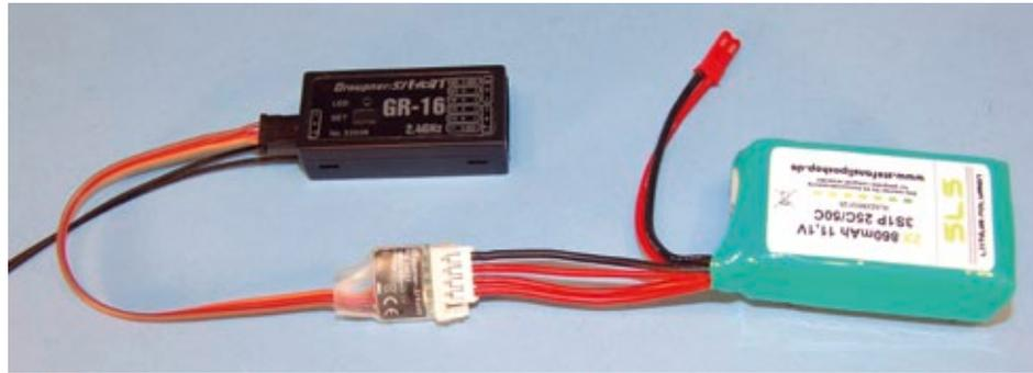
Das Modul wird mit seinem dreidrigen Anschlusskabel in den Telemetrieingang des HoTT-Empfängers gesteckt und ist damit betriebsbereit. Die Belegung des Steckers am Modul startet immer bündig mit dem Masseanschluss. Bei einem 3s-Akku bleibt dann der letzte Pfosten einfach frei
