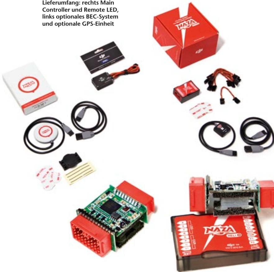
Der Main Controller besteht im Wesentlichen aus einer Hauptplatine und einem gedämpften Sensorblock. Die eigentliche Intelligenz liegt jedoch in der Onboard-Software
