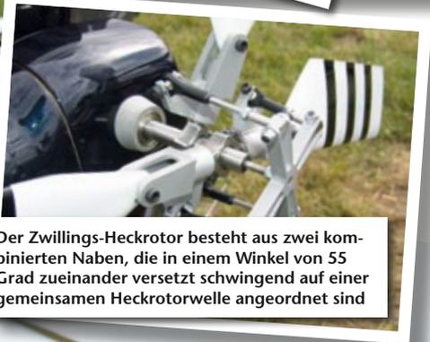
Der Zwillings-Heckrotor besteht aus zwei kombinierten Naben, die in einem Winkel von 55 Grad zueinander versetzt schwingend auf einer gemeinsamen Heckrotorwelle angeordnet sind
