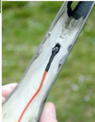
Die entsprechenden Beleuchtungs-Anschlusskabel sind schnell im Rumpf verlegt
