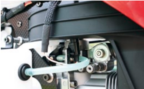
Der Drehzahlsensor des GY701 wird mit dem Halter am Motor befestigt. Dabei ist drauf zu achten, dass dieser so eingestellt wird, dass der Prozent-Wert der Magnetstärke so hoch wie möglich ist
