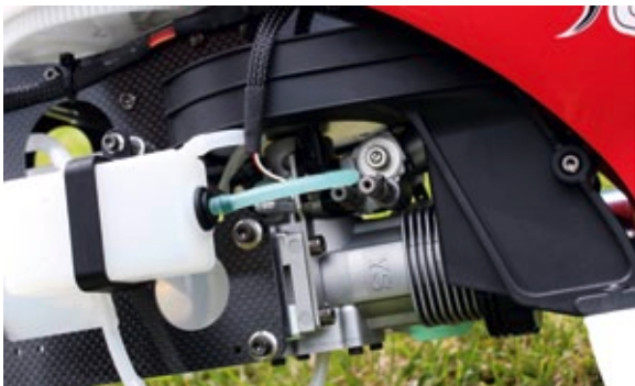
Der Yamada YS 91 SRX von TMRF passt perfekt in den Raptor G4.1. Der Headertank ist im Baukasten enthalten und auch für einen Pumpen-Motor sinnvoll, um eine zuverlässigere Spritzzufuhr gewährleisten zu können
