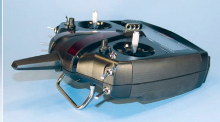
Wohlfühlen: Die stirnseitigen Schalter bieten genügend Abstand, um sicher mit den Fingern hindurchgreifen zu können
