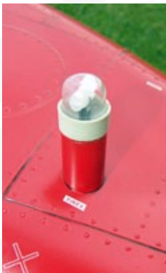
Eine der vielen funktionstüchtigen Beleuchtungskörper an der Kamov KA32, für die eine gesonderte Elektronik verantwortlich zeichnet
