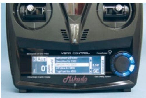
Das Dreh-Drück-Rad ist Schalter und Einsteller zugleich. Unter dem Mikado-Schriftzug ist der Helligkeitssensor für das monochrome Display zu erkennen. Nach dem Verbinden mit dem Modell und Aussuchen des passenden Akkupacks (mit U/I-Sensor-App) ...
