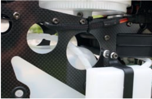
Auch der Druckschlauch zum Tank wird mit einem Spiralschutzschlauch gegen Aufscheuern geschützt
