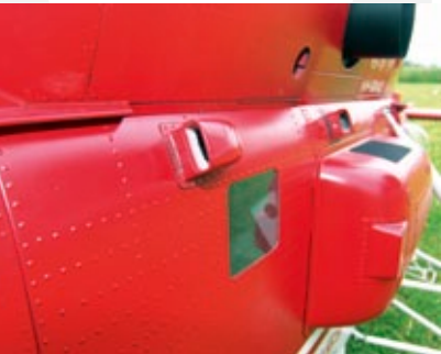
Detail der Seitenwand mit angeformten Lufthutzen
