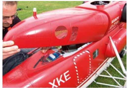
Der hintere Dom-Deckel kann mit wenigen Handgriffen abgenommen werden und gibt den Blick auf das RC-Equipment frei
