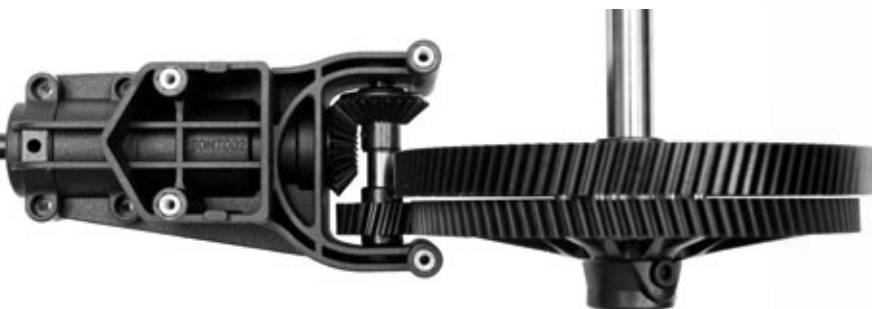
Funktionsschnitt der kompletten Getriebeeinheit. Sowohl Haupt- als auch Heckrotorabtriebs-Zahnrad sind aus CNC-gefrästem Kunststoff und schrägverzahnt ausgeführt
