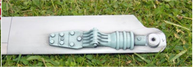
Auch die Rotorblätter – es handelt sich um 1.100 Millimeter lange M-Blades mit einem Gewicht von 510 Gramm – inklusive ihre Blatthälse wurden scalegerecht „verzert“ und mit entsprechendem Alterungseffekt versehen
