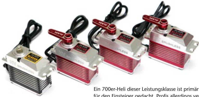
Wo nur ist das übliche Servobrummen geblieben? Die Hochvolt-Servos BL815H (Taumelscheibe) und BL855H (Heck) überzeugen neben Performance auch durch geringen Strombedarf. Dafür werden sie im Betrieb gut warm
