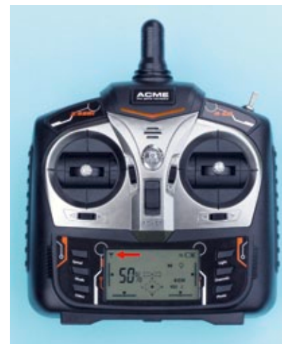
Der Sender des Zoopa Q650. Das Antennen-Piktogramm (roter Pfeil) signalisiert mit Ringen korrekte Bindung, die Ringe verschwinden bei grenzwertiger Entfernung im Flug (Telemetrie)
