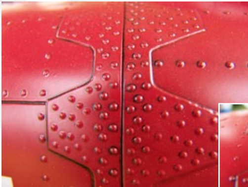
Die Nahaufnahmen verdeutlichen die hohe Oberflächengüte. Die Nieten sind bereits serienmäßig aufgebracht, also fest in der Rumpf-Negativform eingearbeitet
