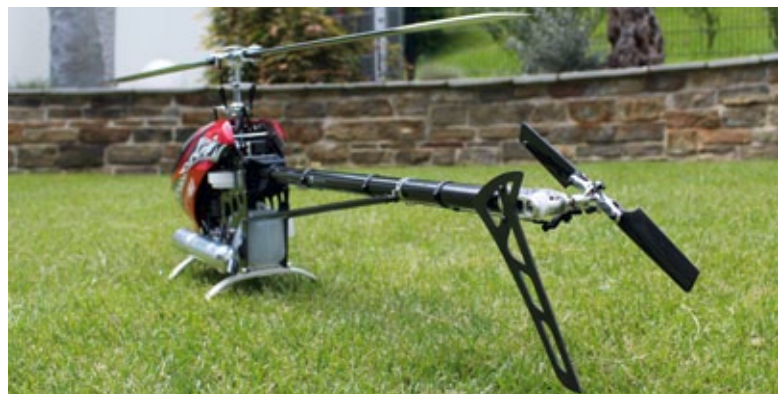
Klare Sache, dass das Heckrohr zum Chassis hin mit Streben abgestützt ist
