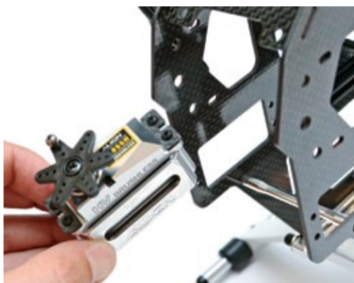
Das superschnelle Heckservo BL855H wird mittels eines Metallrahmens an der Mechanik befestigt und schließt bündig mit der Seitenplatte ab
