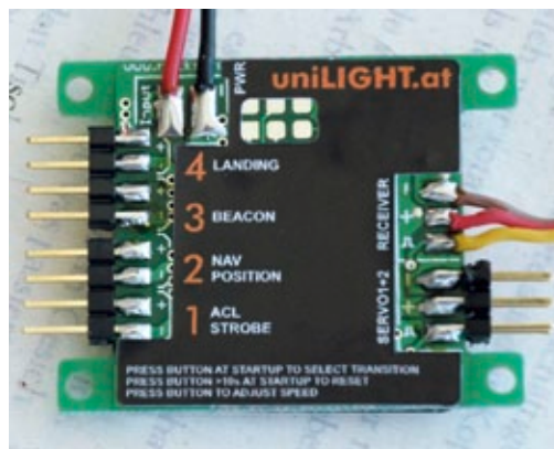
Herzstück der Lichtsteuerung ist das Scale-Schaltmodul-4-300-2, das bis zu vier unabhängige Lichtkreise steuert. Zusätzlich können unter anderem auch noch zwei Servos angeschlossen werden
