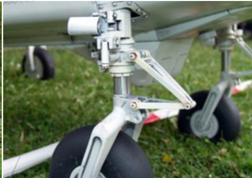
Besser und robuster kann man das kaum bauen: Auch die beiden vorderen Ganzmetall-Fahrwerks-Mechaniken wurden gemäß dem bemannten Vorbild nachgebildet und sind selbstverständlich auch mit funktionstüchtiger Federung ausgestattet
