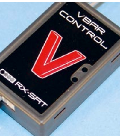
Der Empfangs-Satellit besitzt an seiner Oberseite zwei Status-LED zur Kontrolle des Bindung und der Datenübertragung
