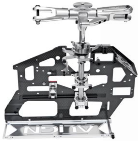
Kein Klemmring, sondern ein erhaben angeformter Ring an der Hauptrotorwelle sorgt zusammen mit Passscheiben für einen spielfreien Sitz über dem obersten Domlager
