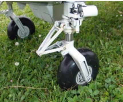
Besser und robuster kann man das kaum bauen: Auch die beiden vorderen Ganzmetall-Fahrwerks-Mechaniken wurden gemäß dem bemannten Vorbild nachgebildet und sind selbstverständlich auch mit funktionstüchtiger Federung ausgestattet
