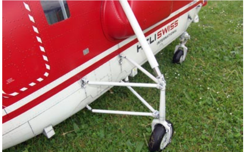
Hier die Gesamtansicht des rechten Hauptfahrwerks mit der zum Rumpf hin verstrebtten Rohrkonstruktion
