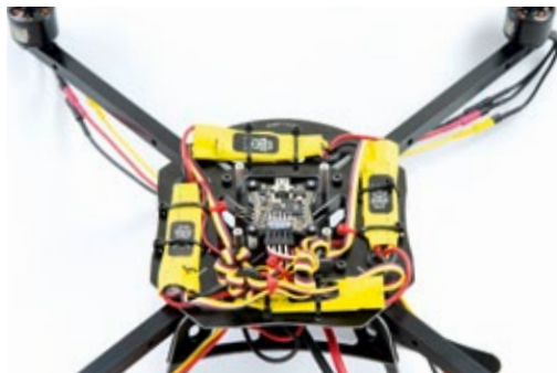
Fertig montierte und verkabelte Motor-Controller
