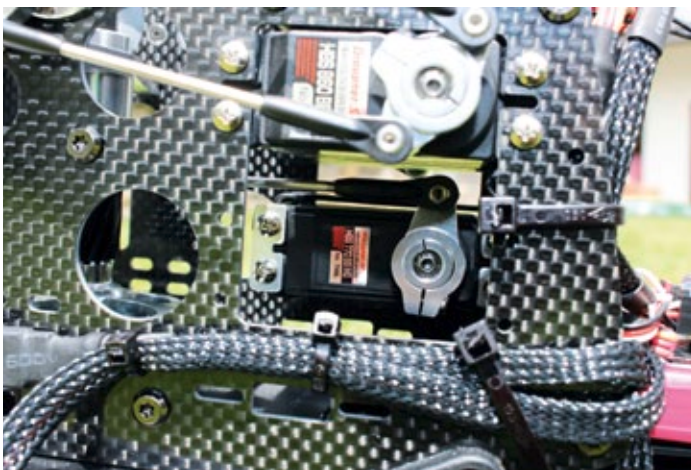
Das Heckservo (unten) sitzt vorne im Chassis. Die Montage des Gestänges ist etwas fummelig, doch dafür sitzt es dort geschützt
