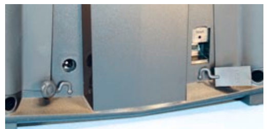
Der Akku kann mit dem Schnelllader oder alternativ per USB-Anschluss geladen werden. Die Anschlüsse werden bei Nichtgebrauch verschlossen
