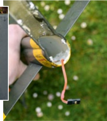
Die entsprechenden Beleuchtungs-Anschlusskabel sind schnell im Rumpf verlegt
