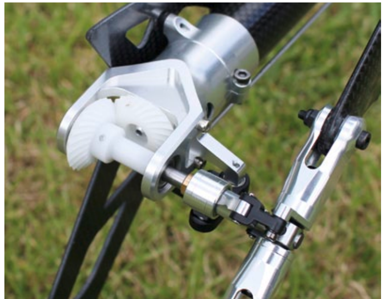
Das Heckrotor-Getriebegehäuse sowie die Blatthalter sind vollständig aus Aluminium gefertigt. Spiralverzahnte Kegelräder aus Delrin sorgen für ein angenehmes Laufgeräusch
