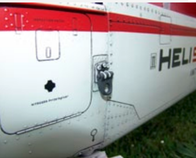
Bleche, Scharniere und Stoßkanten wurden ebenfalls in den GFK-Formteilen berücksichtigt. Enorm viel Liebe steckt auch im Finish der hier gezeigten Heliswiss, in dem auch Alterungsspuren berücksichtigt wurden
