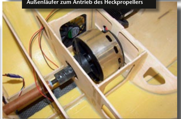
Der im Frontbereich untergebrachte Außenläufer zum Antrieb des Heckpropellers
