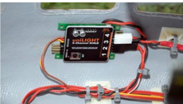
Das Schaltmodul nimmt wenig Platz in Anspruch und kann bequem an der Rumpfsseitenwand befestigt werden
