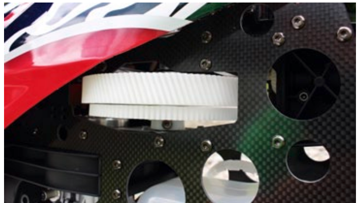
Das massive 111-Zähne-Hauptzahnrad ist auch bei der Nitro-Variante schrägverzahnt. Das leisere Betriebsgeräusch ist beim Nitro allerdings kein Argument. Da das Hauptzahnrad auch bei den Elektrohelis mit Leistungen jenseits von 5 Kilowatt perfekt hält, haben wir auch beim G4.1 keine Sorge
