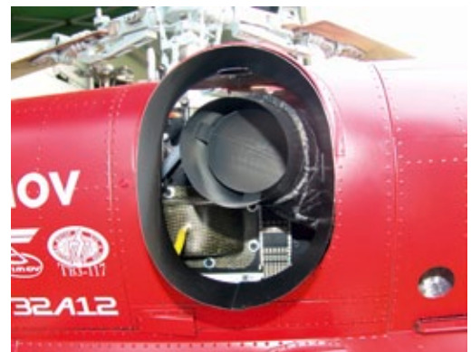
Scale-gerecht befinden sich die beiden Turbinen-Auslassöffnungen beidseitig im oberen Bereich des Rumpfs
