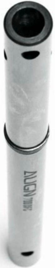
Kein Klemmring, sondern ein erhaben angeformter Ring an der Hauptrotorwelle sorgt zusammen mit Passscheiben für einen spielfreien Sitz über dem obersten Domlager
