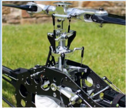
Hat sich bereits in Raptor-Vorgängermodellen bestens bewährt – der Ganzmetall-Hauptrotor. Der Pitchkompensator sorgt für eine Untersetzung der Anlenkung
