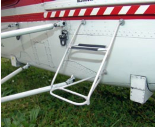
Es wurde an jedes kleine Detail gedacht – sogar die obere Treppenstufe ist mit Antirutsch-Belag versehen. Daneben befinden sich die Streben des Fahrwerks
