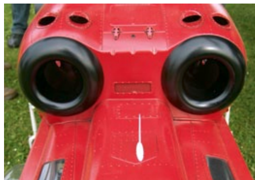
Eine der vielen funktionstüchtigen Beleuchtungskörper an der Kamov KA32, für die eine gesonderte Elektronik verantwortlich zeichnet
