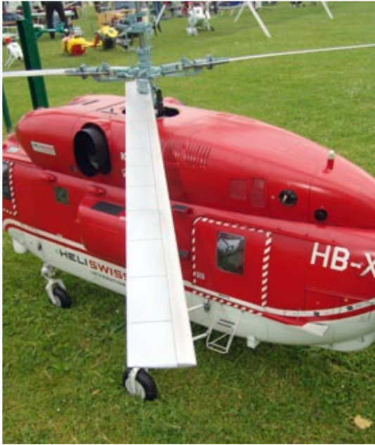
Auch die Rotorblätter – es handelt sich um 1.100 Millimeter lange M-Blades mit einem Gewicht von 510 Gramm – inklusive ihre Blatthälse wurden scalegerecht „verzert“ und mit entsprechendem Alterungseffekt versehen
