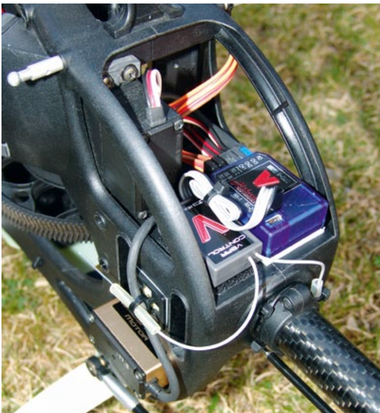
VBar Control im Mikado LOGO 550SE. Die Antennenenden werden mit größtmöglichem Abstand im 90-Grad-Winkel zueinander angeordnet. Die Verbindung zum V-Stabi erfolgt über ein vierpoliges Anschlusskabel
