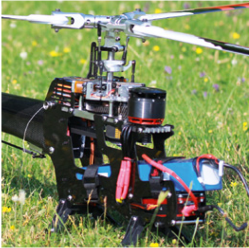
Kraftwerk – der Kontronik Pyro 850-40. Er wird mit 14s-LiPos befeuert. Der Kosmik 200 HV liegt ganz vorne zwischen den Seitenplatten verstaute
