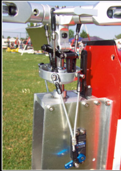
Blick auf eine der beiden Taumelscheiben im Labrador-Tandem von Heiko Fischer, bei der das gleiche Mischsystem arbeitet: Zweiservo-Taumelscheiben-Anlenkungen der Taumelscheibe ohne Nickbewegung
