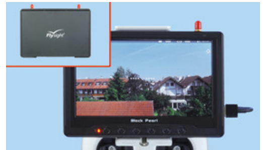
Alternative zur Brille ist der Black Pearl Monitor von Globe Flight mit seinem hervorragenden klappbaren, optionalen Lichtschacht. Das gezeigte Bild ist live, vom P3-OSD ist wenigstens der wichtige CDI zu sehen
