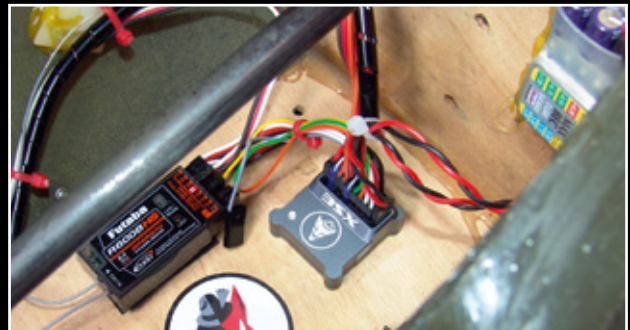
Auf der RC-Platte der Chinook sind der Empfänger sowie das bavarian-DEMON 3SX untergebracht. Das schwarze CFK-Rohr ist die Verbindungswelle zwischen Front- und Heckmechanik-Getriebe
