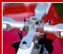
Der Hauptrotor von Benda, kombiniert mit 5-Schlag-Bl ttern von Roban
