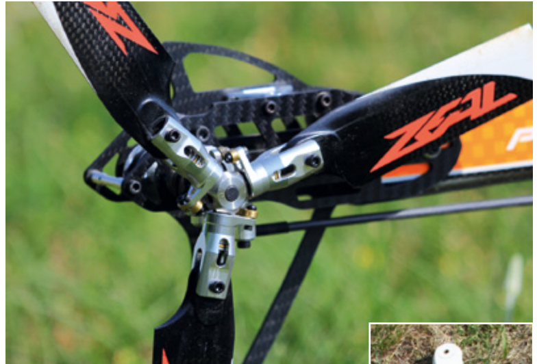
Auch der Goblin-Heckrotor wurde mit entsprechenden Zeal-Blättern (Länge 115 Millimeter) bestückt
