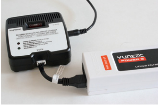
Die Flugakkus können sowohl über den beiliegenden Balancerlader als auch über einen Kompaktlader mit EC3-Ladekabel befüllt werden
