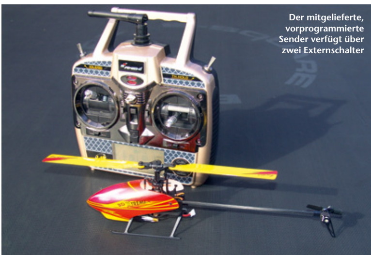
Mit dem rechten Tastschalter kann zwischen hoher und geringer FBL-Aktivität gewählt werden (siehe Text)
