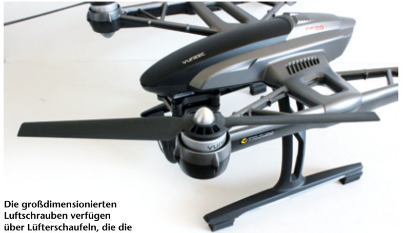
Das verrippte Landegestell ist bereits am Modell platziert und dient zur Aufnahme der Empfangsantenne und des Magnetkompasses
