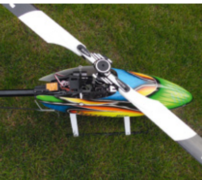
Testträger Nummer 2 ist ein T-Rex 550. Hier wurde das „normale“ Microbeast Plus (nicht die HD-Version) verwendet. Attitude Control-Software und Funktionalität ist die selbe wie in der HD-Ausführung
