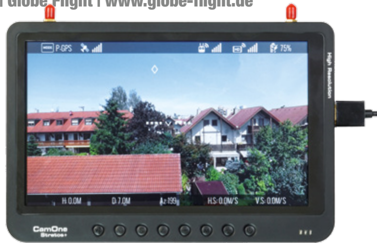
Die 7- beziehungsweise 9-Zoll-Monitore von ACME zeigen in der Einstellung „Just Sync“ das OSD des P3 auch über den HDMI-Eingang komplett. Das Bild ist live
