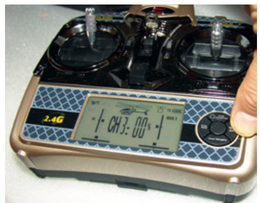
Mit dem rechten Tastschalter kann zwischen hoher und geringer FBL-Aktivität gewählt werden (siehe Text)
