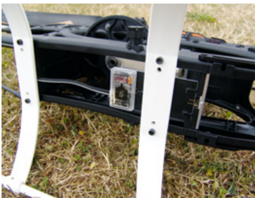
Die automatische Erkennung des Flugakkus übernimmt der optionale Akku-ID-Sensor auf der Unterseite des Chassis
