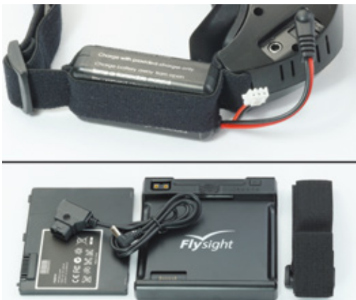
Die Stromversorgung erfolgt mit einem 2s-LiPo (1Ah) in einer Halteschleife am Kopfband oder mit einem 3s-LiPo (1Ah) in einer Armhalterung mit integriertem Ladegerät
