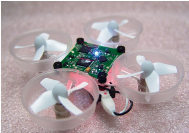
Die Betriebsstatus-LED sitzt auf der Oberseite der Platine – bei blau kann es mit dem Fliegen losgehen
