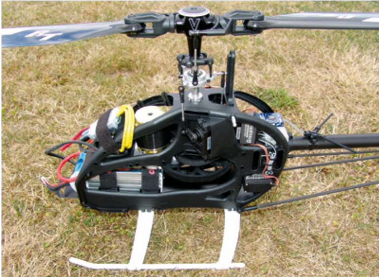
Aufgeräumter und übersichtlicher kann ein Elektrohubschrauber nicht sein. Der Flugakku sitzt für eine korrekte Schwerpunktlage weit vorne
