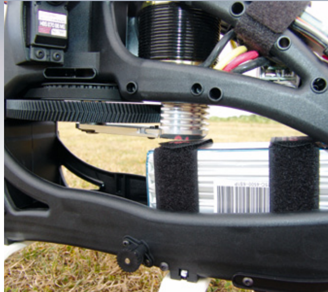
Zwischen Flugakku und Gegenlager verbleibt je nach Akku-Abmessung nur noch ein geringer Luftspalt
