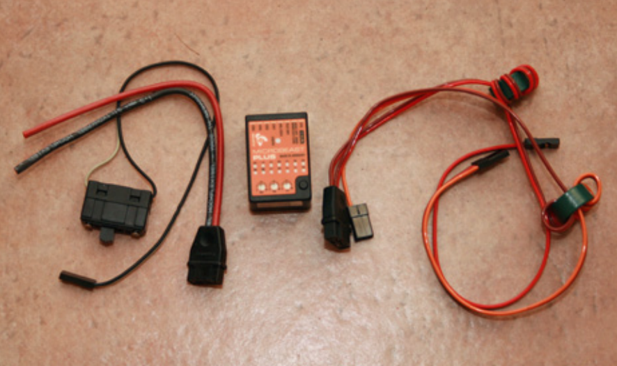
Die Microbeast PLUS HD-Version wird mit einem Kabelsatz und Schalter geliefert. Hier sind die Kabel zum Anschluss an einen Kontronik-Controller (Master und Slave) angelötet
