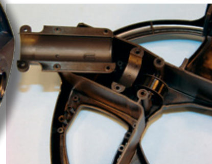
Mit eingesetzten Halbschalen wird der Heckrohr-Durchmesser auf 22 Millimeter adaptiert
