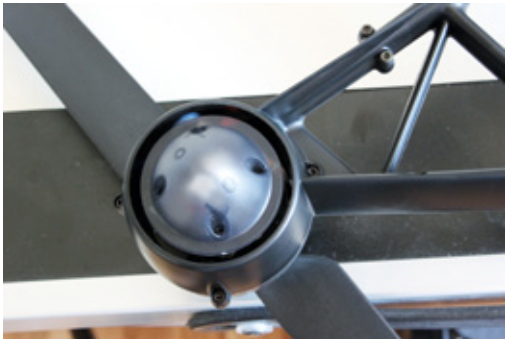
Unter den Motorgondeln befinden sich LED. Diese geben über Blinkfolgen Informationen zum Betriebszustand des Kopters
