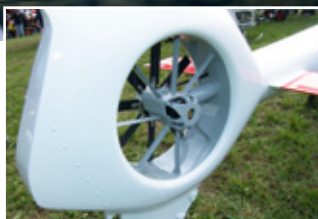
Markant an der Kolibri ist der achtbl trige Fenestron mit einem Durchmesser von etwa 200 Millimeter. Die Fenestron-Drehzahl betr gt etwa 9.500 U/min
