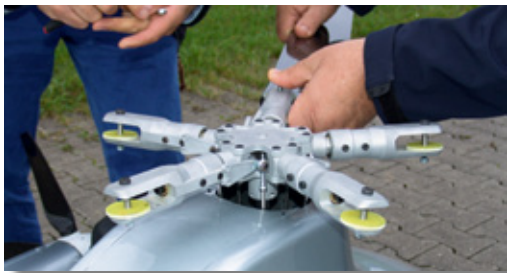
Das Alterbaum-Fünfblatt-Hauptrotorsystem hat einen Durchmesser von 2.500 Millimeter, die bevorzugte Rotordrehzahl beträgt 950 Umdrehungen pro Minute
