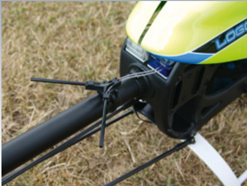
Der Mikado-Antennenhalter ist universell für unterschiedliche Heckrohrdurchmesser verwendbar und wird einfach mit einem Kabelbinder befestigt
