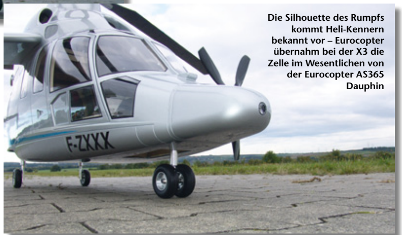
Die Fünfblatt-Luftschauben aus Kohlefaser haben einen Durchmesser von 550 Millimeter und drehen etwa 4.200 Umdrehungen pro Minute
