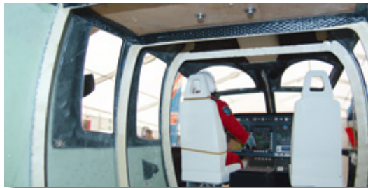
Ein Blick ins Innere der Zelle zeigt den stabilen Aufbau mit Spanten-Aussteifungen und Kohelfaser-Verstärkungen
