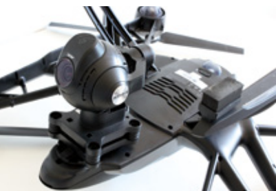
Bei der CGO3 handelt es sich um eine über drei Achsen stabilisierte Kamera, die Aufnahmen mit einer maximalen Auflösung von 4K und 30 Frames erstellt. Eine 16-Gigabyte-Micro-SD-Karte gehört zum Lieferumfang
