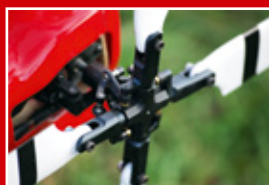
Der Vierblatt-Heckrotor samt Heckbl tter wurde von Roban  bernommen
