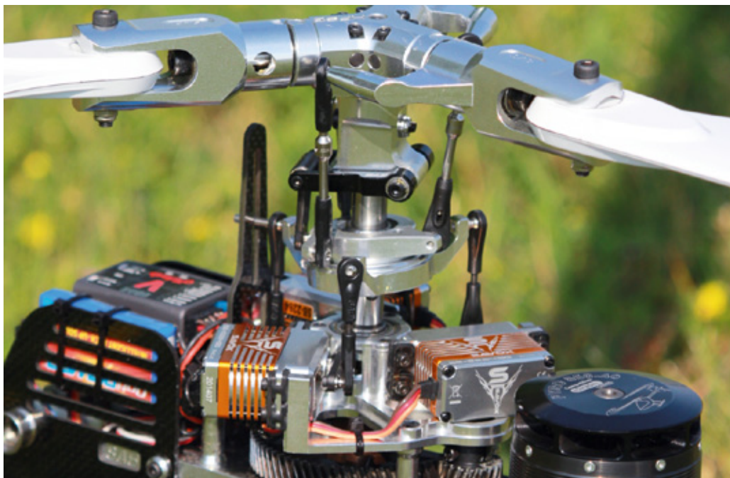
Die Savöx-Taumelscheiben-Servos des Typs SB-2284SG passen nicht nur sehr gut von den Abmessungen, sondern auch von ihren Leistungsdaten zum Dreiblatt-Goblin
