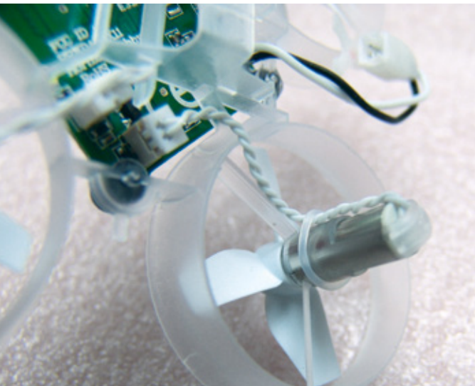
Mit winzigen O-Ringen werden die mit Stecker versehenen Anschlusskabel am Motorgehäuse fixiert
