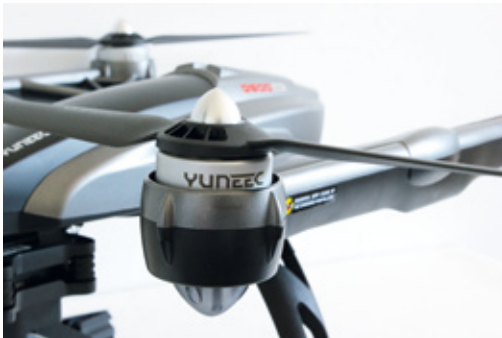
Die Motoren verfügen jeweils über eine spezifische Drehzahl von 700 Umdrehungen pro Minute und Volt
