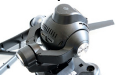
Bei der CGO3 handelt es sich um eine über drei Achsen stabilisierte Kamera, die Aufnahmen mit einer maximalen Auflösung von 4K und 30 Frames erstellt. Eine 16-Gigabyte-Micro-SD-Karte gehört zum Lieferumfang
