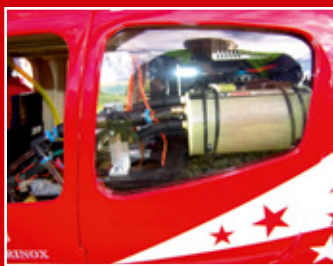
Ma arbeit von Flight Factory war angesagt beim Einpassen der JetCat PHT2-Turbinenmechanik, die ins Spantensystem der Roban-Zelle integriert wurde
