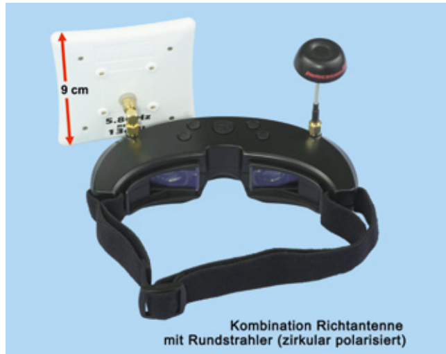
Diversity ermöglicht die Kombination von Antennen für Rundempfang im Nahbereich, mit einer Richtantenne für hohe Reichweite in einem Sektor vor der Brille
