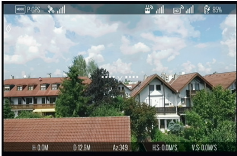
Die 7- beziehungsweise 9-Zoll-Monitore von ACME zeigen in der Einstellung „Just Sync“ das OSD des P3 auch über den HDMI-Eingang komplett. Das Bild ist live
