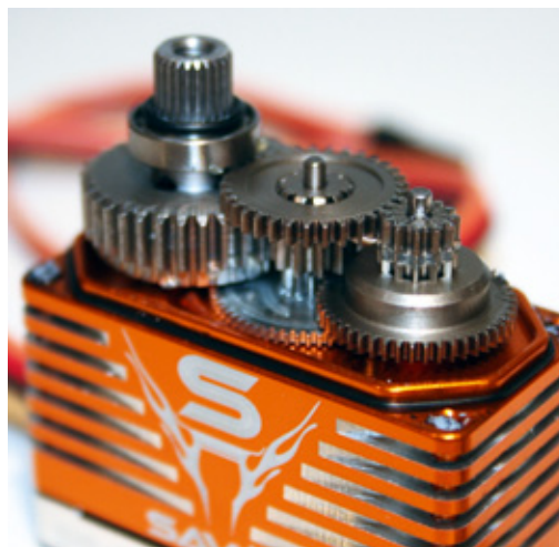
Sehr robust – das Ganzmetallgetriebe des Savöx SB-2284SG
