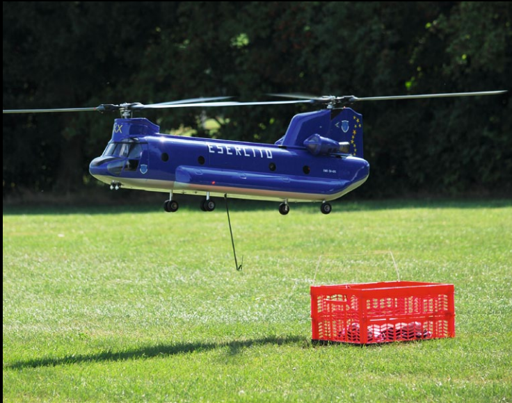
Anflug zur Aufnahme der Flagge. Der Haken ist links geöffnet. Das Außenlastseil im Korb ist als kleines Tor gespannt und kann somit leicht „geangelt“ werden
