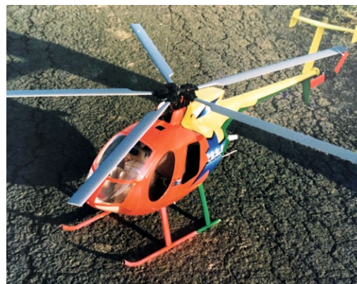
Hier eine der ersten PEKA Hughes 500, deren Rumpf vollständig aus Kevlar gefertigt war. Sensationell niedriges Gewicht und hohe Stabilität zeichneten dieses Modell aus, das mit Fünfblatt-Multi-Blade unterwegs war
