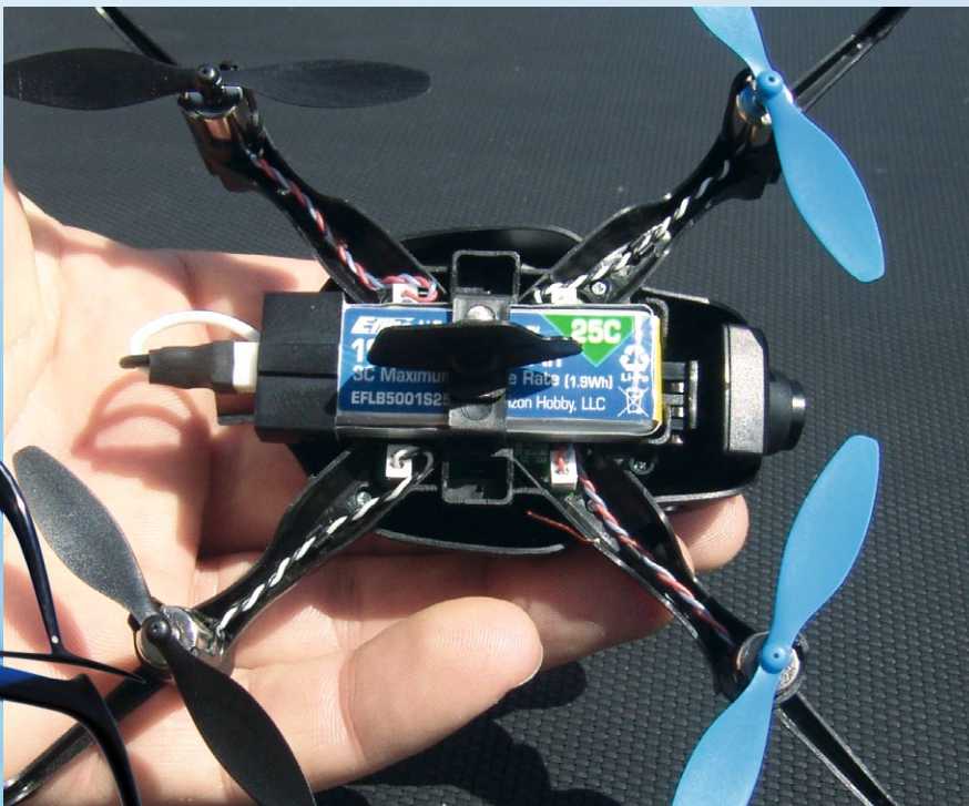
So sitzt der 1s-LiPo-Akku in seiner Halterung
