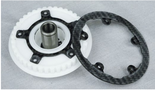
Schritt 5: Das Zahnriemenrad mit dem CFK-Abschlussring
