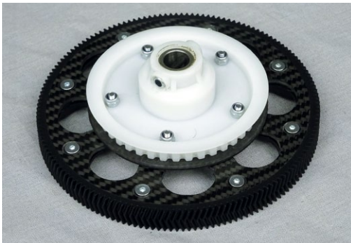
Schritt 8: Hier die umgerüstete Variante mit montiertem Zahnriemenrad
