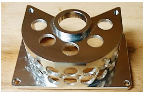
Der bearbeitete Zwischengetriebedeckel, der mit reichlich gewichtsmindernden Aussparungen versehen wurde
