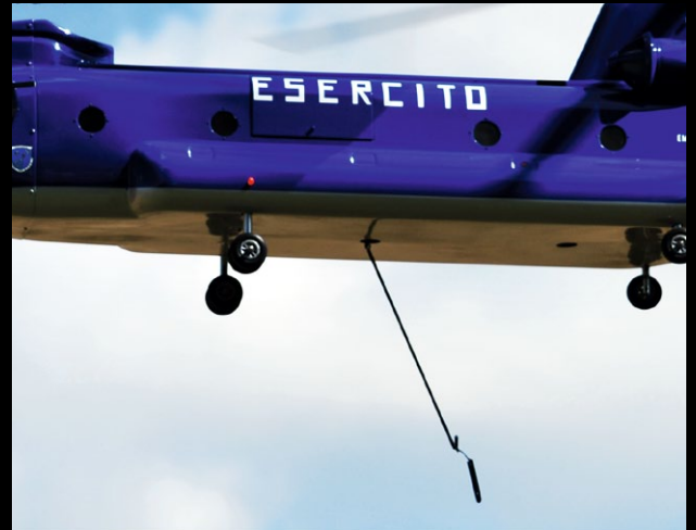
Die hintere Verriegelung ist ausgelöst. Der Fanghaken hängt herunter
