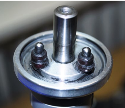
Zentralstück mit den drei Mitnehmern der überarbeiteten, aktuellen Version. Die drei Edelstahl-Kugelzapfen haben jetzt einen Kunststoffring bekommen. Dieser verhindert während des Betriebs das Reiben des Edelstahl-Materials im Aluminium-Zentralstück
