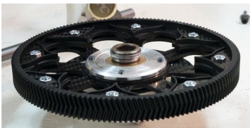
Schritt 9: Das Zahnrad musste mit 3,2 Millimeter Distanz montiert werden
