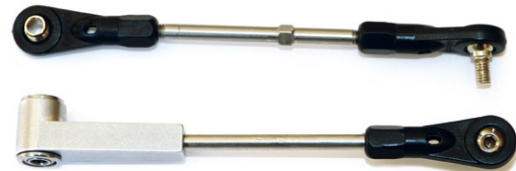
Die Rotorkopf-Gestänge: Das obere ist verstellbar (Links-Rechts-Gewinde), das untere ist nicht verstellbar und dient zur Mitnahme des Taumelscheiben-Innenrings
