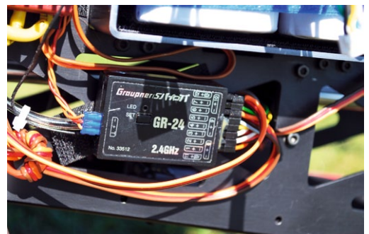
Der Graupner GR-24 HoTT-Empfänger. Man sieht den Anschluss des Jlog an der Telemetriebuchse. Dieser sitzt unter dem Akkufach und ist mit Klettband befestigt. Hierdurch ist es möglich, Updates oder Senderbindungen problemlos durchzuführen. Ein wenig Kleber an der Steckerleiste ist eine Sicherungsmaßnahme für die Stecker des BavarianDemon
