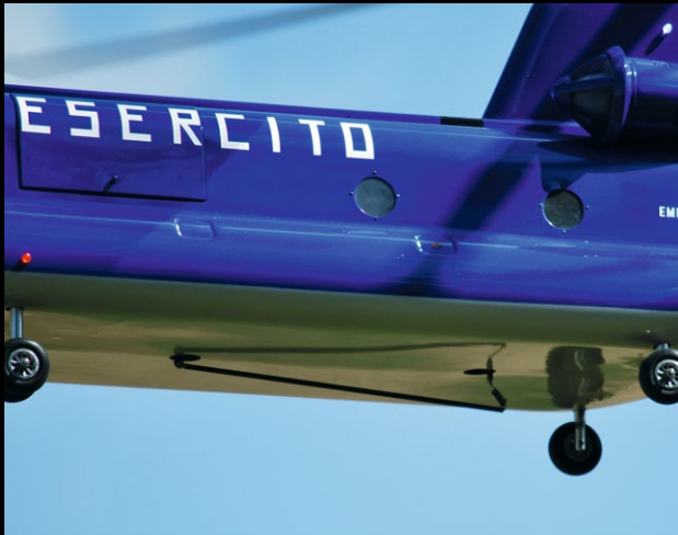
Der unter dem Rumpfboden befindliche, hier noch angeklappte Fanghaken der Schleppkupplung
