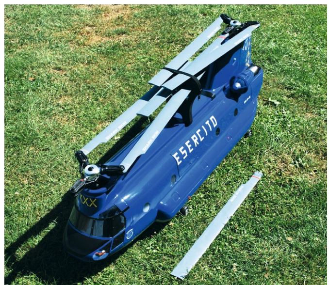
Mit einem umfunktionierten Blatt-Caddy können fünf Blätter angeklappt werden – nur ein Blatt muss man abmontieren. Dadurch geht der Wiederaufbau auf dem Flugplatz fast so schnell wie bei einem Trainer
