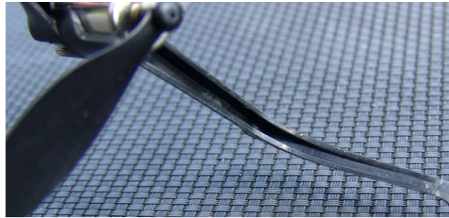
Detail der filigran in Hohlbauweise ausgeführten Landebeinchen, die gleichzeitig als Properschutz dienen
