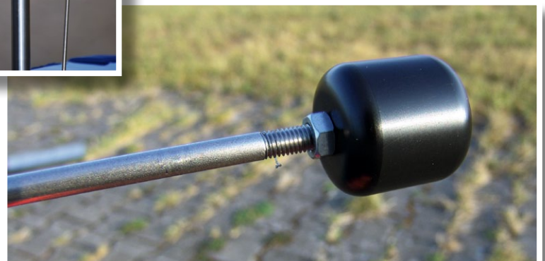
Der Zweiblatt-Rotorkopf der Bell UH-1D ist wie das bemannte Vorbild mit einer Hillerstange samt Gewichten ausgestattet – und zwar keiner Attrappe, sondern einer mit an den mechanischen Dämpfern angelenkte Rotorkopf-Wippe
