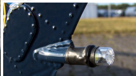
Der Heckrotor mit seinem in der Hohlwelle geführten Pitchgestänge. Deutlich zu erkennen sind auch die vielen aufgetragenen Niete des Rumpfs – und entsprechende Beleuchtung fehlt natürlich auch nicht
