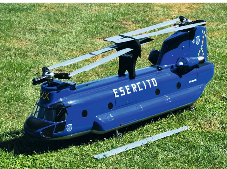
Mit einem umfunktionierten Blatt-Caddy können fünf Blätter angeklappt werden – nur ein Blatt muss man abmontieren. Dadurch geht der Wiederaufbau auf dem Flugplatz fast so schnell wie bei einem Trainer
