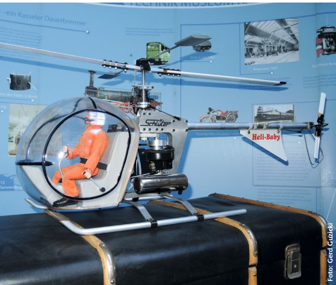
Hier das 40 Jahre Original des Schlüter Heli-Baby mit dem drehzahlgesteuerten Wippen-Rotorkopf und einem 6,5-ccm-Motor
