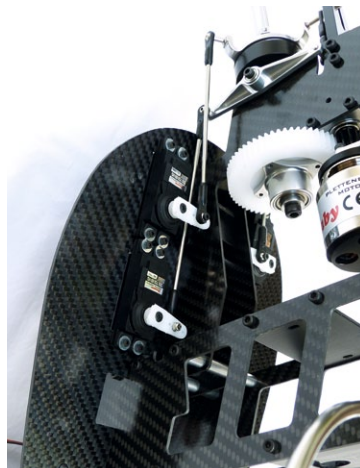
Die 120-Grad-Taumelscheiben-Anlenkung – sehr einfach und direkt
