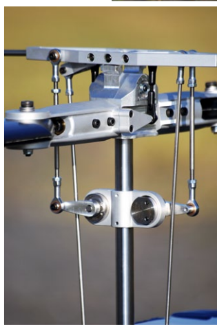
Der Zweiblatt-Rotorkopf der Bell UH-1D ist wie das bemannte Vorbild mit einer Hillerstange samt Gewichten ausgestattet – und zwar keiner Attrappe, sondern einer mit an den mechanischen Dämpfern angelenkte Rotorkopf-Wippe
