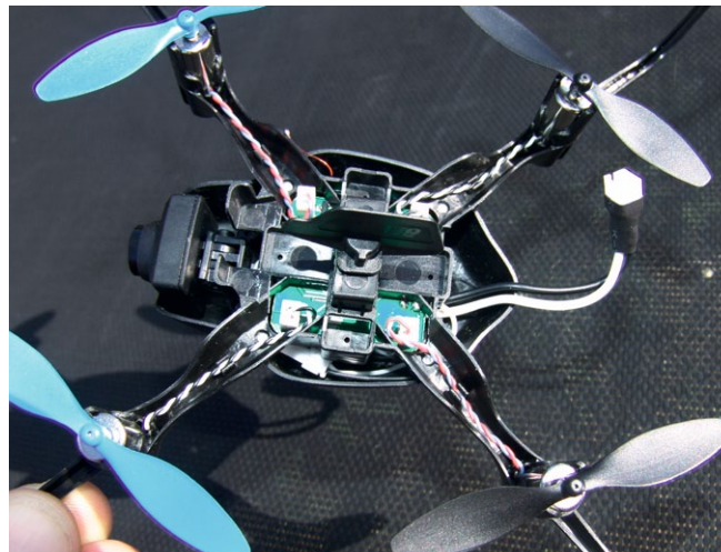
Die Motor-Anschlusskabel sind in den hohl ausgeführten Auslegerarmen verstaut
