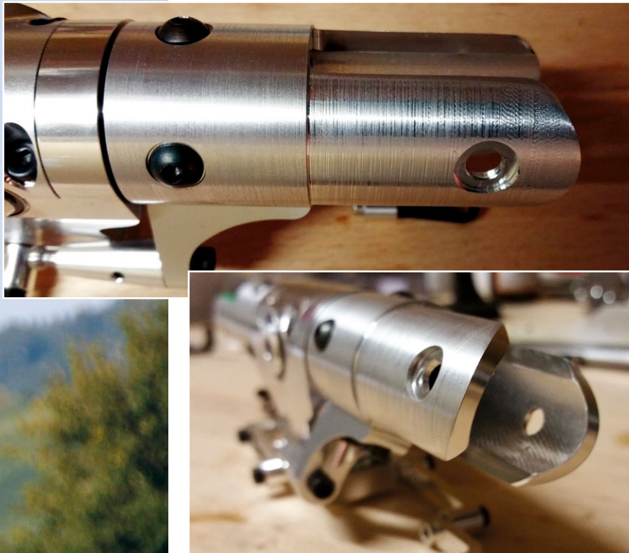
Das Abdrehen der Hauptrotor-Blatthalter brachte eine Gewichtseinsparung von 30 Gramm mit sich
