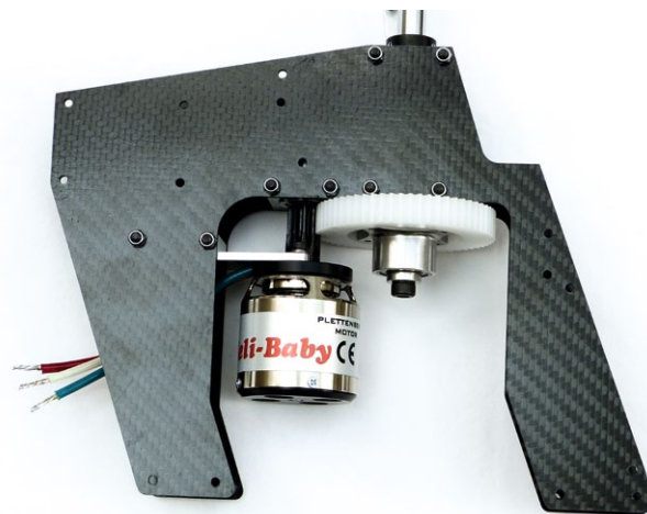
Die Motoreinheit wird zwischen den Chassisplatten verschraubt, wobei die Motorwelle im Lagerbock geführt wird
