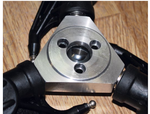
Das Rotorkopf-Zentralstück mit seinen drei Bohrungen für die Mitnehmer. Es hat ein eingebautes Schwenklager, sodass der Rotorkopf – ähnlich einer Taumelscheibe – frei auf der Hauptrotorwelle pendeln kann
