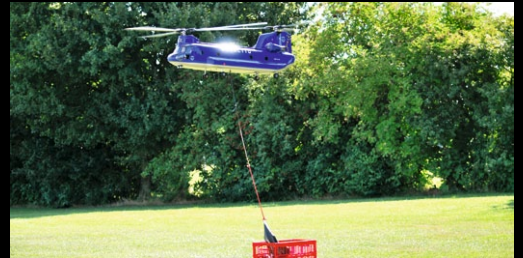
Die hintere Verriegelung ist ausgelöst. Der Fanghaken hängt herunter
