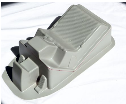
Aus diesem Formteil muss noch der Sitz herausgeschnitten werden (rot markiert)
