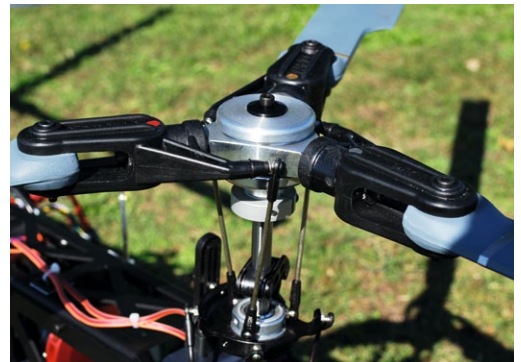
Im Oberteil sitzt der zweite Dämpfungsgummi. Der Deckel wird von oben mit der M4-Schraube und der schwarzen U-Scheibe mit der Rotorwelle verschraubt. Das ergibt eine definierte und super weiche Dämpfung. Wird ein Blatt angehoben, ändern sich die Anstellwinkel der beiden anderen Blattarme
