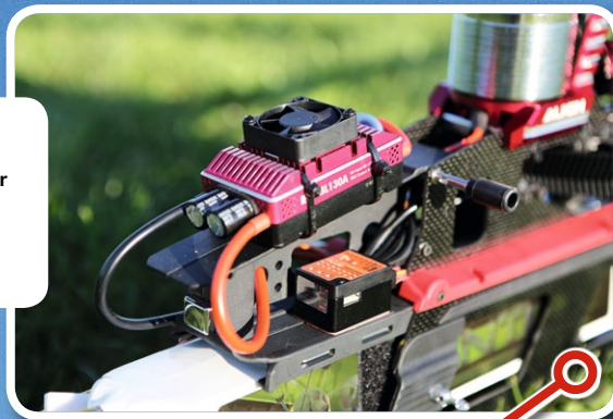
Der zur Super Combo gehörende Controller RCE-BL 130A – diesmal ein Produkt von Align. Unmittelbar davor das im Testmodell zum Einsatz kommende Flybarless-System microBeast HD PLUS von BeastX mit Attitude-Control
