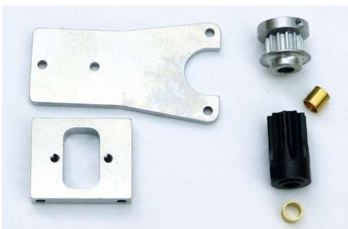
Der Motorträger mit 10-Zähne-Ritzel und Messing-Hülsen. Das Zahnriemenrad dient zum Heckrotorantrieb und wird auf der Motorwelle befestigt
