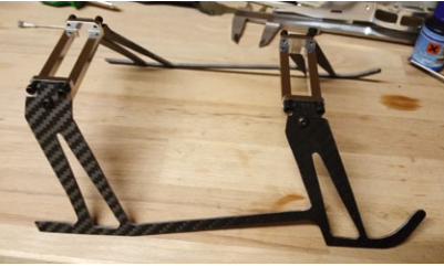
Hier das schlanke und abgespeckte Kufenlandegestell, das bisher klaglos im Betrieb allen Belastungen standgehalten hat
