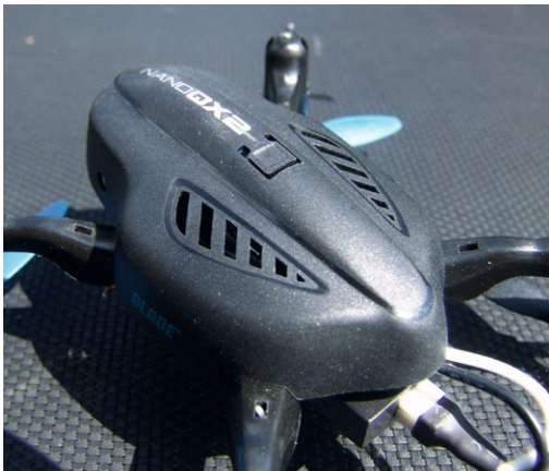
Unter der verschraubten Kabinenhaube befindet sich das Kameramodul samt 5,8-Gigahertz-Video-Sender. Im Zentrum des Chassis sitzt die SAFE Flybarless 4-in-1-Einheit
