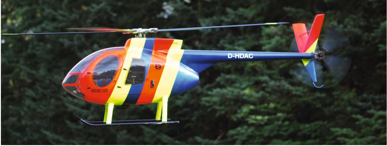
Waren die ersten PEKA Hughes 500 mit Heim-Einbaumechanik und Glühzünder ausgerüstet, passte Günter das Modell in all den Jahrzehnten stets an den aktuellen technischen Standard an. Hier eine modernisierte PEKA-Hughes 500 mit 12s-Elektroantrieb, PEKA-Vierblatt-Hauptrotorkopf und Dreirachs-Flybarless-System
