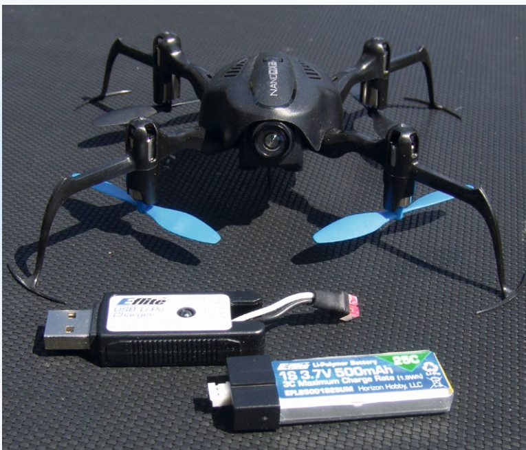
Zur Stromversorgung dient ein 1s-LiPo, geladen wird über USB mittels des Chargers
