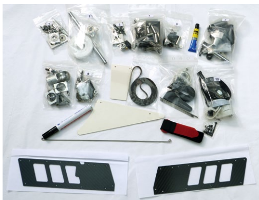
Es handelt sich beim Heli-Baby NT um einen reinen Bausatz – hier ein Blick auf einige der Kleinteile. Mitgeliefert werden auch noch Haube, fertiges Kufengestell, Cockpitsitz und Heckrohr
