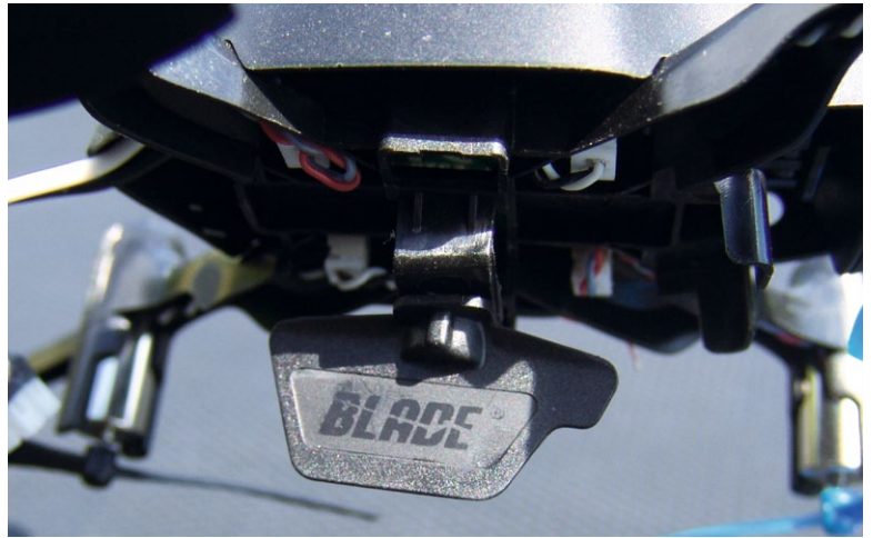
Eine mittig unter dem Kopter angeordnete Finne sorgt für die Einhaltung des Bodenabstands und damit Protschutz beim Landen
