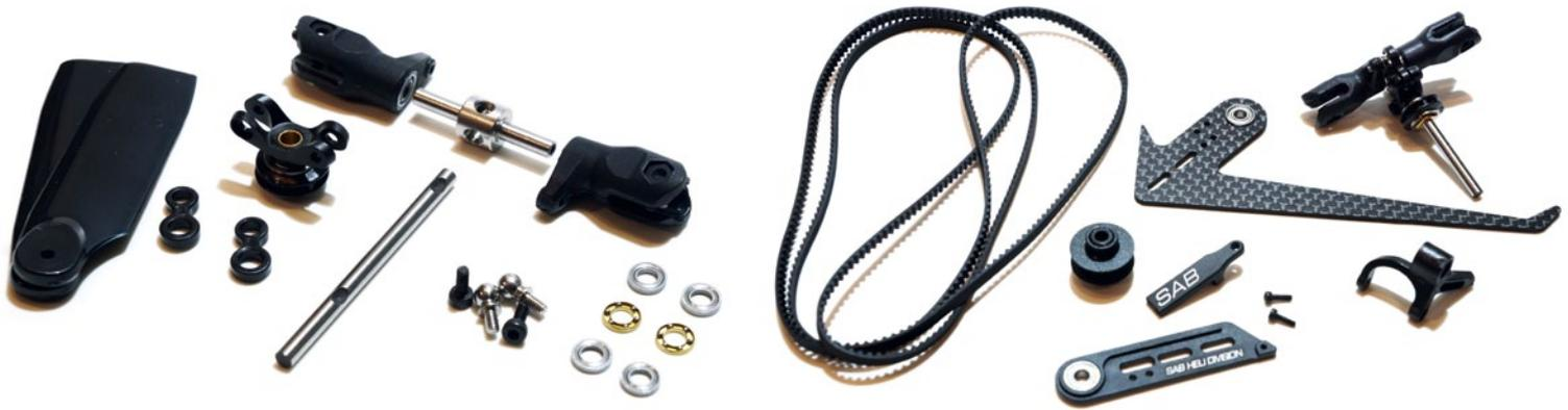
Die wenigen Teile der Heckrotor-Baugruppe. Die linke Seitenplatte (CFK) des Heckrotors ist gleichzeitig das Seitenleitwerk
