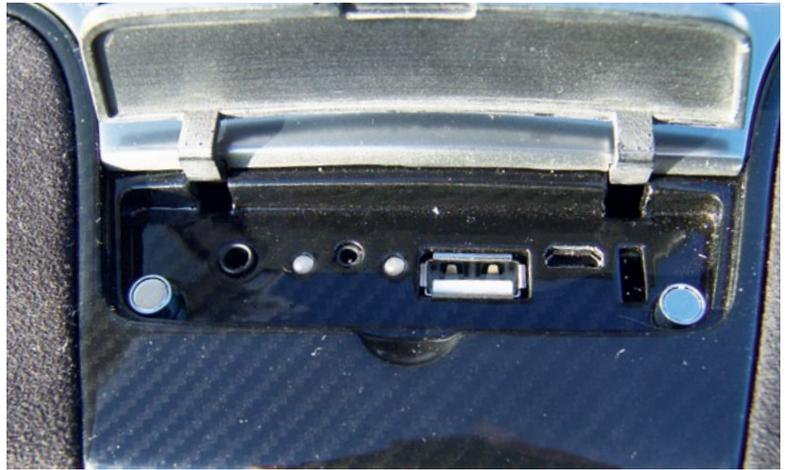
Unter dem Ein-Aus-Schalter befinden sich alle Schnittstellen (von links): Kopfhöreranschluss, Akku-Ladebuchse mit zwei benachbarten Kontroll-LED, zwei USB-Anschlüsse für Gerätestecker und Buchse für integrierten Servotester
