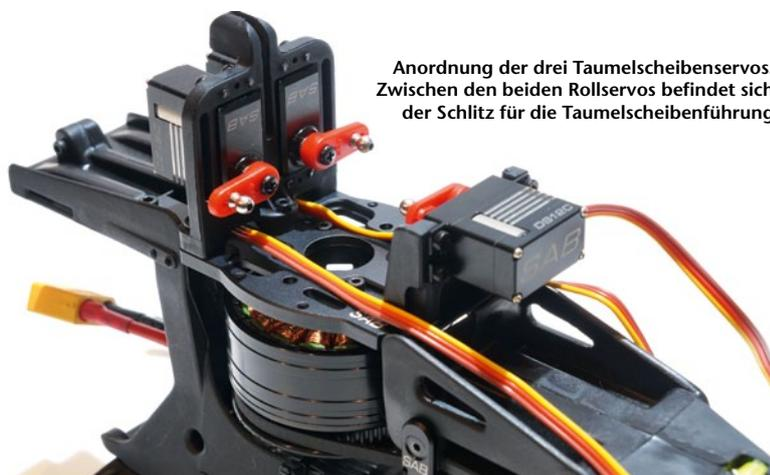
Anordnung der drei Taumelscheibenservos. Zwischen den beiden Rollservos befindet sich der Schlitz für die Taumelscheibenführung
