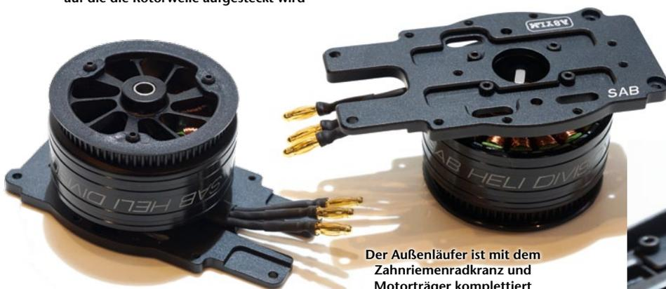
Der Außenläufer ist mit dem Zahnriemenradkranz und Motorträger komplettiert
