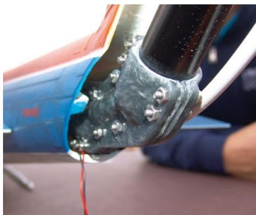
Zwei aus GFK laminierte Halbschalen (Baukasten) nehmen die beiden Alu-Rohre auf. Der Antrieb erfolgt über eine darin gelagerte Flexwelle. Alternativ ist Zahnriemenantrieb möglich
