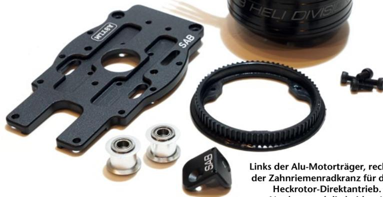
Links der Alu-Motorträger, rechts der Zahnriemenradkranz für den Heckrotor-Direktantrieb. Im Vordergrund die beiden Alu-Führungsrollen für den Heckriemen
