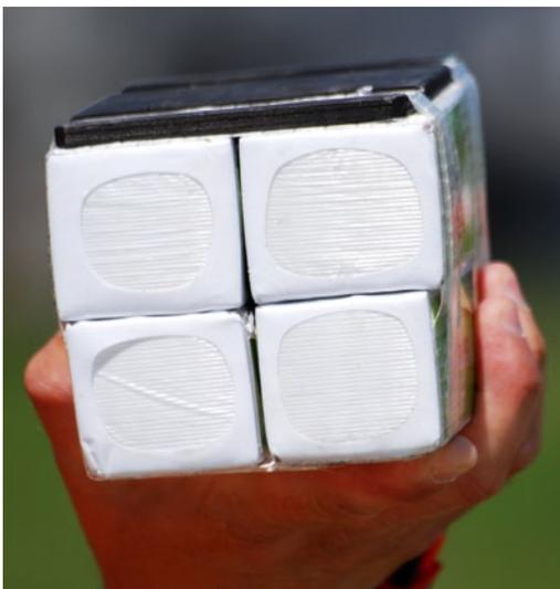
Dieses LiPo-Power-Paket versorgt die Kamov mit Strom. Verschaltet sind diese zu 12s, wobei die Einzelpacks eine Kapazität von 5.000 Milliamperestunden haben
