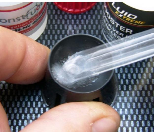
Nun das Klebstoffgel zügig mit dem Rührstäbchen auf die saubere und fettfreie Klebestelle auftragen. Bereits nach etwa fünf Minuten beginnt – je nach Viskosität des Sekundenklebers – der Aushärteprozess
