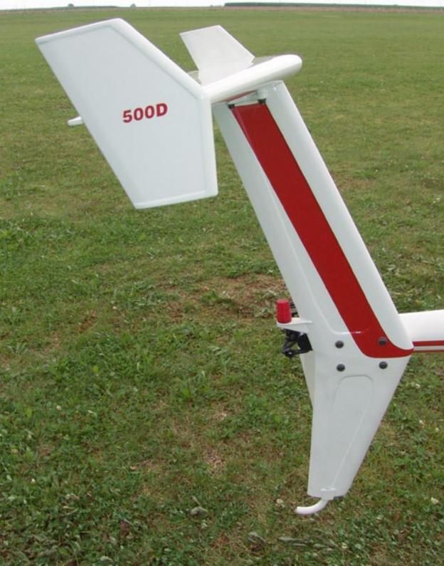
Das T-Leitwerk ist in Sandwich-Bauweise gefertigt und kann zum Transport mit wenigen Handgriffen demontiert werden
