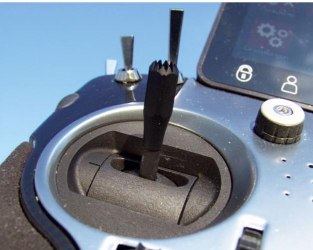
Die kugelgelagerte Mechanik des Kreuzknüppelaggregats ist aus Aluminium gefertigt, glasperlengestrahlt und schwarz eloxiert. Statt Potis kommt neueste Hallsensork zum Einsatz, um verschleißfreien Abgriff zu haben
