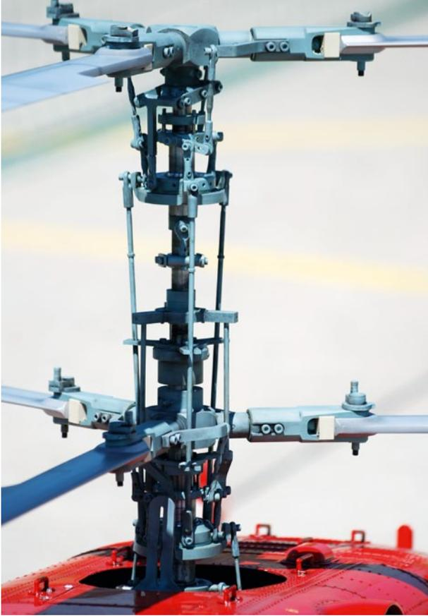
Das koaxiale Hauptrotor-System von HeliClassics, hinter dem ein enormer Entwicklungsaufwand steckt
