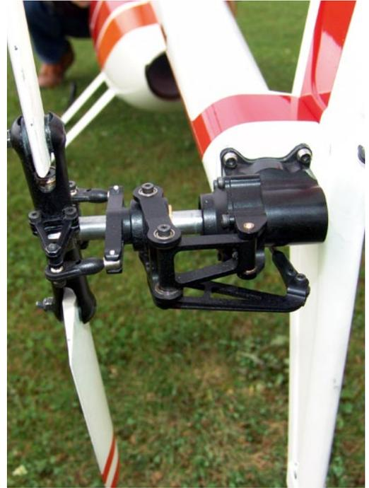
Der schwarz eloxierte M-Blade-Heckrotor mit seinen 140 Millimeter langen Heckrotorblättern
