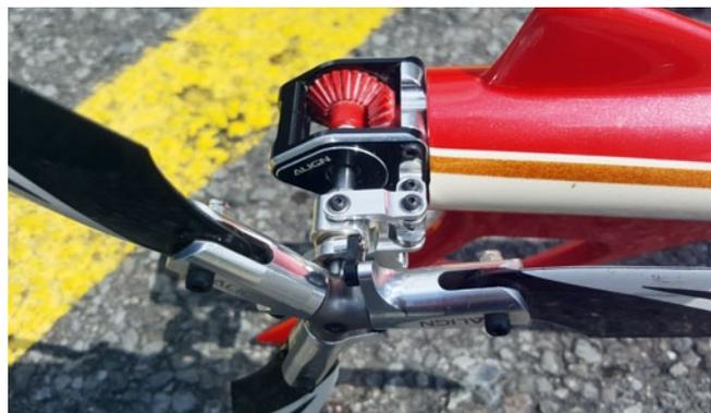
Serienmäßig rüstet Align den T-Rex 760X mit einem Dreiblatt-Heckrotor und Starrantrieb aus
