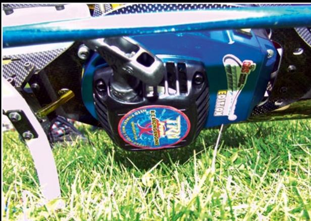
Einen Elektrostarter benötigt man zum Starten nicht. Der Benzinmotor hat einen angeflanschten Seilzugstarter
