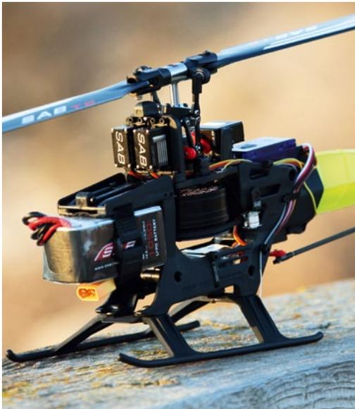
Über eine freiliegende CFK-Schubstange ist der Heckrotor-Umlenkhebel mit dem Heckservo verbunden
