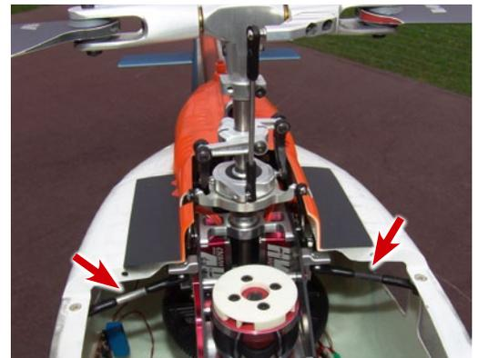
Für zusätzliche Mechanik-Abstützung im oberen Bereich dienen zwei mit der Rumpfwand verbundene Streben (Pfeile). Der hier zu sehende Strecker-Außenläufer hat 1.000 KV
