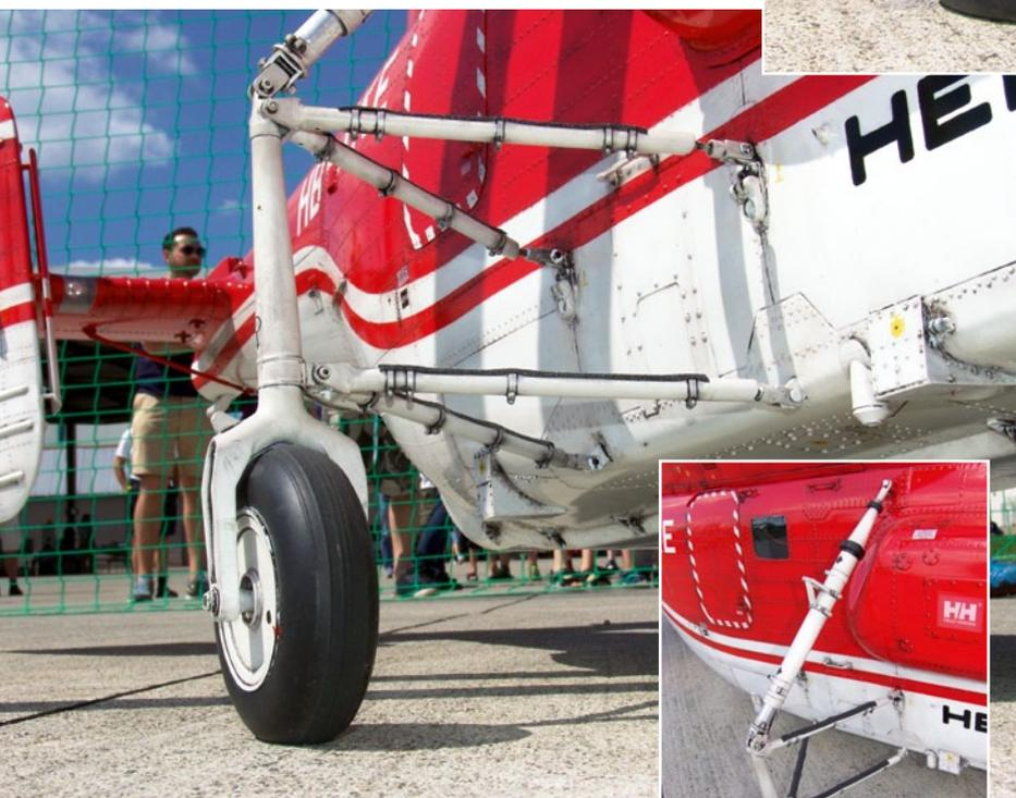
Das linke Hauptfahrwerks mit der zum Rumpf hin verstrebtten Rohrkonstruktion
