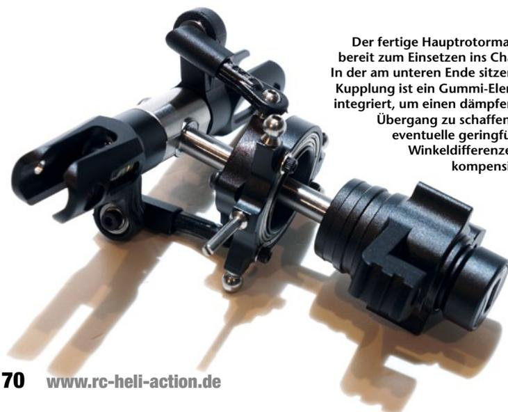
Der fertige Hauptrotormast ist bereit zum Einsetzen ins Chassis. In der am unteren Ende sitzenden Kupplung ist ein Gummi-Element integriert, um einen dämpfenden Übergang zu schaffen und eventuelle geringfügige Winkeldifferenzen zu kompensieren
