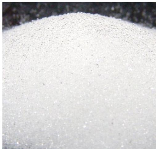
Kein CA-Booster, sondern zum Vergleich die Partikel eines konventionellen CA-Fillers. Die Nahaufnahme verdeutlicht, dass es sich um kleinste Kugeln handelt – alle gleichgroß. Das ergibt mit CA-Kleber eine wenig stabile Struktur, die zwar glashart wird, aber auch schnell bricht
