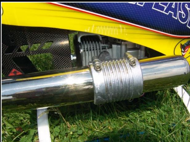
Bei einem Benzinmotor spielt auch die Schalldämpferanlage eine große Rolle bei der Leistungsentfaltung. Hier die von Miniature Aircraft empfohlene Edelstahl-Schalldämpfer-Einheit, die direkt am Auslassstutzen montiert ist
