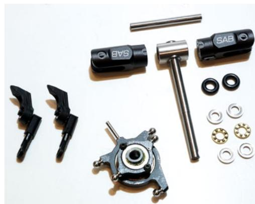
Baugruppe Hauptrotor. Das Rotorkopf-Zentralstück ist fest mit der Welle verbunden. Die Blatthalter besitzen Radial- und Axiallager. Links die DFC-Blattverstellhebel nebst Gestängen
