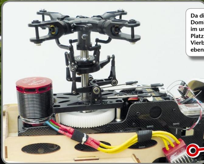
Da die komplette Mechanik im Dombereich verstaut ist, gibt es im unteren Bereich ausreichend Platz für den Scale-Ausbau. Der Vierblatt-Hauptrotor gehört ebenfalls zum Lieferumfang
