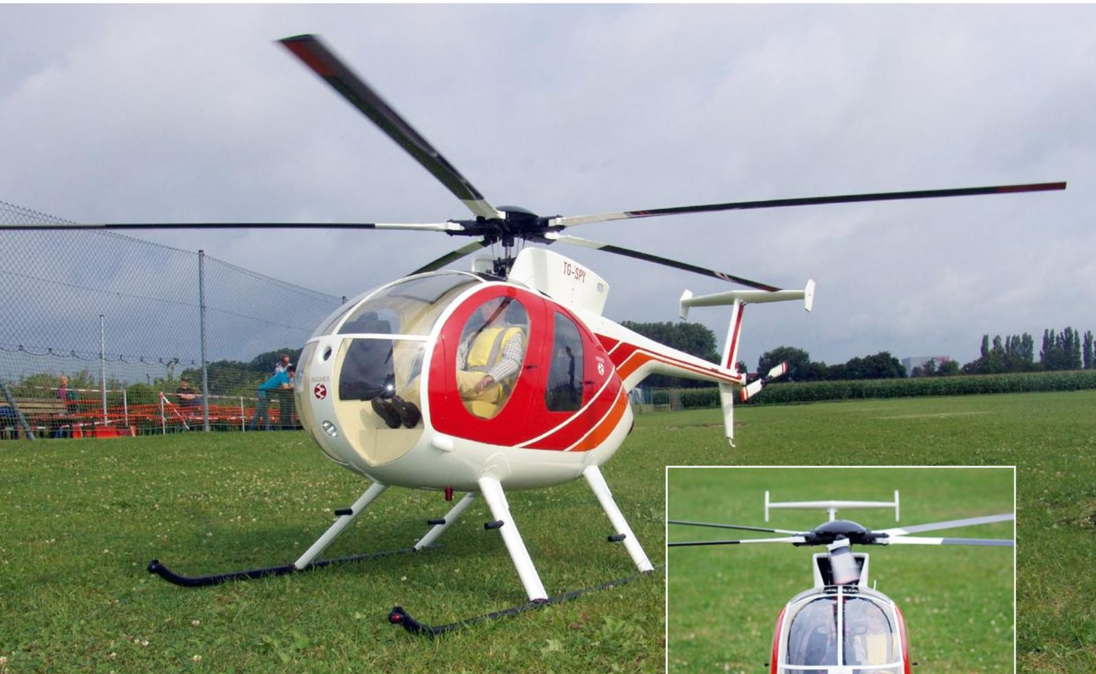
Der Faserverbund-Spezialist aus Senden bietet mit der brandneuen Hughes 500 D ein Scale-Modell der Extraklasse an, das im Maßstab 1:4 gefertigt ist. Das Vorstellungsmuster ist mit einer PHT3-Turbinenmechanik von JetCat und einem Fünfblatt-Hauptrotorsystem ausgerüstet.
