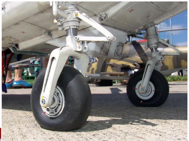
Besser, robuster und detaillierter kann man das kaum bauen: Die beiden vorderen Ganzmetall-Fahrwerks-Mechaniken wurden gemäß dem bemannten Vorbild nachgebildet und sind selbstverständlich auch mit funktionstüchtiger Federung ausgestattet
