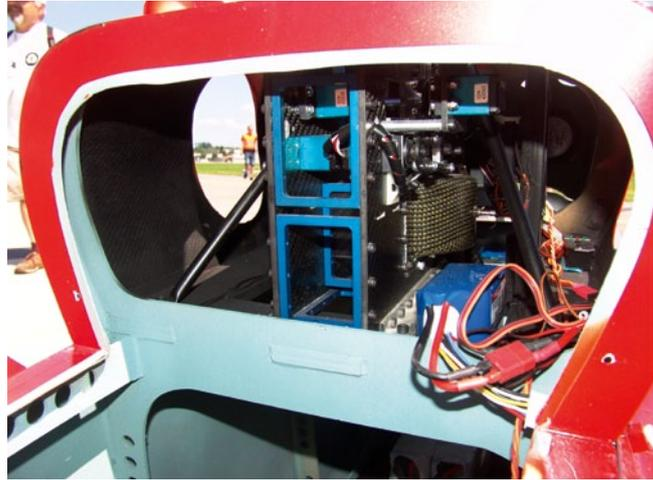
In der Mechanik werkelt statt einer normalerweise vorgesehenen Turbine ein Kontronik-Außenläufermotor Pyro 850
