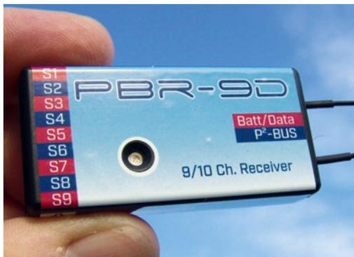
Hier der Zehnkanal-Empfänger PBR-9D mit zwei redundanten Empfangsteilen, der beispielsweise 119,- Euro kosten soll
