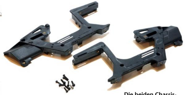
Die beiden Chassis-Seitenteile sind aus glasfaserverstärktem Kunststoff. Integrierte Gewinde-Inserts aus Messing vereinfachen die Montage
