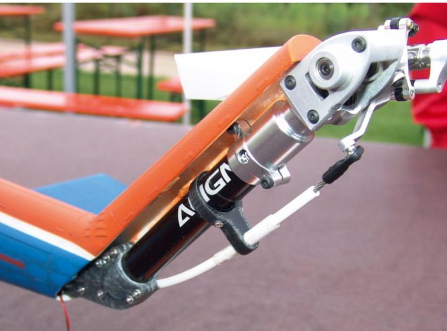
Die leicht abnehmbare Verschlusskappe ermöglicht den Blick auf das Heckrohr und die Bowdenzug-Anlenkung
