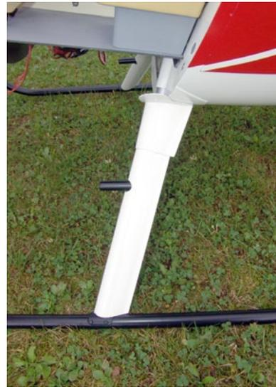
Die in den Rumpf tauchenden Kufenbeine bestehen aus Aluminium, sind aber entsprechend verkleidet. Die Kufenrohre sind aus CFK laminiert
