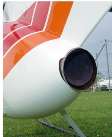
Das Abgasrohr ist so ausgeführt, dass der Abgasstrahl zum Heckrotorschutz nach unten gelenkt und dem Restschub entgegen gewirkt wird
