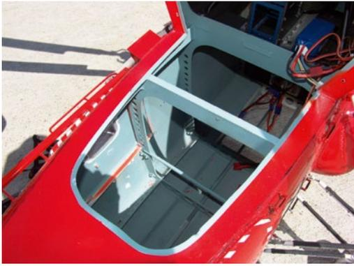
Der hintere Dom-Deckel kann mit wenigen Handgriffen abgenommen werden und ermöglicht bequemen Zugang zu den Rumpfeinbauten. Die Öffnung ist so groß, dass man ...
