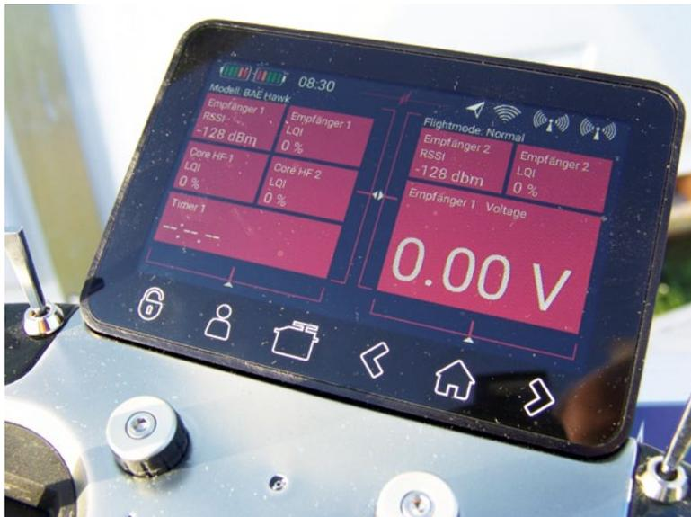
Mit zu den Highlights des CORE zählt das kapazitive Touchdisplay, das frontseitig angeordnet und gut bedien- und einsehbar ist. Es ist selbst bei voller Sonneneinstrahlung bestens lesbar, wovon wir uns vor Ort überzeugen konnte
