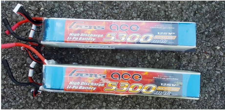
Bei den 12s-LiPo-Akkus setzt der Autor in beiden Modellen GensAce mit einer Kapazität von 5.300 Milliamperestunden ein. Ein Pack wiegt 1.670 Gramm
