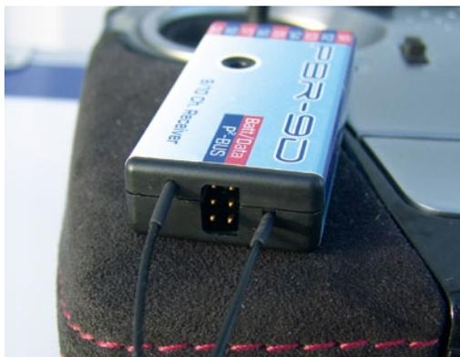
Über 250 Sensoren mit je 32 Datenwerten können an den P<sup>2</sup>-BUS angeschlossen werden
