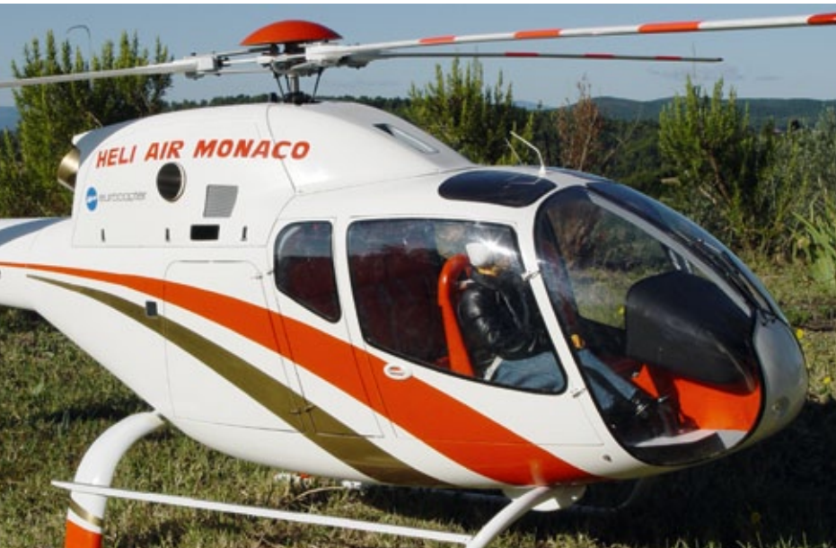
Die Domhaube ist mehrteilig und lässt sich komplett demontieren. Hier ist auch der rechte Turbinenauslass zu erkennen
