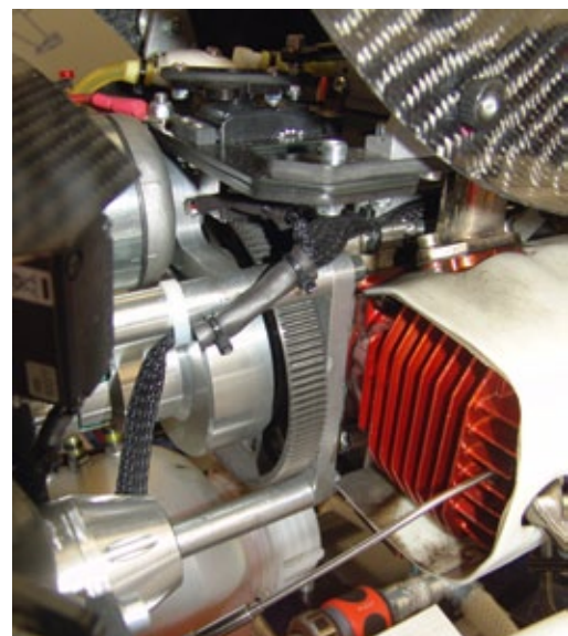
Blick auf einen der beiden Zylinder des Boxermotors, der im Gebläseschacht mit Kühlluft beaufschlagt wird
