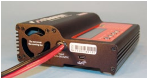
Hier der temperaturgeregelte Lüfter, das Anschlusskabel und die USB-Buchse zum Datenaustausch und Firmware-Update
