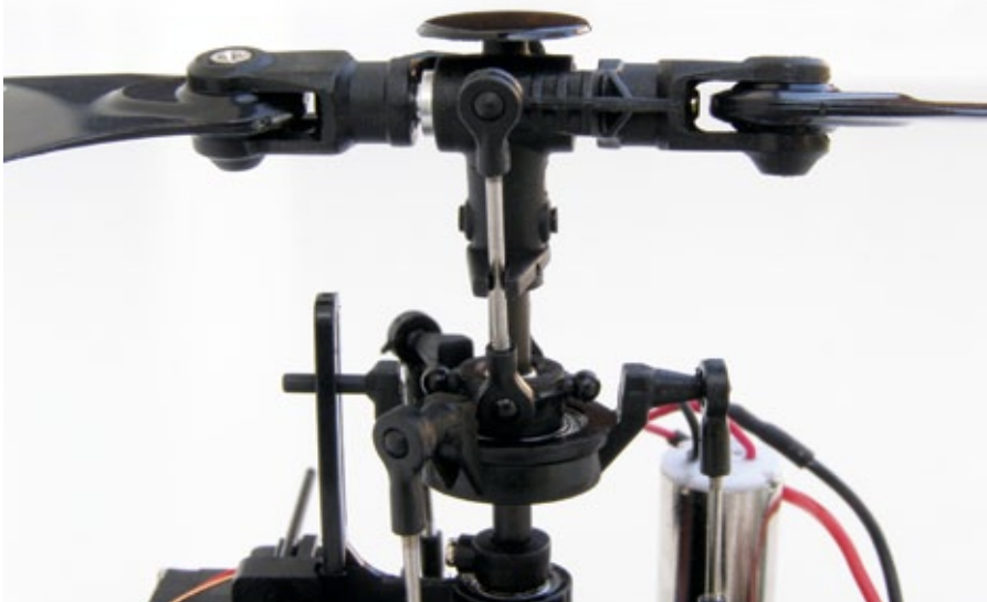
Der rechtsdrehende Mini-Rigid-Zweiblattrotor mit durchgehender Blattlagerwelle und Pitchsteuerung. Der Taumelscheiben-Mitnehmer sitzt unter dem Kunststoff-Zentralstück
