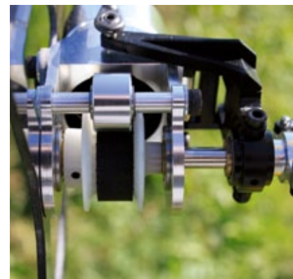
Die Andruckrolle sorgt für gute Riemenföhrung und verhindert ein Überspringen. Das Heckgestänge läuft oberhalb des Heckrohrs
