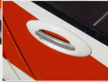
Die im Text erwähnten Türgriffe inklusive Griffmulden – alles Marke Eigenbau und natürlich funktionstüchtig ausgeführt
