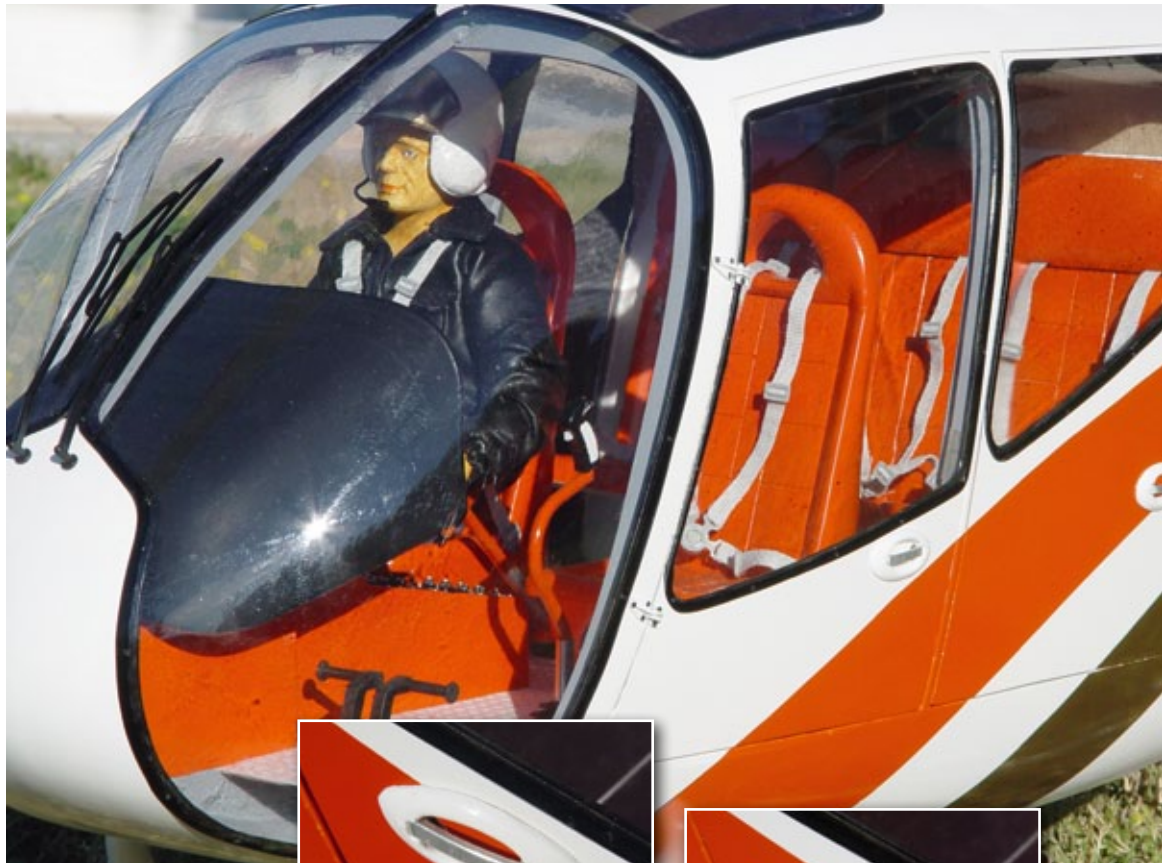
Die im Text erwähnten Türgriffe inklusive Griffmulden – alles Marke Eigenbau und natürlich funktionstüchtig ausgeführt
