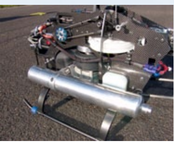
Der großvolumige Schalldämpfer sorgt für eine angenehme Geräuschkulisse und gute Leistungsentfaltung des Zenoah-Motors
