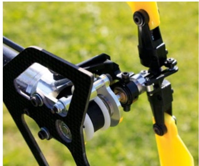
Der Heckrotorantrieb und die Anlenkung zeigen sich äußerst spielfrei. Leider waren die mitgelieferten Heckrotorblätter aus der Erstserie mit dem Drehmoment des Motors etwas überfordert
