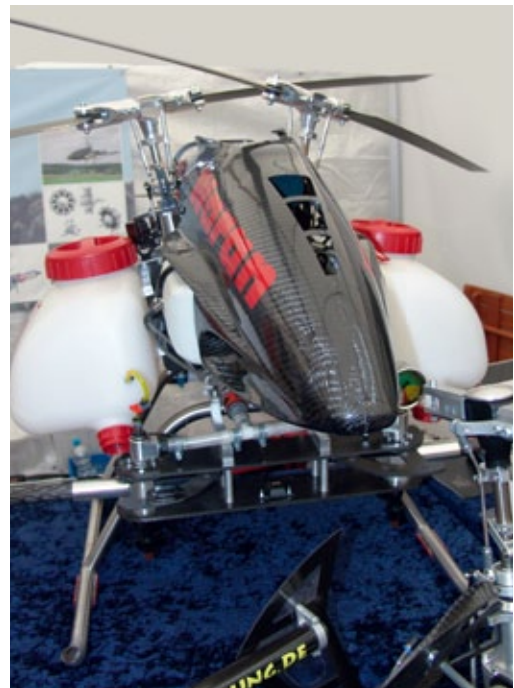
Die Frontansicht verdeutlicht die Anordnung der beiden ineinanderkämmanden, gegenläufigen Hauptrotoren. Außen sitzen die beiden Tanks zur Aufnahme des Sprühmittels
