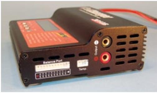
Auf der rechten Gehäusesseite befinden sich die Anschlüsse des 11-poligen Balancers, des Temperatursensors und Ladekabels
