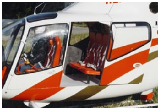
Auf der linken Seite befindet sich hinten eine Schiebetür, die den Zugang zur hinteren Stuhlreihe freigibt
