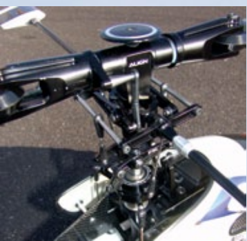
Der serienmäßige Hauptrotorkopf des T-Rex 700 wird beim Benziner unverändert übernommen – hier sind keine Änderungen notwendig. Die Abbildung zeigt den T-Rex 700 von Marc Schimmels
