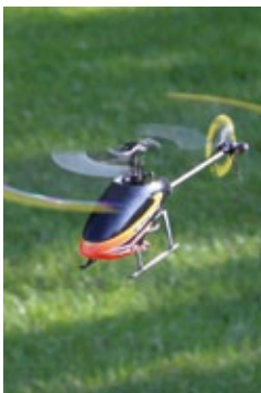
Der rechtsdrehende Mini-Rigid-Zweiblattrotor mit durchgehender Blattlagerwelle und Pitchsteuerung. Der Taumelscheiben-Mitnehmer sitzt unter dem Kunststoff-Zentralstück
