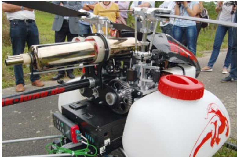
Blick auf die robusten Getriebezahnräder und die beiden Edelstahl-Schalldämpfer des Waran-Flettner-Helis. Der Boxermotor ist frontseitig angeordnet
