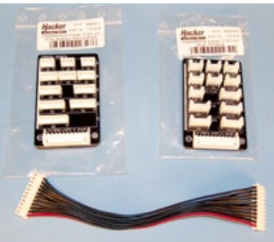
Der iCharger 3010B benötigt zum Anschluss seines Balancers Adapterplatinen, die separat zugekauft werden müssen (links im Bild Kokam, rechts Topfuel)
