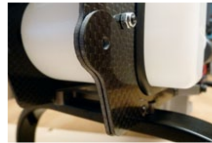
Aufwertung beim Benziner – Aufdoppelung der CFK-Chassisteile im Bereich der Verschraubung der Heckrohr-Abstrebung
