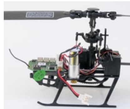
Aus weniger Bauteilen kann man kaum einen so kleinen Pitchheli herstellen. Ganz vorn die Bordelektronik mit integriertem Flybarless-System, Empfänger und Controller
