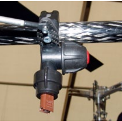
Eine der vielen, hocheffizienten Sprühköpfe, die an den CFK-Auslegerarmen montiert sind
