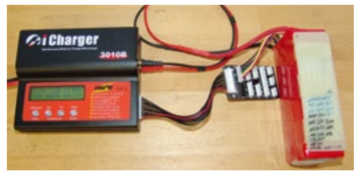
Laden eines 6s-LiPos mit Kokam-Balancer-Adapterplatte. Das hintergrundbeleuchtete Display ist gut ablesbar. Mit vier doppelt belegten Bedientasten navigiert man durch alle Menüpunkte
