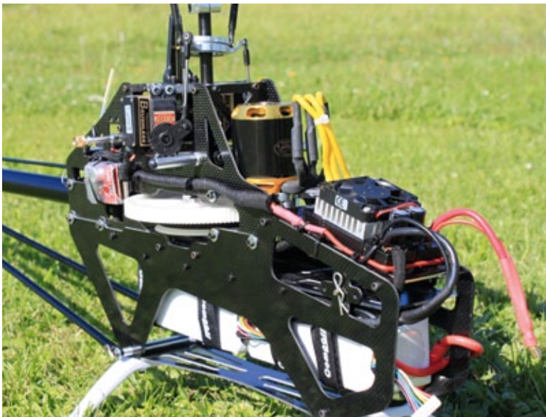
Kabelsalat ist Fehlanzeige. Allen Komponenten können bequem und übersichtlich im Chassis untergebracht werden. Hier ist auch deutlich die Anordnung des LiPo-Akkus zu erkennen mit der beschriebenen Bolzensicherung
