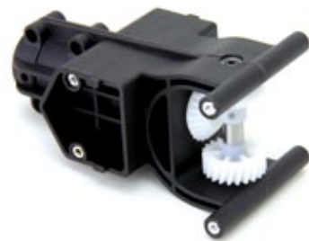
Die Heckrohr-Aufnahme mit dem integrierten Kegelradgetriebe des Heckantriebs
