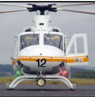
Die Vario Bell 412 von Menard Yann aus Frankreich: JetCat PHT3-3, 2.400 Millimeter Rotordurchmesser, 21 Kilogramm Abfluggewicht – kein Flybarless-System
