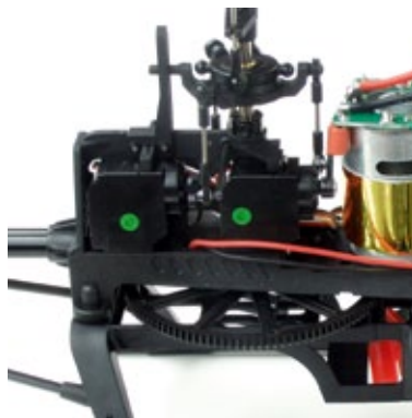
Die drei Taumelscheiben-Servos sind stehend im Seitenteil montiert
