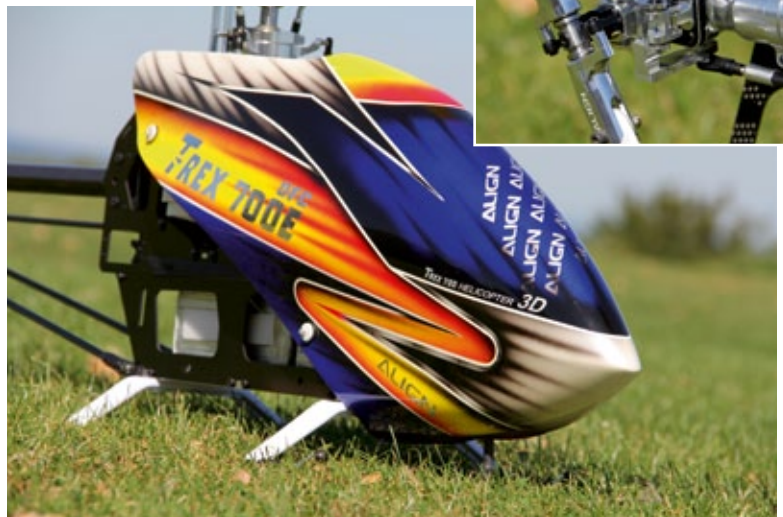
Die fertig lackierte Kabinenhaube wird an vier Punkten sicher mit dem Chassis befestigt
