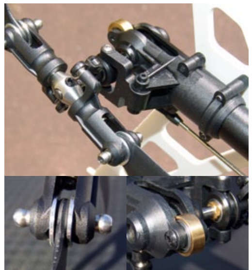
Spielarm und hohe Performance – der Heckrotor des Blade 500 3D. Ganz hinten sitzt über dem Zahnriemen ein mit Messingring versehenes Kugellager. Propeller-Momentgewichte an den Blatthaltern reduzieren die aufzubringenden Steuerkräfte
