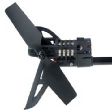
Der Heckrotor verfügt über einen längs angeordneten Bürstenmotor, der über ein Getriebe den feststehenden Propeller antreibt
