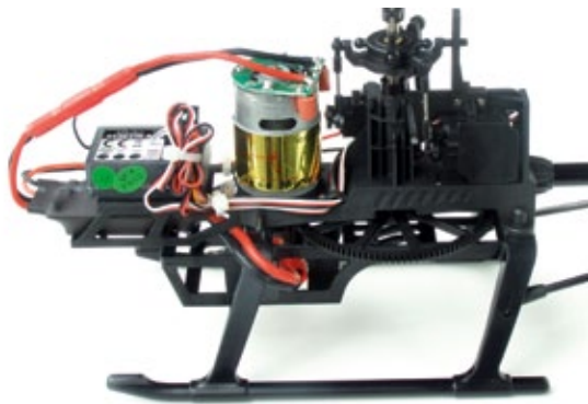
Der Master CP ist komplett aus Kunststoff aufgebaut und verfügt über einen Bürstenmotor und ein Flybarless-System
