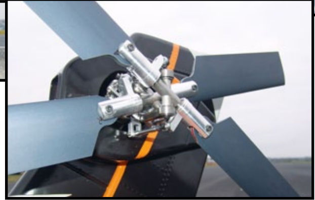
Der Nachbau der Apache AH-64 D Longbow von Alterbaum-Premium-Helicopter. Das Modell ist im Maßstab 1:5,8 nachgebaut und hat einen Rotordurchmesser von 2.500 Millimeter. Markant ist der Zwillings-Heckrotor mit seinen zwei Naben
