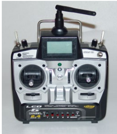
Der dem Set beiliegende Sechskanal-Carson-Sender. Auf der Stirnseite befinden sich die beiden Pitch-Drehregler sowie Schalter
