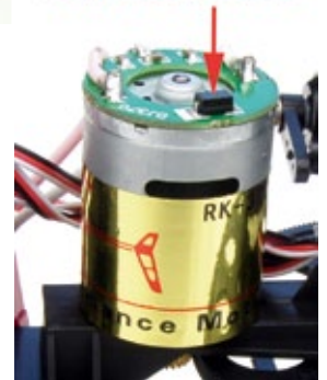
Motoren mit Supressor-Diode dürfen nicht einfach umgepolt werden (Erklärung siehe Text)
