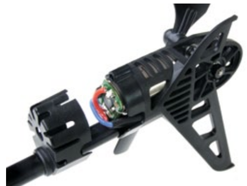
Alles liegt gut geschützt hinter entsprechenden Kunststoff-Verkleidungen. Der Heckmotor kann ohne Lötarbeiten getauscht werden
