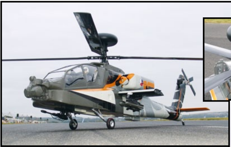
Der Nachbau der Apache AH-64 D Longbow von Alterbaum-Premium-Helicopter. Das Modell ist im Maßstab 1:5,8 nachgebaut und hat einen Rotordurchmesser von 2.500 Millimeter. Markant ist der Zwillings-Heckrotor mit seinen zwei Naben
