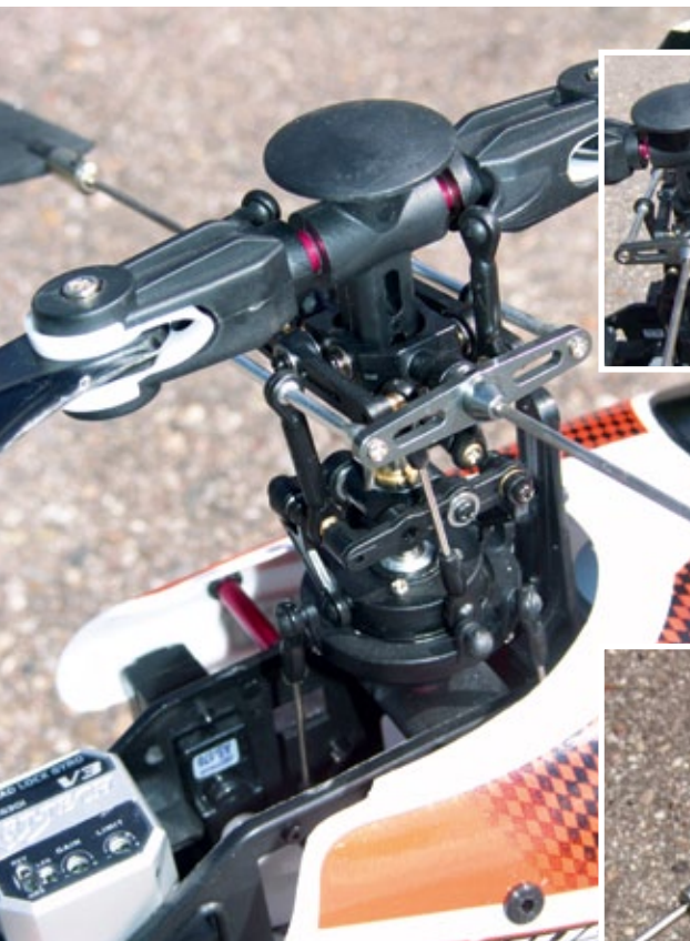
Das rechtsdrehende Hauptrotorsystem mit konventioneller Stabilisierungs-Stange und -Paddeln besteht hauptsächlich aus Kunststoff. Die serienmäßigen Einstellungen führen zu gutmütigen Flugeigenschaften
