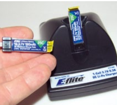
Der 1s-LiPo wird in eine entsprechende Halterung am Kufergestell platziert. Geladen wird er mit 300 Milliamperestunden über ein batteriebetriebenes Ladegerät
