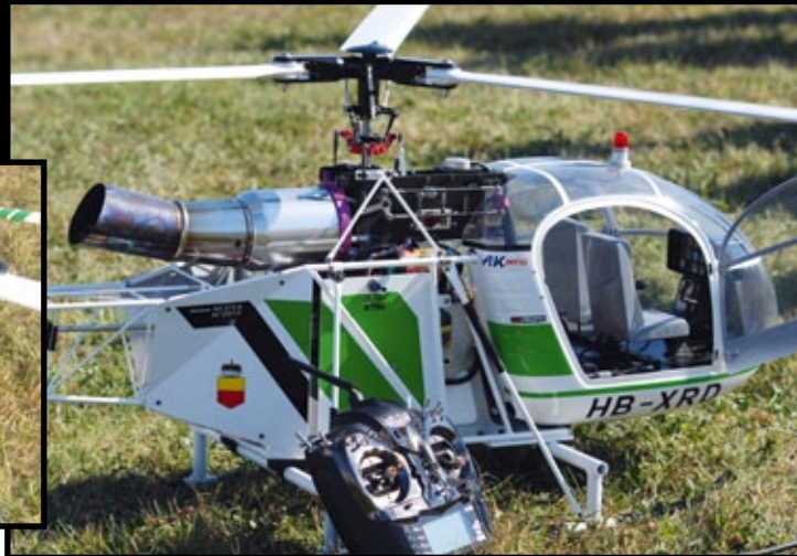
Die VARIO Lama von Andy Kessler (Firma AKmod), ausgestattet mit JetCat PHT2, K&S-Dreiblattrotor und Flybarless-System JR Tags 01
