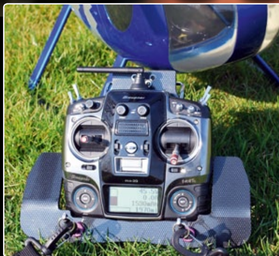
Das Vario-Senderpult der mx-22 wurde von Thomas Rühl in der Höhe entsprechend modifiziert, um den Abmessungen des mx-20-Senders gerecht zu werden
