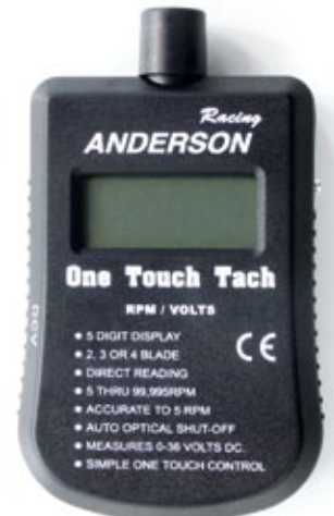
Ein Drehzahlmesser kann oft hilfreich sein. Hier ist jedoch stets äußerste Vorsicht bei der Messung geboten, speziell an größeren Helis. Immer auf genügend Abstand zu rotierenden Teilen achten
