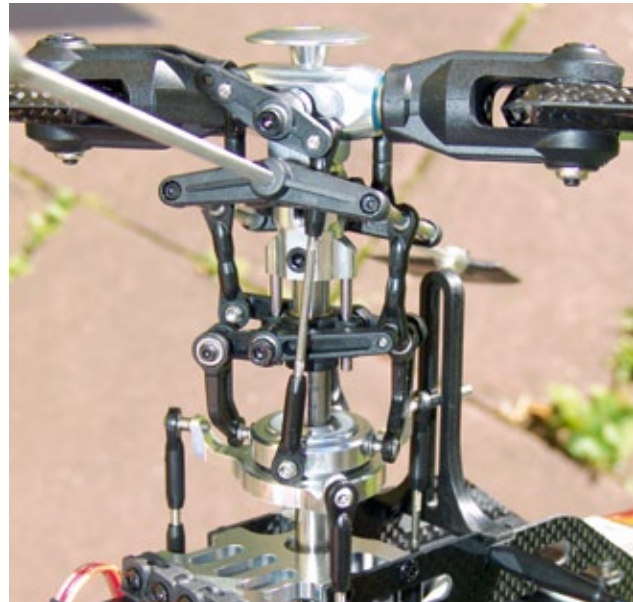
Der Zweiblatt-Hauptrotor mit Scheren-Pitchkompensator und Alu-Taumelscheibe. Die Tariergewichte an der Stabstange (Bild oben) können verschoben werden
