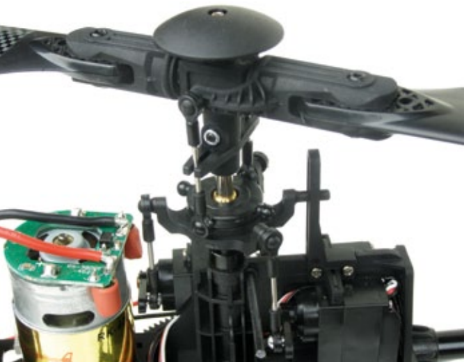
Extrem einfach aufgebaut ist der Zweiblatt-Hauptrotor mit seinen Gestängeführungen und der Kunststoff-Taumelscheibe
