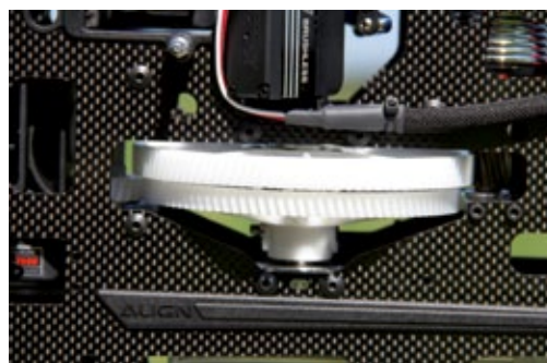
Beim T-Rex 700 DFC ist nicht nur der Hauptrotorantrieb schrägverzahnt, sondern auch der Heckantrieb des darunter liegenden Zahnrad
