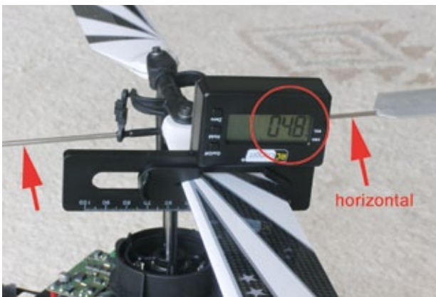
Bei der Messung mit einer digitalen Pitchlehre müssen die Paddelstange und der ganze Heli horizontal stehen
