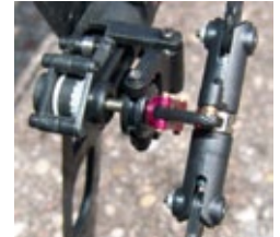
Der Heckrotor mit seiner doppelt ausgeführten Schiebehülsen-Anlenkung. Der Zahnriemen wird sogar mit einem Zusatz-Kugellager an einem eventuellen Überspringen gehindert
