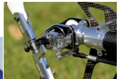
Detail der kugelgelagerten Heckrotor-Scherenanlenkung
