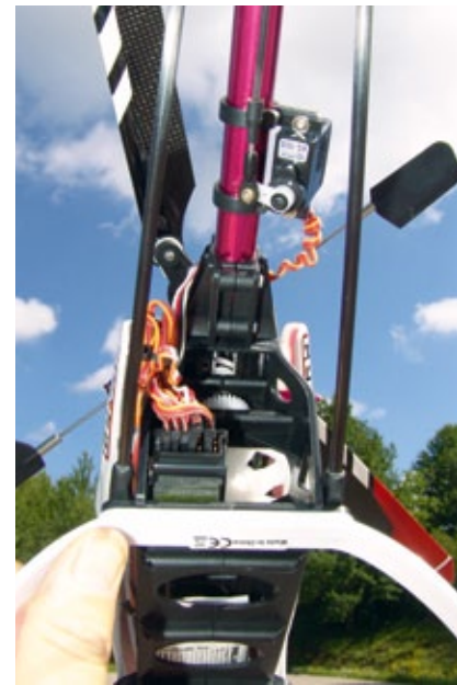
Blick auf den Carson-Sechskanal-Empfänger und das am Alu-Heckrohr befestigte Heckservo. Wer genau hinschaut, erkennt auch zwischen den Chassisteilen den Heckantrieb
