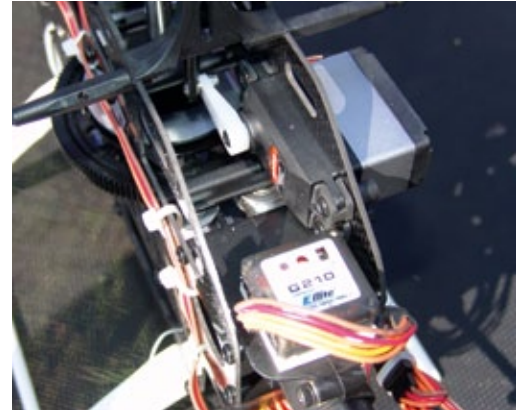
Das liegende Nickservo und das Heckrotor-Gyro-System. Klasse gemacht auch die Zugentlastung der Anschlusskabel
