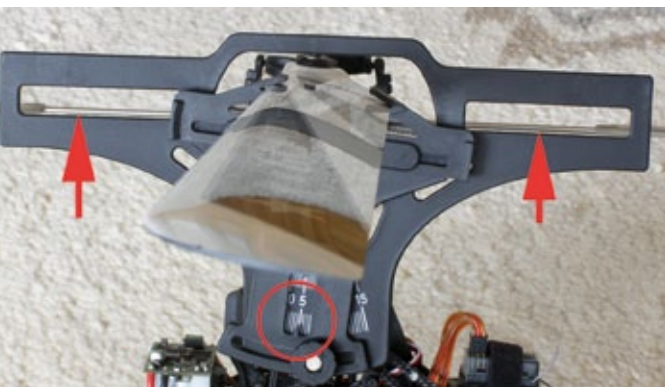
Einfacher geht es kaum: Paddelstange ausrichten und ablesen. Diese Methode funktioniert aber nicht bei Flybarless-Systemen
