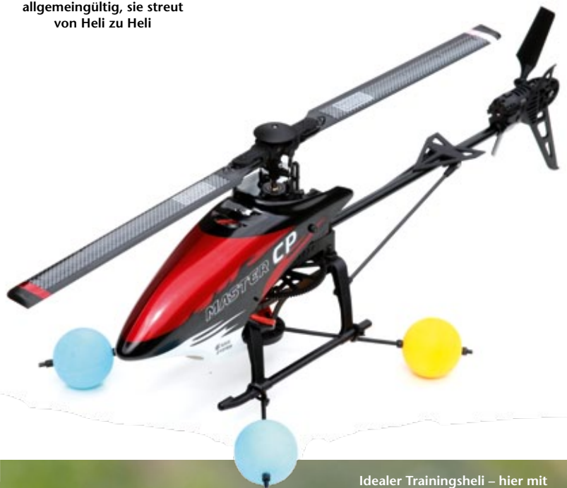
Idealer Trainingsheli – hier mit verbreitertem Landegestell, auf das Einsteiger keinesfalls verzichten sollten – auch zur verbesserten Lageerkennung
