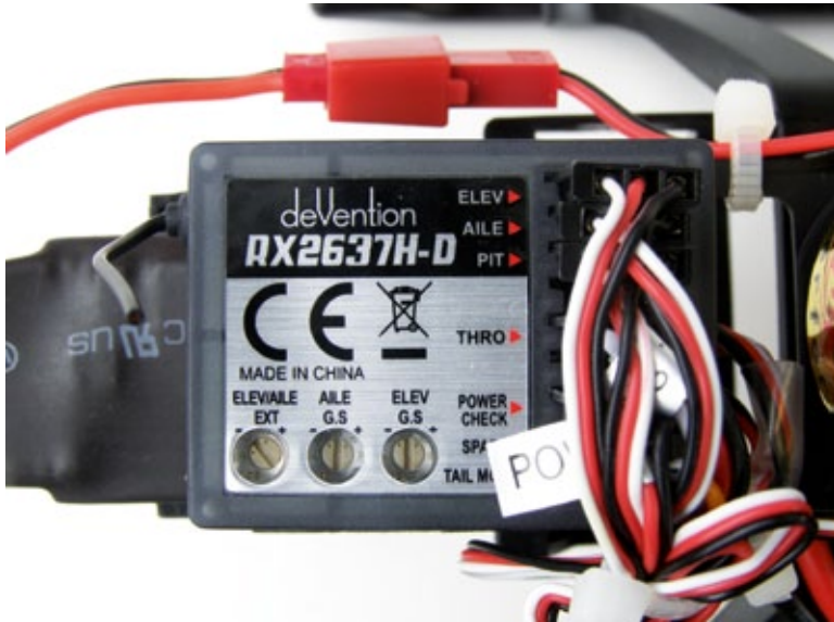
Die Flybarless/Empfänger-Einheit 2637H-D. Die im Bild gezeigte Stellung der drei Regler ist nicht allgemeingültig, sie streut von Heli zu Heli
