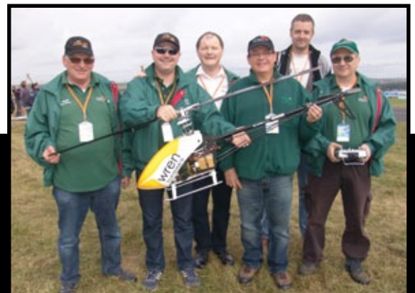
Das WREN-Team führte ihren mit WREN 44-Zweiwellenturbine ausgestatteten T-Rex 700 vor: Rotordurchmesser 1.600 Millimeter, Abfluggewicht 6 Kilogramm
