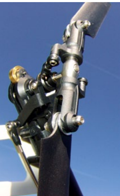
Die Rotorblätter müssen mit den beiliegenden Distanzscheiben montiert werden
