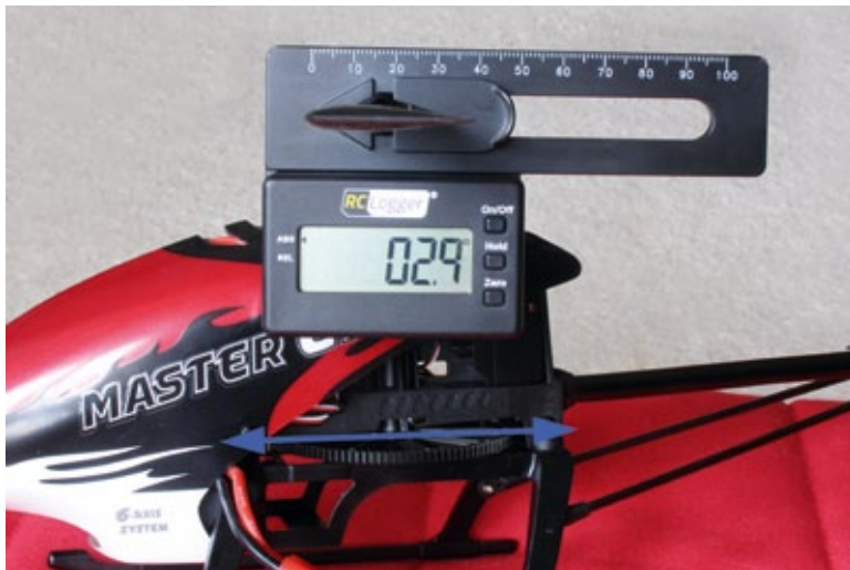
Bezugsebene für das Einstellen des Pitchwinkels ist die Zahnradoberfläche (blauer Pfeil) oder bei senkrecht stehender Rotorwelle der Boden
