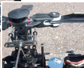
Das rechtsdrehende Hauptrotorsystem mit konventioneller Stabilisierungs-Stange und -Paddeln besteht hauptsächlich aus Kunststoff. Die serienmäßigen Einstellungen führen zu gutmütigen Flugeigenschaften
