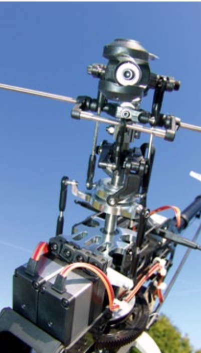
Der Zweiblatt-Hauptrotor mit Scheren-Pitchkompensator und Alu-Taumelscheibe. Die Tariergewichte an der Stabstange (Bild oben) können verschoben werden
