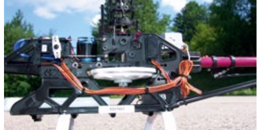
Basis der Konstruktion ist ein stabiles, zweiteiliges Kunststoff-Chassis. Der Heckantrieb erfolgt über ein sogenanntes Split-Gear in Verbindung mit einem Zahnriemen
