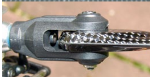
Die Rotorblätter müssen mit den beiliegenden Distanzscheiben montiert werden
