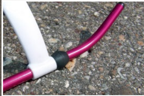
Die stabile Kabinenhaube wird im unteren Bereich geführt. Um ein Verdrehen der Kufenrohre zu verhindern, empfiehlt sich das Verkleben mit den Bügeln (Sekundenkleber)
