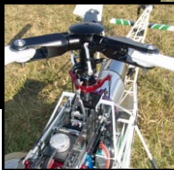
Die VARIO Lama von Andy Kessler (Firma AKmod), ausgestattet mit JetCat PHT2, K&S-Dreiblattrotor und Flybarless-System JR Tags 01
