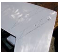
Für das Aufbringen der Nieten wurden zur Orientierung mit dem Bleistift Striche gezogen
