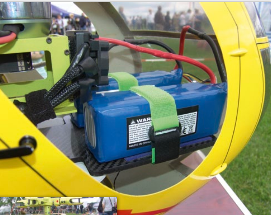
Die beiden in Serie geschalteten 5s-LiPos mit 5.800 mAh sind schwerpunktünstig im Vorbau der Hughes auf einer CFK-Platte verstaub. Durch die große abnehmbare Fronthaube ist ein Akkuwechsel bequem durchführbar
