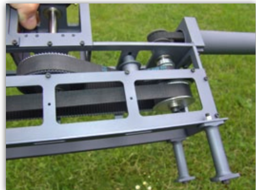
Direkt aus der ersten Zahnriemenstufe wird der Heckrotor angetrieben
