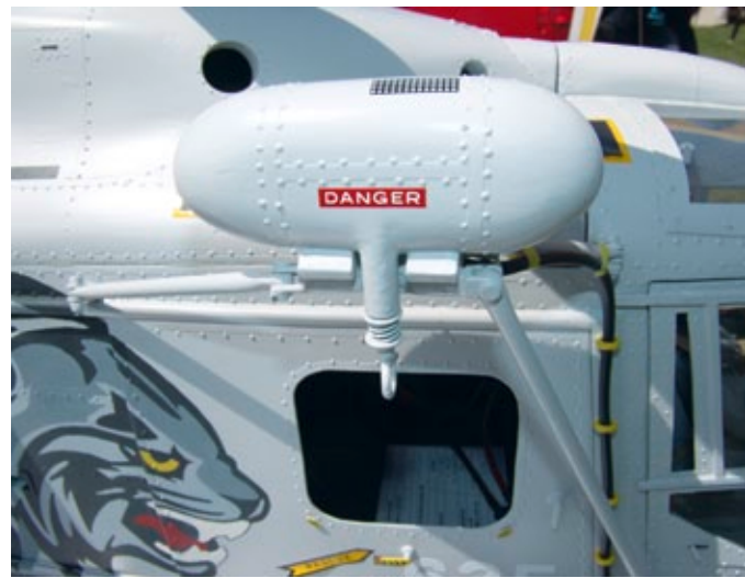
Linke Rumpfmite mit der abgestützten Seilwinde. Die vielen Nieten-Imitationen auf der Oberfläche des Rumpfs bestehen aus Weißleim
