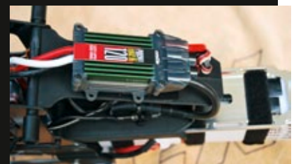
Der Castle Creation Phoenix Edge HE 120 wurde im Vorbau des T-Rex eingebaut
