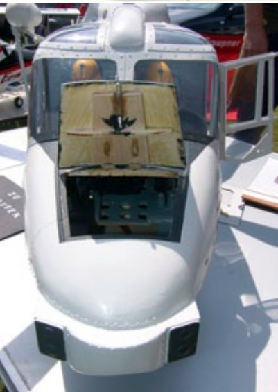
Die Wartungsklappe ist voll funktionstüchtig ausgeführt. In geöffnetem Zustand wird der Aufbau mit Verstärkungsgurt deutlich
