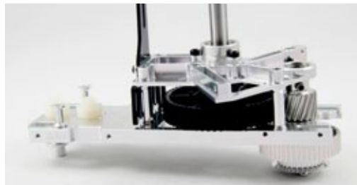
Der fertig aufgebaute Getriebelock ist extrem stabil. Dieser wird komplett ins Chassis als Einheit verschraubt
