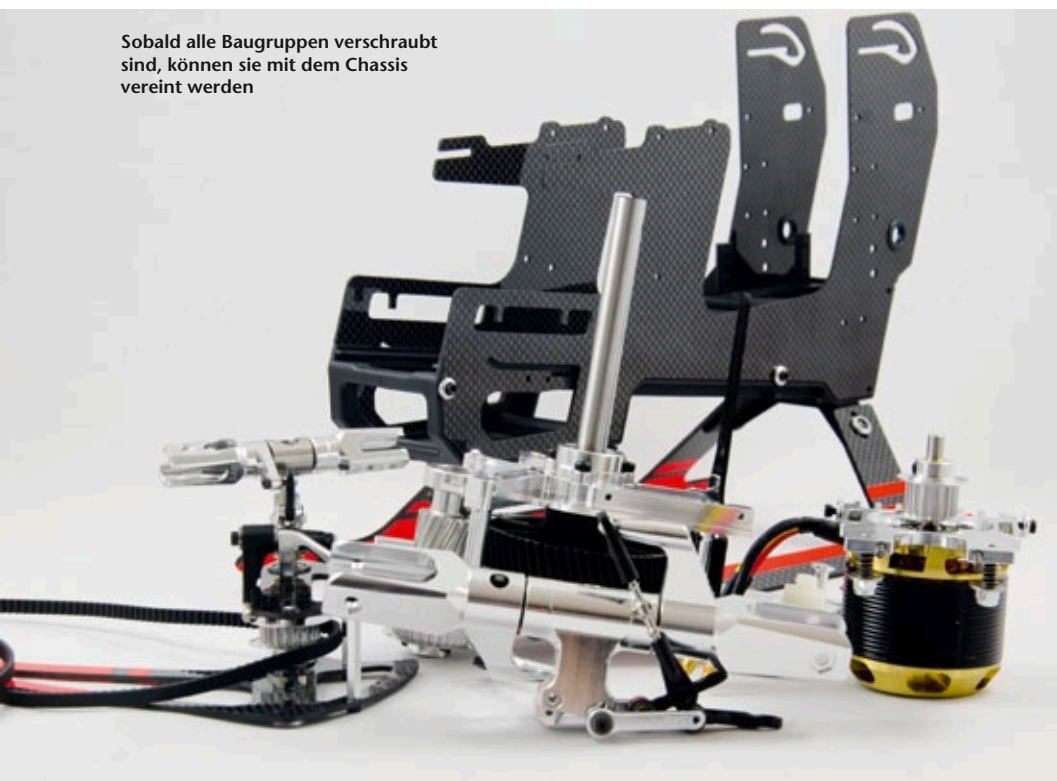
Blick auf die Motorbefestigung und sauber geordnete Kabelführung zum Controller
