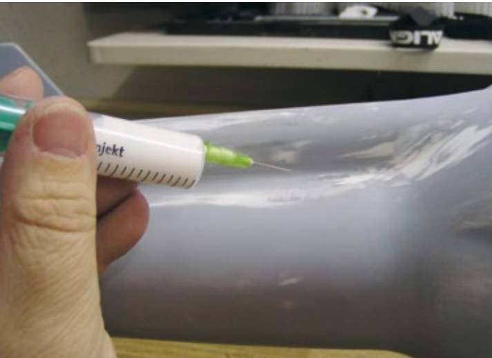
Mit einer mit Weißleim gefüllten Einwegspritze und einer gekürzten Kanüle werden die Nieten getupft
