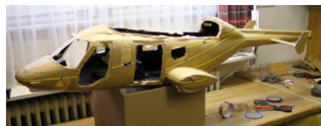
Eine der vielen Szenen der aufwendigen Finish-Arbeiten. Der bereits gelb und schwarz lackierte Rumpf wird für das Aufbringen von Rot abgeklebt
