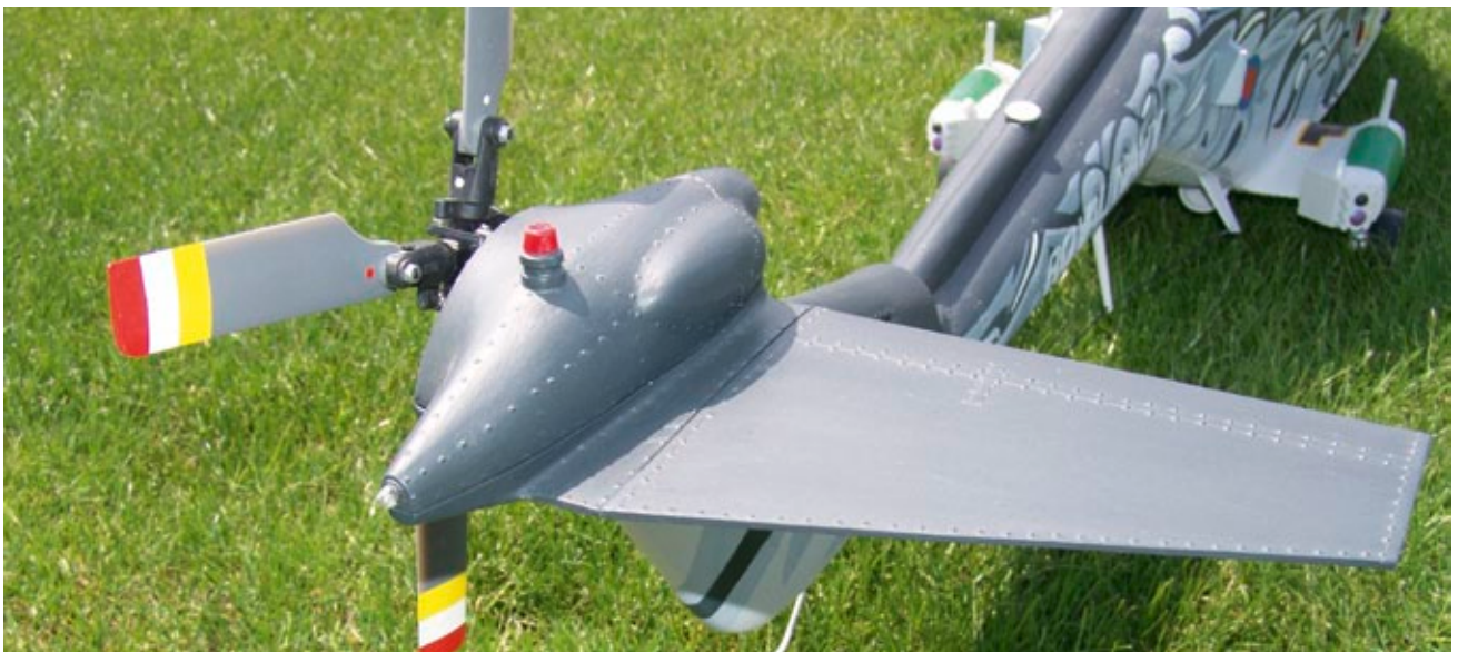
Die sehr schön profilierte Heckpartie der Super Lynx lässt kaum vermuten, dass hier auch alles aus Balsaholz gefertigt wurde. Die Höhenleitwerkshälfte ist für den problemloseren Transport demontierbar konstruiert
