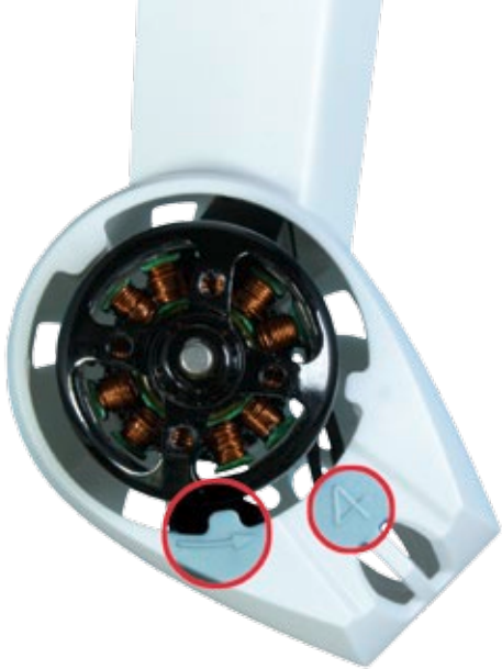
Motornummer und Drehrichtung sind markiert. Zwei Motoren hatten leichtes Lagerspiel
