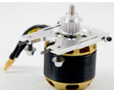
Motorhalterung mit dem Scorpion HK-4020. Markant sind die am Träger befindlichen Federn zur korrekten Vorspannung des Riemens
