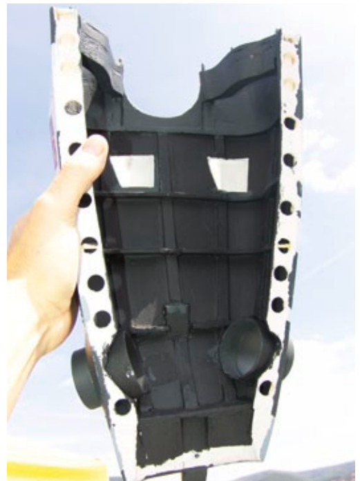
Die Innenseite der abnehmbaren Dom-Abdeckhaube verdeutlicht die in aufwendiger Spantenbauweise erstellte Konstruktion mit Balsabeplankung
