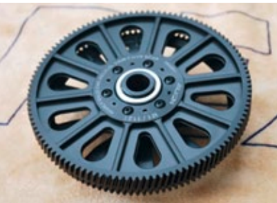
Das gefräste Hauptzahnrad ist schrägverzahnt, mit Freilauf ausgerüstet und aus Kunststoff gefräst
