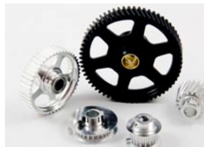
Alle für den Goblin 500 notwendigen Zahnräder und Riemenräder. In der ersten Getriebestufe wird ein Zahnriemen verwendet, in der zweiten schrägverzahnnte Zahnräder
