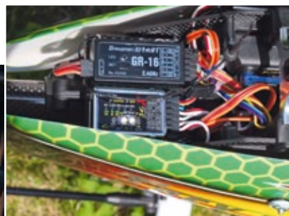
Das Align-Flybarless-System 3GX mit dem Graupner/SJ HoTT GR-16 auf der Plattform
