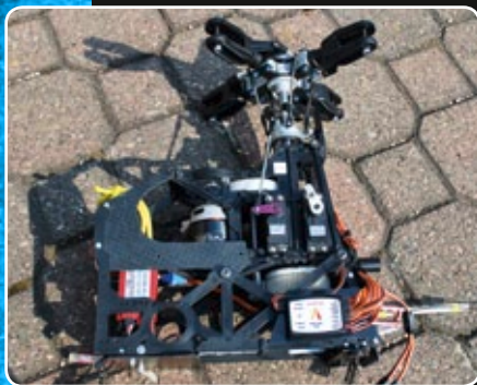
Die auf Elektroantrieb umgerüstete Graupner UNI 2000-Mechanik von Thomas Rühl
