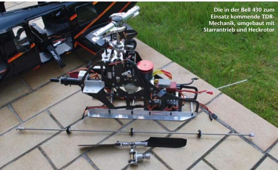
Deutlich zu erkennen sind die befestigten Aluwinkel, sodass sich die Mechanik im Rumpf nicht verwinden kann. Der Heckantrieb erfolgt über Starrwelle und Kardankupplung. Das Heckservo sitzt auf dem Heckrohrstummel
