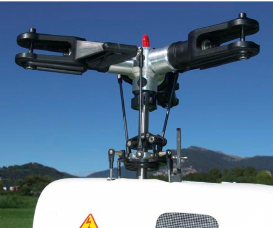
Beispiel eines Dreiblatts mit exakt senkrecht verlaufenden Steuerstangen
