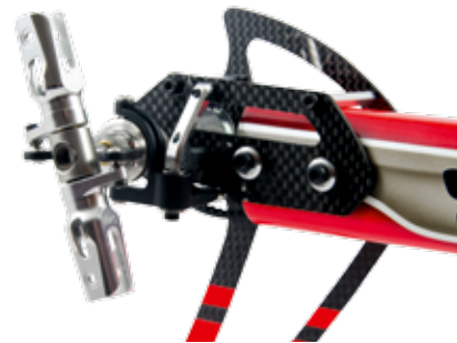
Der Heckrotor wird mit Hilfe von CFK-Spannen am Heckausleger verschraubt
