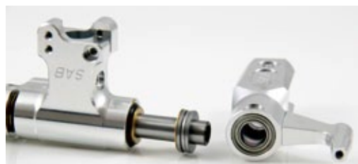
Der Aufbau des Rotorkopfs ist klassisch, das heißt bestehend aus Blattlagerwelle, Dämpfung, zwei Radial- und einem Axiallager
