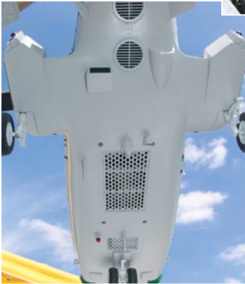
Auf der Unterseite des Rumpfs gibt es viele Öffnungen, die bei der ausreichenden Belüftung der Antriebskomponenten behilflich sind
