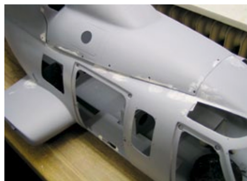
Was im ersten Moment gut aussieht, bedarf noch des Nachspachtelns
