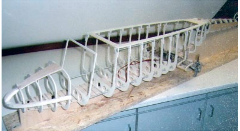
Ein Bild aus dem Rohbaustadium auf der Helling. Deutlich zu erkennen sind die über Aluminium-Rohre und Leisten verbundenen Spanten
