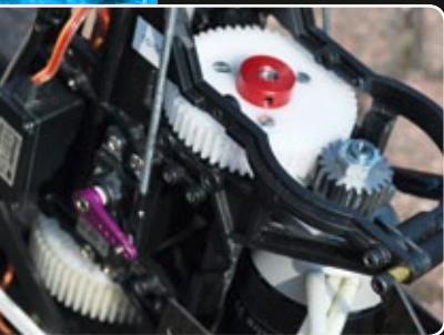
Die erste Getriebestufe mit der selbstgefertigten Motorbefestigung (Lagerleiste) und der geänderten Untersetzung. Die Plättchen zwischen Chassis und Lagerböcken verbreitern das Innenmaß der Mechanik um 4 Millimeter, damit der Motor passt
