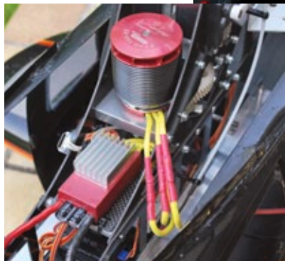
Die eingebaute Mechanik mit eingekuppeltem Heckrotor-Starrantrieb
