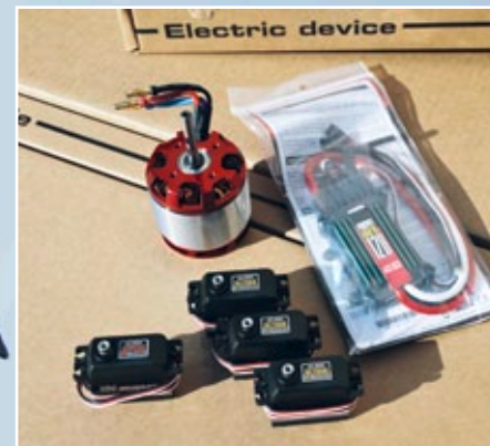
Das zur Kombo gehörende Elektronik-Zubehör des T-Rex 700 ist hochwertig: Motor 800 MX, Castle Creation Phoenix Edge HE 120 und vier Brushless-Servos in Hochvolt-Version
