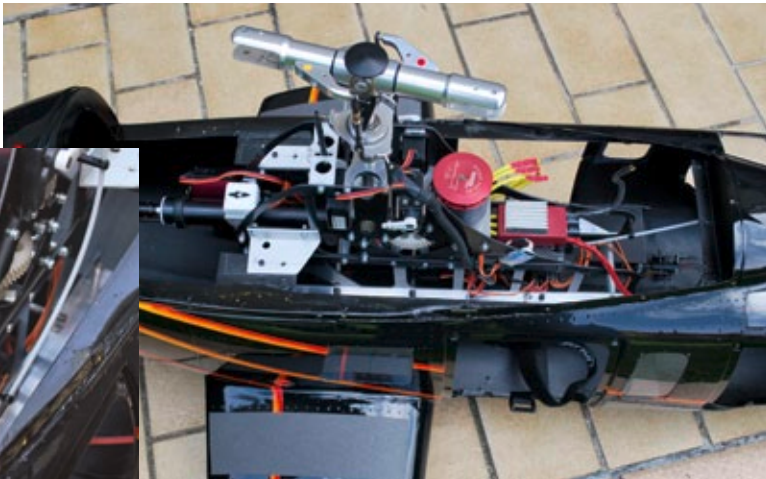
Die eingebaute Mechanik mit eingekuppeltem Heckrotor-Starrantrieb
