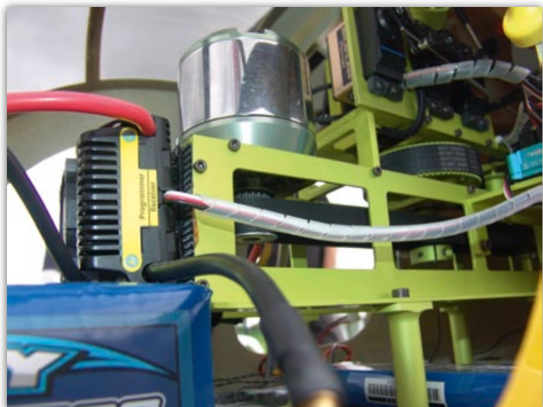
Blick in den Frontbereich der Hughes 500. Der Controller sitzt unmittelbar vor dem Roxxy-BL-Motor
