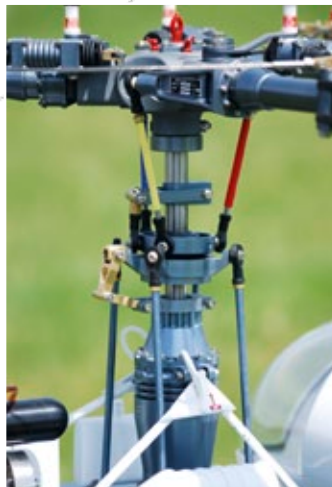
Ein Dreiblatt-Scale-Hauptrotor der Vario-Lama. Auch hier muss der Mitnehmer korrekt ausgerichtet werden. Die Steuerstangen sind hier farblich markiert, um sie bei einer eventuellen Demontage später wieder eindeutig zuordnen zu können
