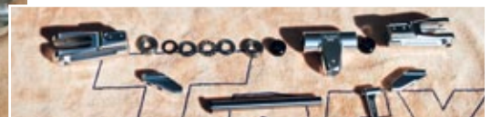
Die Konstruktion ist mit einer 10 Millimeter starken Blattlagerwelle und entsprechend dimensionierten Druck- und Radiallagern versehen
