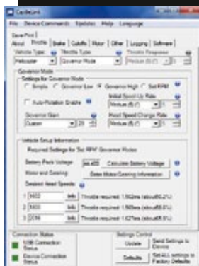
Die Drehzahl und die notwendigen Ausschläge im Sender. Wer diese Werte einstellt, bekommt exakt die angegebene Hauptrotordrehzahl
