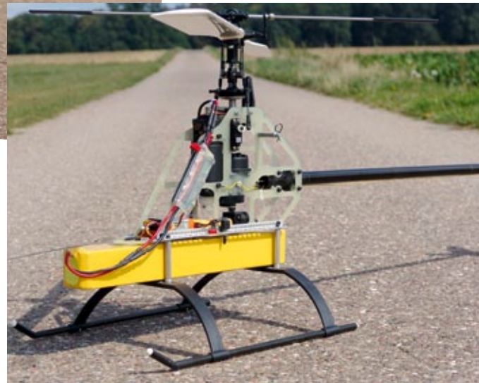
Der selbst entworfene Trainer, der beim Langzeitflug-Rekord verwendet wurde. Die Mechanik-Komponenten waren ein Mix aus Heim-, Vario- und Mikado-Teilen (mehr Details auf nächster Doppelseite)
