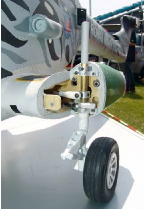
Detailstudie des Hauptfahrwerks, dessen Lager aus Duraluminium gefertigt wurden. Deutlich zu erkennen ist der Verdreh-Mechanismus. Die abnehmbare Balsa-Hutze gestaltet die Wartung sehr einfach
