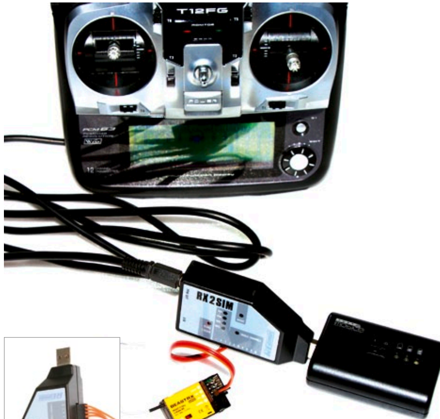
Exemplarischer Anschluss eines Schülersenders (siehe Text)
