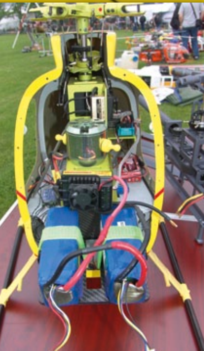
Die beiden in Serie geschalteten 5s-LiPos mit 5.800 mAh sind schwerpunktünstig im Vorbau der Hughes auf einer CFK-Platte verstaub. Durch die große abnehmbare Fronthaube ist ein Akkuwechsel bequem durchführbar
