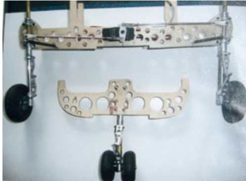
Zum Verdrehen der Räder sitzt ein zentral angeordnetes Servo im Spant des Hauptfahrwerks
