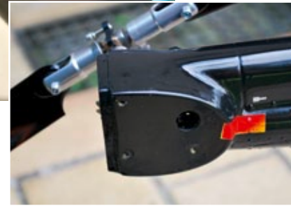
Der TDR-Heckrotor sitzt komplett im Rumpf. Dadurch kann die Abschlussklappe am Seitenleitwerk festgeklebt werden
