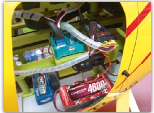
Empfänger und Flybarless-System sind nebeneinander auf einer Konsole befestigt
