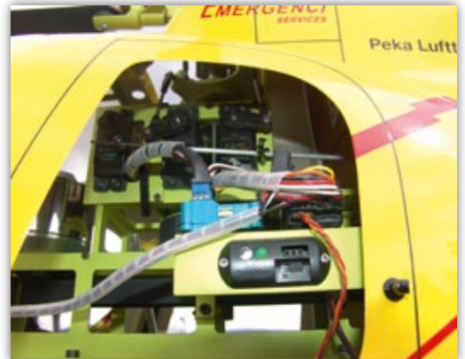
Oben im Bild zwei der vier Taumelscheibenservos. Links daneben sitzt das Heckservo, das über ein Gestänge den Heckrotor anlenkt
