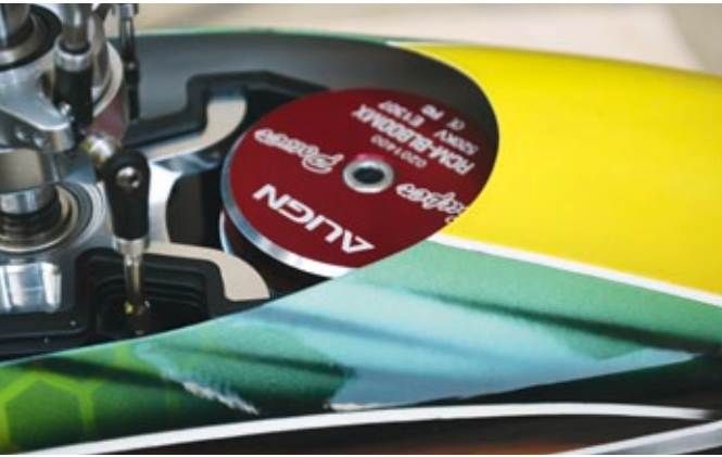
Mit aufgesetzter Haube hat der Motor wenig Platz für seine Kühlluftzirkulation
