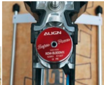
Die Motoreinheit sitzt saugend im Chassis. Sehr formschön schließt das obere Domlager an
