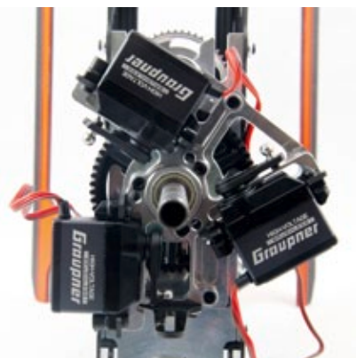
Die Draufsicht verdeutlicht die Anordnung der Taumelscheiben-Servos (120-Anlenkung)
