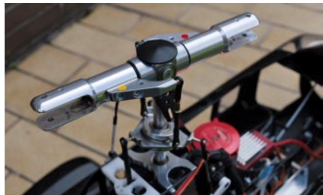
Der ursprünglich verwendete TDR-Rotorkopf, der gegen die nicht pendelbare Ausführung gewechselt wurde
