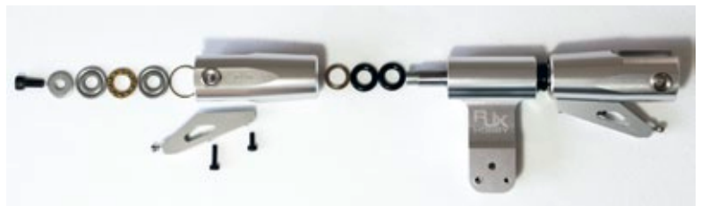
Der Ganzmetall-Zweiblatt-Kopf mit durchgehender Blattlagerwelle und doppelter O-Ring-Dämpfung pro Seite
