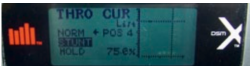
Der Stunt-Modus mit seiner Gasgeraden und genügend Regelpolster (Governor-Modus)
