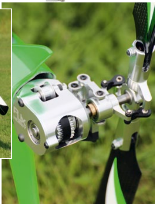
Robust und spielfrei – der Heckrotor des Vector
