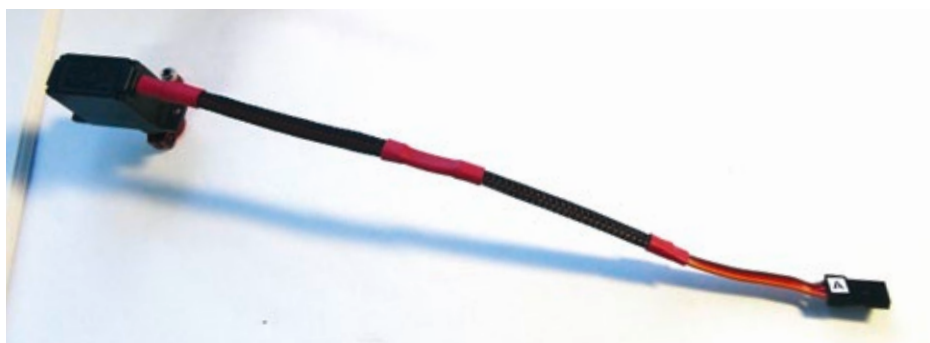
Die Servostecker sind gekennzeichnet, was die spätere Zuordnung enorm vereinfacht. Hier ist bereits ein entsprechender Geflechschlauch aufgezogen, der das Kabel vor Beschädigung schützt
