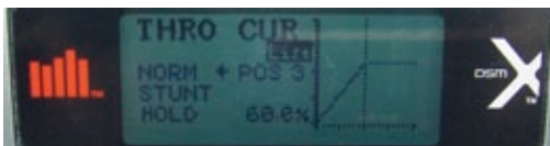
Um Strom zu sparen, kann im Normal-Modus die Gaskurve im Maximalwert noch auf etwa 50 Prozent reduziert werden (hier Originalwert)
