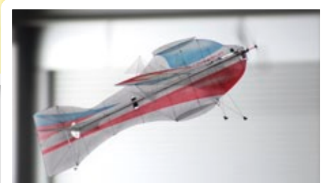
Gerade einmal rund 50 Gramm wiegt dieses Kunstflug-Modell. Es markiert das derzeit Machbare im Indoor-Kunstflug
