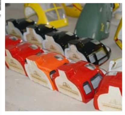
Die fertig lackierten Ecureuil-Rümpfe sind für das Einsetzen der Mechaniken vorbereitet. Die fertig mit Scheiben bestückten Fronthauben liegen zur Komplettierung bereit
