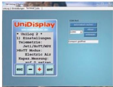
Das UniDisplay kann auf dem UniLog 2-Tool ebenfalls simuliert werden. Das virtuelle Abbild hat die volle Funktionalität des echten Geräts
