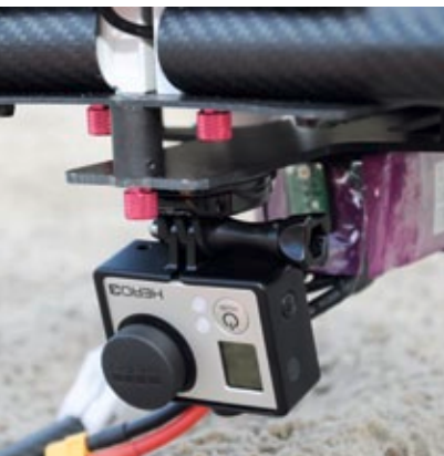
Detail der Kamera-Aufhängung, die inklusive Akku auf der schwingungsgedämpften Platte sitzt
