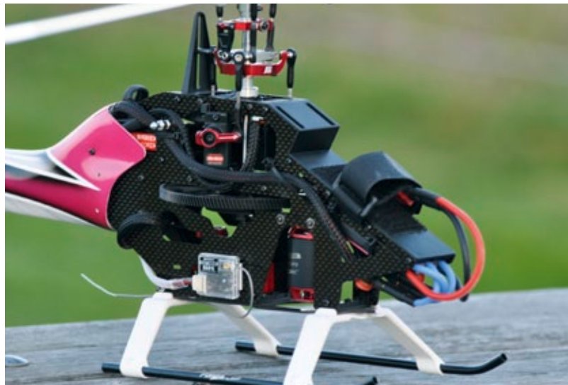
Gesamtübersicht des konstruktiven Chassis-Aufbaus: Der Controller sitzt unterhalb der Akku-Aufnahmeplatte
