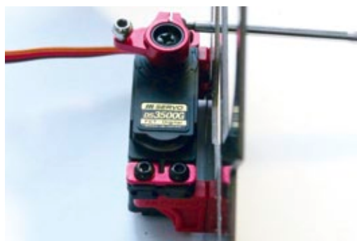
Die Klemmschraube lässt sich später noch gut durchs Chassis erreichen, um die Null-Punkt-Justage vorzunehmen
