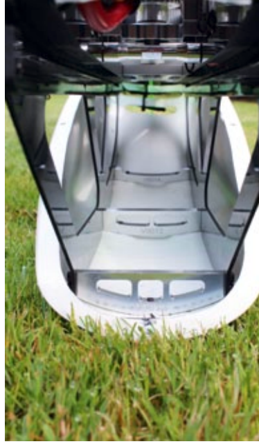
Die drei Alu-Bodenprofile des Akkuschachts sind der Kontur des Rumpfs angepasst
