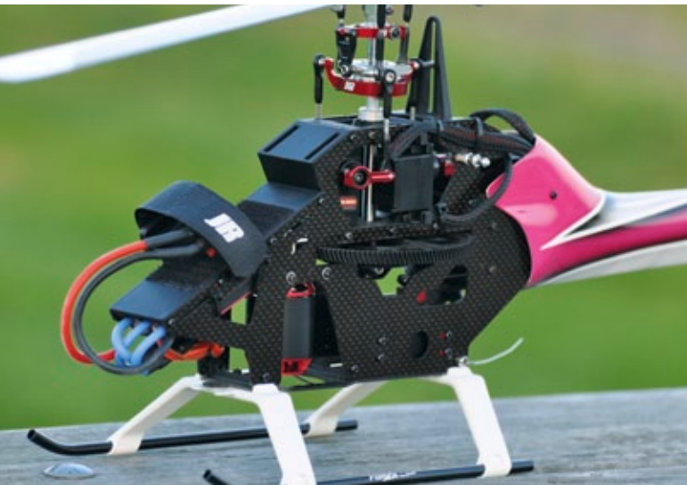
Gesamtübersicht des konstruktiven Chassis-Aufbaus: Der Controller sitzt unterhalb der Akku-Aufnahmeplatte
