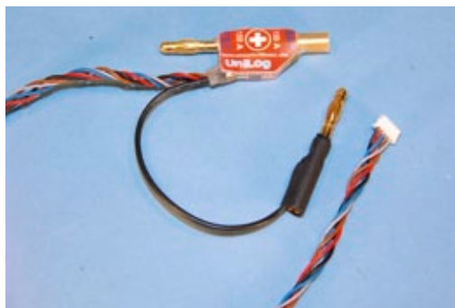
Der Stromsensor muss in die Plus- und Minus-Zuleitung des Akkus eingeschleift werden
