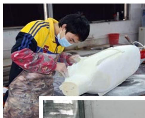
Blick in die GFK-Verarbeitung bei Roban. Hier werden mit größter Sorgfalt unter anderem auch die Urmodelle gefertigt, die für die Herstellung der Negativformen erforderlich ist
