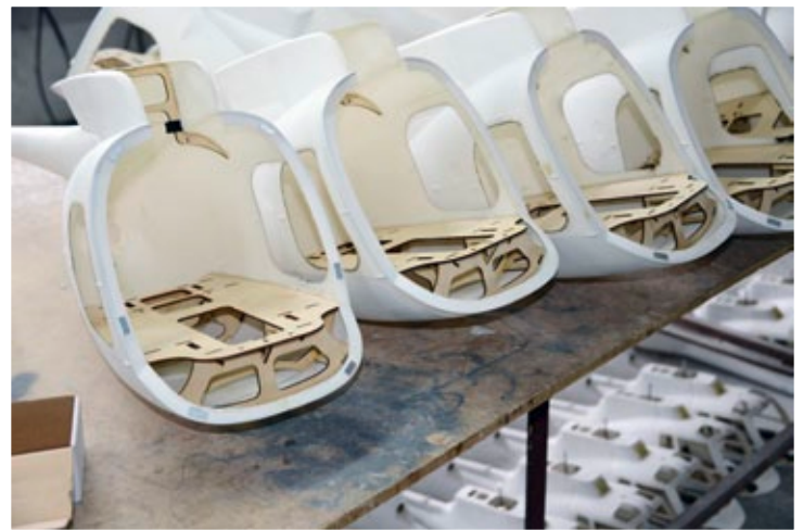
...bevor das Spantengerüst im Rumpf einlaminiert werden kann
