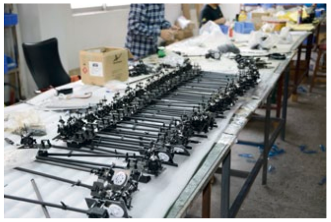
Serienfertigung entsprechender Roban-Mechaniken, die bereits mit Heckrohr versehen sind
