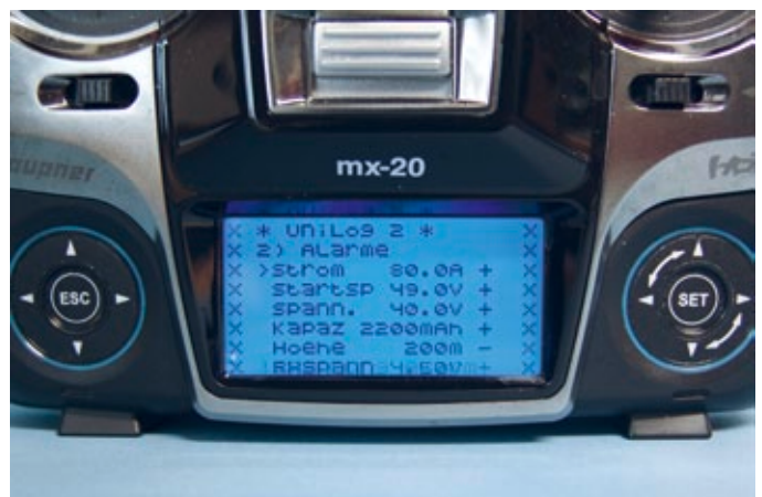
Super: Graupner HoTT-User – hier die mx-20 – können den im Modell eingebauten UniLog 2 auch drahtlos über ihren Sender konfigurieren
