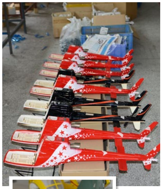
Die fertig lackierten Ecureuil-Rümpfe sind für das Einsetzen der Mechaniken vorbereitet. Die fertig mit Scheiben bestückten Fronthauben liegen zur Komplettierung bereit
