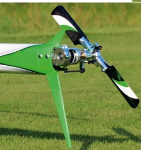
Robust und spielfrei – der Heckrotor des Vector
