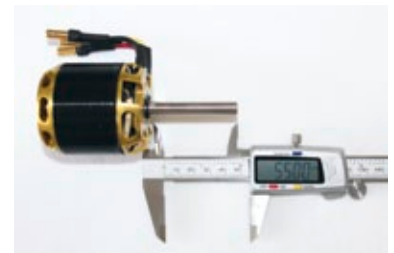
Der austretende Teil der Motorwelle sollte einen Durchmesser von 6 oder 8 und eine Länge von etwa 55 Millimeter haben. Hier der Scorpion HK-4530-540KV LE
