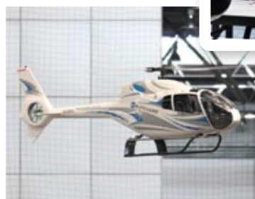
Mit einem Rotordurchmesser von 2.300 Millimeter war dieser Eurocopter EC-120 von Vario Helicopter der größte vorgeführte Hubschrauber
