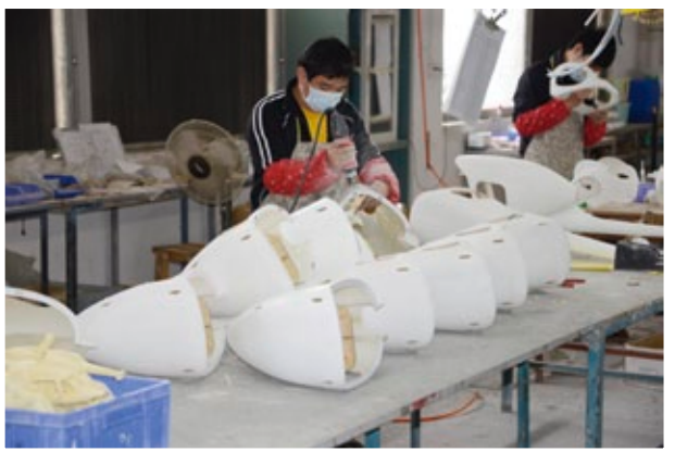
Hier ein Mitarbeiter beim Ausfräsen von Fenster-, Türen und sonstigen Öffnungen
