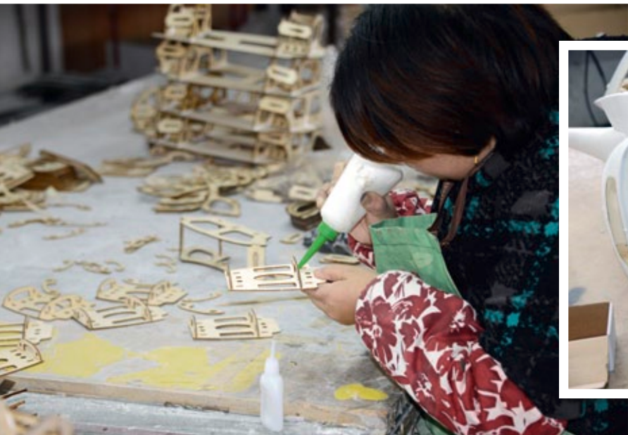
Serienfertigung – hier das Verkleben von Spanten, ...
