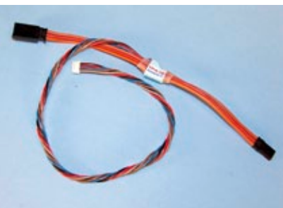
Mit dem Stromsensor Rx lässt sich die Stromaufnahme/Stromverlauf der Empfangsanlage loggen (maximal 20A). Die Kabel haben dafür einen ungewöhnlich starken Querschnitt
