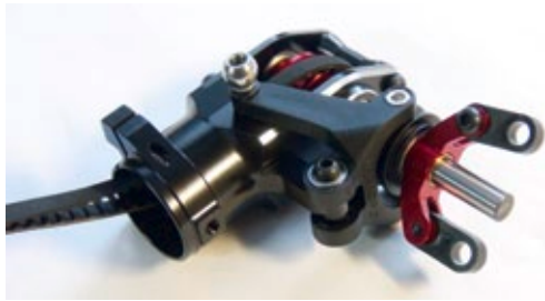
Robust und spielarm ist der Zahnriemengetriebene Heckrotor des Forza 450, der ein Metallgehäuse besitzt
