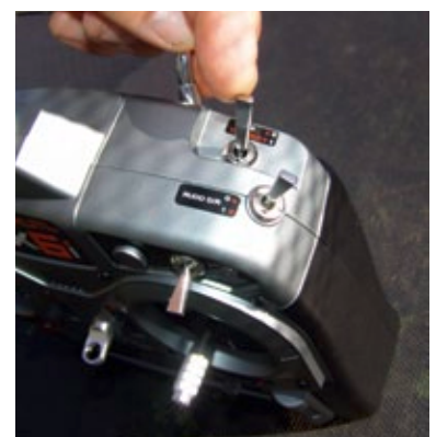
Der lange Schalter rechts außen ist auf „Autorotation“ programmiert. Schalterstellung nach hinten aktiviert „Motor Stopp“
