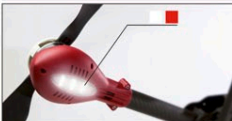
Die LED's können je nach Anforderung weiß oder rot leuchtend eingestellt werden und zeigen auch eine optische Warnung vor Unterspannung an.
