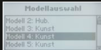
In der DX8, die als Schülersender dient, einen Modellspeicher auswählen, aktivieren und Sender wieder ausschalten
