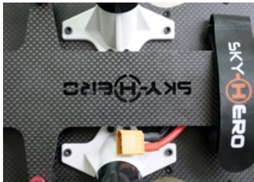
Ansicht des Kopters von unten. Hier der schwingungsgedämpfte Akku- und Kameraträger
