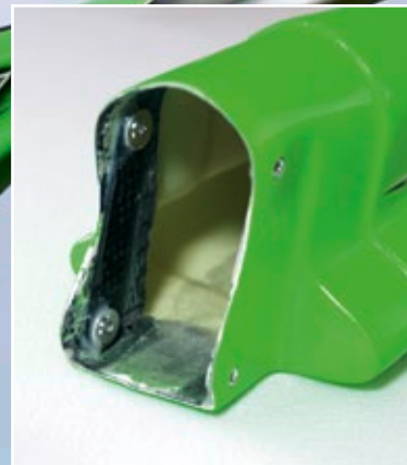
Anschlussstutzen der GFK-Heckrohr-Verkleidung
