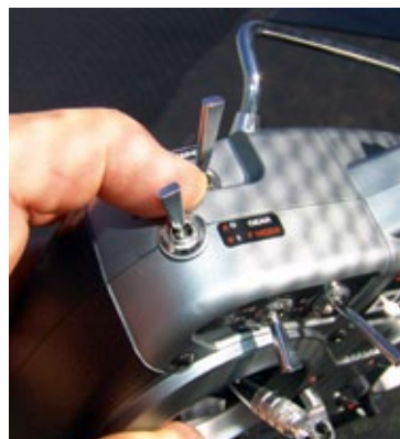
Mit diesem Zweiweg-Schalter werden die Flugphasen „Normal“ (nach vorn) und „Stunt“ abgerufen
