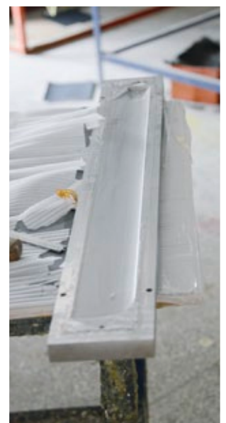
Zur Roban-Fertigung gehören auch Hauptrotorblätter in verschiedenen Größen – hier eine Negativ-Formenhälfte, in die bereits die Deckschicht eingebracht wurde
