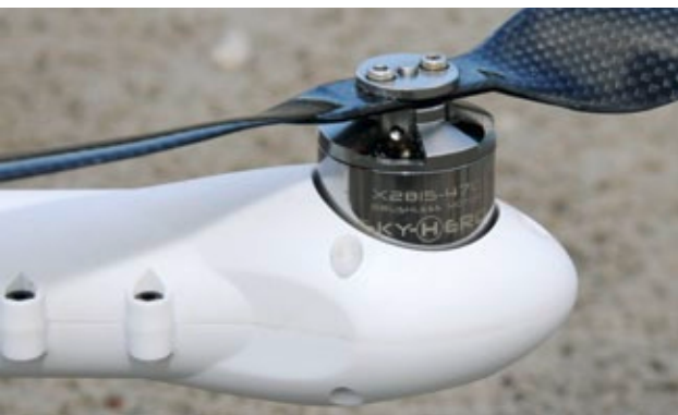
Detail der Luftschrauben-Befestigung am Außenläufermotor
