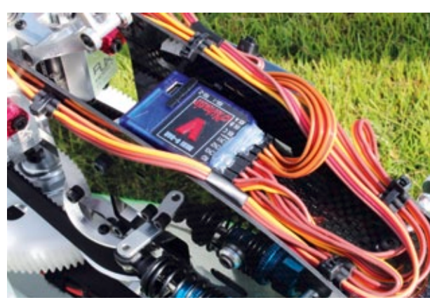
Das mini VStabi sitzt geschützt über der Heckrohr-Lagerung. Man achte auf saubere und scheuerfreie Kabelverlegung – hier mustergültig ausgeführt
