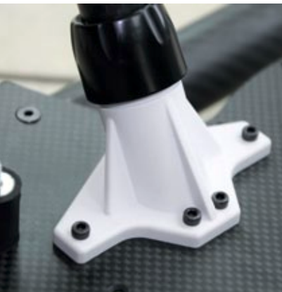
Die Schrauben erlauben ein schnelles Montieren oder Demontieren des Landegestells
