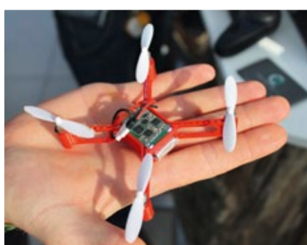
Auch das geht schon: ein Multikopter aus dem 3D-Drucker. Motoren und Elektronik sind jedoch noch herkömmliche Komponenten
