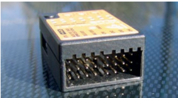
Sehr praktisch und vom microbeast übernommen – die stirnseitigen Seroanschlüsse
