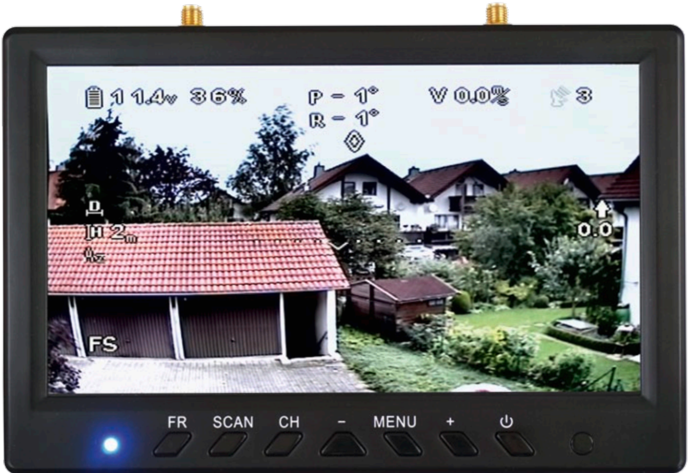
Maximale Bildqualität für eine Nicht-HD FPV-Kamera. Eine HD-Kamera kann das besser
