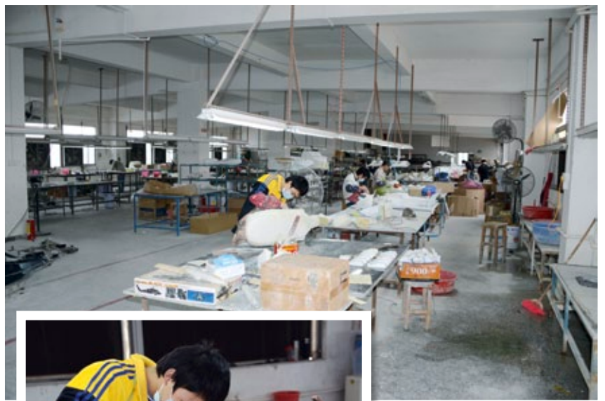
Blick in die GFK-Verarbeitung bei Roban. Hier werden mit größter Sorgfalt unter anderem auch die Urmodelle gefertigt, die für die Herstellung der Negativformen erforderlich ist
