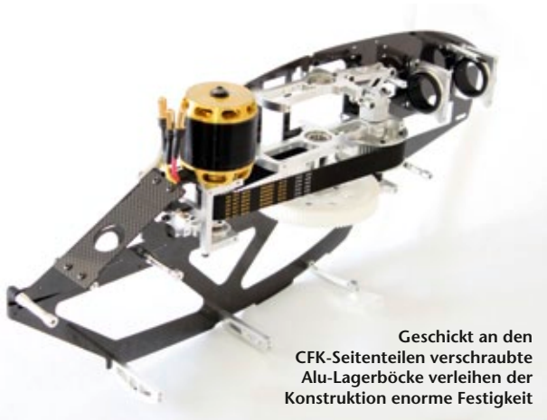
Der konstruktive Aufbau, hier noch ohne zweites Seitenteil, zeigt anschaulich das zweistufige Getriebe mit einem Zahnriemen in der ersten Stufe
