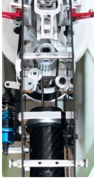
Ansicht des Heckrotor-Zahnriemenspanners mit der Rollenführung von oben
