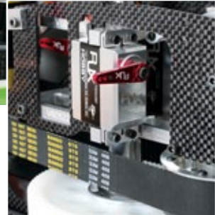
Die im Chassis verschraubten Taumelscheiben-Servos müssen nur noch mit den Gestängen versehen werden
