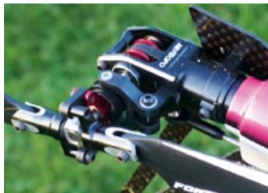
Die kugelgelagerte Pitch-Schiebehülse und der Heckrotor-Umlenkhebel mit doppelter Kulissen-Anlenkung
