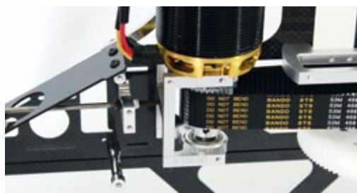
Der L-förmige Motorträger mit Gegenlager. Mit Hilfe einer Schraube, die in ein Gewinde am Motorträger greift, lässt sich der Antriebsriemen bequem per Inbusschlüssel spannen
