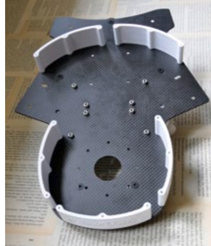
Die untere Bodenplatte mit den Kunststoff-Abstandshaltern ist bereit für die Verkabelung
