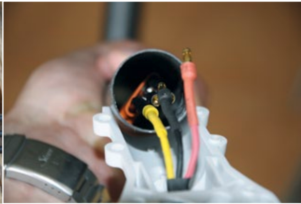
Die Opto-Controller von Sky-Hero werden ... in den Carbonrohren verstaut (siehe Text)
