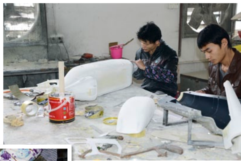
Blick in die GFK-Verarbeitung bei Roban. Hier werden mit größter Sorgfalt unter anderem auch die Urmodelle gefertigt, die für die Herstellung der Negativformen erforderlich ist
