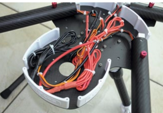
Übersichtliche und gut verstaute Kabelverlegung – dank vorkonfektioniertem Kabelset
