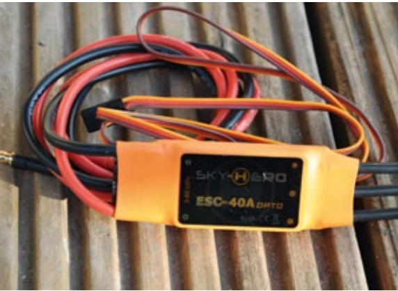
Die Opto-Controller von Sky-Hero werden ... in den Carbonrohren verstaut (siehe Text)
