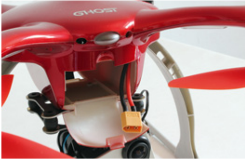
An der Front-Seite befindet sich die Klappe, die den groß-dimensionierten Akku-Schacht verschließt
