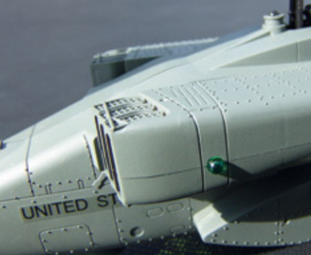
Detail der Turbinenatrappe mit Positionsleuchte
