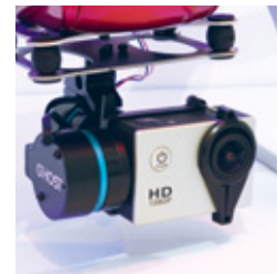
Die Sports-Cam von Ehang ist in dem für diesen Kameratyp beziehungsweise für die GoPro der Serien Hero 3, 3+ und 4 ausgelegten Brushless-Gimbal platziert
