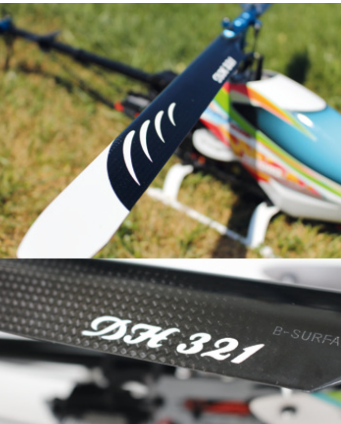
Die im Text erwähnten DH Blades mit einer Länge von 321 Millimeter sorgen für höhere Agilität
