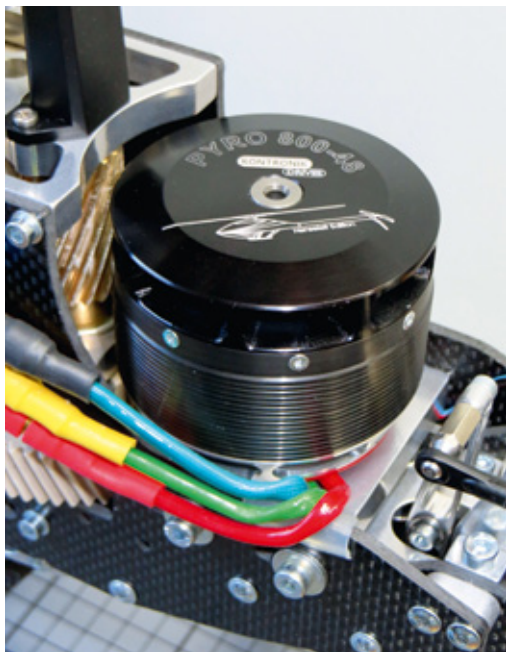
Die Anschlüsse des Pyro 800-48 sollten an der Chassiskante weich unterfüttert werden
