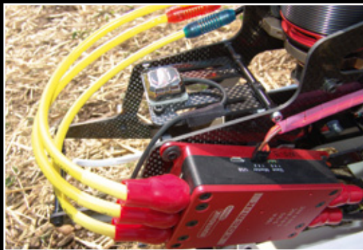
Der Kontronik-Kosmik ist seitlich am Chassis verschraubt, der kleine Sensor des Futaba-Flybarless-Systems wirkt schon fast etwas verloren auf dem großen Front-Podest
