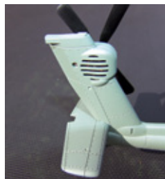
Am Heck arbeitet ein eigener Außenläufer, der mit einer x-förmigen Vierblatt-Luftschraube versehen ist. Schlitze sorgen für Frischluftzufuhr des Motors
