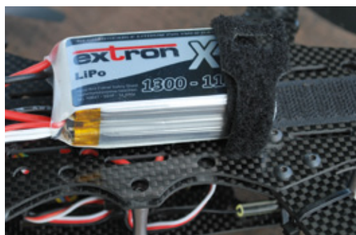
Der von Pollin bezogene Extron 3s-LiPo wird mit Klettband befestigt
