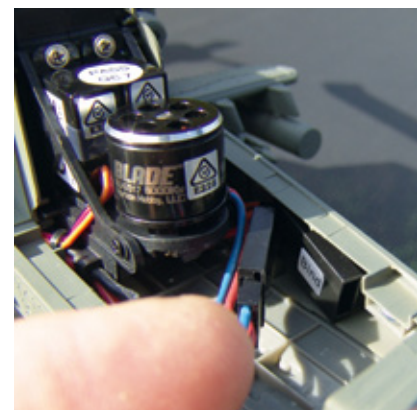
Die Anschlussbuchse für den Bind-Stecker befindet sich im Frontbereich
