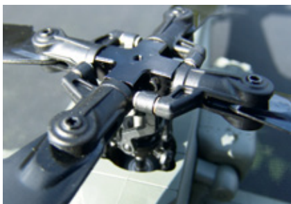
Der linksdrehende Vierblatt-Hauptrotor mit Metall-Zentralstück und Kunststoff-Blatthaltern
