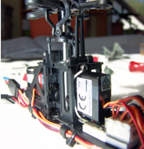
Die drei Taumelscheibenservos sitzen in den Seitenteilen. AS3X und Controller befinden sich im Heckbereich
