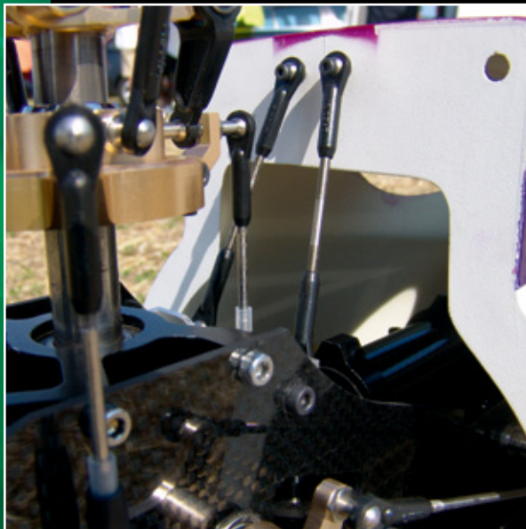
Zusätzliche Rumpfabstützung im Dombereich mit Hilfe von zwei Gestängen
