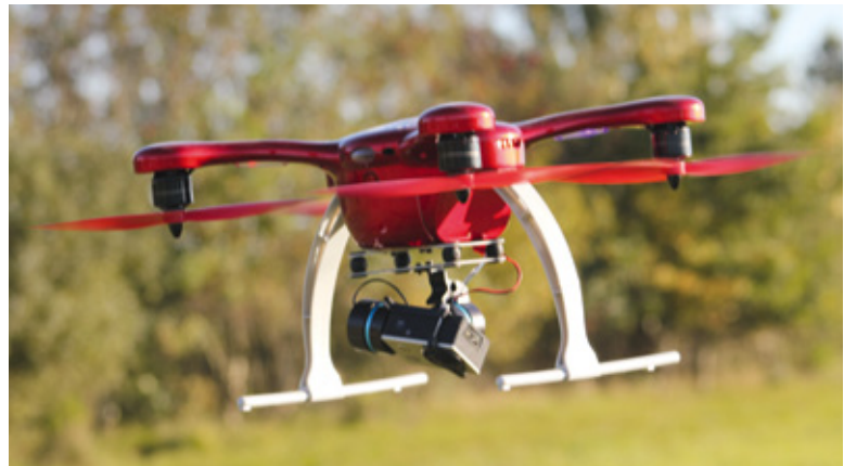
Das Gimbal kann über die App geneigt und horizontal gedreht werden
