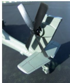
Am Heck arbeitet ein eigener Außenläufer, der mit einer x-förmigen Vierblatt-Luftschraube versehen ist. Schlitze sorgen für Frischluftzufuhr des Motors
