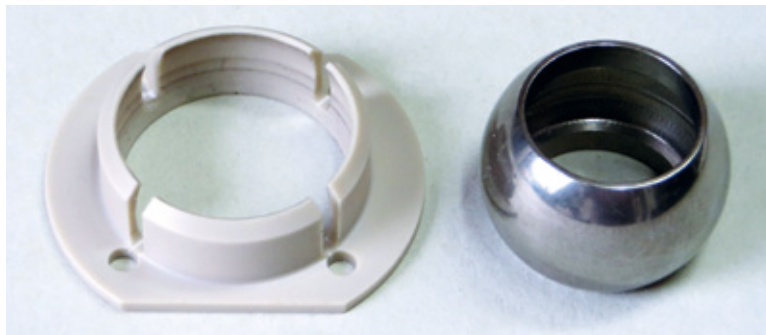
Die hohlgedrehte Edelstahlkugel des zentralen Taumelscheiben- Gelenks ist in einer Fassung aus hitzefestem PEEK gebettet
