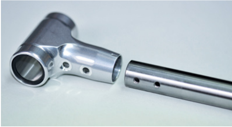
Die 15-mm-Rotorwelle wird mit vier M4-Schrauben mit dem Zentralstück verbunden
