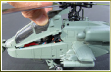
Die Kabinenhaube ist abnehmbar gestaltet und wird mittels Magneten gehalten
