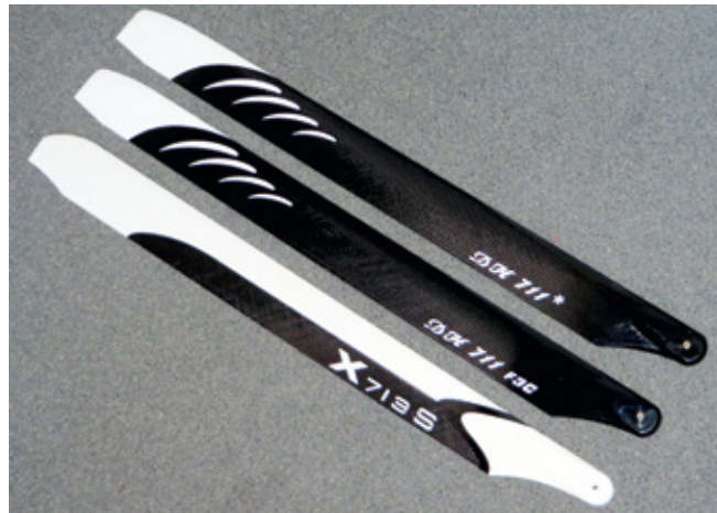
Jedes dieser drei Rotorblätter hat seine Stärken – das DH 711 FBL mit 200 g ist das agilste und wendigste mit den knackigsten Reaktionszeiten, das DH 711 F3C mit 238 g passt gut zum Speeden und Allroundfliegen und das X713S mit 232 g ist ein reines Wettbewerbs-Speedblatt. Für Präzision und Allround sind die DH-Blätter nicht zu schlagen
