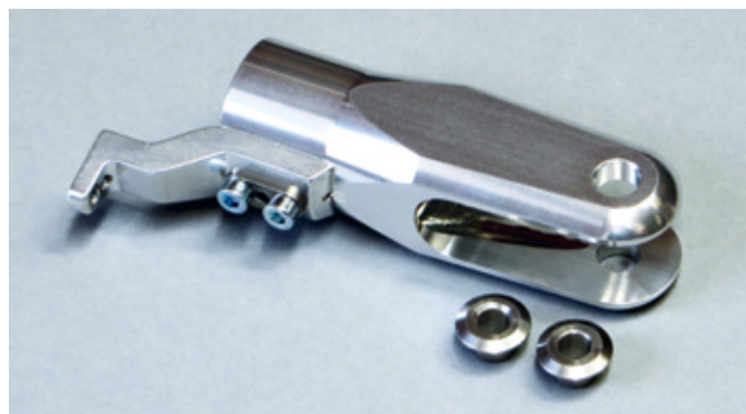
Ein TDR-II Blattgriff mit dem um \pm 4 Grad verstellbaren Anlenkhebel und Buchsen aus Edelstahl für die Befestigungsschrauben
