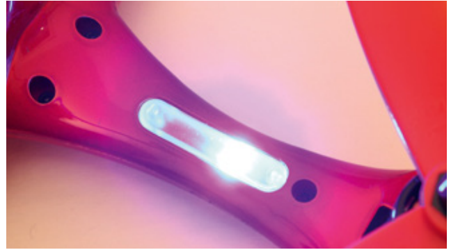
Helle LED in den Auslegern erleichtern die Lage-Erkennung, geben aber auch Infos über den Betriebszustand
