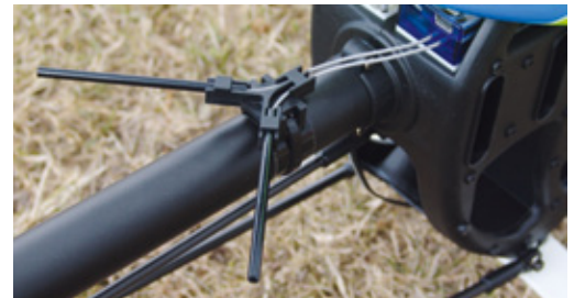
Absolut empfehlenswert: der Mikado-Antennenhalter bringt die Empfangsantennen in einen perfekten 90-Grad-Winkel und lässt sich an jedes Heckrohr mit einem Kabelbinder montieren (wahlweise auch mit Klebefläche für Rumpfmmodelle erhältlich)
