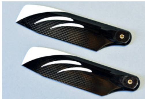
Die Heckrotorblätter von Dominik Hägele haben 107 mm Länge
