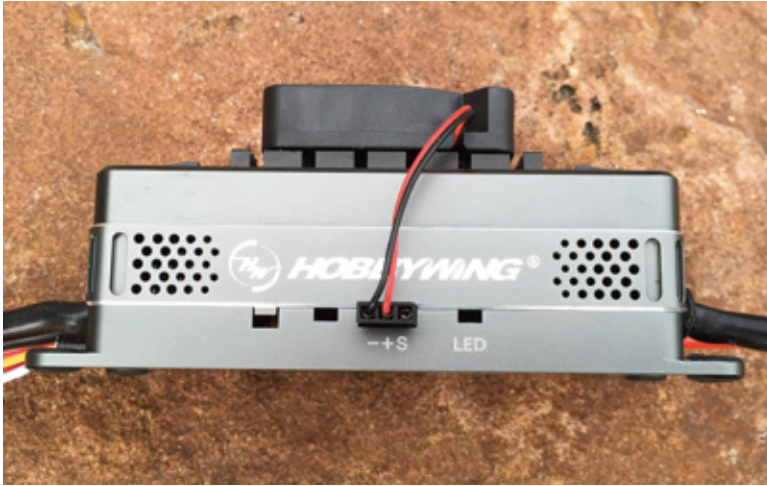
Auf der rechten Seite befindet sich der Anschluss für die Programmierereinheit beziehungsweise den Lüfter und die Status-LED
