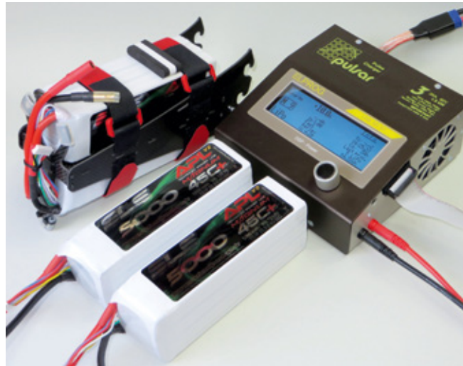
Mit diesen APL-Magnum V2-Powerpaketen von SLS wurden alle Testflüge durchgeführt. Links im bestückten Akkuträger sitzen 2x6s-, daneben 2x7s-Packs
