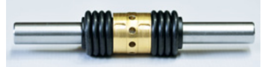
Technik der Blattlagerwellen-Dämpfung. Neben dem gelochten Justier-Element sitzen die in Langlöchern geführten Andruckkörper mit einem Rechts- sowie einem Links-Feingewinde. Verstellt man das Justier-Element mit einem 3-mm-Stift, ...
