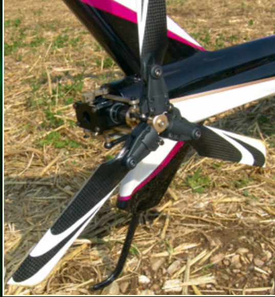
Auch der Quest-Dreiblatt-Heckrotor hat eine aufwendige, dafür aber nahezu spielfreie Push-Pull-Anlenkung
