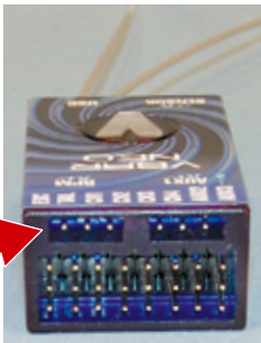
Am RPM-Anschluss (ganz oben links) kann ein externer Drehzahlsensor angeschlossen werden, um den internen Drehzahlregler (Elektro oder Verbrenner) mit Infos zu versorgen
