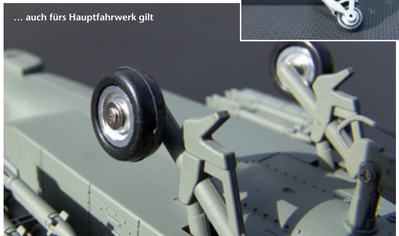
Das Spornfahrwerk ist sehr robust und verträgt auch manche harte Landung, was ...
