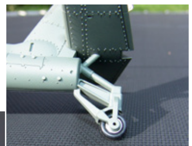
Das Spornfahrwerk ist sehr robust und verträgt auch manche harte Landung, was ...
