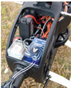
Am RPM-Anschluss (ganz oben links) kann ein externer Drehzahlsensor angeschlossen werden, um den internen Drehzahlregler (Elektro oder Verbrenner) mit Infos zu versorgen
