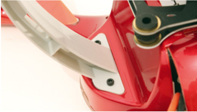
Das Landegestell ist zweiteilig ausgeführt und wird einfach mit jeweils zwei Schrauben am Gehäuse befestigt
