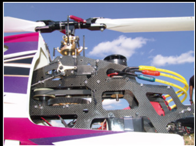
Markant sind an der Quest-Mechanik nicht nur die goldeloxierten Alu-Teile und CFK-Seitenteile, sondern auch das zweistufige Hauptgetriebe (Zahnriemen und schrägverzahnte Zahnräder) sowie die Push-Pull-Anlenkungen
