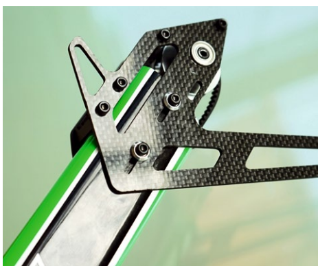
Dank der Langlöcher kann die Heckrotor-Riemenspannung bequem eingestellt werden
