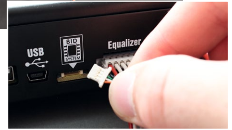
Bei Roxxy ab Werk installiert: Ein BID-Chip an jedem LiPo, der eine Kapazität von mindestens 1.800 Milliamperestunden hat. Über ein Verbindungskabel werden der LiPo-BID-Chip ...
