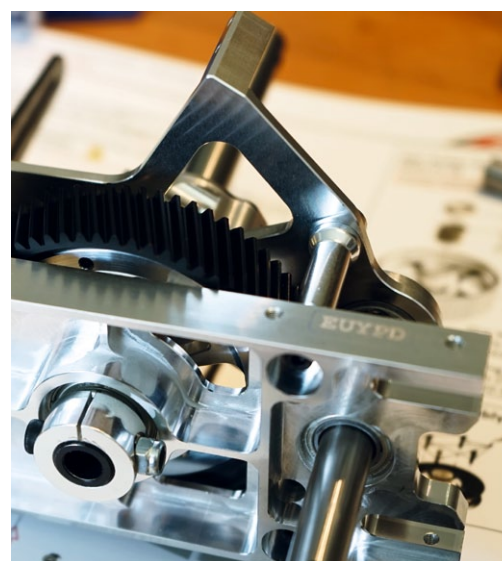
Besondere Beachtung erfordert die Montage der Rotorwelle nebst Klemmring (siehe Text)
