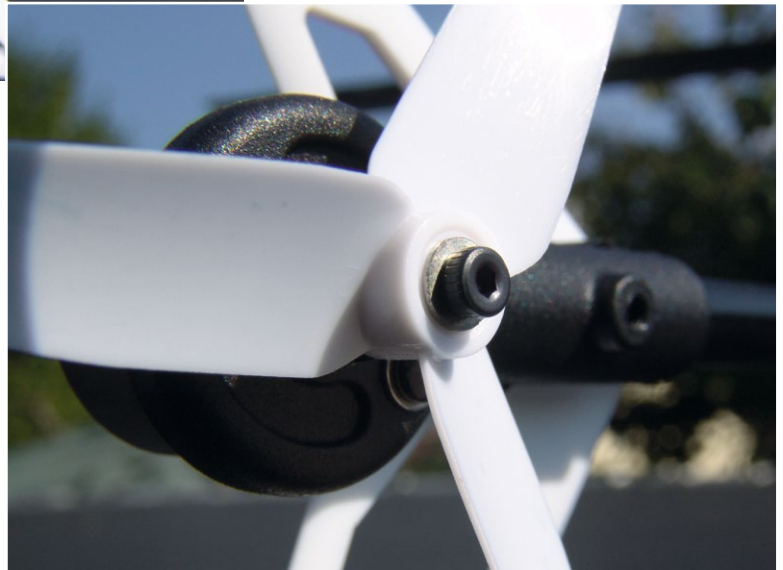
Am Ende des Alu-Heckrohrs (Durchmesser 8 mm) sitzt formschlüssig montiert der Brushless-Heckmotor. Der Dreiblatt sorgt für reichlich Schub
