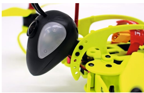
Der Kopf ist im Neigungswinkel verstellbar – das Chassis bietet entsprechende Bohrungen frei zur Auswahl
