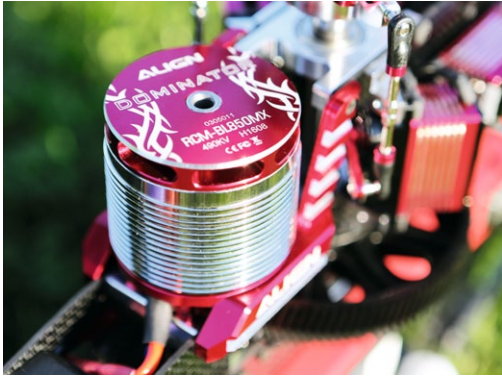
Der mit 5,1 kW Dauerleistung angegebene BL 850 MX hat sich bereits im 700L Top-Dominator bewährt und kommt auch hier zum Einsatz
