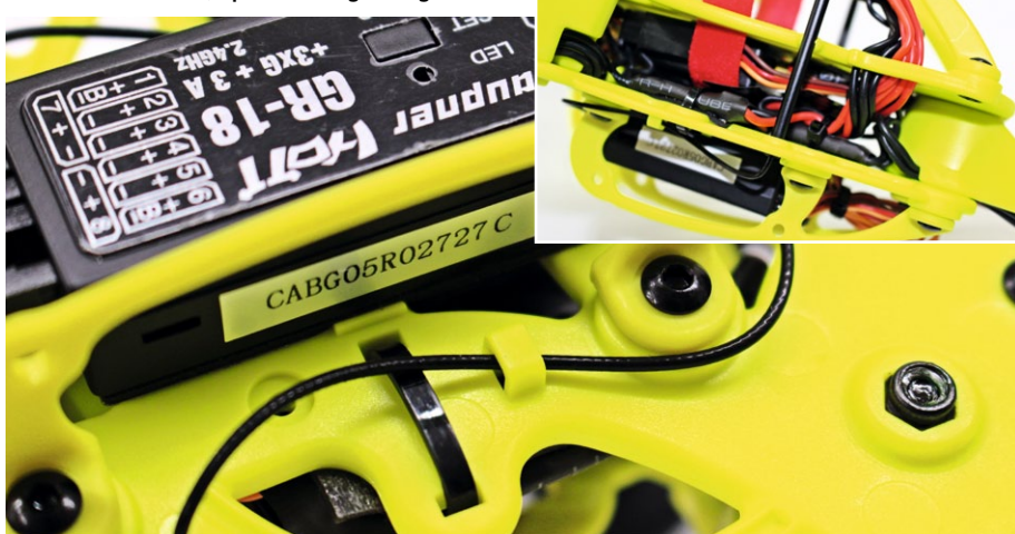
Die Antennen des GR-18 sind in den Röhren, die in die Halterungen geklippt sind, optimal verlegt und geschützt
