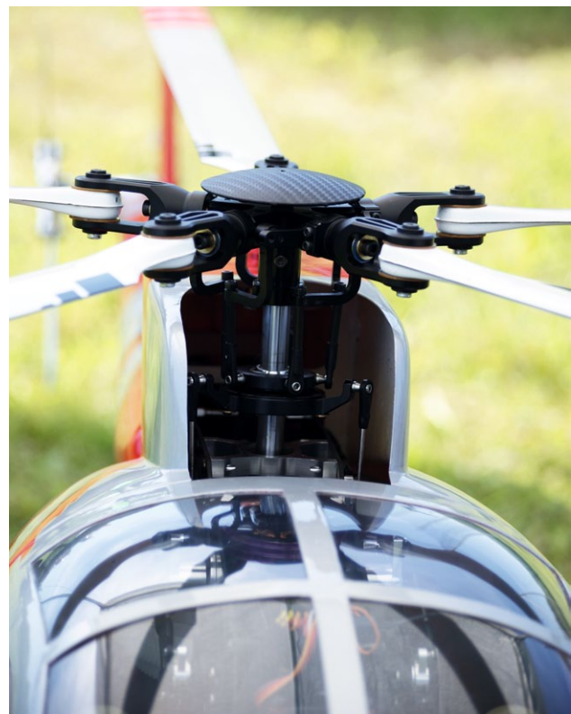
Und so sieht die montierte Hauptrotoreinheit in der MD 500E aus. Deutlich zu erkennen sind die 90 Grad voreilend angelenkten Blatthalter. Durch die besondere Anlenkung/Konstruktion wird kein Taumelscheiben-Mitnehmer benötigt. eine virtuelle Taumelscheiben-Verdrehung erübrigt sich ebenfalls
