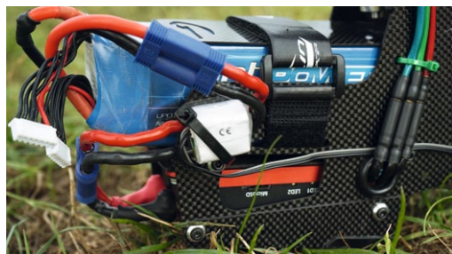
Hier der fertig konfigurierte Frontbereich mit untenliegendem Controller und darüber positioniertem LiPo-Akku. Die Chassis-Bohrung zur Durchführung der Motorkabel ist serienmäßig vorhanden
