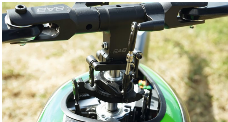
Die montierte Hauptrotoreinheit mit Taumelscheibe, Mitnehmern und Rotorkopf-Gestängen
