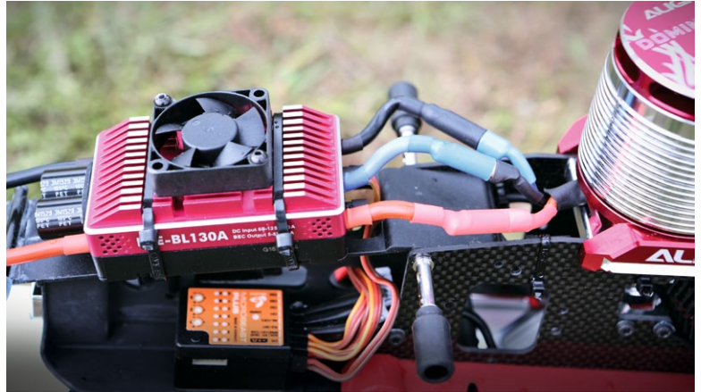
Hinter dem Controller RCE-BL 130A verbirgt sich ein Hobbywing Platinum HV 130A V4, jedoch abgespeckt auf 12s-LiPo. Hier die optimale Verbindung zwischen Controller und Motor. Vorsicht: Vor dem Wiederanlöten der Stecker muss auf Motorseite der Schutzlack entfernt werden
