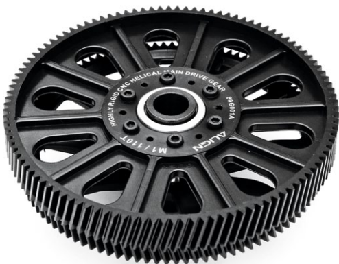
Das aus Verbundmaterial hergestellte Modul-1-Hauptzahnrad des 700X ist 2 Millimeter dicker als beim Vorgänger. Verwindungssteifigkeit und Robustheit sind damit abermals gestiegen
