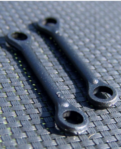
Die von der Taumelscheibe zu den Blatthaltern führenden Doppel-Kugelgelenke sind nicht verstellbar – Spurlauf-Einstellen entfällt
