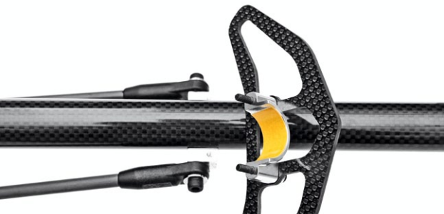
Die Klemmung für die Heckstreben ist mit doppelseitigem Klebeband gegen Verrutschen unter hoher Last zu sichern
