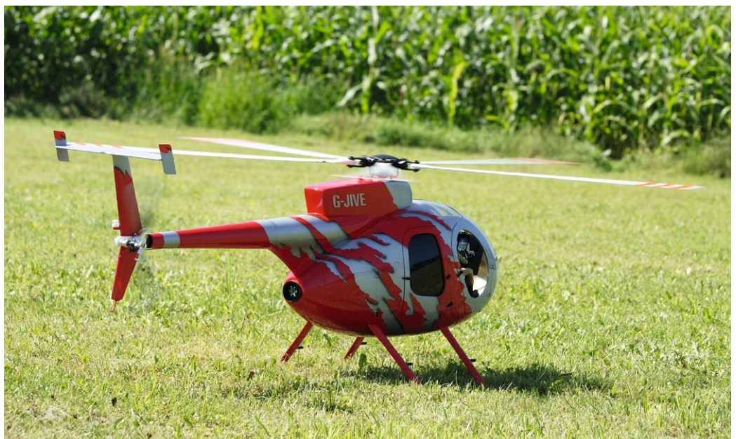
Beim ersten Boden-Drehzahltest wurde auch der Spurlauf des Fünfblatt-Hauptrotors perfekt justiert
