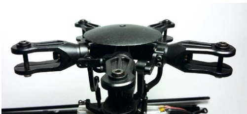
Der in der MD 500E montierte Fünfblatt-Hauptrotorkopf der Firma Scaleflying mit 14-Millimeter-Blatthaltern. Der Durchmesser beträgt 165 Millimeter
