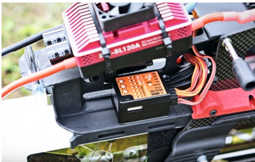
Da vor dem Controller definitiv kein Platz ist, sitzt das Microbeast Plus seitlich im RC-Vorbau
