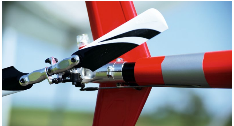
Das Seitenleitwerk der MD 500E ist mit dem Hecktriebhalter verschraubt. Für das Heckrotor-Gestänge wurde im Rumpf eine entsprechende Aussparung angebracht
