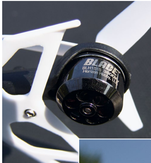
Am Ende des Alu-Heckrohrs (Durchmesser 8 mm) sitzt formschlüssig montiert der Brushless-Heckmotor. Der Dreiblatt sorgt für reichlich Schub
