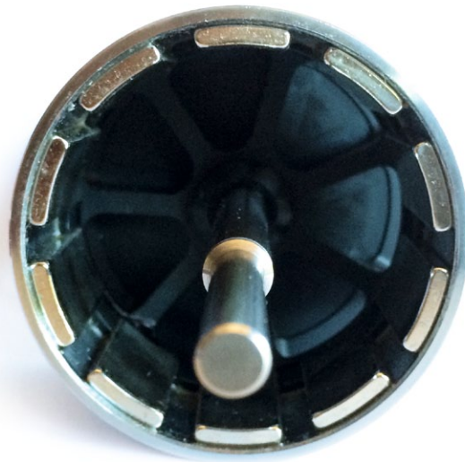
Im Inneren der Glocke präsentieren sich zehn Magnete. Deutlich zu erkennen auch die abgestufte Motorwelle (innen 8, außen 6 Millimeter)
