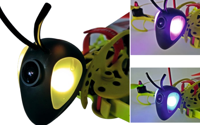
Die im Hornet-Kopf untergebrachten RGB-LED lassen sich via Fernsteuerung aktivieren und im Farbton beliebig verstellen
