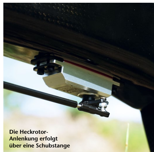
Carlos beim Einsetzen des Heckrotorservos in die entsprechende Befestigung des Carbon-Heckauslegers
