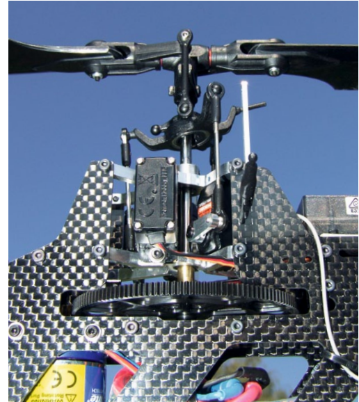
Bewährt – die senkrechte Anordnung der Taumelscheibenservos, die in zwei sternförmig gefrästen Alu-Lagerplatten montiert sind. Es gibt sogar Alu-Servohebel
