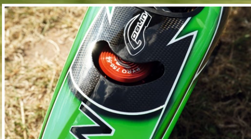
Die Kabinenhaube bietet im Bereich des Antriebsmotors eine ausreichend dimensionierte Kühlluft-Öffnung
