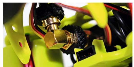
An alles wurde gedacht: Die Update- und Telemetrie-Buchse des GR-18 hat ihren festen Platz
