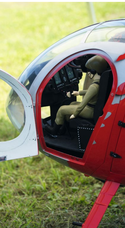
Blick ins vorbildgetreu ausgebaute Cockpit. Die Türen werden von Neodym-Magneten sicher in Position gehalten
