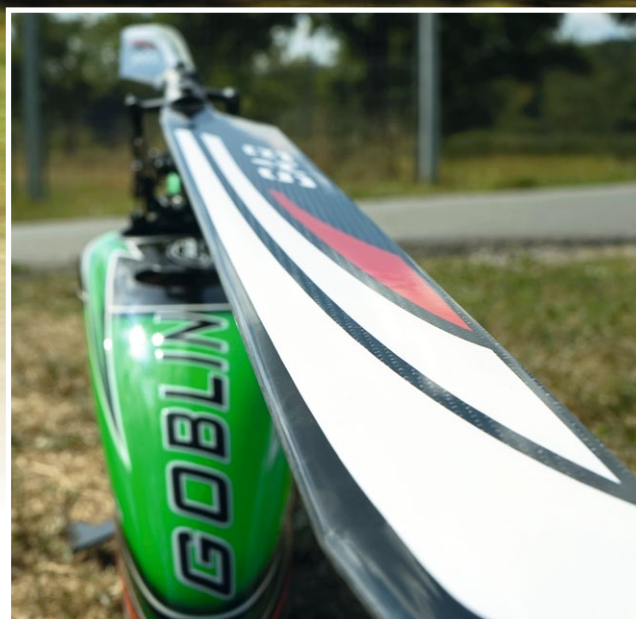
Die 690 Millimeter langen SAB Thunderbolt-Rotorblätter sorgen für beste Flug-Performance
