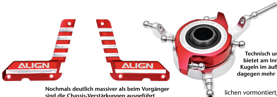
Siehe da, ein alter Bekannter? Mit dem 700X Dominator kehrt Align zum EFL-Rotorkopf samt am Zentralstück befestigtem Taumelscheiben-Mitnehmer zurück. Mehr zu den Hintergründen gibt es im Text
