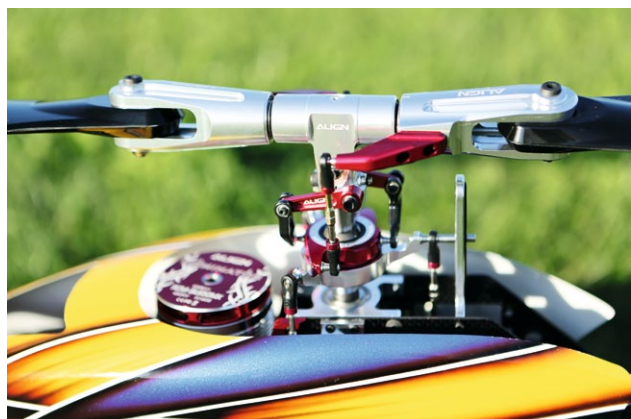
Trotz des Mitnehmers baut der EFL-Kopf des 700X nicht höher als der DFC-Kopf des 700L. Beibehalten wurde der direkt an die Rotorwelle angeformte „Klemmring“
