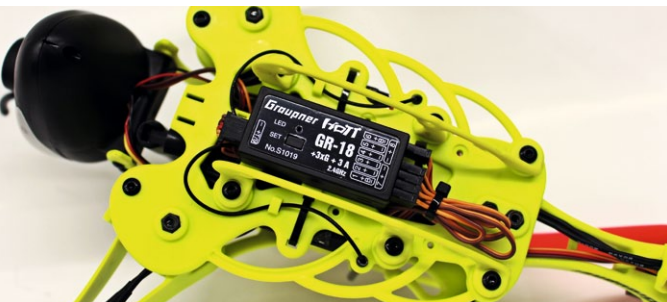
Der GR-18 HoTT Gyro-Empfänger ist am Bauch der Hornet untergebracht und durch zwei Bügel geschützt
