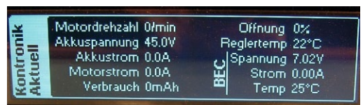
Menü „Kontronik Aktuell“: Die live hereinkommenden Daten werden nach Leistungs- und BEC-Pfad unterteilt und dargestellt
