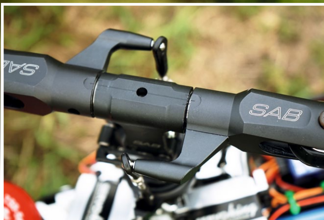
Mit Hilfe der Markierung lässt sich die Nullstellung der Blatthalter gut einstellen
