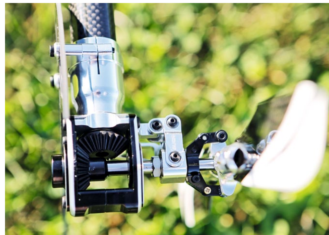
Spielfrei und Kugellager, soweit das Auge reicht: Der Heckrotor ist identisch mit dem des 700L Dominator
