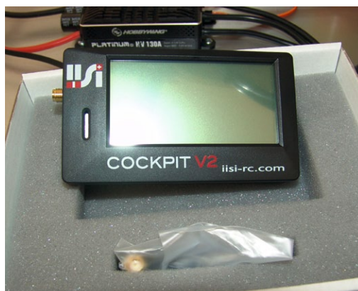
Zum Lieferumfang des Cockpit V2-Receiver gehören auch eine Antenne, eine MicroSD-Card, ein IISI-Link-Kabel und eine Kurzanleitung. Das Gute: IISI-RC ist nicht an bestimmte Fernsteuerungs-Hersteller gebunden, es arbeitet autonom als eigenständiges System
