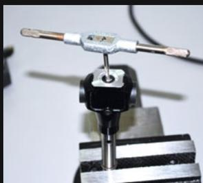
In das Zentralstück wird ein M3-Gewinde geschnitten
