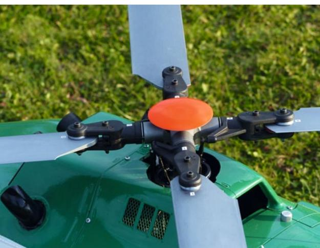
Der OF-Rotorkopf sorgt zusammen mit den M-Blades-Rotorblättern und dem HC-35X für ein ausgewogenes Flugverhalten
