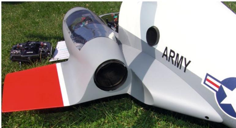
Hier die in der Lockheed XH-51A eingelassene Strahltriebwerke P60 von JetCat
