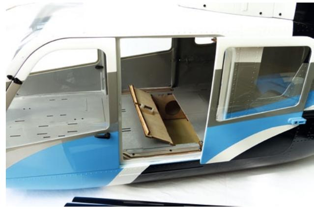
Durch Öffnen der hervorragenden Schiebetüren ergibt sich der Zugang zum Batteriefach
