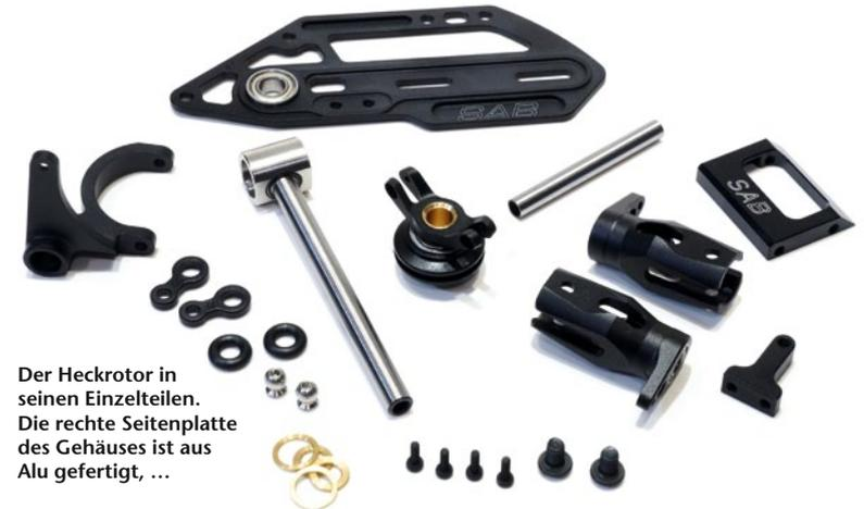
Der Heckrotor in seinen Einzelteilen. Die rechte Seitenplatte des Gehäuses ist aus Alu gefertigt, ...
