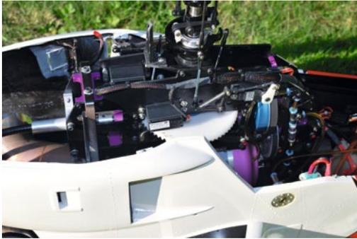
Alt: Die Cobra war ursprünglich mit vier Graupner/JR Taumelscheiben-Servos ausgestattet – 90-Grad-Anlenkung
