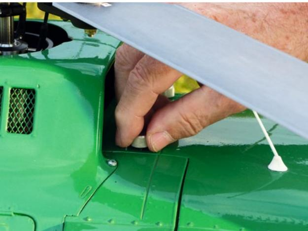
Optimal für den schnellen Akkuwechsel: Das abnehmbare Cockpit wird oben mit nur zwei Rändelschrauben befestigt
