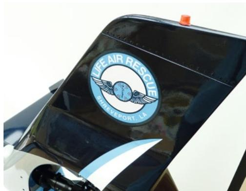
Das am Seitenleitwerk befindliche Navigationslicht sowie der „Life Air Rescue“-Aufkleber
