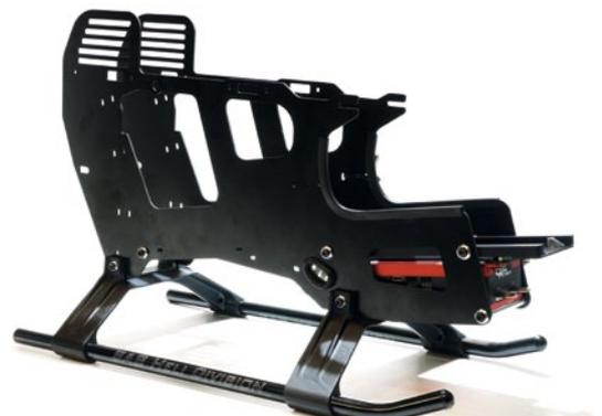
Sicherer Stand: Der Motor-Controller ist bereits zwischen den Seitenteilen platziert
