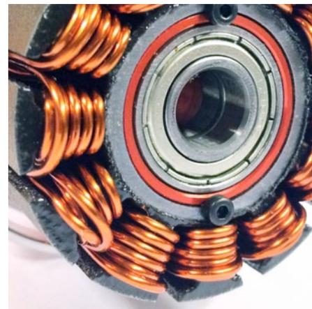
So sieht die Wicklung des „12 Nuters“ aus. Verwendet wird 1,25 Millimeter starker Draht, der „Bifilar“ (zwei Drähte im Bündel) verwendet wird. Das entspricht etwa einer 1,8 Millimeter starken Einzeldrahtwicklung
