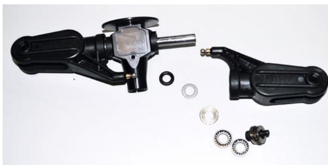
Die Blattlagerwelle ist ins Zentralstück eingesetzt. Dieses hat einen Kunststoffeinsatz, der durch seine O-förmige Bohrung der Blattlagerwelle nur eine Pendelbewegung nach oben und unten erlaubt
