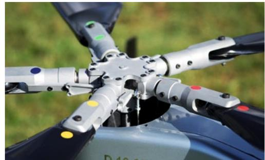
Der von Alterbaum gefertigte Ganzmetall-Fünfblatt-Hauptrotor
