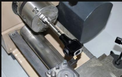
Das Zentralstück wird auf eine ältere Rotorwelle montiert und in das Backenfutter der Drehbank eingespannt
