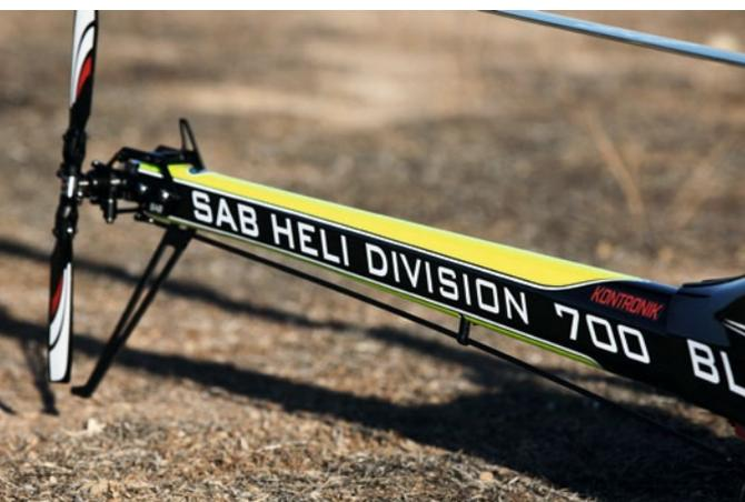
Wie üblich, wird der Heckrotor über eine außenliegende CFK-Schubstange angelenkt
