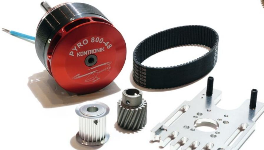
Wie üblich, wird in der ersten Getriebestufe ein Zahnriemen verwendet. Es können auch kleinere Triebwerke als der hier zum Einsatz kommende Pyro 800 verwendet werden
