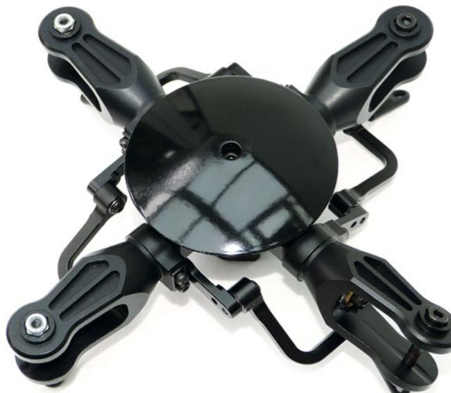
Der vormontierte Vierblatt-Hauptrotor ist aus Ganzmetall
