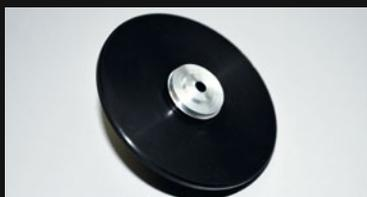
Der fertige Bremsteller von unten. Zu erkennen ist der kleine angedrehte Absatz, der saugend in die entsprechende Bohrung des Zentralstücks passt, um das Bauteil präzise zu zentrieren
