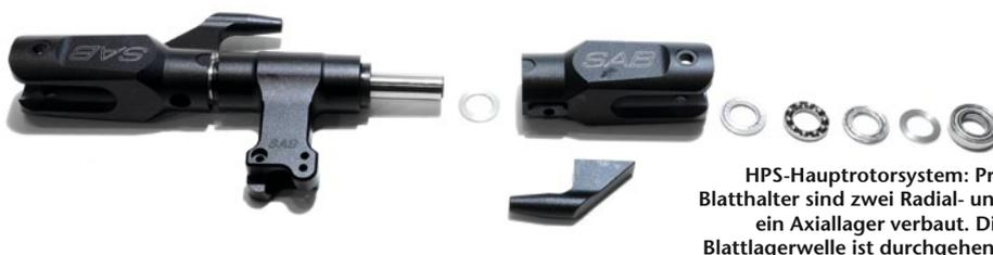
HPS-Hauptrotorsystem: Pro Blatthalter sind zwei Radial- und ein Axiallager verbaut. Die Blattlagerwelle ist durchgehend
