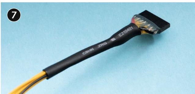
Jetzt noch ein Stück Schrumpfschlauch darüber, damit die Kabel gebündelt zusammengefasst sind. Wichtig ist, dass man durch den Heißkleber die Kabelfarben erkennen kann. Ansonsten muss man sich die Minus-Seite markieren, denn dieser Stecker ist nicht verpolungssicher
