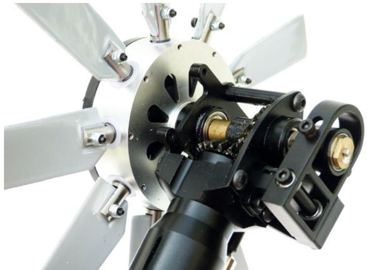
Der Fenestron mit seinem Kegelradgetriebe und der robusten Anlenkung
