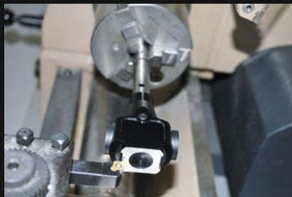
Die Befestigungen für die Paddelstange können plan abgedreht werden
