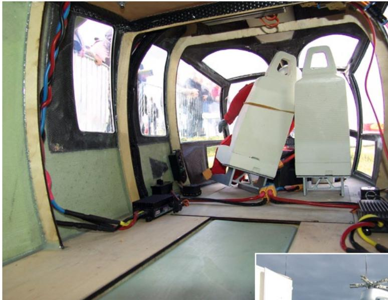
Da die Mechanik inklusive Turbine im oberen Bereich untergebracht ist, herrscht im Rumpf nahezu gähnende Leere
