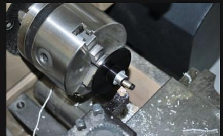
Nun wird der Aluminium-Bremsteller ebenfalls abgedreht, sodass er so beschaffen ist, dass er flach auf dem Zentralstück aufliegt
