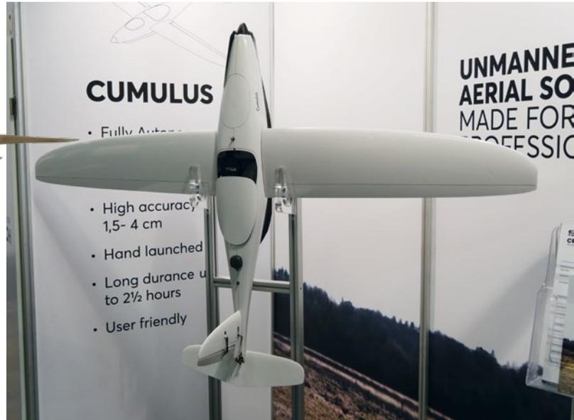
Ein Allrounder ist der Cumulus V1 von Sky-Watch. Die Flächenflugdrohne mit einer maximalen Zuladung von 500 Gramm kann aus der Hand gestartet werden, fliegt und landet hingegen automatisch. Sie ist schnell demontierbar und erreicht eine Flugdauer von 150 Minuten bei einer Reisegeschwindigkeit von 58 Kilometer in der Stunde.
