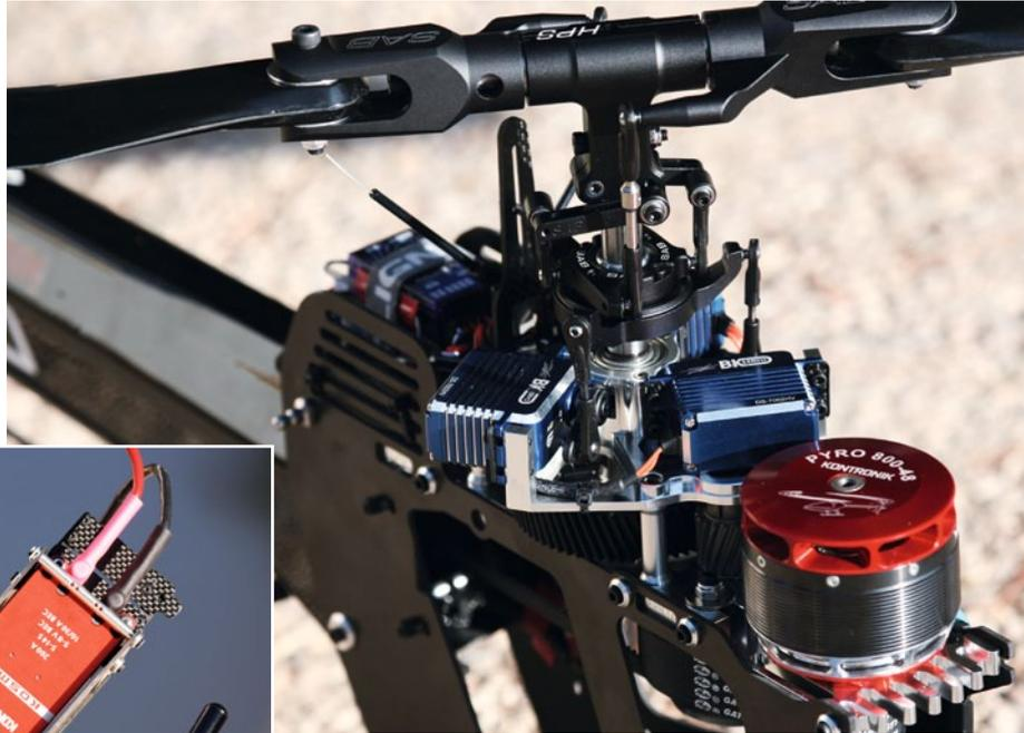
Gut geschützt sitzt der Controller zwischen den Seitenplatten (Ansicht von unten)
