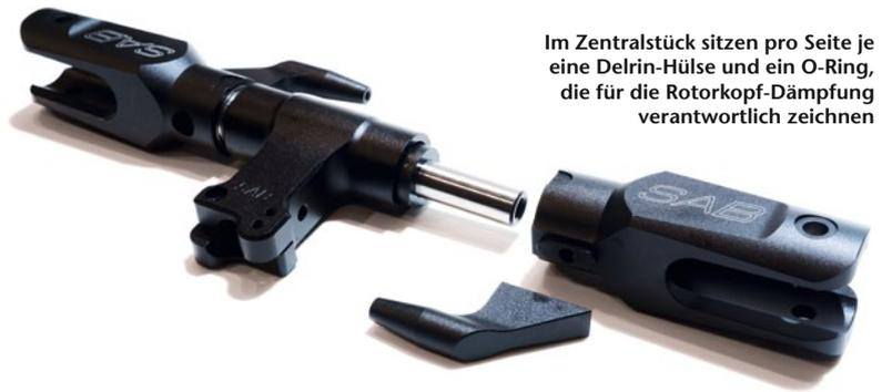
Im Zentralstück sitzen pro Seite je eine Delrin-Hülse und ein O-Ring, die für die Rotorkopf-Dämpfung verantwortlich zeichnen
