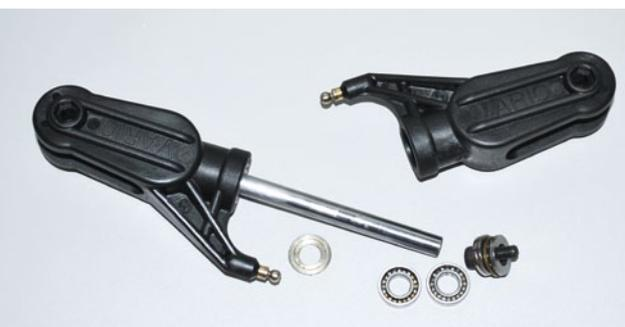
Die vorhandenen Kugellager und die Blattlagerwelle wurden in die neuen Kunststoff-Blatthalter eingebaut
