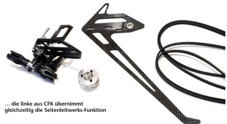
... die linke aus CFK übernimmt gleichzeitig die Seitenleitwerks-Funktion
