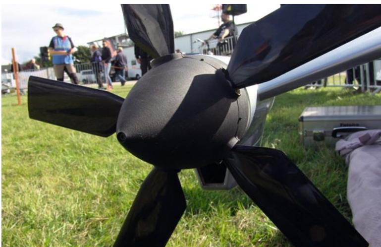
Die beiden in den Gondeln befindlichen Props haben Pitchverstellung und werden über E-Motoren angetrieben
