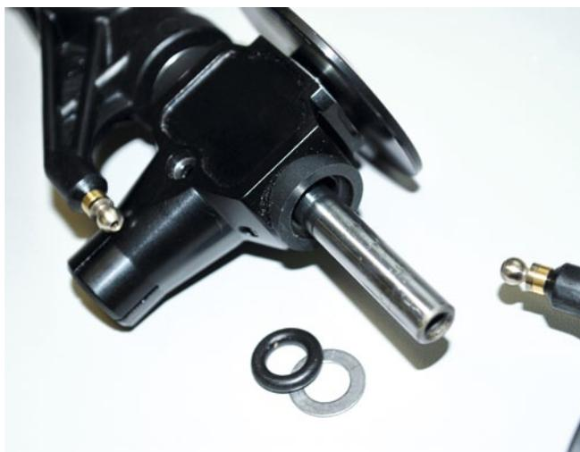
Der Dämpfungsgummi wird mit Fett eingesetzt. Anschließend wird auf die Blattlagerwelle eine Passscheibe aufgefädelt. Die Blatthalter sollen stramm am Zentralstück sitzen, sich dabei aber noch leicht drehen lassen
