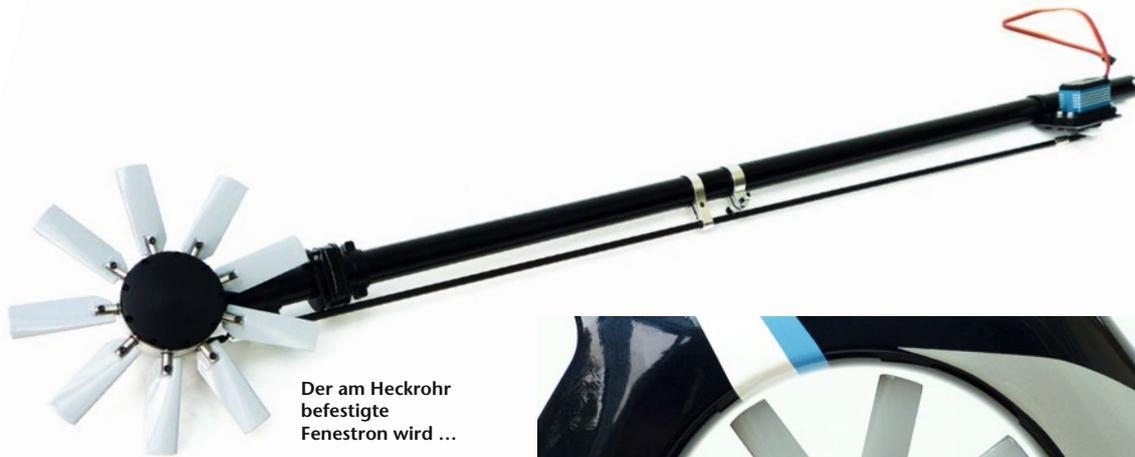
Der am Heckrohr befestigte Fenestron wird ...
