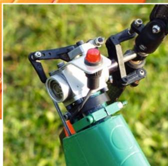
Der Heckrotor der BO 105 mit den montierten Heckrotorblättern von MS Composit, mit denen das Modell nun perfekt fliegt
