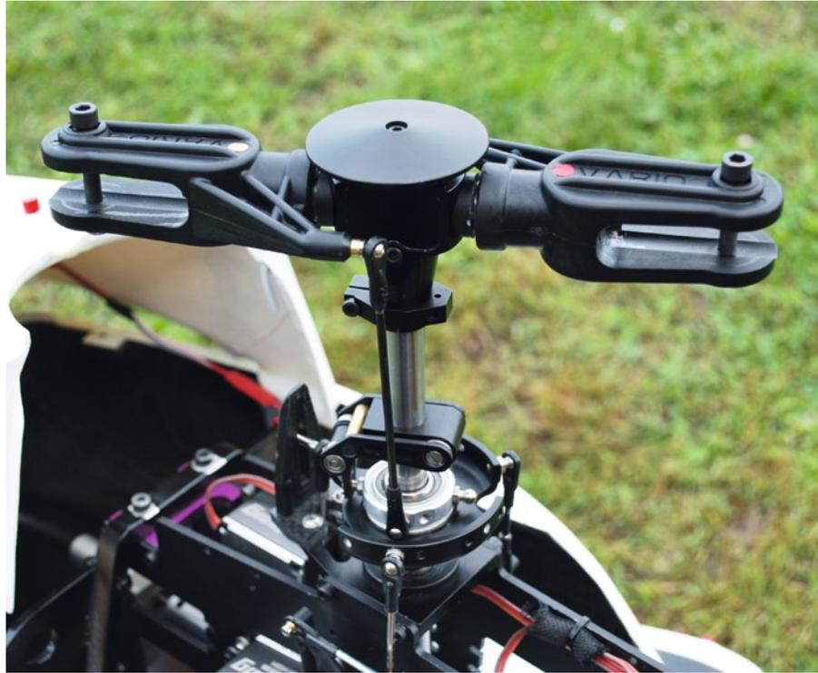
Der flugfertig montierte Flybarless-Rotor mit seiner Taumelscheiben-Anlenkung inklusive Mitnehmer
