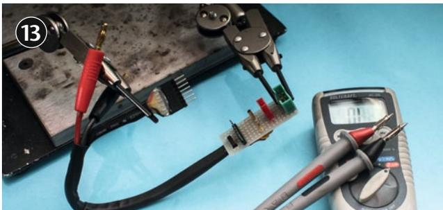
13 Vor dem ersten Einsatz wichtig: alles in Ruhe durchprüfen, denn schnell hat man sich mal vertan. Also mit dem Durchgangsprüfer checken, ob alle Minus-Seiten der Ladestecker auch wirklich Minus sind, und bei Plus genauso. Auch die korrekte Reihenfolge der Balancer-Leisten kontrollieren
