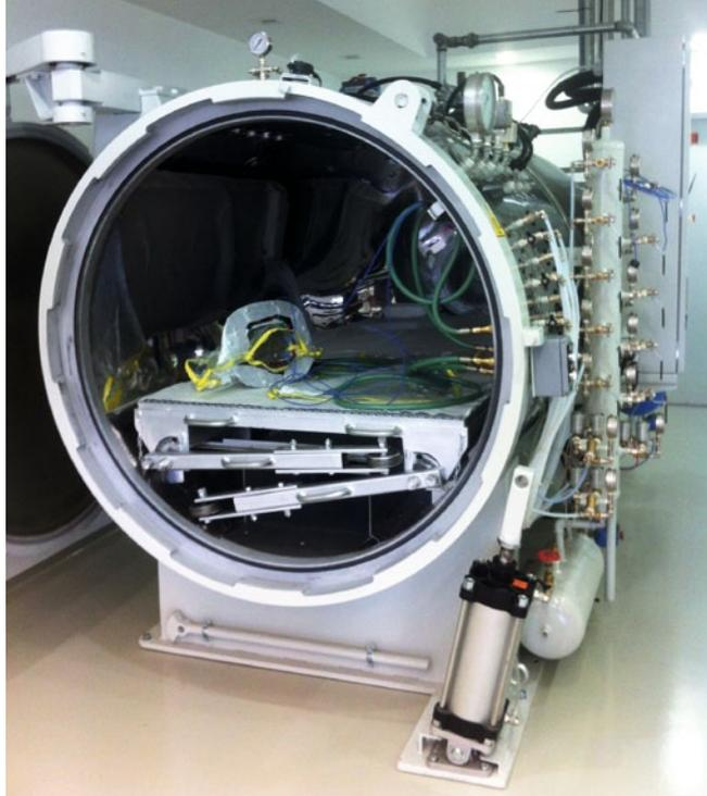
Das ist keine geöffnete Raumkapsel, sondern ein Heißluft-Autoklav. Hier werden die meisten Produkte von Witte Helicopters unter Druck zum Aushärten getempert
