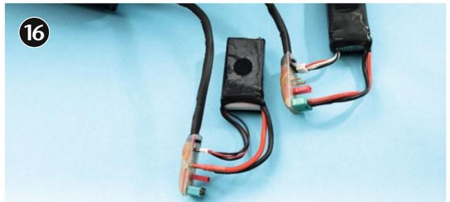
16 Man könnte den fehlenden Verpolungsschutz der Balancerstecker nun als Kritikpunkt sehen, aber notfalls erkennt das hier eingesetzte Ladegerät zuverlässig einen solchen Steckfehler und rügt den fahrgigen Verwender mit vernehmlichem Piepsen. Des Weiteren sollte klar gesagt werden, dass man niemals mehrere, unterschiedliche Akkus parallel an einem Ladeausgang laden darf. Das 3-in-1-Kabel ist stets für nur einen einzelnen Pack gedacht
