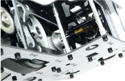
Blick auf das 68- und 22-Zähne-Riemenrad, um die Drehzahl des Fenestron-Heckantriebs zu erhöhen
