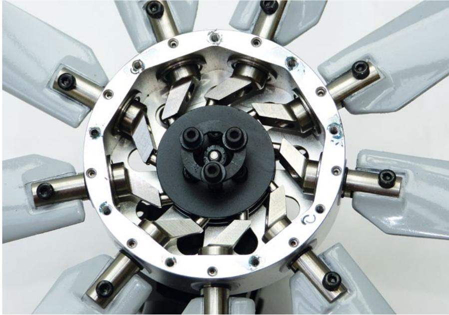
Ein Blick ins Innere verdeutlicht den Aufbau. Die Blattlagerwellen sitzen in Radiallagern, die umgewinkelten Verstellhebel greifen in die Nabe
