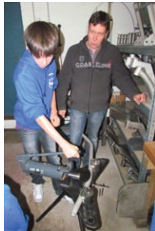
Rohre biegen und Fußrasten drücken bei BBS
