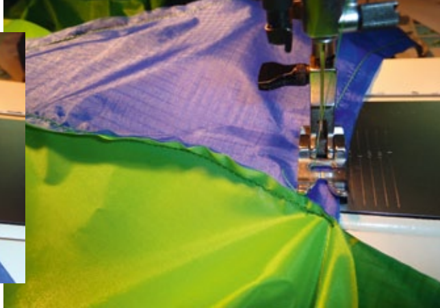
Einfügen und Zunähen der Zacken
