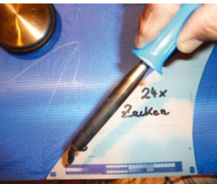
Kleinteile lassen sich sauberer heißschneiden (auf Belüftung achten!)
