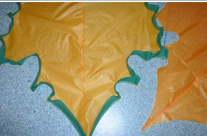
Zuschnitt des Schleppsacks und umlaufendes Band als Profil
