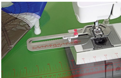
Einsatzbereit montiert: Circular Attachment mit verstellbarem Nähradius
