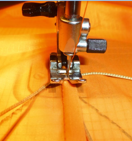
Schnurkreuze zur Verstärkung der Waagepunkte
