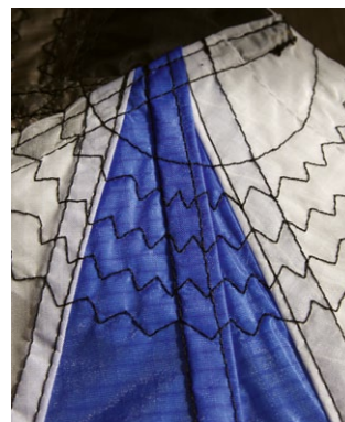
Von der Rückseite: trotz vieler Nähte keine Schwächung durch Perforation
