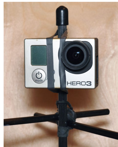
GoPro-Kamerabefestigung mit seitlicher Stabzuführung
