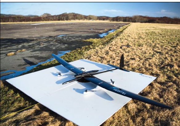
Aktueller Kitemill-Flügel: ein Hochleistungsflugzeug mit Quadrokopter-Startpropellern
