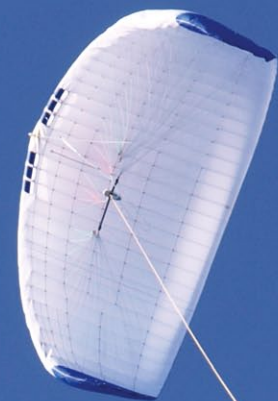
Der Kite von SkySails ist stablos und wird an einer Schnur gehalten
