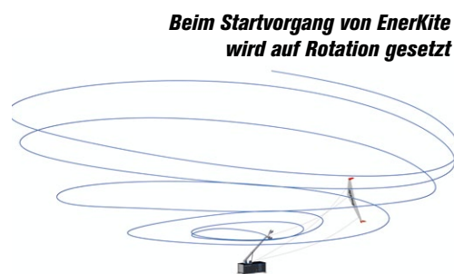
So sieht die EK200-Einheit mit Startmast, Kite und Schnüren aus
