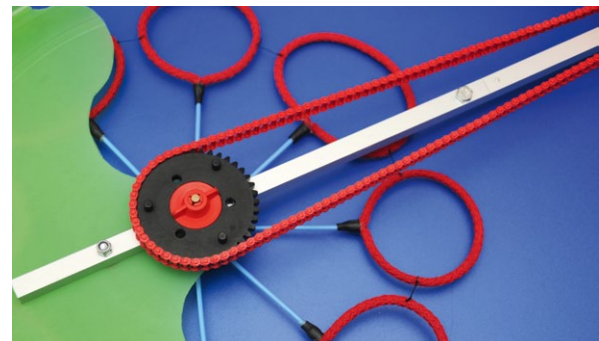
Zahnradantrieb beim Typ L, von uns empfohlen
