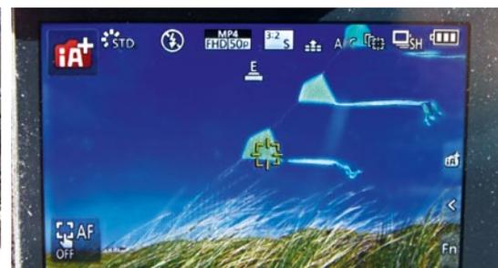
Per Touch kann der Schärfepunkt positioniert werden und bleibt beim Schwenken auf dem Objekt
