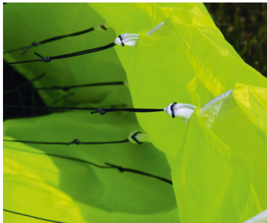
Profil Support (PS) an der Profilnase und die Waageschlaufen
