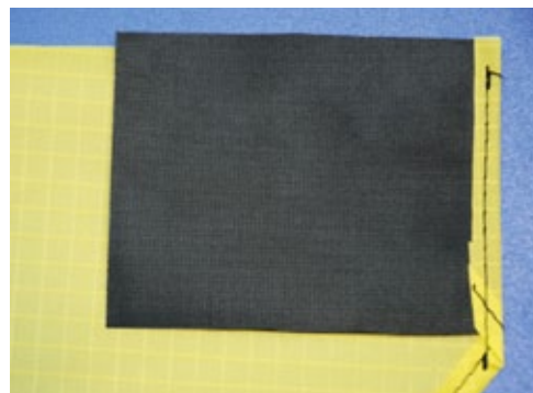
Hier wird zunächst das Dacron aufgenäht und an der kurzen Seite versäumt
