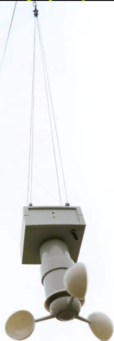
Fertig verbaute Anlage im Betrieb in der Drachenschnur
