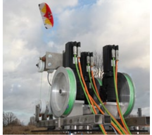
Test der NTS-Steueranlage mit Serien-Tractionkites
