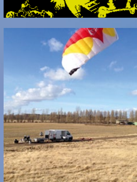
Kontrolle des Fluges mit vier Leinen durch Computersteuerung
