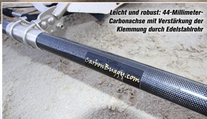
Leicht und robust: 44-Millimeter-Carbonachse mit Verstärkung der Klemmung durch Edelstahlrohr
