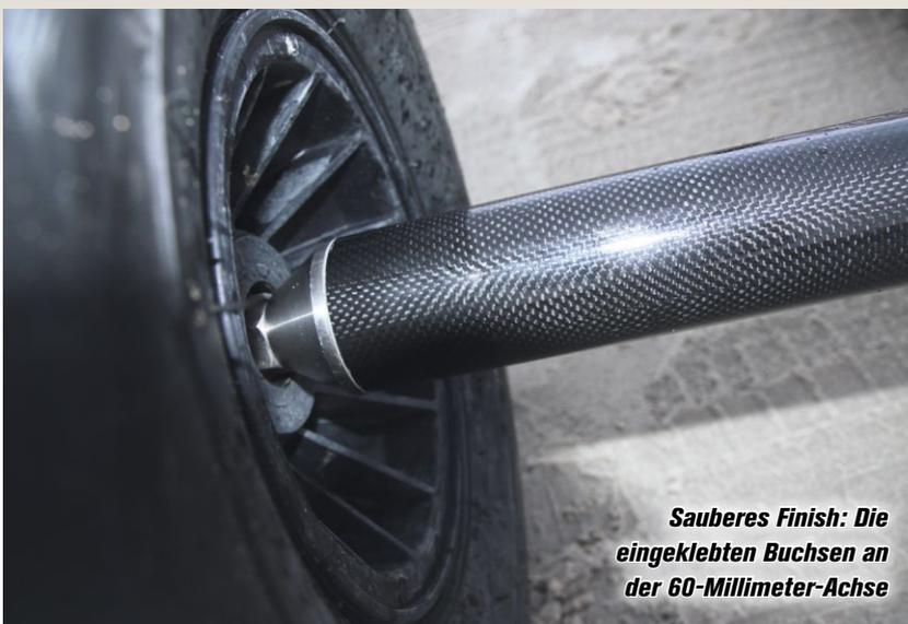
*Sauberes Finish: Die eingeklebten Buchsen an der 60-Millimeter-Achse*
