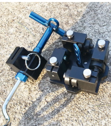
Das fertige Umlenksystem wird einfach am Bodenanker eingehängt
