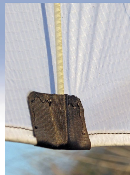
Segelseitige Aufnahme des 3-Millimeter-Schlafstabs
