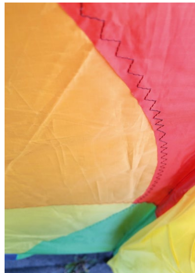
Saubere Segelmachernähte der rundgeschnittenen Paneele (links)
