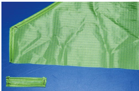
Segel und Spinnakerstreifen werden gesäumt
