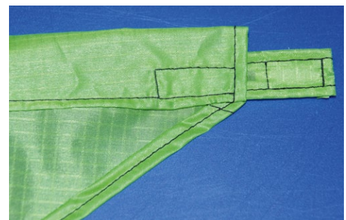
Umgeschlagene und fertig vernähte Stabtasche
