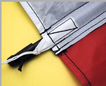
Prima Näharbeiten im Bereich der Stabauhängungen
