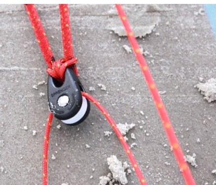
Vier Schlaufen sichern die farbcodierten Waageenden
