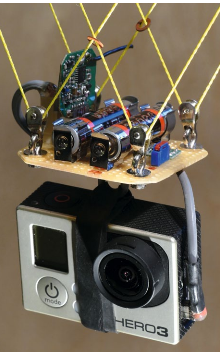
Wolfgang Biecks KAP 'n' Hook-Rigg mit Videoübertragung
