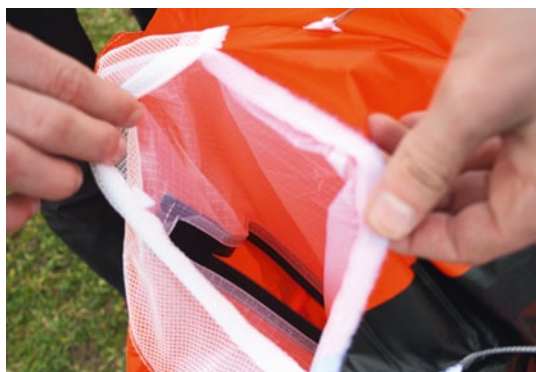
Man öffnet den Reißverschluss und schließt danach den Klettverschluss wieder
