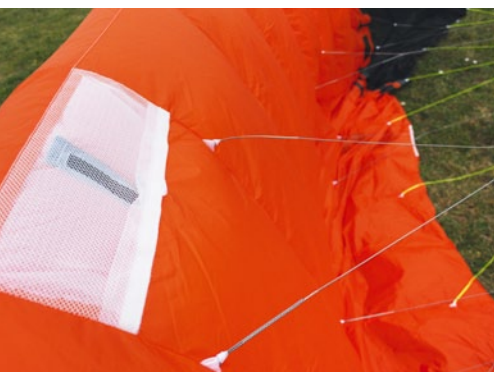
Durch den Klettverschluss gelangt man zum Einlassventil
