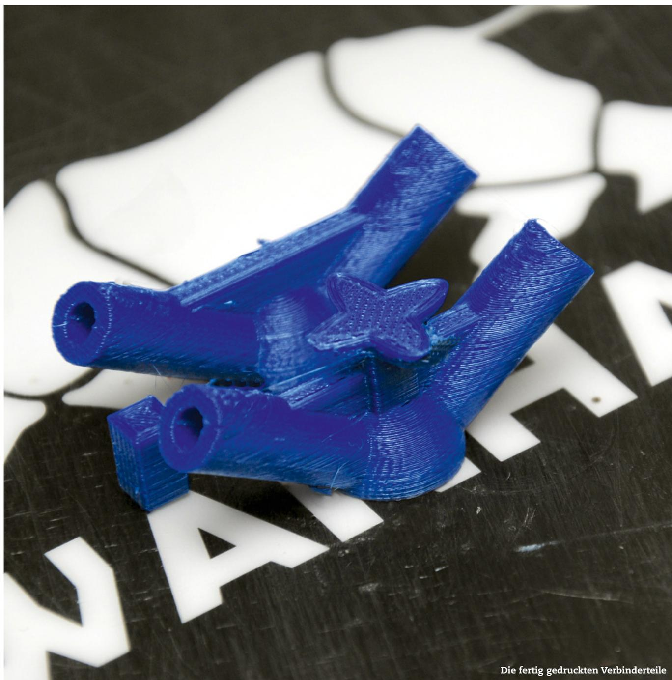
Die fertig gedruckten Verbinderteile
