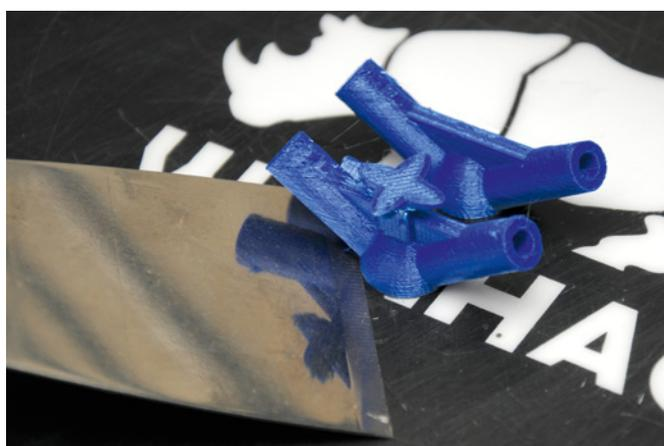
Die fertig gedruckten Bauteile werden mit einem Spachtel vorsichtig abgehoben
