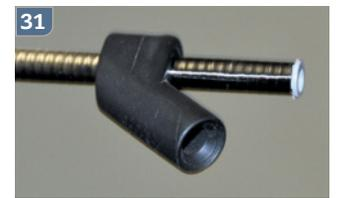
(26) Per Lochzange werden die Löcher gestanzt (27) Abschmelzen der Fadenreste (28) Das Aerostuff-Gestänge wird zugeschnitten (29) Muffen per Sekundenkleber einkleben (30) Trick: Dübel statt Endkappe (31) Eingesetzter Dübel und APA-Verbinder
