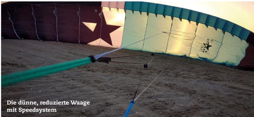
Die dünne, reduzierte Waage mit Speedsystem
