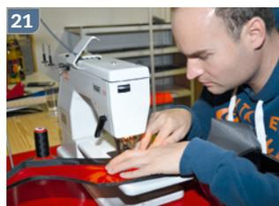
**(19)** Kielabspannung mit Mylarverstärkung, Flausch- und Klettband **(20)** Die Stabausschnitte werden heißgeschritten, aber an der frischen Luft **(21)** Langsames, konzentriertes Aufnähen der Dacron-Stabtaschen
