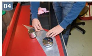
(01) Sauber gerolltes Icarex, bereit zur Verarbeitung (02) Klare Pläne geben den Aufbau von Segel und Gerüst vor (03) Das Tuch wird elektrostatisch aufgeladen, damit es auf der Platte klebt (04) Die Metallschablone auflegen, fixieren und das Paneel scharf schneiden (05) Vorn die Schablonen und hinten der fertige Zuschnitt (06) Ohne Zug wird das doppelseitige Tape aufgebracht (07) Die Paneele werden exakt ausgerichtet (08) Nachprüfen, ob die Kanten genau gerade sind
