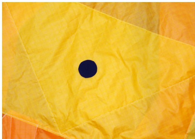
Untere Waageverstärkung auf der Rückseite
