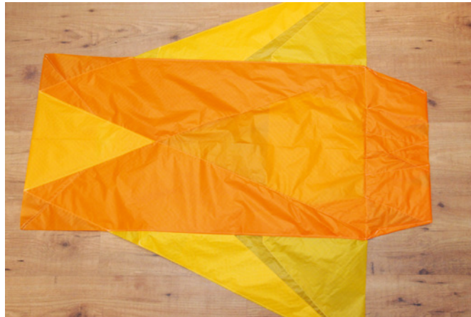
Die untere Spitze des vorderen Segels wird über das hintere Segel gelegt und vernäht
