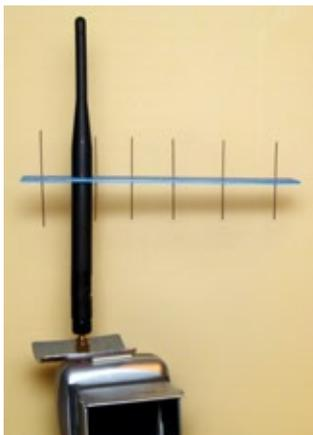
**Yagi-Uda-Antenne, berechnet für 2,4 GHz (mit Gelenk!); Grundantenne: Wireless-LAN-Antenne, Frequenz: 2,4–2,5 GHz, Gewinn: 5,0 dB; Impedanz: 50 Ohm**
