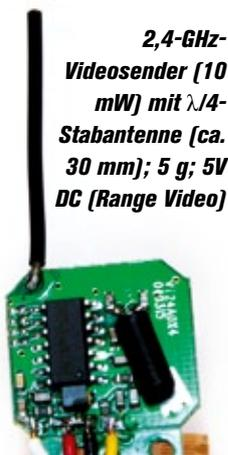
**2,4-GHz-Videosender (10 mW) mit  $\lambda/4$ -Stabantenne (ca. 30 mm); 5 g; 5V DC (Range Video)**
