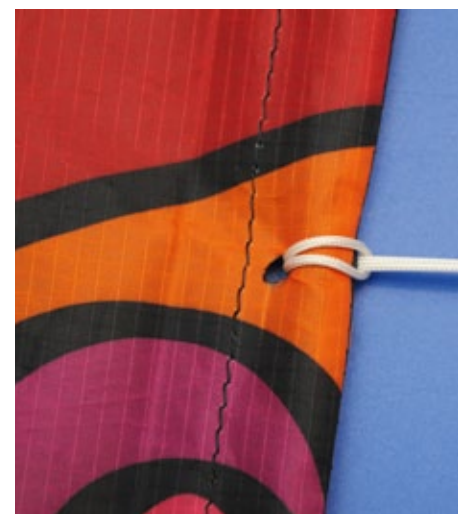
Für die Waageaufhängung wurde ein Loch in den Kiel gebrannt
