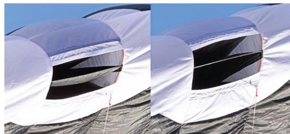
**Hier die Lufteinlässe mit Adaptive Maximum Pressure Valves: links depowert mit Strömung auf die Nase, rechts angepowert mit Strömung von der Kappenseite**
