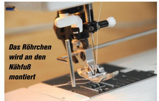
**Das Röhrchen wird an den Nähfuß montiert**
