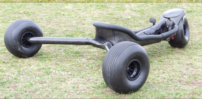
Fertiger Spider-Buggy, mit einem Chassis hauptsächlich aus Carbon
