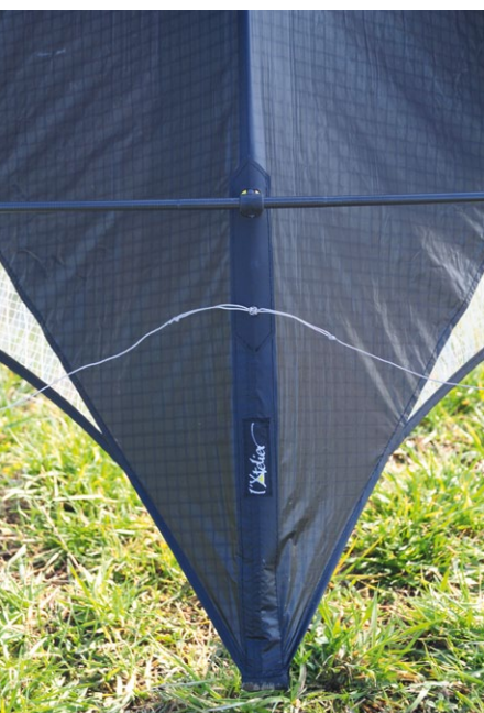
Die Waage ist weiter unter dem Mittelkreuz angebracht
