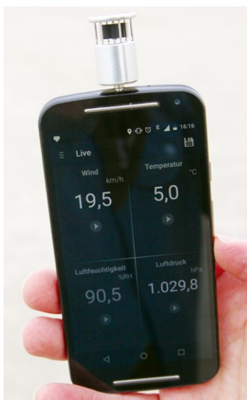
Messung von Windstärke, Temperatur, Luftfeuchte und Luftdruck beim Windoo 3
