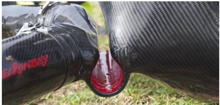
Hier sitzt das Monocoque gefedert an den hinteren Längslenkern
