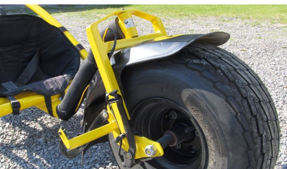
An der Vorderradgabel wurde der Bremshebel installiert
