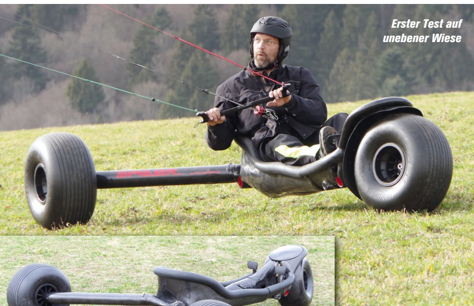
Fertiger Spider-Buggy, mit einem Chassis hauptsächlich aus Carbon
