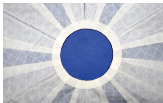
Das Loch in der Mitte wird heißgeschnitten und mit einem Ring aus Dacron gesäumt
