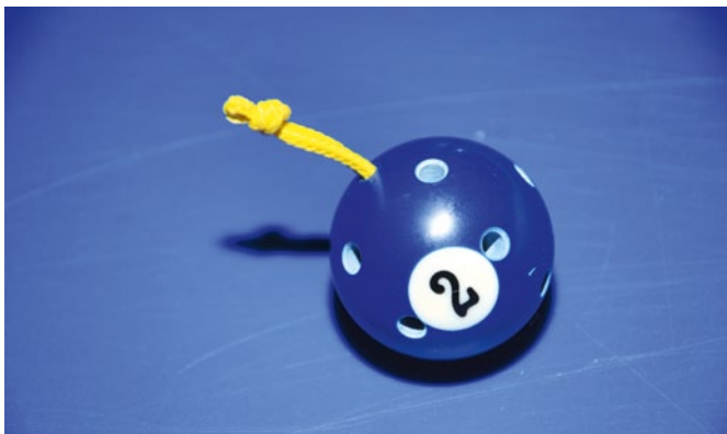
Billardkugel als Mittelverbinder
