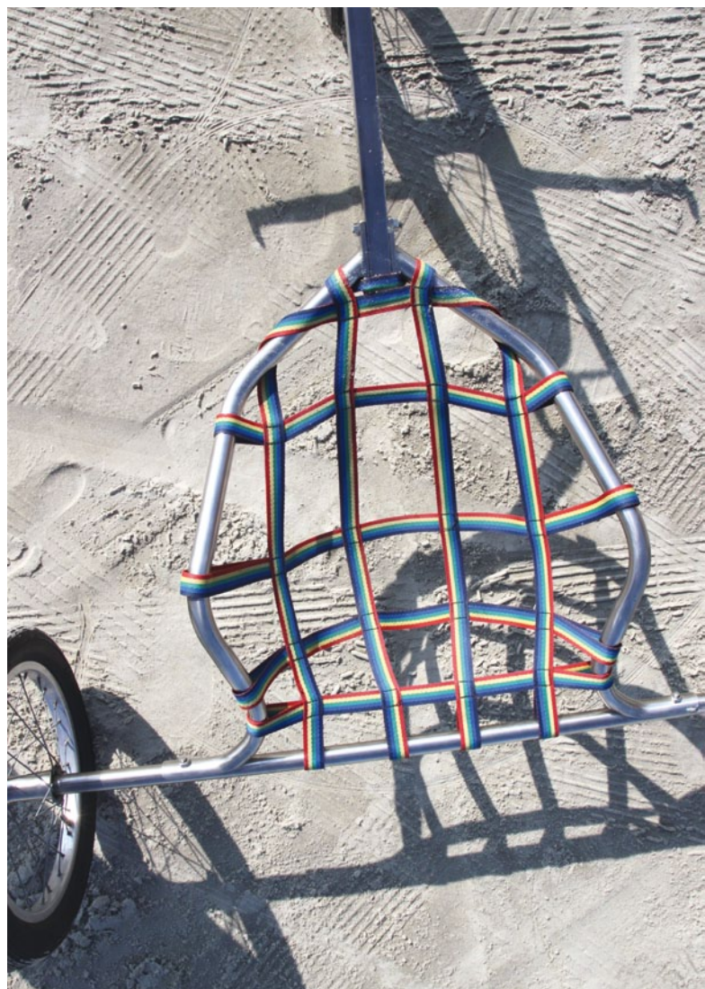
Der leichte, flache Rahmen und das dünne Gurtgeflecht sollten die Zugkräfte aufnehmen: Bequemlichkeit war Fehlangezeige
