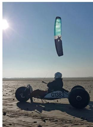
lometer auf dem GPS. Das Flattern der Schleppe ist auf ein Minimum dessen reduziert, was eben für diese Art der Depower-Funktion nötig ist, und der Giereffekt beim Depowern, der den Kite ohne Flattern effektiv und ohne Seitenzug nach vorne laufen lässt, ist deutlich ausgeprägter als beim Bruder ohne Stäbchen im Segel.
