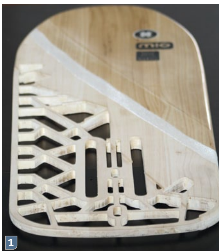
Aufbau-Muster: vorne die gefräste Kernstruktur und hinten die Toplage mit Finish (1). Passende Plugs für die Fußschlaufen (2). Aufnahme des Flügels mit Carbon verstärkt (3)
