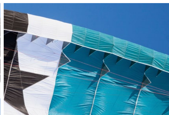
Stabil ausgebildete Leitkante und einfache Dreieckskiele
