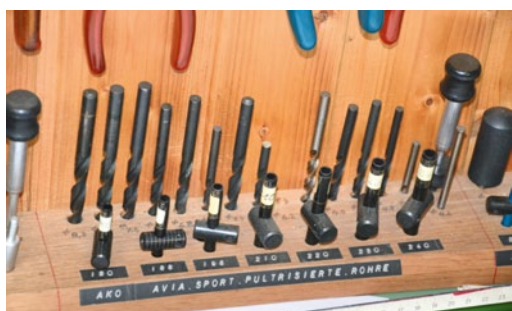
FSD-Verbindungstechnik, hier die Varianten für die gängigen pultriierten Avia-Stäbe zwischen 4,6 und 6,1 Millimetern Durchmesser
