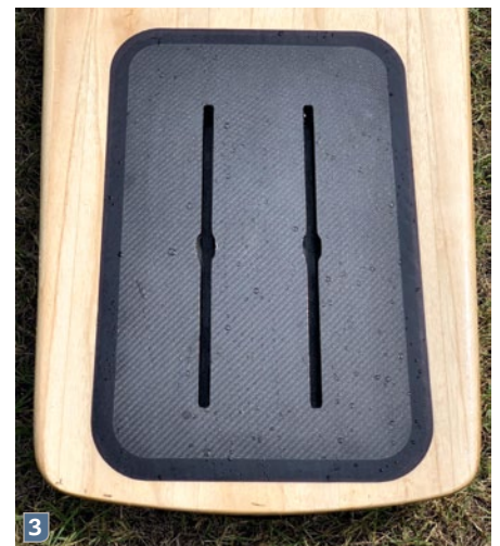
Aufbau-Muster: vorne die gefräste Kernstruktur und hinten die Toplage mit Finish (1). Passende Plugs für die Fußschlaufen (2). Aufnahme des Flügels mit Carbon verstärkt (3)
