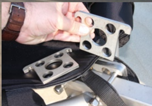
Ausgeklügelt: Dank dieser Platten kann die Sitzbreite um gut 3,5 Zentimeter verstellt werden
