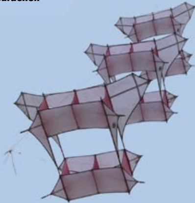
Das Saconney-Manlifting-System wurde erfolgreich eingesetzt
