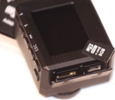
Kamera-Ausgänge und Platz für zwei Micro-SD-Karten
