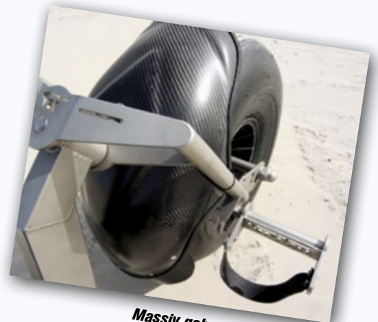
Massiv gebaute Deichsel und Fußrasten mit Trittsflächen
