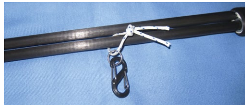
7. Spreize mit Stahlring und Karabiner durch Waageschleufe (klein, aber frei beweglich) befestigen
