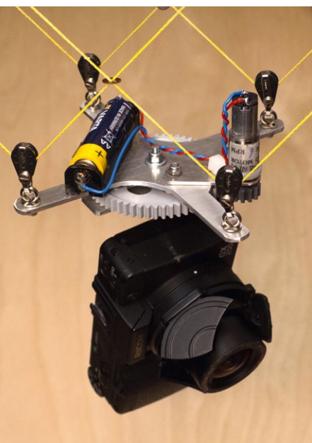
Wolfgang Biecks 1,5-Volt-Panorama-Auto-KAP-Rigg mit einer Umdrehung in 75 Sekunden, dank zwei Zahnrädern mit 13 Zähnen am Motor und 58 Zähnen an der Kamera
