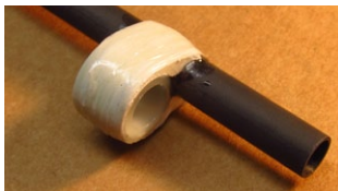
2. Eine dünne Schicht Epoxy-Kitt um Abstandhalter und Stab, zum Beispiel WIKO EPOKGN 56 von Reichelt Elektronik
