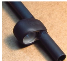
5. Ausgehärtete Verbindung mit einem Stück Schrumpfschlauch umhüllen
