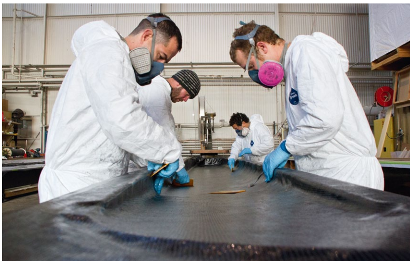
Fertigung der Bauteile des Boots aus Carbon
