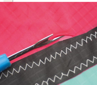
Ein unachtsamer Augenblick und schon hat man einen Schnitt im applizierten Segel
