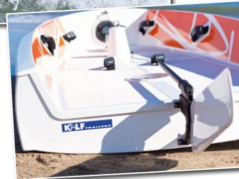
Flaches Heck mit Self Draining Cockpit
