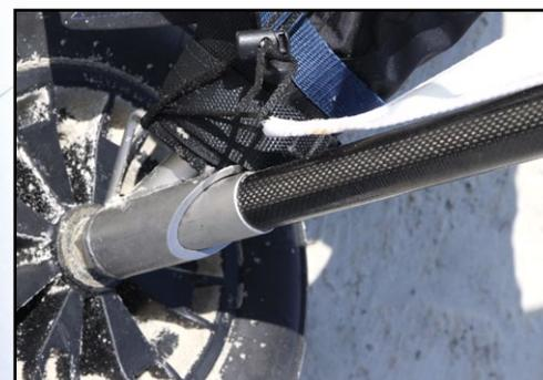
**Feinste Materialien: Hinterachse aus Kohlefaser mit passender Aufnahme**
