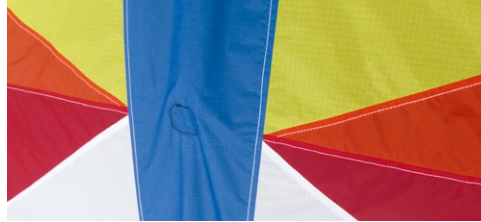
Sauber ausgeführte Kappnähte halten die Segelpaneele zusammen
