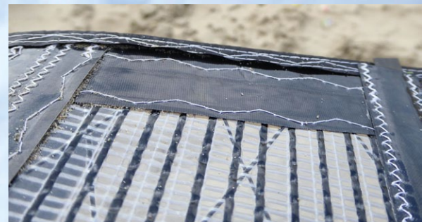
High-End-Verarbeitung, doch hier steht die Saumbandkante etwas ab
