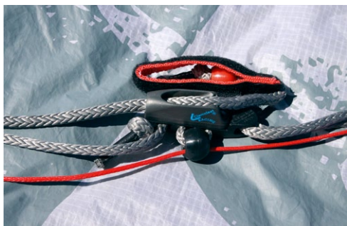
Clamcleat-Adjuster mit Klettbandfixierung der Schlaufe
