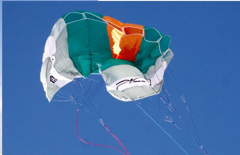
Ausgelöst: Über die linke Schleppkante geht die Twice hier in den Backstall
