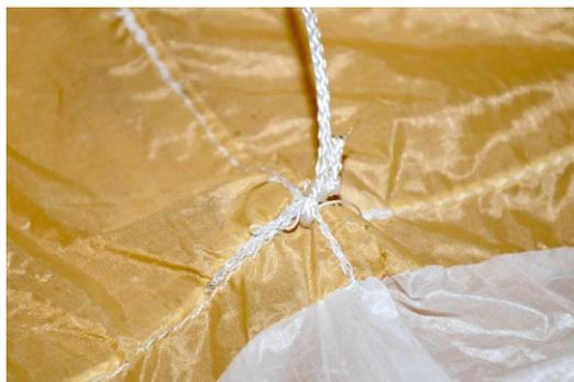
Aufhängungen der großzügig dimensionierten Waage am Schnurkreuz
