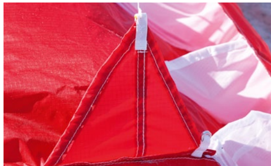
Die kleinen Kiele sind der Dreh- und Angelpunkt der Anstellwinkelveränderung
